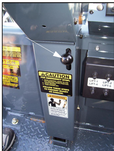
Alavanca de travamento da inclinação da coluna de direção (Localizado no centro da coluna de direção) -Vista típica
