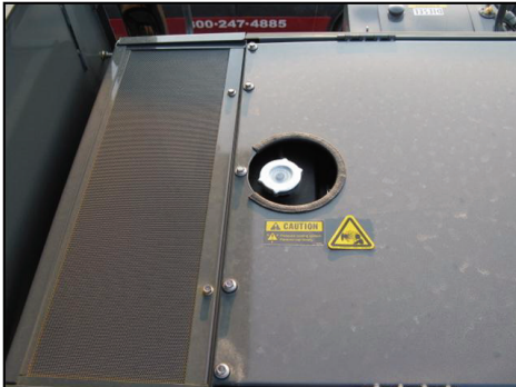
Tampa do radiador (Localizado atrás da estação do operador) of the operator's station) -Vista típica
