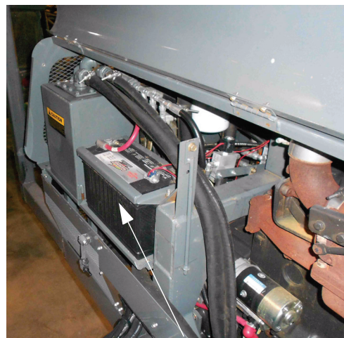
Acesso à bateria (Localizado atrás do painel lateral traseiro do lado direito) right-hand side panel) -Típica instalação mostrada
