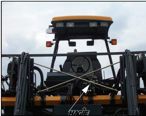
Válvula de dobra hidráulica (Localizada na barra central de ferramentas) -Vista típica
