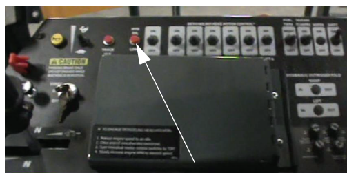
Indicador de nível baixo de óleo hidráulico (Localizados no console lateral) -Vista típica
