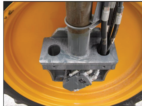
Ponto de reboque -Vista típica
