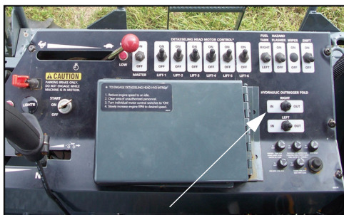
Retranca hidráulica Direita/Esquerda Interruptores de válvula de dobra (Localizado no console lateral) -Vista típica
