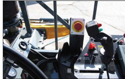
Interruptor E-Stop (Parada de emergência) (Localizado perto do console lateral) -Vista típica
