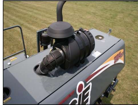
Filtro de admissão de ar do motor (Retire a tampa da extremidade do limpador de ar para acessar) -Vista típica
