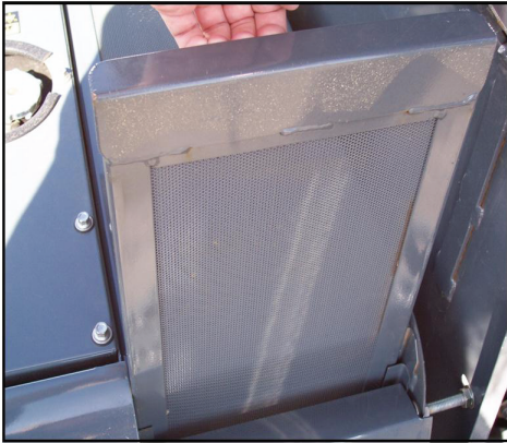
Tela de grade lateral (Deslize para fora da carcaça do radiador para remover) -Vista típica
