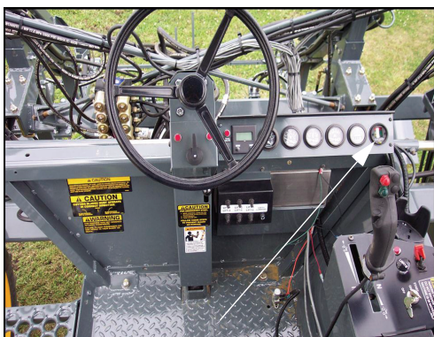
Filter Minder (Localizado perto da estação do operador) -Vista típica
