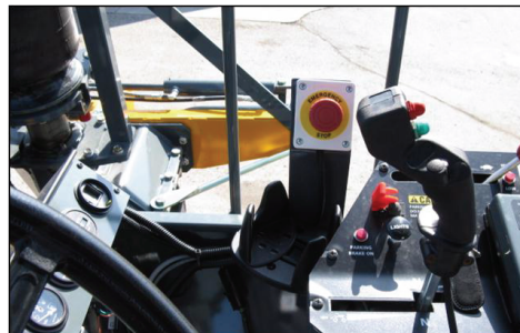
Prekidač za nužni stop (smešten blizu bočne konzole) - Uobičajeni izgled
