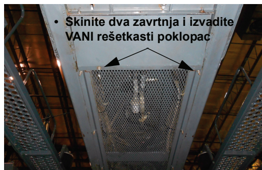
Rešetkasti poklopac (smešten na donjoj strani mašine) -Pogled prema zadnjem kraju mašine
