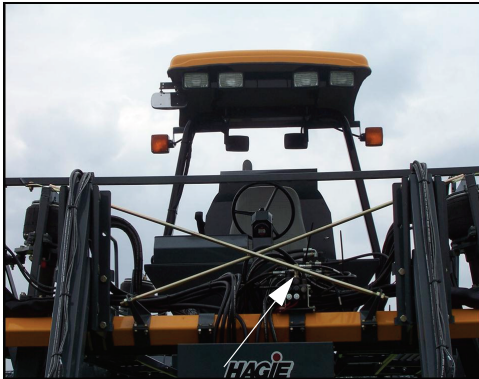
Hidraulični ventil za sklapanje (smešten na centralnom nosaču alata) - Uobičajeni izgled
