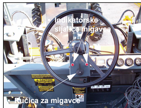
Ručica i indikatorske sijalice migavca (smešteni na stubu volana) - Uobičajeni izgled
