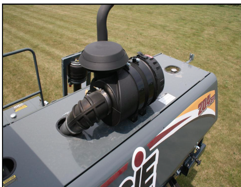
Filter usisnog sistema motora (skinite gornji poklopac filtera za vazduh za pristup) - Uobičajeni izgled
