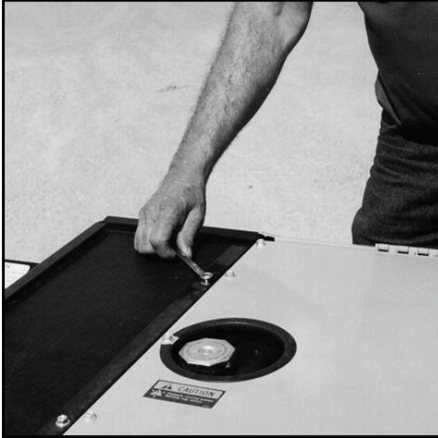
Gornje sito hladnjaka (skinite dva zavrtnja na panelu hladnjaka/panel za pristup) - Uobičajeni izgled
