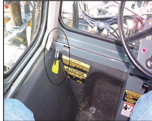
Alat "Res-Q-Me" (smešten na levoj strani kabine) -Prikazana je uobičajena instalacija
