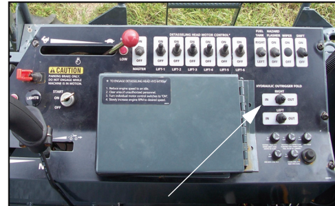
Leva/desna hidraulična konzola Prekidači za ventil za sklapanje (smešten na bočnoj konzoli) - Uobičajeni izgled
