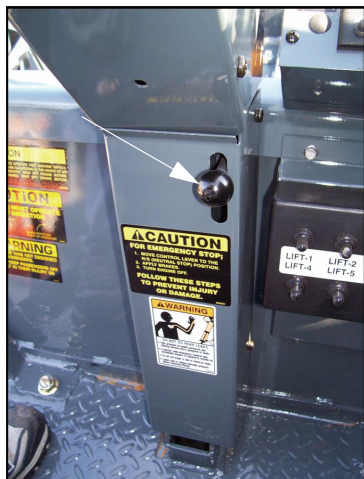
Poluga za blokiranja nagiba stuba upravljača (smeštena u sredini stuba upravljača) - Uobičajeni izgled
