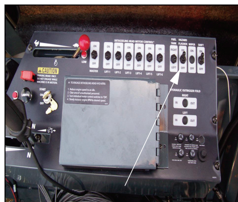
Prekidač svetla upozorenja (smešten na bočnoj konzoli) - Uobičajeni izgled
