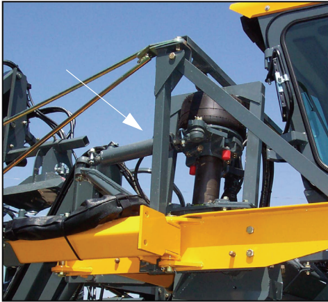
Cilindri upravljača (montirani na krajeve obe upravljačke spone i spoljnih zavarenih konstrukcija kraka) - Uobičajeni izgled
