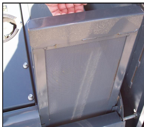
Bočno sito hladnjaka (za skidanje izvucite vani iz kućište hladnjaka) - Uobičajeni izgled
