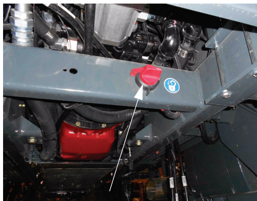
Prekidač za isključivanje akumulatora (smešten na zadnjem ramu) - Uobičajeni izgled
