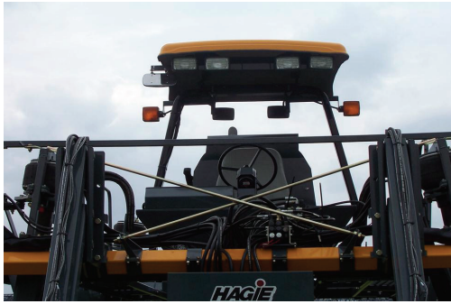
Radna svetla (smeštena na prednjem i zadnjem kraju nadstrešnice ili kabine) - Uobičajeni izgled
