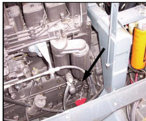
Uređaj za pumpanje goriva (smešten na levoj strani motora) - Uobičajeni izgled
