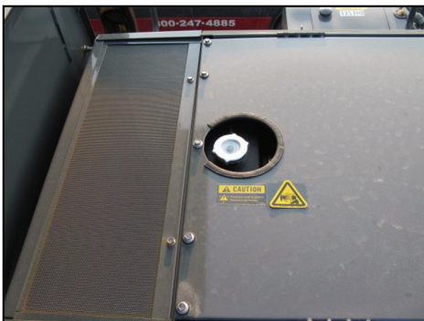
Poklopac hladnjak (smešten iza zadnje strane radne stanice vozača) - Uobičajeni izgled
