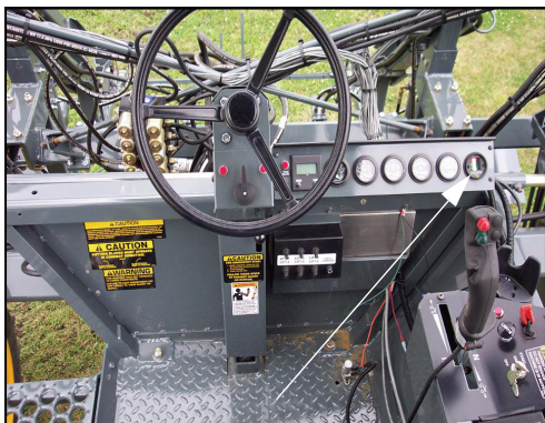
Uređaj Filter Minder (smešteni blizu radne stanice vozača) - Uobičajeni izgled
