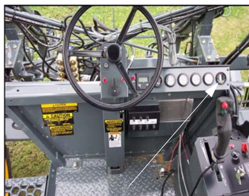
Індикатор стану фільтра "Filter Minder" ( поруч із робочим місцем оператора) -Типовий вигляд
