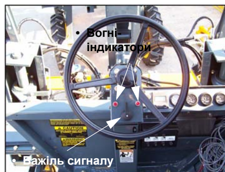
Важіль сигналу повороту та вогні-індикатори сигналу повороту (Розташовані на кермовій колонці) -Типовий вигляд
