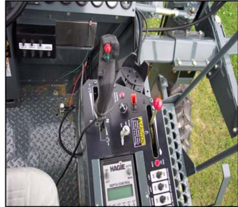
Перемикач робочих вогнів (Розташований на бічній консолі) -Типовий вигляд
