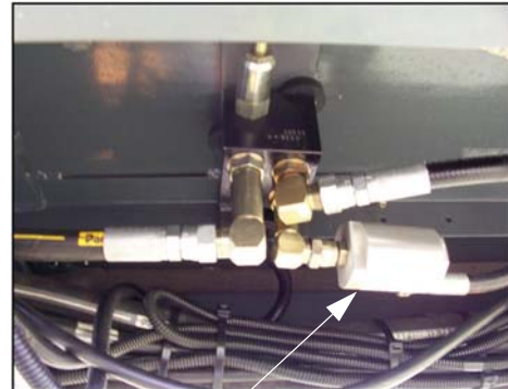
90-мікронний лінійний фільтр (Вид із знятою захисною решіткою) -Типовий вигляд
