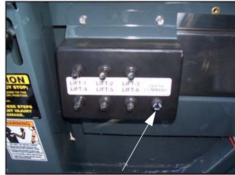
Запобіжник управління глибиною. (Розташований на панелі перемикача підйомників) -Типовий вигляд
