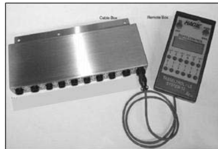
Панель управління системою "Tasselrol" (Розташований біля бічної панелі оператора)
