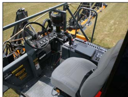
Вимикач присутності оператора Запускайте двигун лише знаходячись у сидінні оператора.
