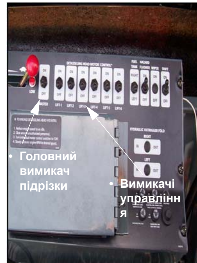
Головний вимикач підрізки та Вимикачі управління підрізкою (Розташовані на бічній консолі) -Типовий вигляд
