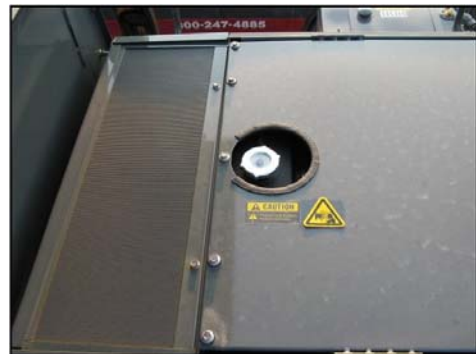
Кришка радіатора (Розташована за задньою частиною робочого місця оператора) -Типовий вигляд
