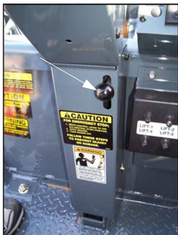
Стопорний важіль регулювання нахилу кермової колонки (Розташований по середині кермової колонки) -Типовий вигляд
