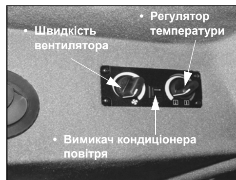
Органи регулювання клімату (на обшивці стелі кабіни) -Типовий вигляд
