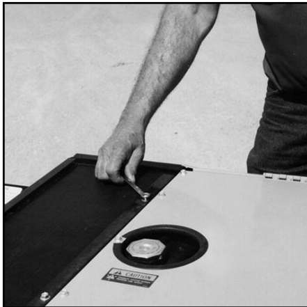
Верхня захисна решітка (Зніміть два болти панелі радіатора та панель для доступу) -Типовий вигляд
