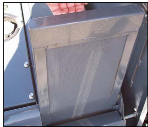
Бічна захисна решітка (Щоб зняти, висуньте її з кріплення на радіаторі) -Типовий вигляд
