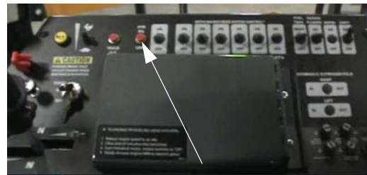
Індикатор низького рівня гідравлічного мастила (Розташовані на бічній консолі) -Типовий вигляд
