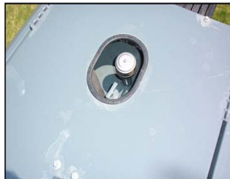
Щуп перевірки рівня гідравлічного мастила (Розташований на верхній частині ємності гідравлічного мастила) -Типовий вигляд
