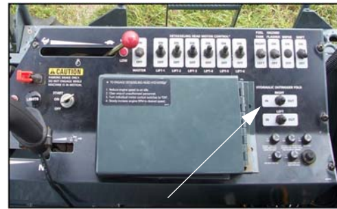
Перемикачі правого/лівого гідравлічного клапана складання консольної балки (Розташований на бічній консолі) -Типовий вигляд
