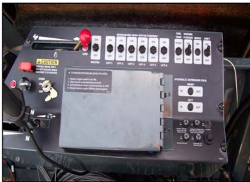
Перемикач вибору паливного бака (Розташований на бічній консолі) -Типовий вигляд
