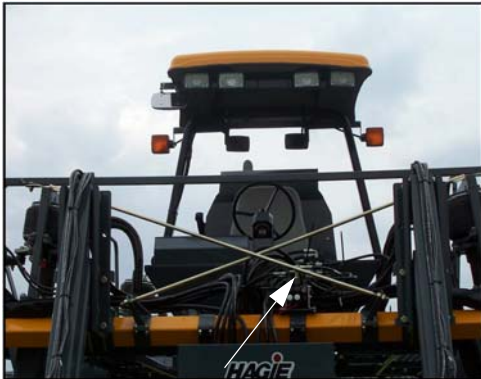
Гідравлічний клапан складання (Розташований на центральній балці навісного обладнання) -Типовий вигляд
