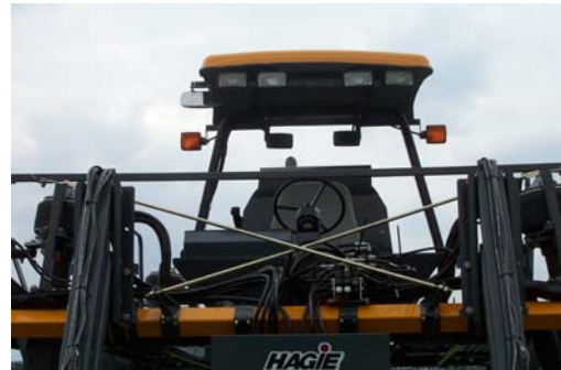
Робочі вогні (Розташовані на передній та задній частинах навісу або кабіни) -Типовий вигляд
