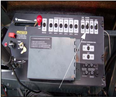
Вимикач аварійної сигналізації (Розташований на бічній консолі) -Типовий вигляд
