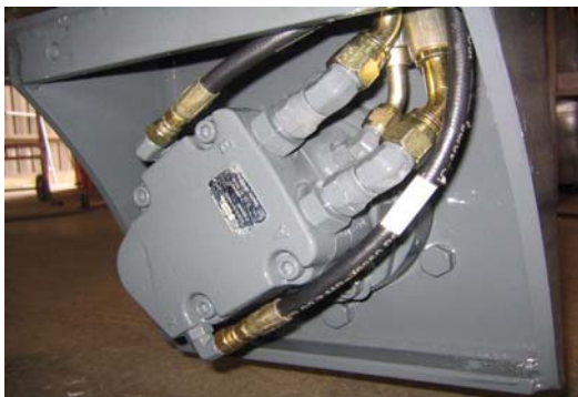
Передні та лівий задній колісні гідромотори
