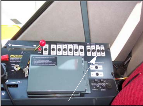
Перемикач очисника лобового скла (Розташований на бічній консолі) -Типовий вигляд
