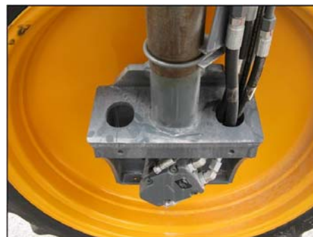
Точка кріплення буксирувальних ланцюгів -Типовий вигляд
