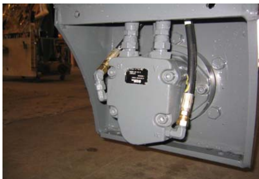
Задній правий колісний гідромотор (із сенсором)
