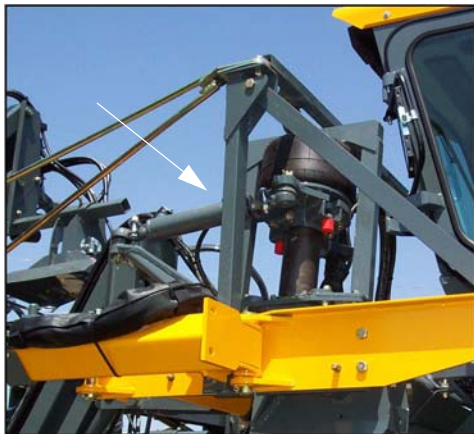
Кермові циліндри (Встановлені на обох передніх кермових тягах та зовнішніх зварних деталях стійок) -Типовий вигляд
