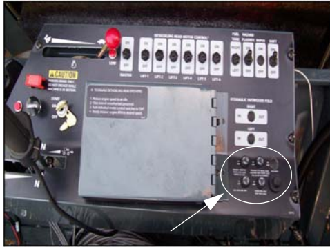
Плавкі запобіжники (Розташовані на бічній консолі) -Типовий вигляд
