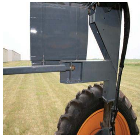
Задня стопорна гайка (розташована на дужці опори) -Типовий вигляд
