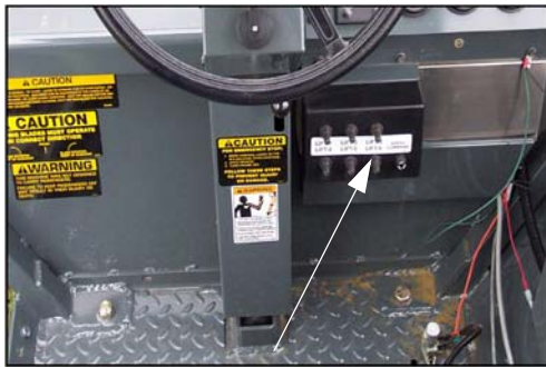
Перемикачі управління глибиною (Розташовані поруч із робочим місцем оператора) -Типовий вигляд
