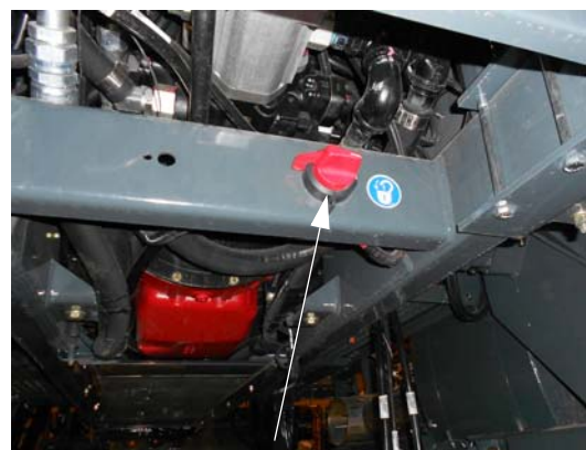
Вимикач акумуляторної батареї (Розташований на задній рамі) -Типовий вигляд
