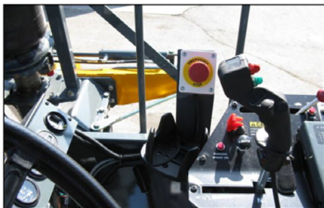
Вимикач E-Stop (Розташований біля бічної панелі оператора)
