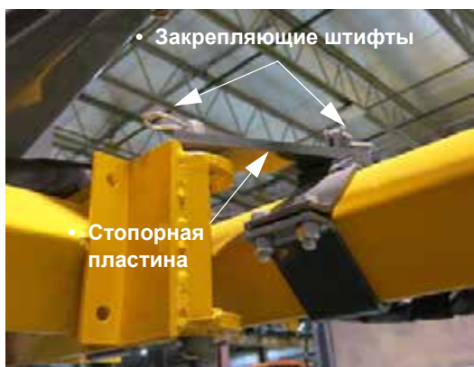
Закрепляющий штифт/Стопорная пластина в сборе (расположены между выносной опорой и центральной инструментальной оправкой) – стандартный вид
