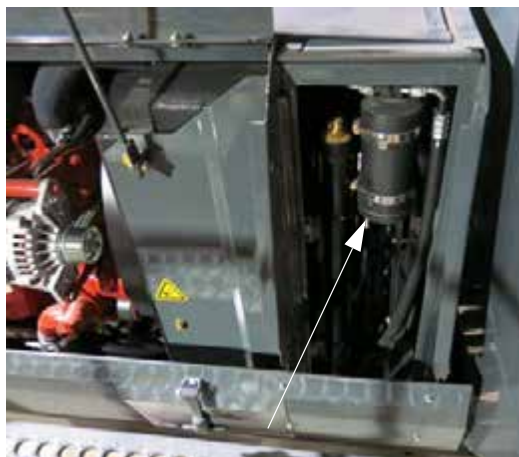
Приемник/осушитель системы кондиционирования (расположен за кабиной возле радиатора – для доступа снимите жалюзи радиатора) – стандартный вид
