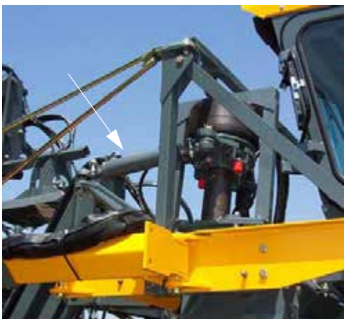
Цилиндры рулевого управления (расположены на обеих передних рулевых сошках и наружных сварных опорах) – стандартный вид
