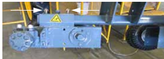
Болты счетверенного корчевателя (на каждой опорной трубе корчевателя) – стандартный вид
