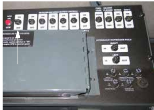
Главный выключатель машины для удаления метелок кукурузы (расположен на боковой панели) – стандартный вид
