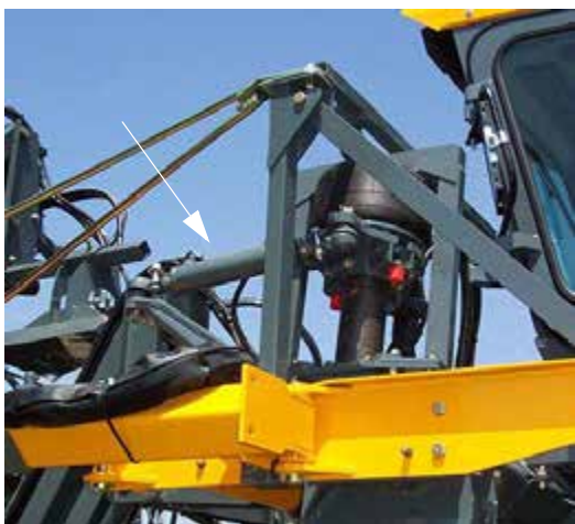
转向油缸 (位于两个前转向臂和外侧立腿焊接件上) - 典型视图
