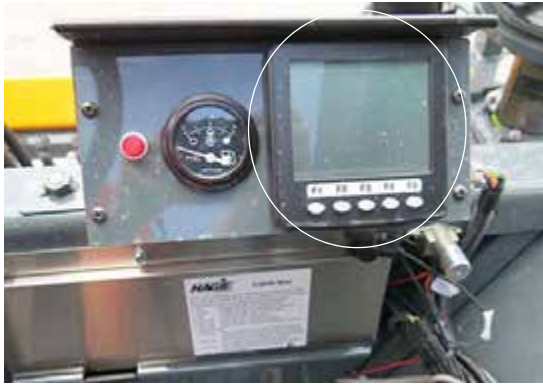
发动机监控器显示屏 (位于操作员工作站前端的附近) - 典型视图
