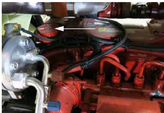
发动机加油口 (位于发动机的左侧 - 打开护罩可以够着) - 典型视图
