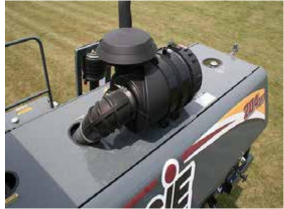
发动机进气过滤器 (位于机器后侧附近 - 拆除空气净化器端盖后可以够着) - 典型视图
