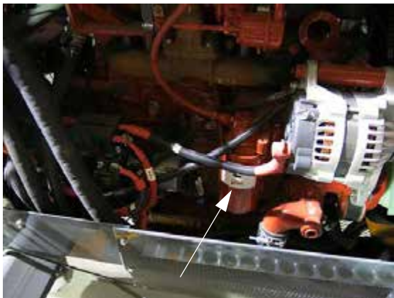
发动机油过滤器 (位于发动机的右手侧 - 打开护罩可以够着) - 典型视图
