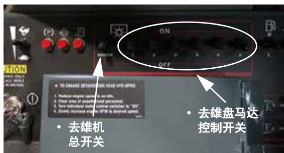
去雄机总开关和去雄盘马达控制开关 （位于侧控制台上） - 典型视图
