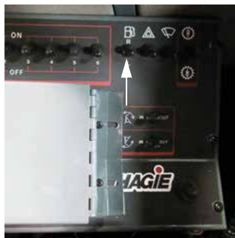
燃油箱选择器开关 （位于侧控制台上） - 典型视图
