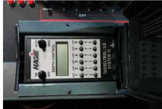
Tasselrol/LS System 12 控制面板 （位于侧控制台上 - 提起盖子进入） - 典型视图
