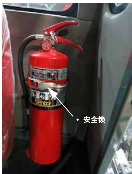
灭火器 (位于操作员座椅的侧面) - 典型视图
