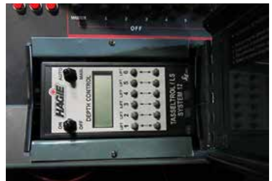
Tasselrol/LS 系统 12 控制面板 (位于侧控制台上 - 提起盖板可以够着) - 典型视图
