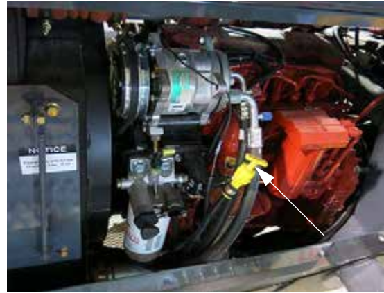
发动机油尺 (位于发动机左手侧 - 打开护罩可以够着) - 典型视图
