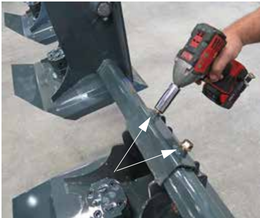
Vágófej csavarjai (Minden egyes vágó fej rögzítő csövön egy van elhelyezve) - Tipikus nézet
