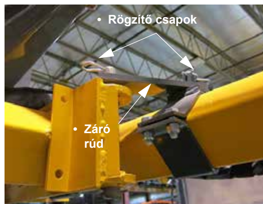
Rögzítő csap/záró rúd összeszerelés (a szerelvényhordó gémkar, és a középső szerelvényhordó rúd között helyezkedik el) - Tipikus nézet
