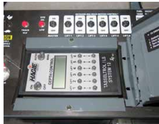
Tasseltról/LS System 12 vezérlőpult (oldalsó vezérlőpulton - hozzáféréshez hajtsa fel a védlapot) - Tipikus nézet
