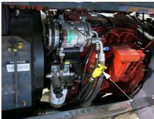
Motorolaj nívópálca (a gép hátsó, bal kéz felőli részén helyezkedik el - a hozzáféréshez nyissa fel a motorháztetőt) - Tipikus nézet
