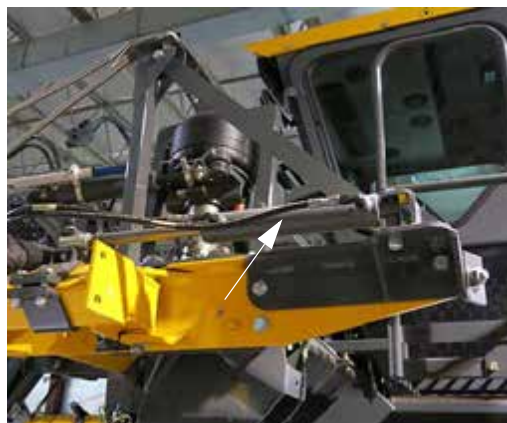
Hidraulikus hajtású henger (a szerelvényhordó gémparkhoz, és a központi szerszámtartó rúdhoz van csatlakoztatva) - Tipikus nézet
