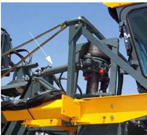
Kormány munkahengerek (Mind az elülső vezérlő karokra, mind a külső láb hegesztésekre fel van szerelve) - Tipikus nézet
