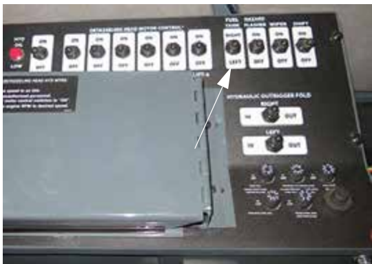
Üzemanyag tartály választó kapcsoló (oldalsó vezérlőpulton) - Tipikus nézet
