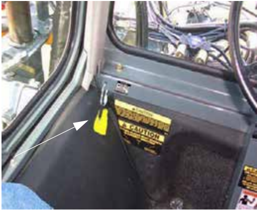
Vészhelyzeti üvegtörő eszköz (a fülke bal kéz felőli oldalához közel) - Tipikus nézet
