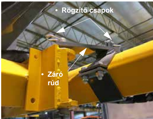
Rögzítő csap/záró rúd összeszerelés (a szerelvényhordó gémkar, és a középső szerszámtartó rúd között helyezkedik el) - Tipikus nézet
