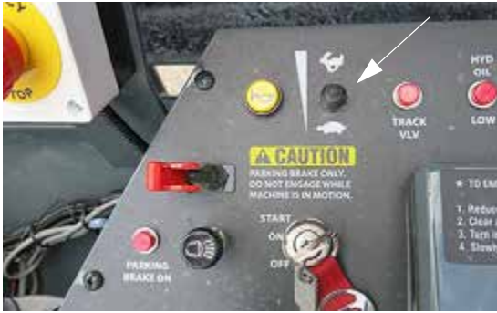
Fojtáskapcsoló (oldalsó vezérlőpulton) - Tipikus nézet
