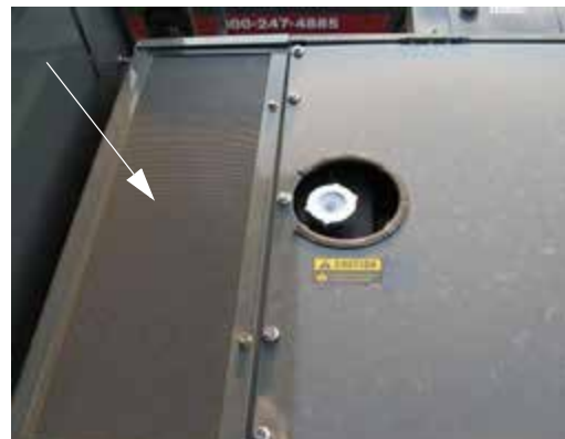
Felső hűtőrács külső része (Távolítsa el a két radiátor panel csavart a panelhoz való hozzáféréshez) - Tipikus nézet
