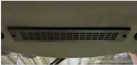
Friss levegő vezetőfülke szűrőhöz való hozzáférés (A vezetőfülke tetőkárpitjában helyezkedik el) - Tipikus nézet
