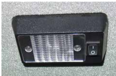
Belső munkalámpa (a kezelőfülke tetőkárpitján) - Tipikus nézet
