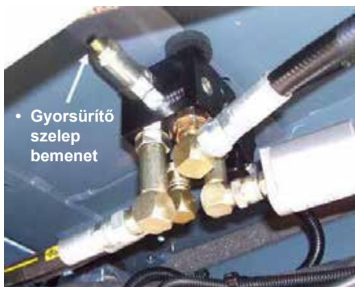
Gyorsűrítő szelep (a kezelő ülése alatt helyezkedik el) - Tipikus nézet
