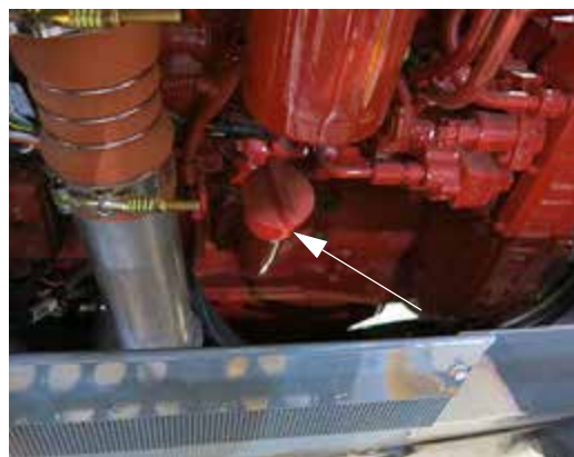
Közvetett motorolaj töltés csatlakozó (a gép hátsó, bal kéz felőli részén helyezkedik el - a hozzáféréshez nyissa fel a motorháztetőt) - Tipikus nézet
