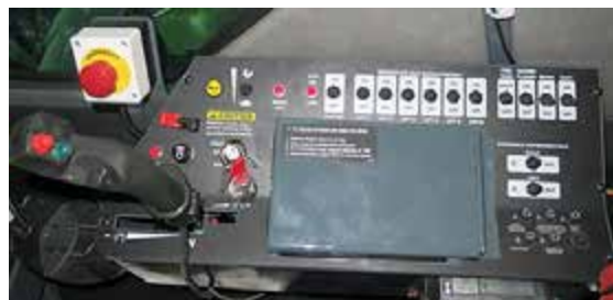
Hozzáférés az árammegszakítóhoz (az oldal konzol alatt helyezkedik el - a hozzáféréshez távolítsa el a hidrosztatikus hajtás vezérlő karját, és a felső panel csavarjait) - Tipikus nézet
