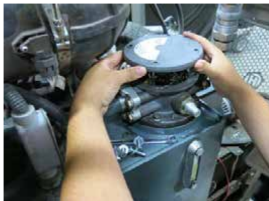
Llenar el tanque por el alojamiento del filtro de retorno hidráulico - Vista típica
