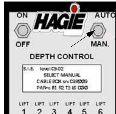
Interruptor manual/automático (ubicado en el panel de control Tasselrol)
