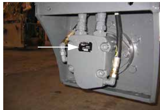
Placa de identificación (con sensor) del motor de la rueda trasera derecha -Vista típica
