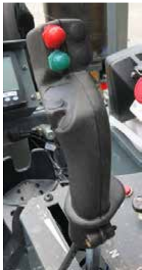
Palanca de control de la transmisión hidrostática (ubicada en la consola lateral) -Vista típica
