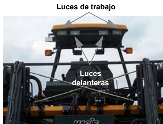
Luces delanteras/luces de trabajo -Vista típica
