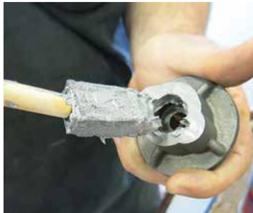
Aplicación de lubricante antiagarrotamiento -Vista típica
