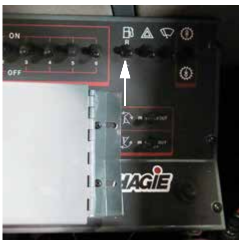
Interruptor selector de depósito de combustible (ubicado en la consola lateral) -Vista típica
