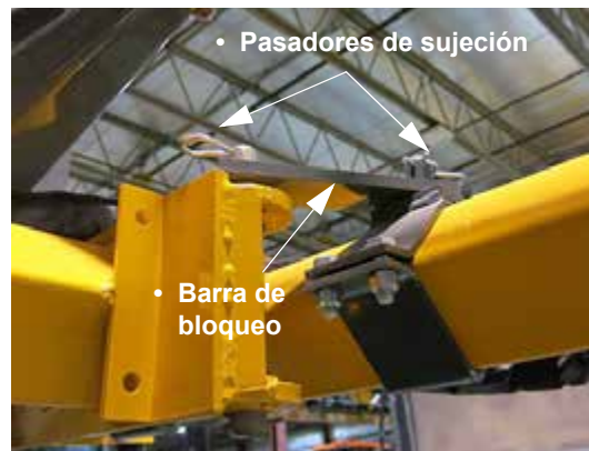
Conjunto de la barra de bloqueo/pasadores de sujeción (ubicado entre el estabilizador y la barra de herramientas central) -Vista típica
