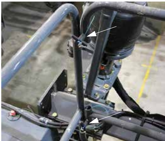
Pasadores del pasamanos (ubicados en la parte superior e inferior de la extensión del pasamanos) -Vista típica
