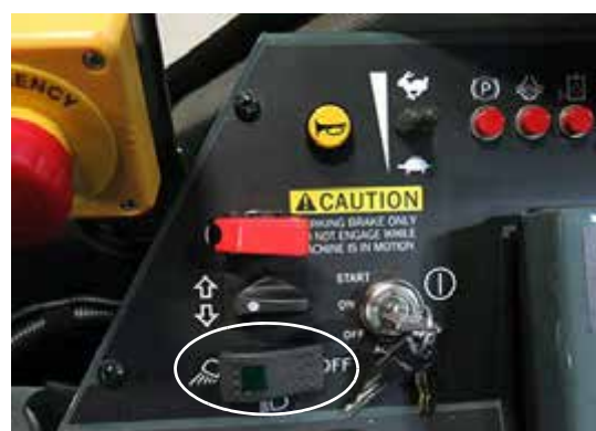
Interruptor de las luces (ubicado en la consola lateral) -Vista típica
