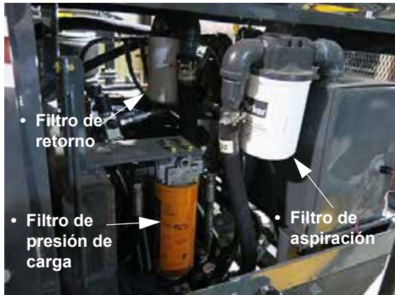
Filtros de retorno, presión de carga y aspiración (ubicados cerca del lado izquierdo de la parte trasera de la máquina, abra el capó para acceder a los filtros) -Vista típica
