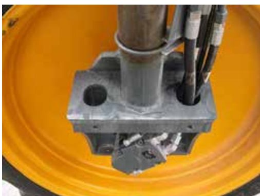
Punto de remolque (ubicado en cada pata) -Vista típica
