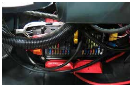
Caja de fusibles/relés (con la tapa quitada) - Vista típica
