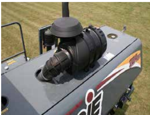
Filtro de la admisión de aire del motor (ubicado cerca de la parte trasera de la máquina, quite la tapa de cierre del filtro de aire para acceder al filtro) -Vista típica
