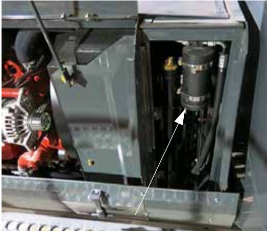
Receptor/secador del sistema de aire acondicionado (ubicado detrás de la cabina cerca del radiador, quite las pantallas del radiador para acceder) -Vista típica
