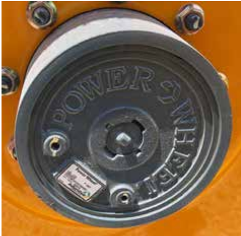
Placa de identificación del cubo planetario de la rueda -Vista típica ta típica
