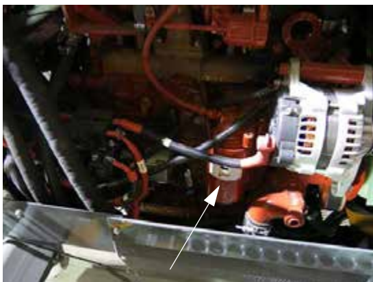
Filtro de aceite del motor (ubicado en el lado derecho del motor, abra el capó para acceder al filtro) -Vista típica
