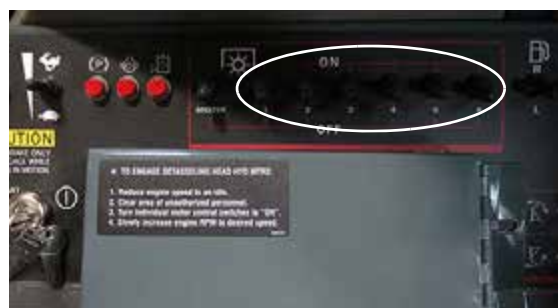
Interruptores de control de los motores de los cabezales de despenachado (ubicados en la consola lateral) -Vista típica
