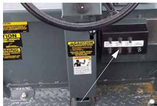
Interruptores de control de profundidad (ubicados cerca de la parte delantera del puesto del operador) -Vista típica
