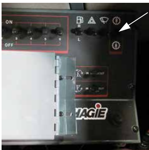
Interruptor selector de marchas (ubicado en la consola lateral) -Vista típica
