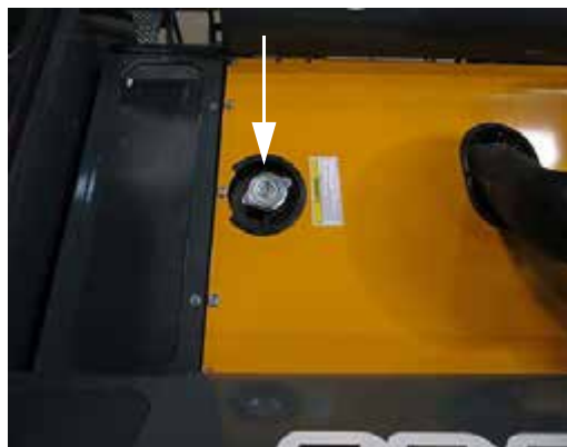
Tapa del radiador (ubicada detrás del puesto del operador) -Vista típica
