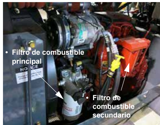
Filtros de combustible principal y secundario (ubicados en el lado izquierdo del motor, abra el capó para acceder a los filtros) -Vista típica
