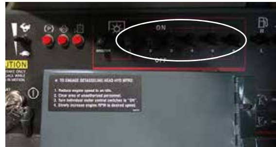
Interruptores de control de los motores de los cabezales de la despenachadora (ubicados en la consola lateral) -Vista típica
