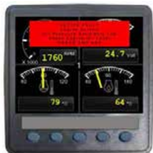
Advertencia de falla activa - Vista típica
