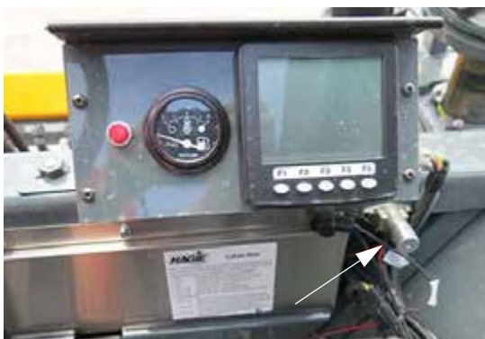
Interruptor de las válvulas de tracción - Delanteras (ubicado cerca de la parte delantera del puesto del operador) -Vista típica
