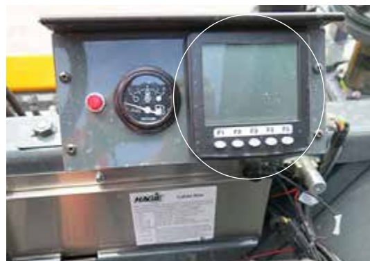
Pantalla del monitor del motor (ubicado cerca de la parte delantera del puesto del conductor) -Vista típica
