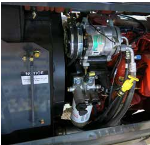
Puerto de carga del aire acondicionado (ubicado en el lado izquierdo de la máquina, abra el capó para acceder) -Vista típica
