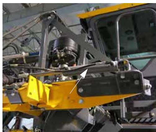
Cilindro de replegado hidráulico (unido al estabilizador y la barra de herramientas central) -Vista típica
