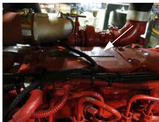
Placa de identificación del motor -Vista típica
