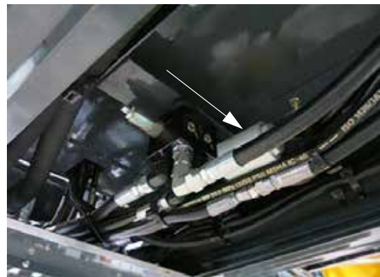
Filtro en línea de alta presión (ubicado debajo de la máquina, bajo el panel delantero de la pantalla y retírelo para acceder) - Vista típica
