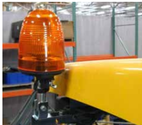
Faro giratorio (ubicado en el lado izquierdo del puesto del operador) -Vista típica
