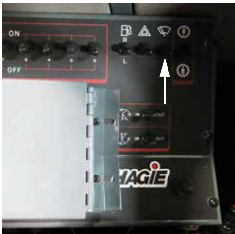
Interruptor del limpiaparabrisas (ubicado en la consola lateral) -Vista típica
