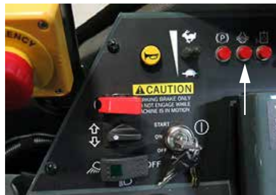
Indicador de la válvula de tracción (ubicado en la consola lateral) -Vista típica
