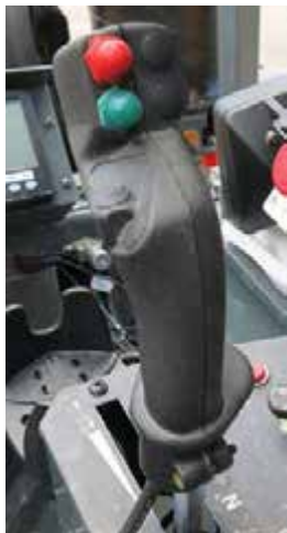
Palanca de control de la transmisión hidrostática (ubicado en la consola lateral) -Vista típica
