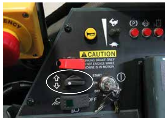
Interruptor de las luces direccionales (ubicado en la consola lateral) -Vista típica
