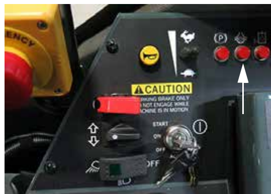
Indicador de válvulas de tracción (Ubicado en la consola lateral) -Vista típica
