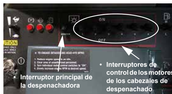
Interruptor principal de la despenachadora e interruptores de control de los motores de los cabezales de despenachado (ubicados en la consola lateral) -Vista típica
