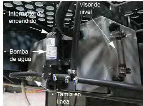
Depósito para lavado de manos (ubicado debajo de la plataforma izquierda) -Vista típica
