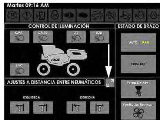
Botón de la página de distancia entre neumáticos (ubicado en la página de controles auxiliares de la pantalla de la máquina)
