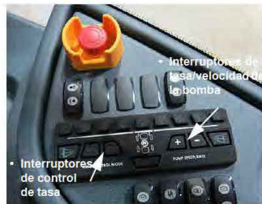
Interruptores de control de tasa de tasa/ velocidad de la bomba (ubicados en la consola lateral) -Vista típica
