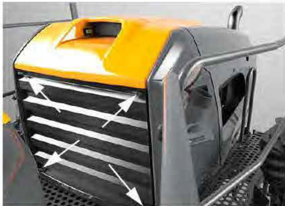
Retenes de la rejilla del radiador (ubicados en cada esquina de la rejilla) -Vista típica
