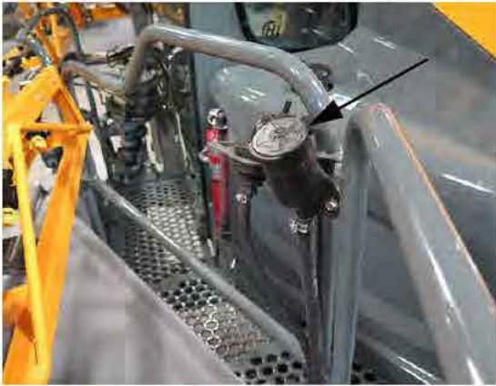
Puerto de llenado del depósito para el lavado de manos (ubicado en el pasamanos de la plataforma izquierda) -Vista típica
