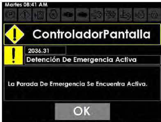
Mensaje de interruptor de parada de emergencia activado (se muestra en la pantalla de la máquina)
