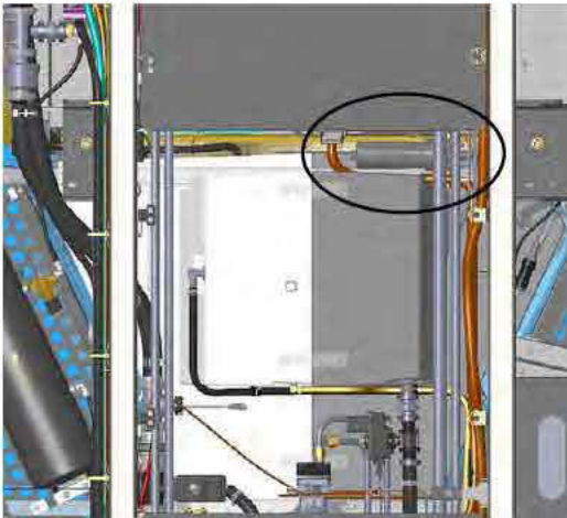
Filtro de presión (ubicado debajo del lado delantero izquierdo de la máquina) -Vista típica
