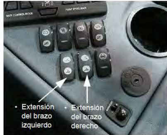
Interruptores de las extensiones de los brazos - Izquierda/Derecha (ubicados en la consola lateral) -Vista típica
