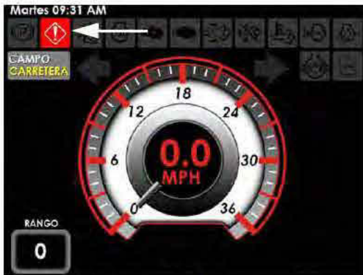
Luz indicadora de advertencia (ubicada en el lado superior izquierdo de cada página de la pantalla)
