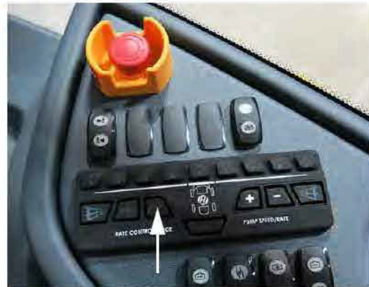
El interruptor de control de tasa "MAN" (ubicado en la consola lateral) -Vista típica
