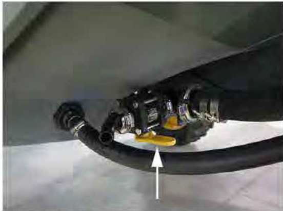
Válvula de drenaje de la solución (ubicada debajo de cada tanque de solución en la parte inferior de la máquina) -Vista típica
