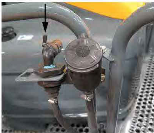
Válvula de lavado de manos (pasamanos de la plataforma izquierda) -Vista típica
