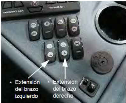
Interruptores de extensión del brazo - Izquierdo/Derecho (ubicados en la consola lateral) -Vista típica
