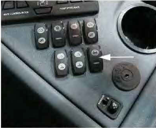
Interruptor de la válvula de tracción (ubicado en la consola lateral) -Vista típica
