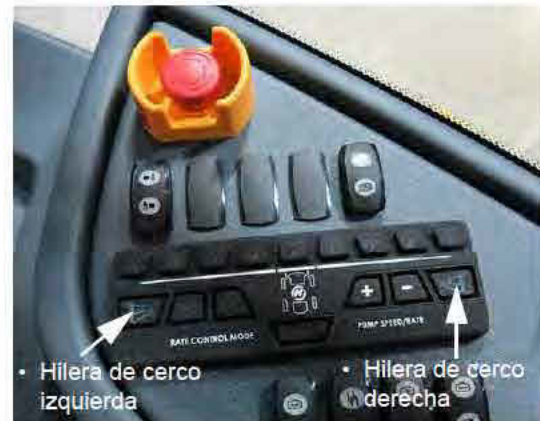
Interruptores de hilera de cerco - Izquierda/derecha (ubicados en la consola lateral) -Vista típica
