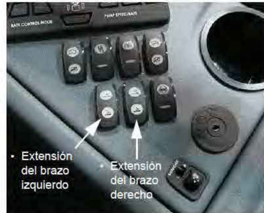
Interruptores de extensión de los brazos - Izquierdo/derecho (ubicados en la consola lateral) -Vista típica
