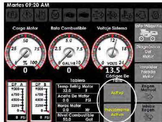
Botones de códigos de fallas (ubicados en la página de diagnósticos de la máquina)
