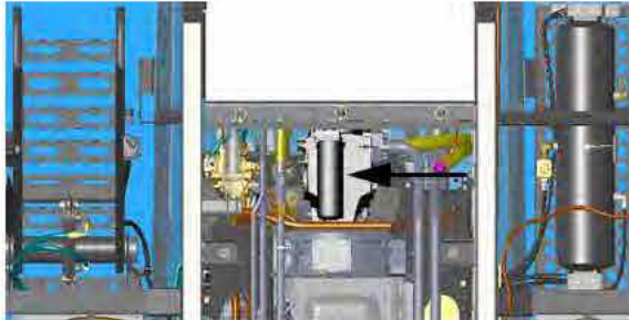
Filtro de bomba de carga (ubicado debajo de la parte trasera de la máquina) -Vista típica
