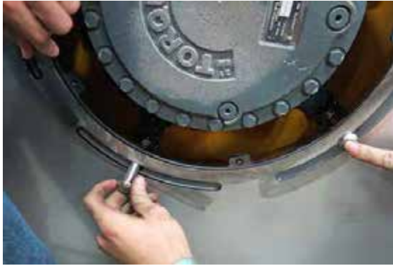
Instalación del perno de montaje de la cubierta de rueda -Vista típica
