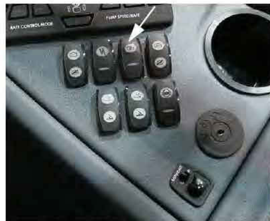
Interruptor de la válvula de agitación (ubicado en la consola lateral) -Vista típica
