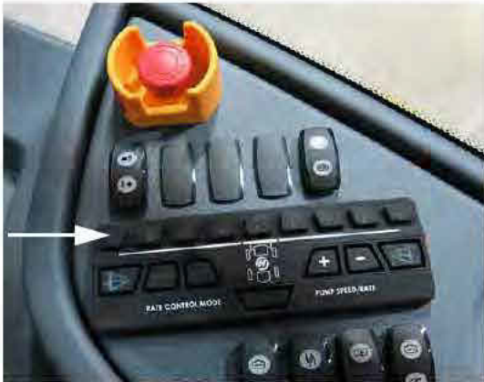
Interruptores de la válvula de solución del brazo (ubicados en la consola lateral) -Vista típica
