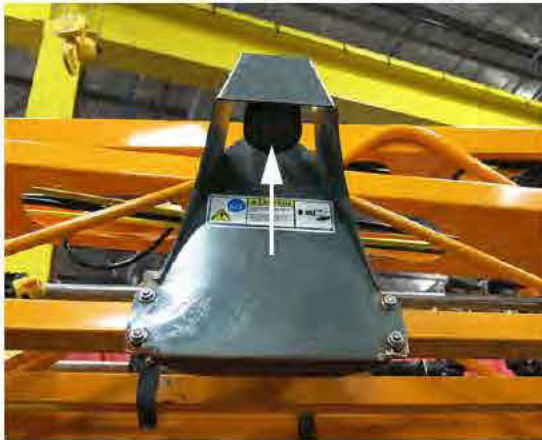
Almohadilla de espuma del sensor NORAC (ubicada en la parte inferior de cada sensor) -Vista típica
