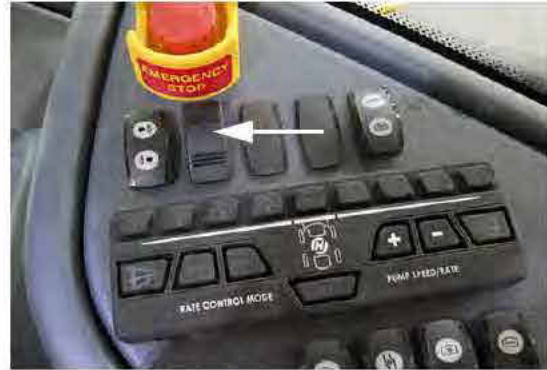
Interruptor de aspersión nocturna (ubicado en la consola lateral) -Vista típica
