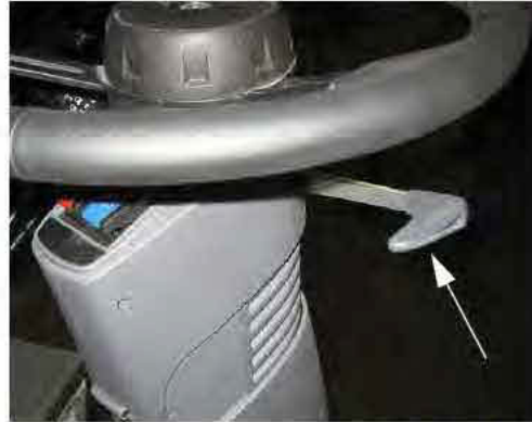
Palanca de ajuste telescópico del volante (ubicada en el lado derecho de la columna de dirección) -Vista típica
