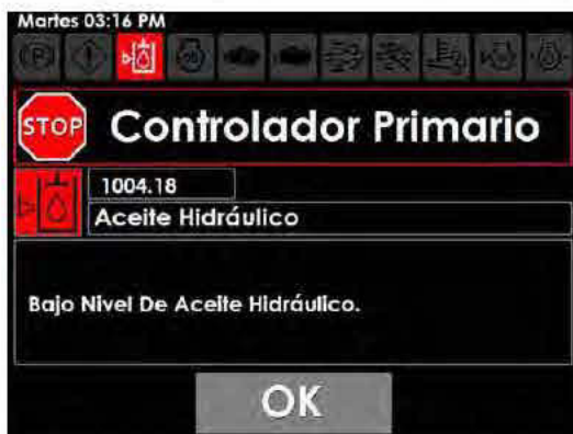
Mensaje de advertencia de bajo nivel de aceite hidráulico (en la pantalla de la máquina)
