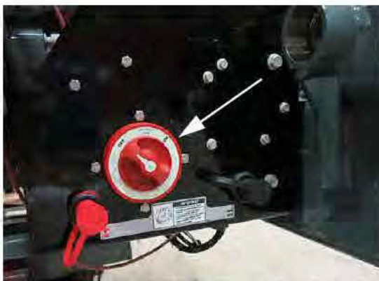
Interruptor de desconexión de las baterías (ubicado en el bastidor principal trasero) -Vista típica
