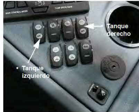
Interruptores de las válvulas del tanque principal (ubicados en la consola lateral) -Vista típica
