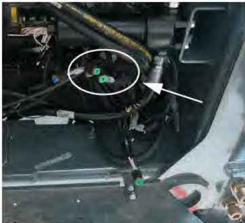
Conexiones de entrada para cámaras de vídeo (ubicadas debajo de la cabina - retire el panel frontal para tener acceso) - Vista típica
