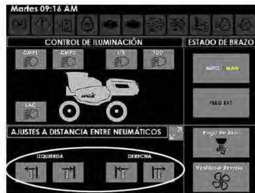
Botones de ajuste de la distancia entre neumáticos (ubicados en la parte inferior de la página de controles auxiliares)
