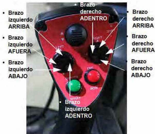
Interruptores de los brazos izquierdo y derecho (ubicados en la manilla de control de la transmisión hidrostática) -Vista típica
