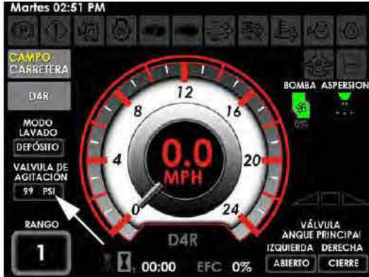
Indicador de presión de la válvula de agitación (ubicado en la página de inicio de la pantalla de la máquina - modo de carretera y campo)
