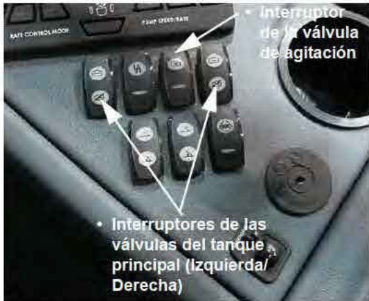
Interruptores del tanque principal y de las válvulas de agitación (ubicados en la consola lateral) -Vista típica
