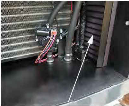
Filtro de recirculación (Ubicado a lo largo del lado derecho del compartimento de servicio) -Vista típica *Vista con el filtro de carbón retirado
