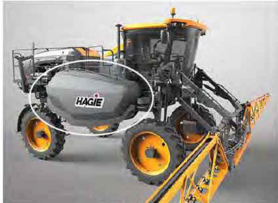
Tanque de solución -Vista típica
