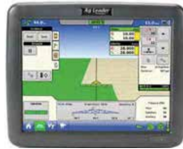
Consola del sistema de aspersión -Vista típica
