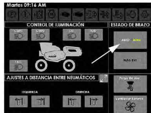
Botón de estado del brazo - Auto/Manual (ubicado en la página de controles auxiliares de la pantalla de la máquina)
