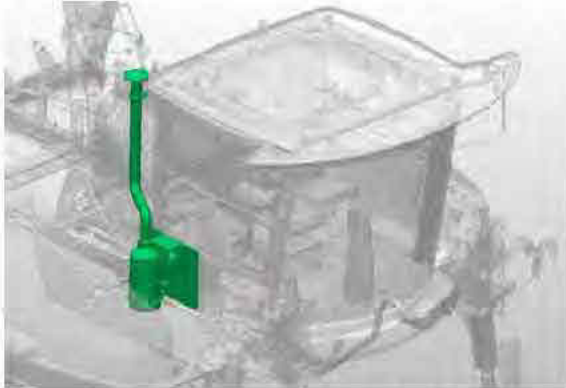
Sistema de filtrado de la cabina (ubicado en el lado derecho del exterior de la cabina) -Vista típica
