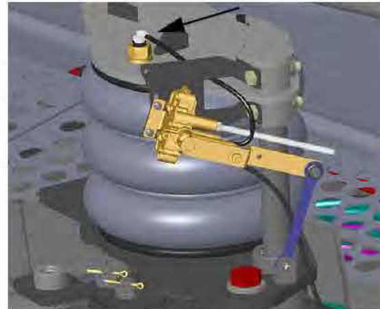
Manguera de conexión de las bolsas de aire (ubicada en la parte superior de cada bolsa) -Vista típica
