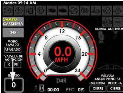
Rango de velocidad (ubicado en la página de inicio de la pantalla de la máquina - modo de campo o carretera)
