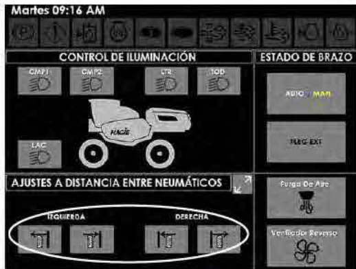
Botones de ajuste de distancia entre neumáticos (ubicados en la página de controles auxiliares de la pantalla de la máquina) -Vista típica
