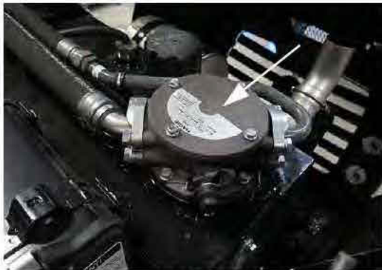
Carcasa del filtro de retorno (ubicada en la parte superior del depósito de aceite hidráulico - abra el capó para tener acceso) -Vista típica
