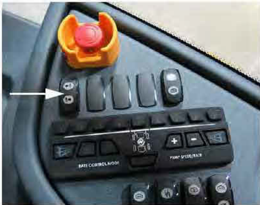
Interruptor del marcador de espuma (ubicado en la consola lateral) -Vista típica
