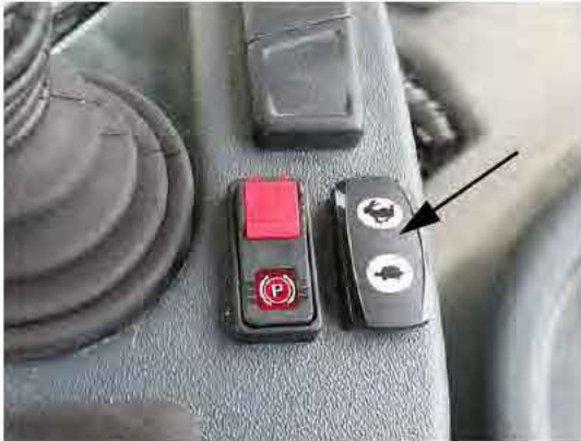
Interruptor del acelerador (ubicado cerca de la manilla de control de la transmisión hidrostática) -Vista típica
