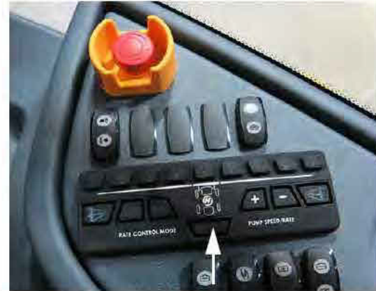
Interruptor de boquilla trasera (ubicado en la consola lateral) -Vista típica
