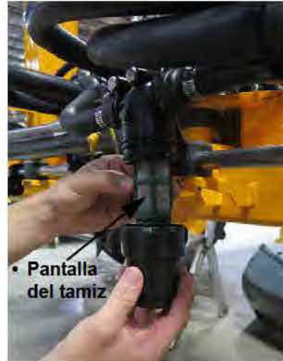
Tamiz de sección (ubicado en cada sección del brazo) -Vista típica
