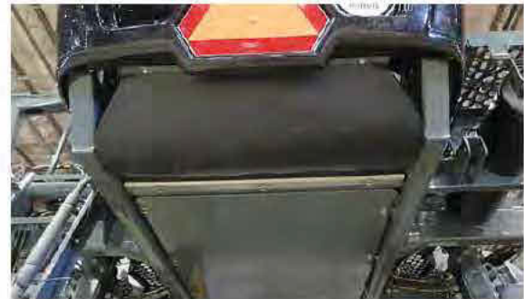
Instalación de cortina de escobillas -Vista típica
