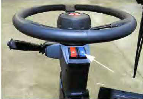
Interruptor de luces de manejo/carretera (ubicado en la columna de dirección) -Vista típica
