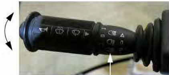
Luces altas (ubicadas en la palanca de las luces direccionales) -Vista típica
