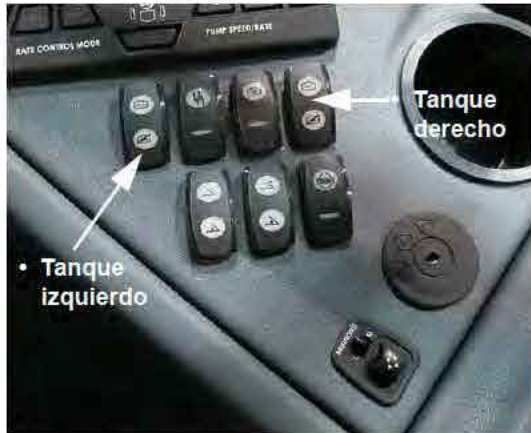
Interruptores de las válvulas del tanque principal - izquierda/derecha (ubicados en la consola lateral) -Vista típica
