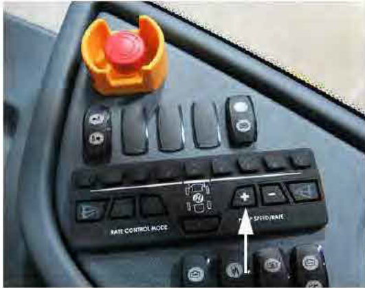
Interruptor de tasa/velocidad de la bomba "+" (ubicado en la consola lateral) -Vista típica
