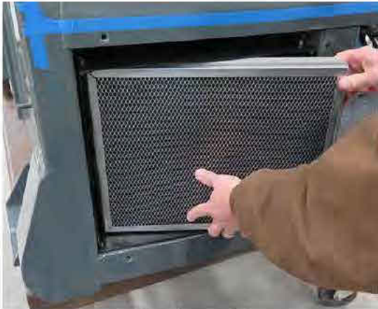
Filtro de carbón (Ubicado detrás del tablero de servicio exterior en el lado derecho de la cabina) -Vista típica
