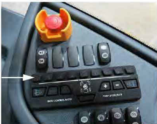
Interruptores de las válvulas de solución de los brazos (ubicados en la consola lateral) -Vista típica
