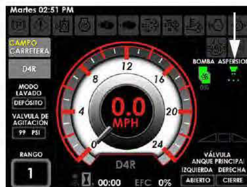
Indicador de aspersión principal (ubicado en la parte superior derecha de la página principal de la pantalla de la máquina - modo de campo)
