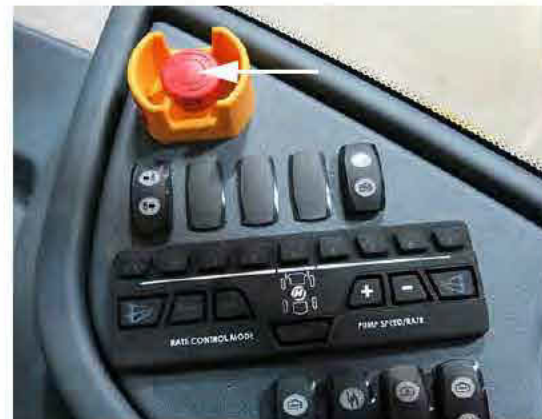
Interruptor de parada de emergencia (ubicado en la consola lateral) -Vista típica
