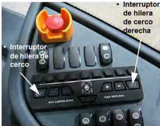
Interruptores de hilera de cerco - derecha e izquierda (ubicados en la consola lateral) -Vista típica
