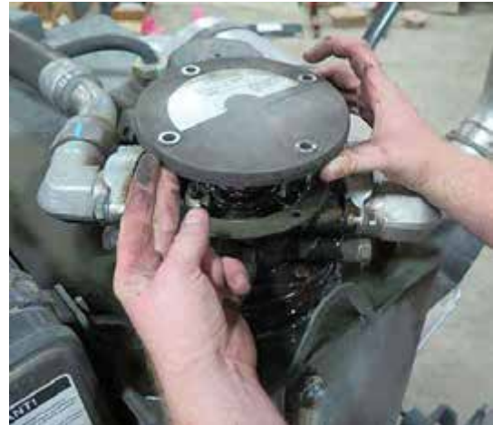
Llenado del tanque a través del receptáculo del filtro de retorno hidráulico -Vista típica
