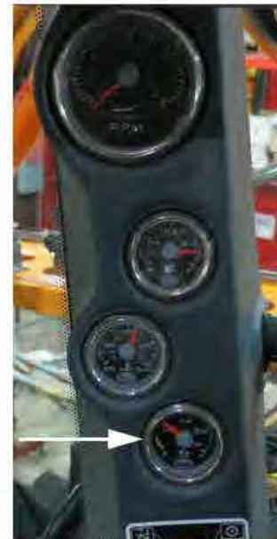
Medidor del DEF (ubicado en el poste A de la cabina) -Vista típica
