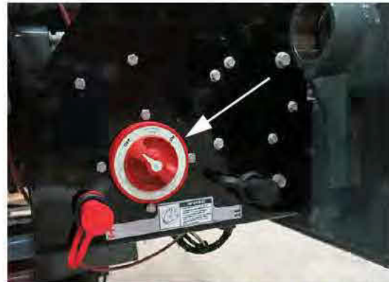
Interruptor de desconexión de la batería (ubicado en la parte posterior del chasis principal) -Vista típica
