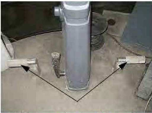
Estribos para los pies del operador (ubicados a cada lado de la columna de dirección) -Vista típica
