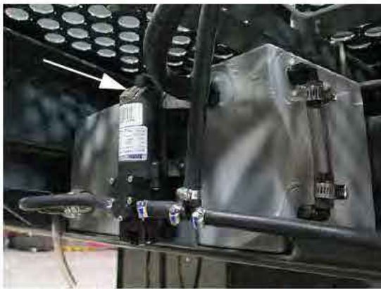
Interruptor de encendido de la bomba para lavado de mano (ubicado en la parte superior de la bomba) -Vista típica
