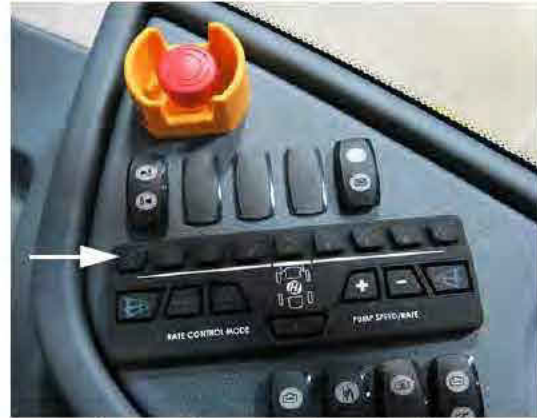
Interrupores de las válvulas de solución del brazo (ubicados en la consola lateral) -Vista típica
