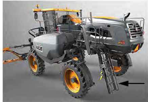
Escalera -Vista típica
