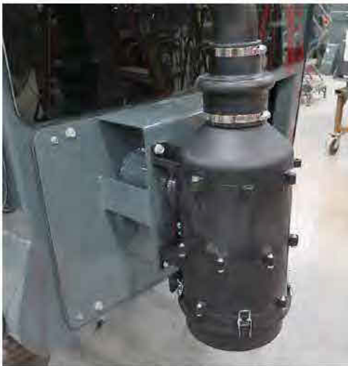
Abrazadera de brida - Superior (Ubicada cerca de la parte superior de la unidad de filtración RESPA) -Vista típica
