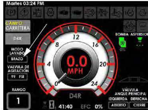
Indicador del modo de lavado (ubicado en la página de inicio de la pantalla de la máquina - modo de campo) -Vista típica
