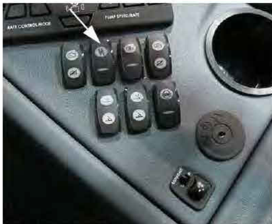
Interruptor de la bomba de solución (ubicado en el lateral de la consola lateral) -Vista típica
