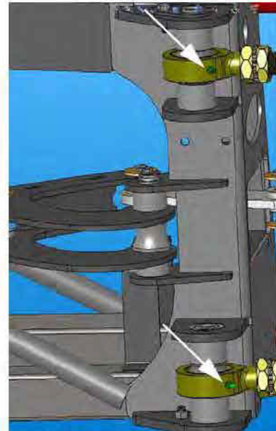
Engrasadores tipo Zerk a los extremos de la varilla de la articulación de plegado exterior -Vista típica
