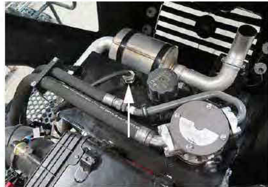
Sensor de nivel/temperatura (ubicado encima del depósito de aceite hidráulico) -Vista típica
