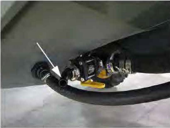
Salida de descarga del tanque de solución (ubicada debajo de cada tanque de solución en la parte inferior de la máquina) -Vista típica
