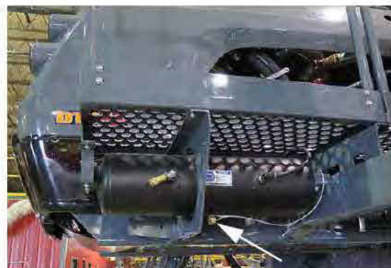
Válvula de drenaje del tanque (principal) (ubicada debajo de la plataforma en el lado trasero derecho de la máquina) * Hale HACIA ABAJO para abrir -Vista típica
