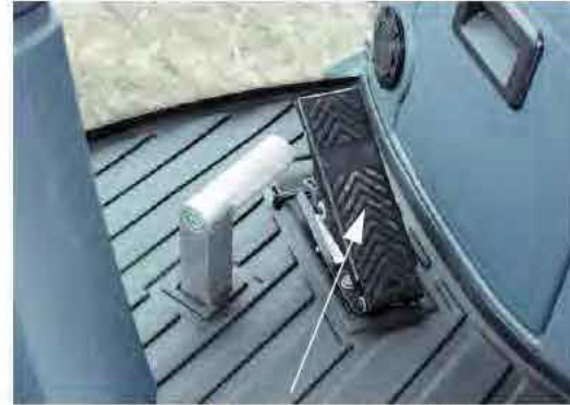
Pedal de desaceleración (ubicado en la parte inferior derecha de la columna de dirección) -Vista típica
