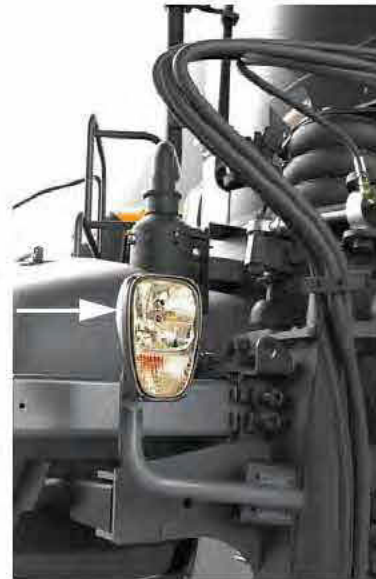
Luces de manejo/carretera (2) -Vista típica
