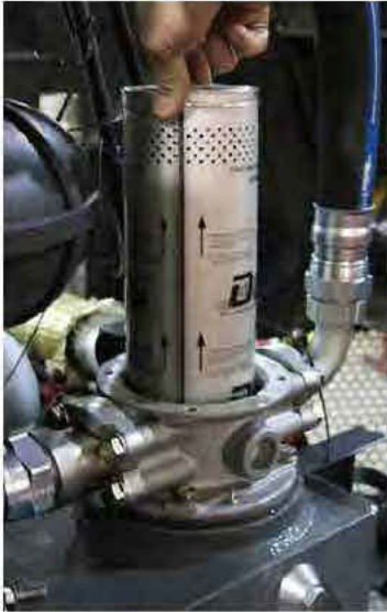
Filtro de retorno (ubicado en el interior del alojamiento del filtro, en el lado izquierdo de la máquina) -Vista típica
