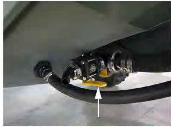
Válvula de drenaje del tanque de solución (ubicada debajo de cada tanque de solución en la parte inferior de la máquina) -Vista típica
