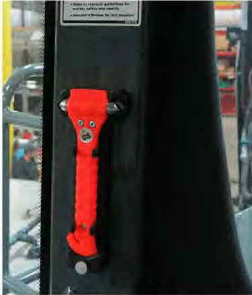
Herramienta de salida de emergencia (ubicada en la parte trasera derecha de la cabina) -Vista típica
