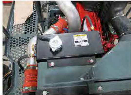
Radiador (ubicado cerca de la parte trasera de máquina - abra el capó para tener acceso) -Vista típica
