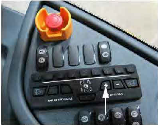
Interrupor de tasa/velocidad de la bomba “+” (ubicado en la consola lateral) -Vista típica
