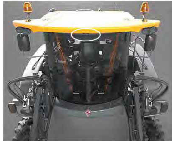
Boquilla de pulverización del líquido del lavaparabrisas (ubicada cerca de la parte superior de la cabina exterior) -Vista típica
