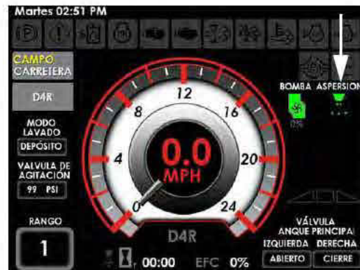
Indicador de aspersión principal (ubicado en la parte superior derecha de la página de inicio de la pantalla de la máquina - modo de campo)
