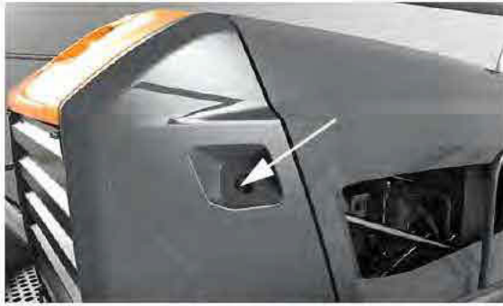
Tapa de llenado de DEF (ubicada cerca del fondo del depósito de DEF) -Vista típica
