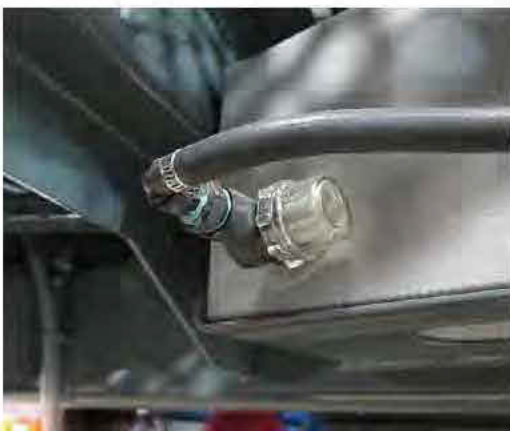
Tamiz para el lavado de manos (ubicado cerca de la parte inferior del tanque para el lavado de manos) -Vista típica
