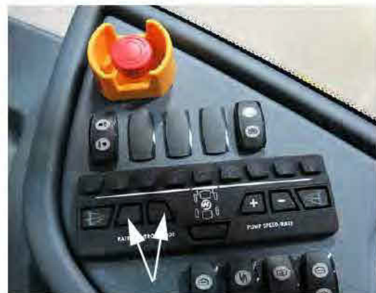
Interruptores de control de tasa (ubicados en la consola lateral) -Vista típica
