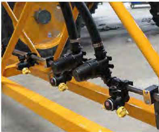
Tamices de sección (ubicados a lo largo de cada sección del brazo) -Vista típica
