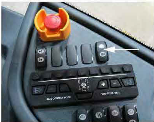
Interruptor de lavado (ubicado en la consola lateral) -Vista típica
