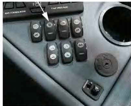
Interruptor de la bomba de solución (ubicado en la consola lateral) -Vista típica
