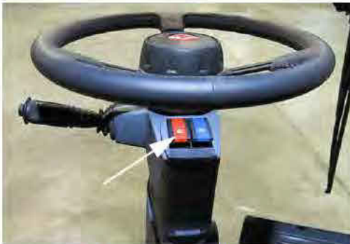
Interruptor de luces de peligro/advertencia (ubicado en la columna de dirección) -Vista típica
