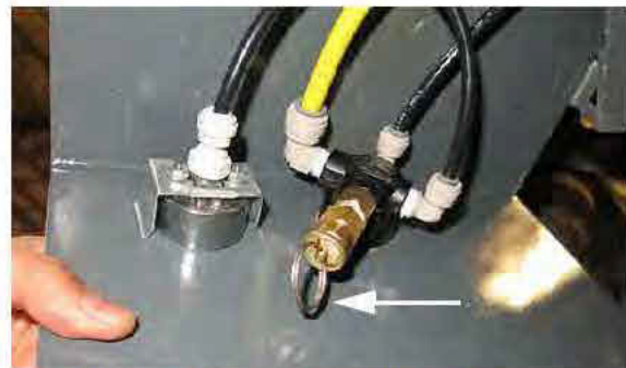
Anillo de la válvula de alivio de presión (ubicado en la parte posterior del regulador de presión de espuma) -Vista típica
