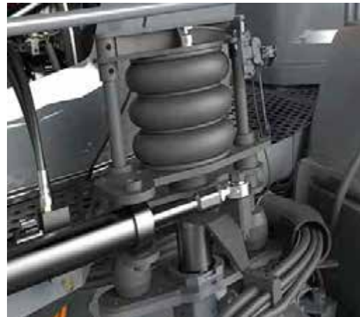
Bolsa de aire (ubicada en cada pata) -Vista típica
