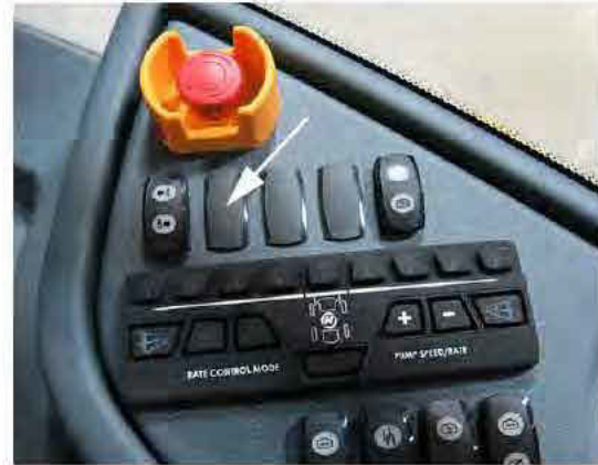
Interruptor de aspersión nocturna (ubicado en la consola lateral) -Vista típica
