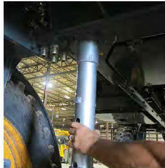
Inserte el gato en el anillo de guía del punto de elevación -Vista típica
