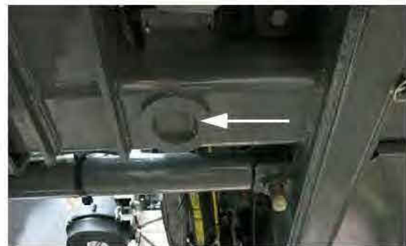
Anillo de contención del punto de elevación (ubicado en el bastidor cerca de cada pata) -Vista típica
