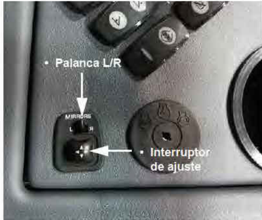
Interruptor de espejos eléctricos (ubicado en la consola lateral) -Vista típica
