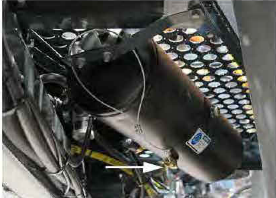
Válvula de drenaje del tanque (Purga de aire) (ubicada debajo de la plataforma cerca del lado derecho central de la máquina) * Hale HACIA ABAJO para abrir -Vista típica
