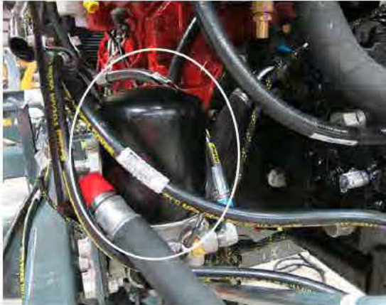
Secador de aire (montado en el bastidor del motor en la parte trasera izquierda) -Vista típica
