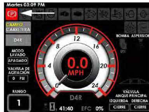
Indicador del freno de estacionamiento (ubicado en la esquina superior izquierda de cada página de la pantalla de la máquina)
