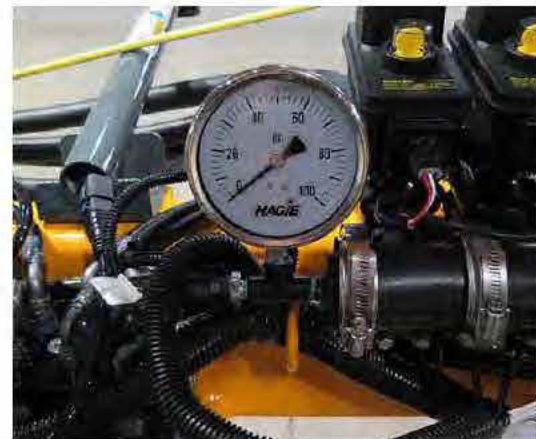
Manómetro (montado en el brazo) -Vista típica
