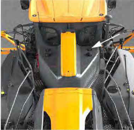
Llenado del tanque de líquido del lavaparabrisas (ubicado en la parte superior derecha del FRM) -Vista típica
