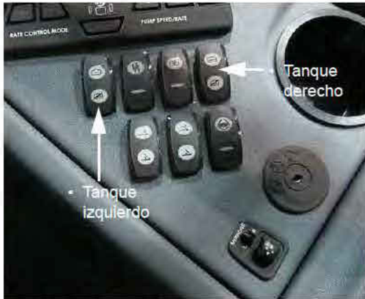
Interruptores de las válvulas del tanque principal – Izquierdo/derecho (ubicados en la consola lateral) -Vista típica
