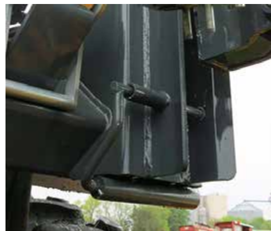
Pasador de bloqueo -Vista típica
