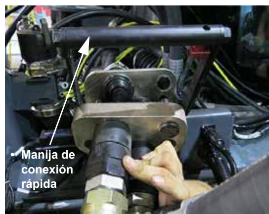
Conjunto de acoplador múltiple hidráulico (en el lado derecho de la máquina) -Vista típica
