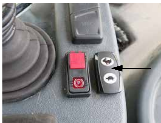
Interruptor del acelerador (situado cerca de la manija de control de la transmisión hidrostática) -Vista típica
