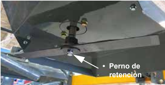
Conjunto de cuchilla de corte (montado en la parte inferior del cabezal de corte) -Vista típica
