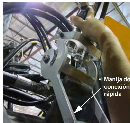
Conjunto del acoplador múltiple hidráulico/eléctrico (se muestra el lado izquierdo de la máquina) -Vista típica
