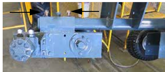
Pernos del extractor cuádruple (ubicados en cada tubo de montaje del extractor cuádruple) -Vista típica
