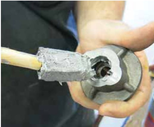
Aplicación de lubricante antiagarrotamiento -Vista típica
