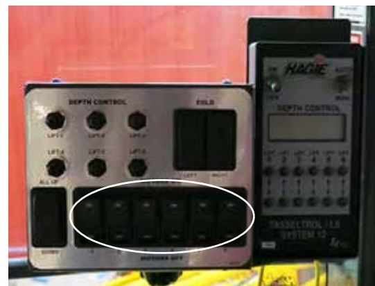
Interruptores de control del motor (ubicados en el panel de control de despenchado) -Vista típica
