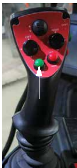
Interruptor de control principal (ubicado en la manilla de control de la transmisión hidrostática) -Vista típica
