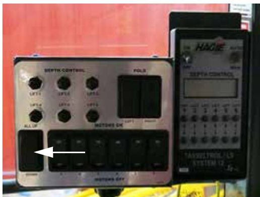
Interruptor de todo arriba/abajo (ubicados en el panel de control de despenchado) -Vista típica
