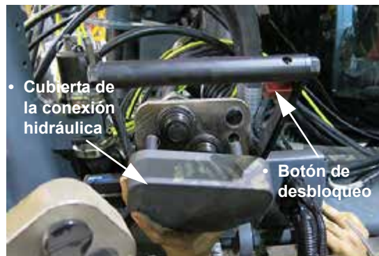
Cubierta de la conexión hidráulica y botón de desbloqueo (en el lado derecho de la máquina) -Vista típica
