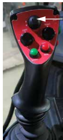
Interruptor de todo arriba/abajo (ubicado en la manilla de control de la transmisión hidrostática) -Vista típica
