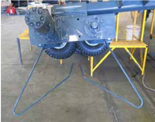
Instalación de guía de tallos -Vista típica
