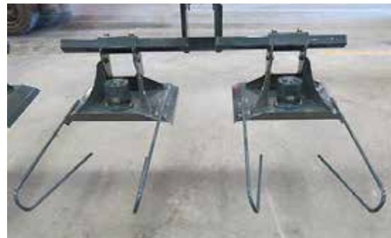
Instalación de guía de tallos -Vista típica
