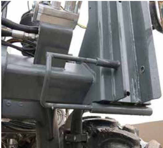
Pasador de bloqueo (situado en la parte delantera izquierda y derecha de la máquina) -Vista típica
