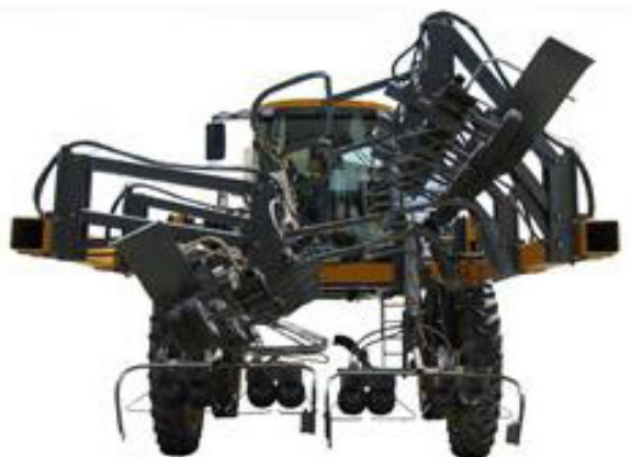
Têtes de castration décalées - Vue typique
