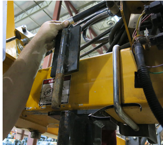
Plaque de butée (située sur le côté intérieur de chaque chandelle du combo d'accessoires) - Vue typique
