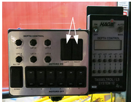
Boutons « Outrigger Fold Switch » (pliage de rampe) - « Left/Right » (Droite/Gauche) (situés sur le pupitre de commande de castration) - Vue typique
