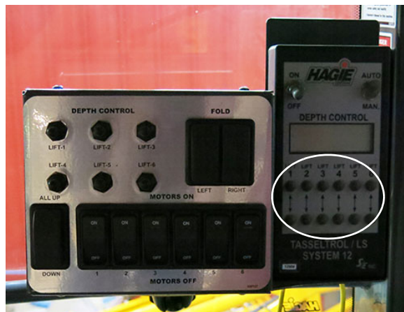
« Lift Up/Down Switches » (boutons vers le Haut/Bas) (situés sur le pupitre de commande de Tasseltrol) - Vue typique
