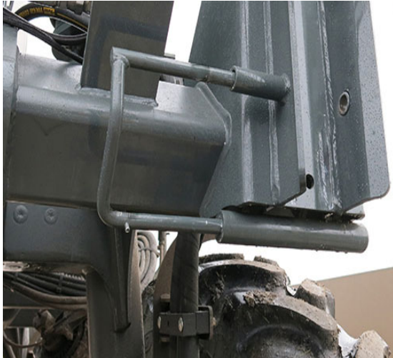
Goupille de verrouillage (2) (située à l'avant gauche et côté droit de la machine) - Vue typique * Position désengagée illustrée
