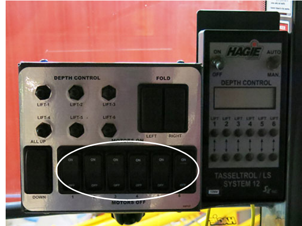
« Motor Control Switches » (Boutons de commande de moteur) (situés sur le pupitre de commande de castration) - Vue typique
