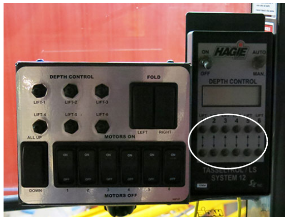
« Lift Up/Down Switches » (boutons vers le Haut/Bas) (situés sur le pupitre de commande de Tasselrol) - Vue typique
