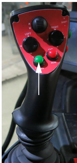
Commutateur principal de commande (situé sur le levier de vitesse de la transmission hydrostatique) - Vue typique
