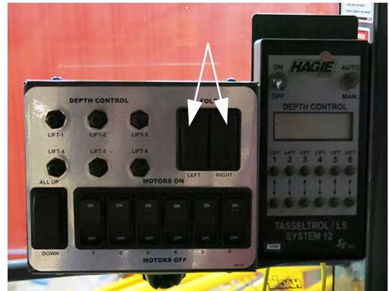
Boutons « Outrigger Fold Switch » (pliage de rampe) - « Left/Right » (Droite/Gauche) (situés sur le pupitre de commande de castration) - Vue typique
