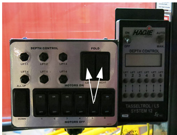
« Left/Right Fold Switches » (commutateurs de pliage gauche/droit) (situé sur le pupitre de commande de castration) - Vue typique
