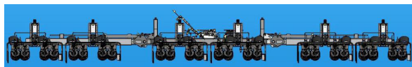
4-2 Barre porte-outils d'enjambeur de castration - si la machine en est équipée (vue rétractée)
