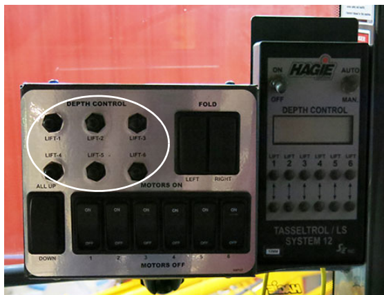
« Depth Control Switches » (Boutons de commande de la profondeur) (situés sur le pupitre de commande de castration) - Vue typique
