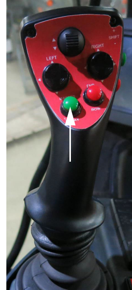
Commutateur principal de commande (situé sur le levier de vitesse de la transmission hydrostatique) - Vue typique
