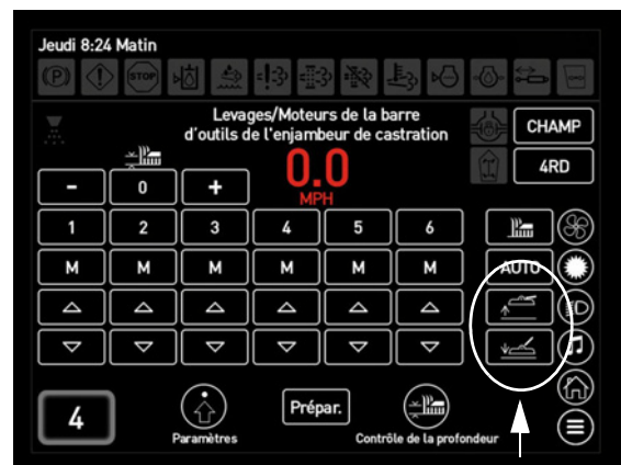
Icônes de relevage - Tous relevés / Tous abaissés (situées sur l'écran d'affichage de la machine « Levages/Moteurs de la barre porte-outils ») - Vue typique
