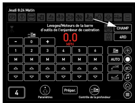
Touche Champ/Route (située sur l'écran Levages/Moteurs de la barre porte-outils de l'écran de la machine)
