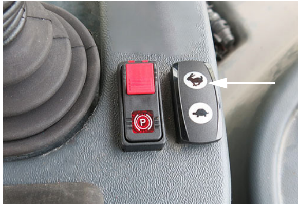
Touche d'accélération (située près du levier de vitesse de la transmission hydrostatique) - Vue typique
