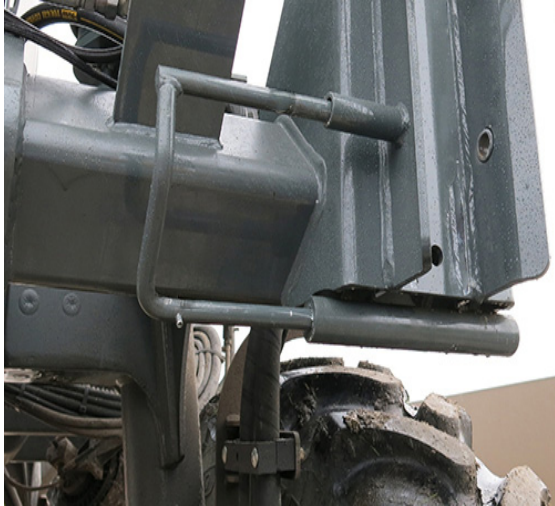
Goupille de verrouillage (2) (située à l'avant gauche et côté droit de la machine) - Vue typique
