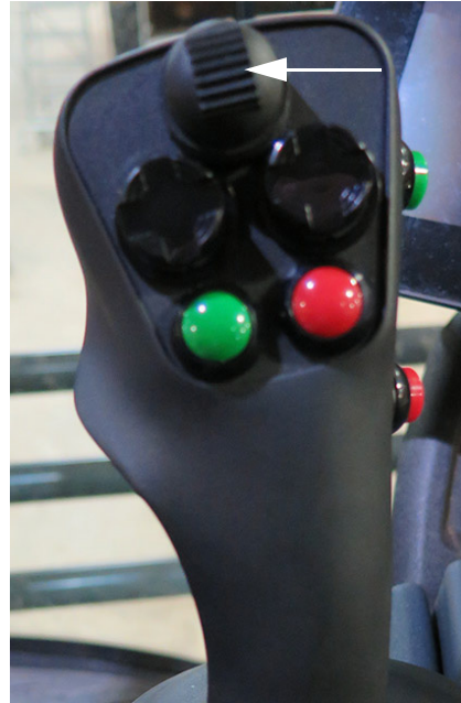
Commutateur Tous relevés/abaissés (situés sur le levier de commande de l'entraînement hydrostatique) - Vue typique
