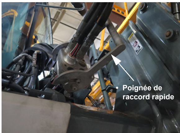
Prise de la poignée de raccordement rapide (côté gauche de la machine illustré) - Vue typique
