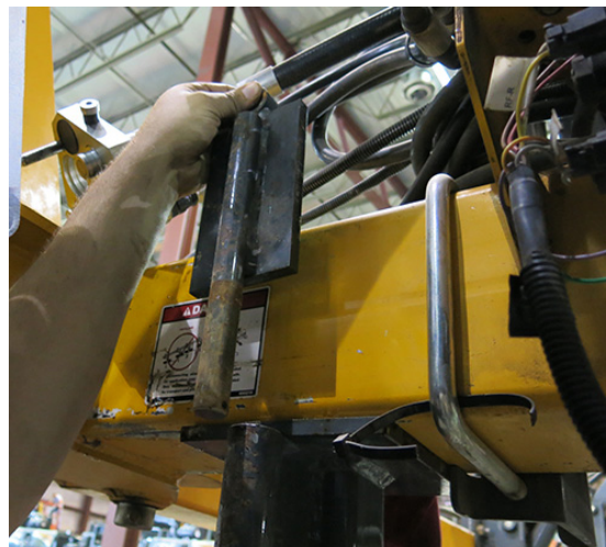
Plaque de butée (situé sur le côté intérieur de chaque chandelle de la barre porte-outils) - Vue typique
