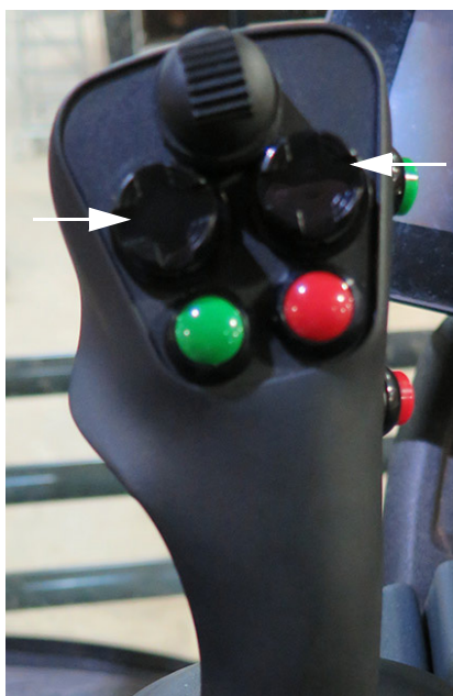
Commutateurs de repli des stabilisateurs - gauche/droit (situés sur le levier de commande de l'entraînement hydrostatique) - Vue typique
