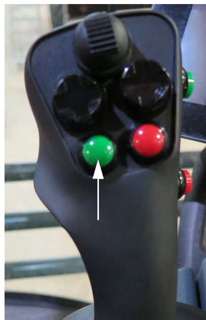
Commutateur principal des moteurs (situé sur la poignée de commande de l'entraînement hydrostatique) - Vue typique
