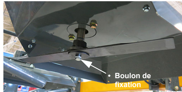
Lames de coupe (montées sur le côté inférieur de la tête de coupe) - Vue typique
