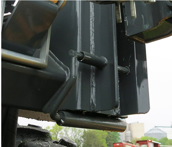
Goupille de verrouillage (2) - Vue typique * Position engagée illustrée
