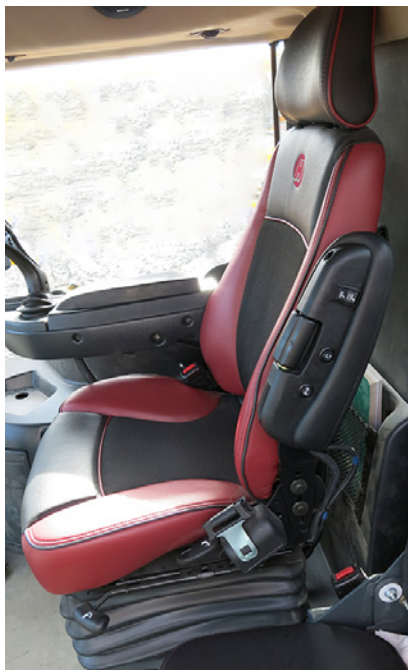
Dispositif de veille automatique (situé dans le siège du conducteur) - Vue typique
