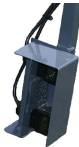
Capteurs photoélectriques du système LS - Vue typique
