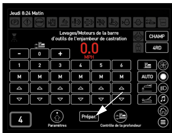
Touche Préparation (située sur l'écran Levages/Moteurs de la barre porte-outils de l'écran de la machine OU l'écran « Commande de profondeur de la barre porte-outils »)
