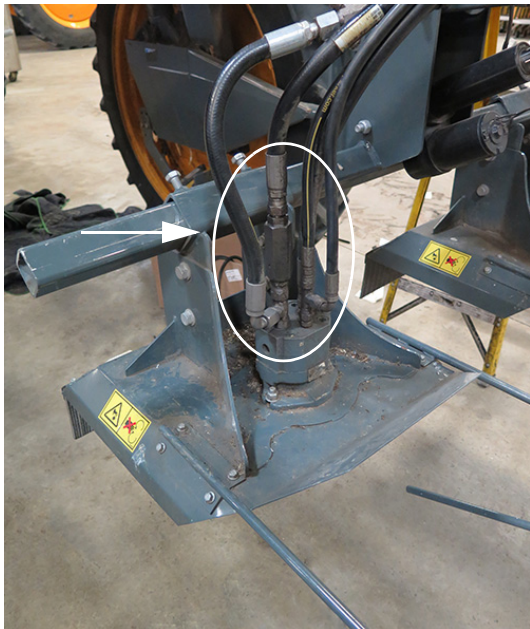
Branchements hydrauliques des têtes de coupe - Vue typique
