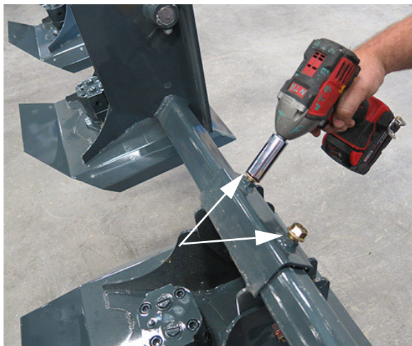
Skrutky reznej hlavy (nachádzajú sa na každej montážnej rúre reznej hlavy) - Typický pohľad
