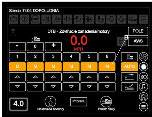
Obrazovka Zdvíhacie zariadenia/motory DTB (automatický režim)
