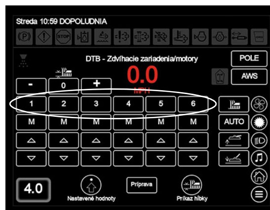
Tlačidlá motorov (1 - 6) (nachádzajú sa na obrazovke „Zdvíhacie zariadenia/motory DTB“ displeja stroja)
