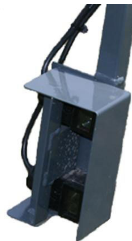
Zostava fotografických svetelných snímačov LS - Typický pohľad
