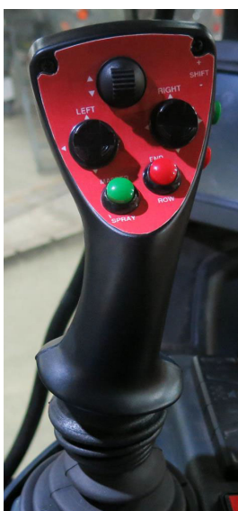
Radiaca páka hydrostatického pohonu - Typický pohľad
