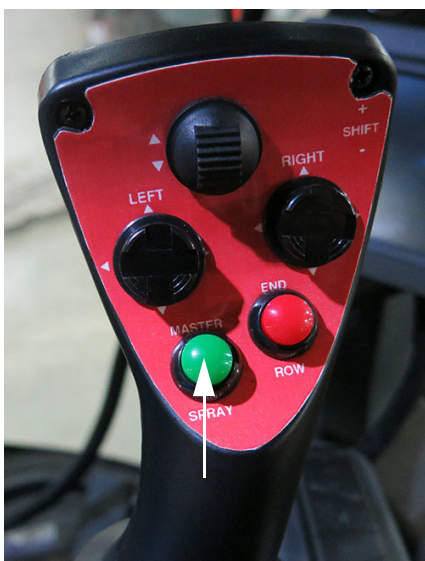
Hlavný ovládací spínač (nachádza sa na radiacej páke hydrostatického pohonu) - Typický pohľad
