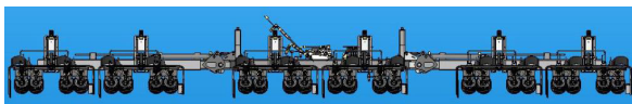
Lišta nástrojov na odstraňovanie kukuričných metlín 4-2 - ak je súčasťou výbavy (pohľad na zložený stav)
