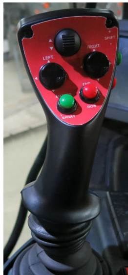
Radiaca páka hydrostatického pohonu - Typický pohľad
