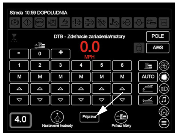
Tlačidlo Príprava (nachádza sa na obrazovke Zdvíhacie zariadenia/motory DTB alebo Príkaz hĺbky DTB displeja stroja)
