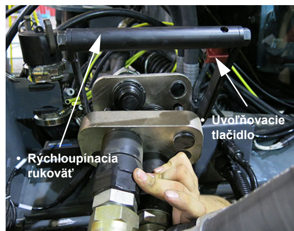
Zostava hydraulických univerzálnych spojok (zobrazená je pravá strana stroja) - Typický pohľad
