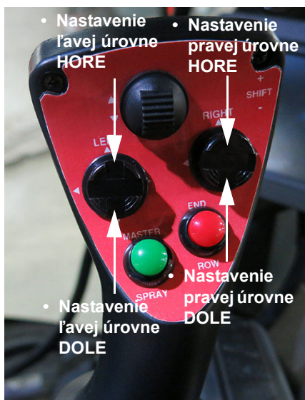
Spínače nastavenia úrovne - ľavý/pravý (nachádzajú sa na radiacej páke hydrostatického pohonu) - Typický pohľad
