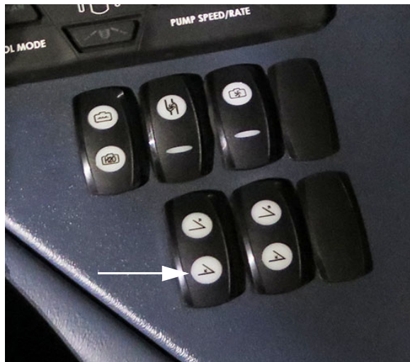
Spínač posuvných predlžovacích prvkov 4-2 (nachádza sa na bočnej konzole) - Typický pohľad
