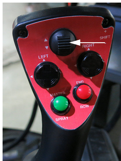
Spínač všetkých prvkov hore/dole (nachádza sa na radiacej páke hydrostatického pohonu) - Typický pohľad
