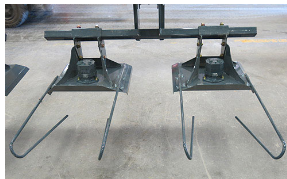
Inštalácia vodiacich prvkov stebiel - Typický pohľad
