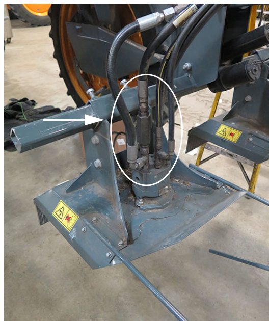
Hydraulické spoje reznej hlavy - Typický pohľad
