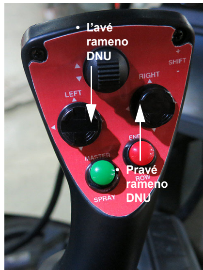
Spínače sklápacích mechanizmov ramien - ľavý/pravý (nachádzajú sa na radiacej páke hydrostatického pohonu) - Typický pohľad
