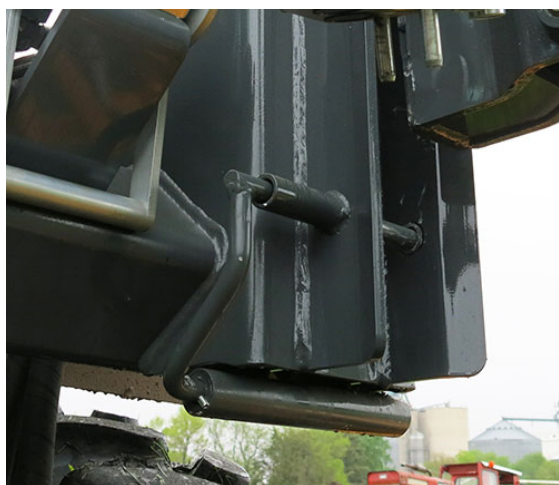
Poistný kolík (2) - Typický pohľad * Zobrazenie zapojenej polohy
