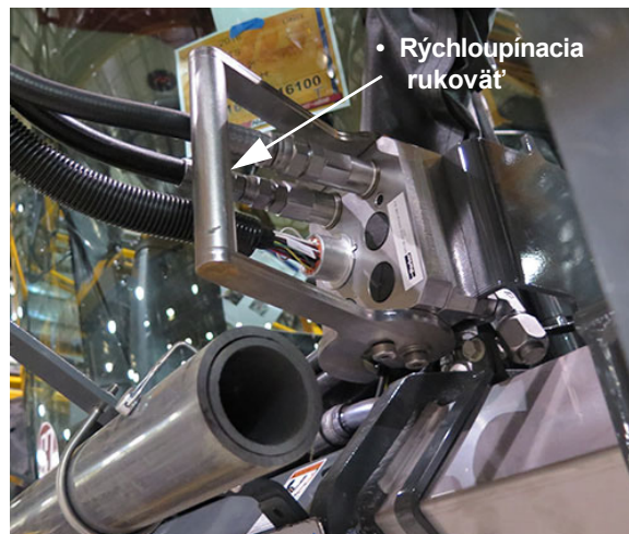
Zostava hydraulických/elektrických univerzálnych spojok (zobrazená je ľavá strana stroja) - Typický pohľad
