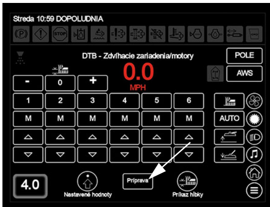
Tlačidlo Príprava (nachádza sa na obrazovke Zdvíhacie zariadenia/motory DTB alebo Príkaz hĺbky DTB displeja stroja)
