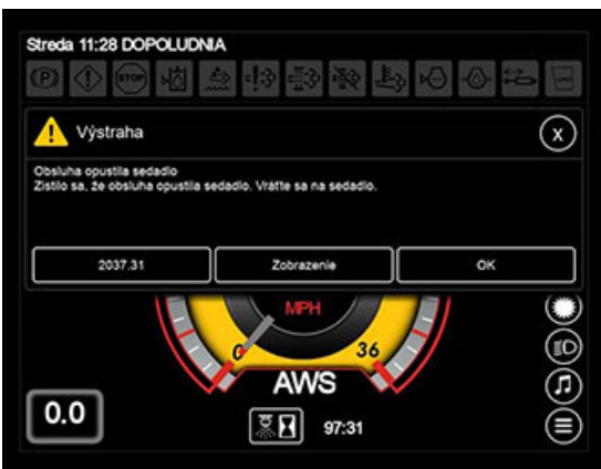
Hlásenie o neprítomnosti operátora na sedadle (nachádza sa na displeji stroja)
