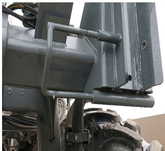
Poistný kolík (2) (nachádza sa na ľavej a pravej prednej strane stroja) - Typický pohľad * Zobrazenie odpojenej polohy
