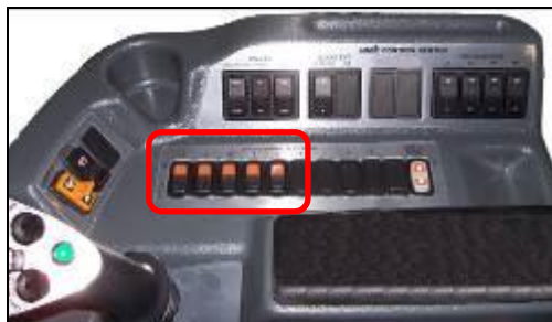
12. Ábra: Permetező-szakasz kapcsolók
