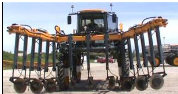
16. Ábra: 16 soros nitrogén segédkar behajtott csúcsokkal
