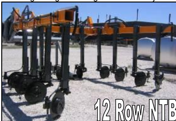
18. Ábra: 12 és 16 soros nitrogén segédkar behajtott elrendezésben
