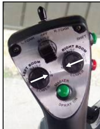
17. Ábra: Nitrogén segédkar behajtása
