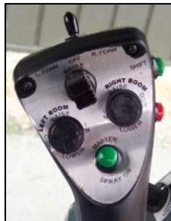
6. Ábra: Hidrosztatikus kapcsolókar
