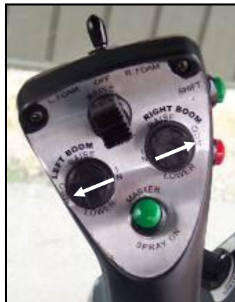
8. Ábra: Nitrogén segédkar kihajtása
