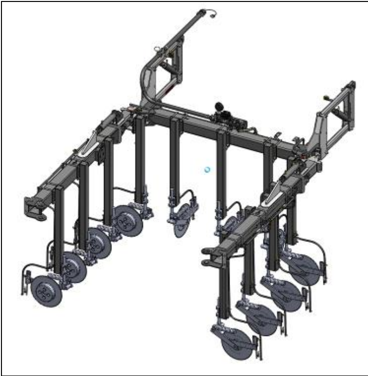
1. Ábra: 12 soros segédkar behajtott elrendezésben
