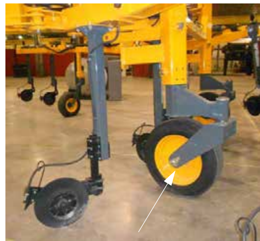
Mérőkerék (az NTB mindegyik oldalán egy-egy) - Tipikus nézet
