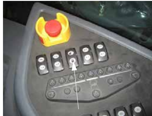
Zárószerelvény kapcsoló (oldalsó vezérlőpulton) - Tipikus nézet
