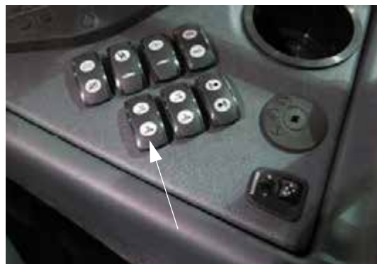
Gém/NTB toldalék kapcsoló (oldalsó vezérlőpulton) - Tipikus nézet
