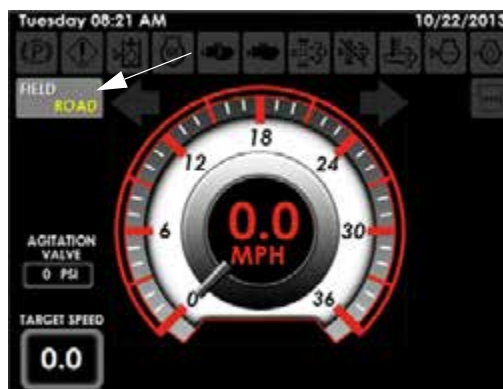
Mezei/Közúti üzemmód kapcsoló (munkagép képernyőjén - Nyitólap)
