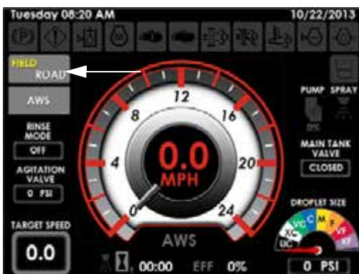
Mezei/Közúti kapcsoló (a munkagép képernyőjének kezdőoldalán)
