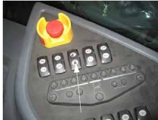
Mérőkerék kapcsoló (oldalsó vezérlőpulton) - Tipikus nézet
