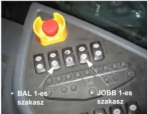
Fő-(1-es) szakaszok Felemelés/Leengedés kapcsolói (oldalsó vezérlőpulton) - Tipikus nézet
