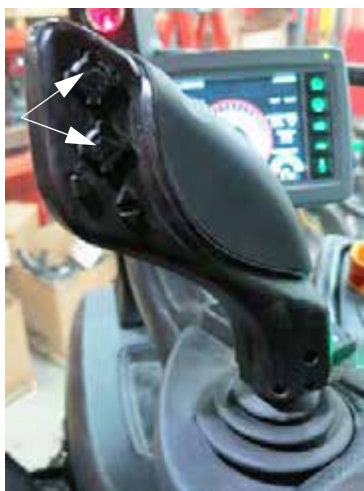
Bal és jobb gém/NTB kapcsolói (a hidrosztatikus vezérlést irányító karon) - Tipikus nézet
