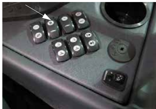
Permetlé szivattyú kapcsolója (oldalsó vezérlőpulton) - Tipikus nézet
