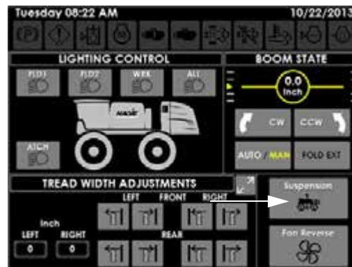
Felfüggesztés gombja (a munkagép képernyőjének segédvezérlések oldalán)
