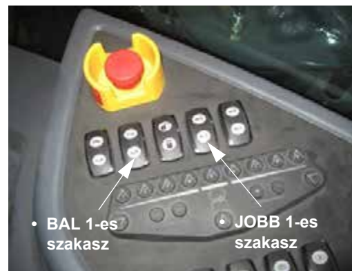
1-es szakaszok Felemelés/Leengedés kapcsolói (oldalsó vezérlőpulton) - Tipikus nézet
