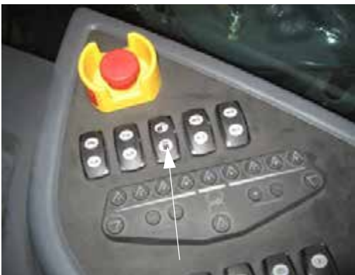
Mérőkerék kapcsoló (oldalsó vezérlőpulton) - Tipikus nézet
