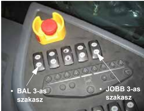
3-as szakaszok Felemelés/Leengedés kapcsolói (oldalsó vezérlőpulton) - Tipikus nézet
