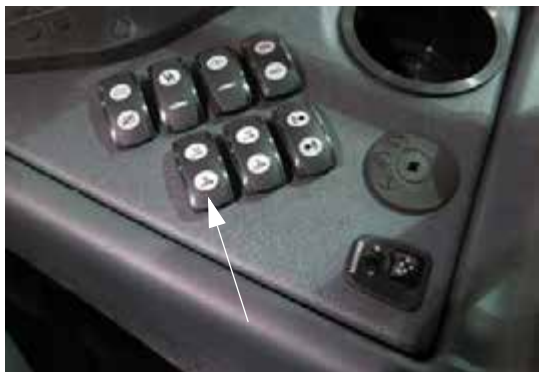
Gém/NTB toldalék kapcsoló (oldalsó vezérlőpulton) - Tipikus nézet
