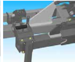
Zárószerelevény „Kiengedett/Nyitott” helyzetét mutatja
