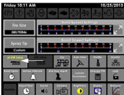
A 60' NTB beállítás gombja (a munkagép képernyőjének beállítások oldalán)
