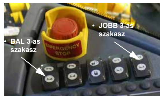
3-as szakaszok Felemelés/Leengedés kapcsolói (oldalsó vezérlőpulton) - Tipikus nézet
