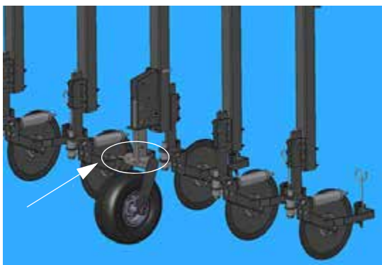
Emelő fogantyú (kaliber kerék felett) - Tipikus nézet
