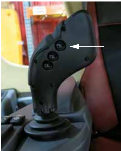
Elsődleges permetező kapcsoló (a hidrosztatikus vezérlést irányító kar hátoldalán - 1-es változatnál) - Tipikus nézet
