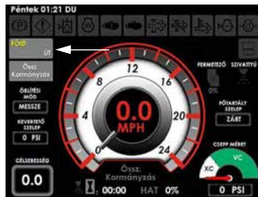
Mezei/Közúti kapcsoló (a munkagép képernyőjének kezdőoldalán)
