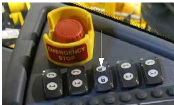
Kaliber kerék/rögzítő szerelvény kapcsoló (oldalsó vezérlőpulton) - Tipikus nézet
