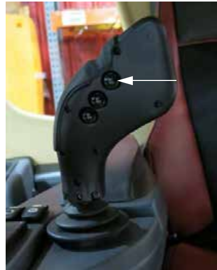
Elsődleges permetező kapcsoló (a hidrosztatikus vezérlést irányító kar hátdalán - 1-es változaton) - Tipikus nézet
