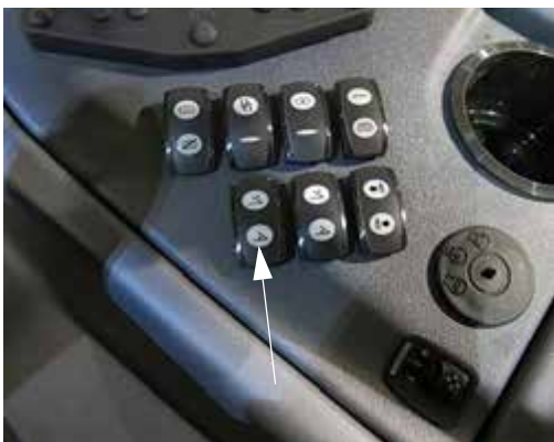
Gém/NTB toldalék kapcsoló (oldalsó vezérlőpulton) - Tipikus nézet
