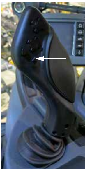
Támasztómű kapcsoló - Fel [UP] (a hidrosztatikus vezérlést irányító karon - 1-es változaton) - Tipikus nézet
