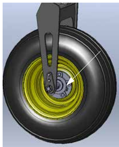
Kenési pont F (baloldali megjelenítés)
