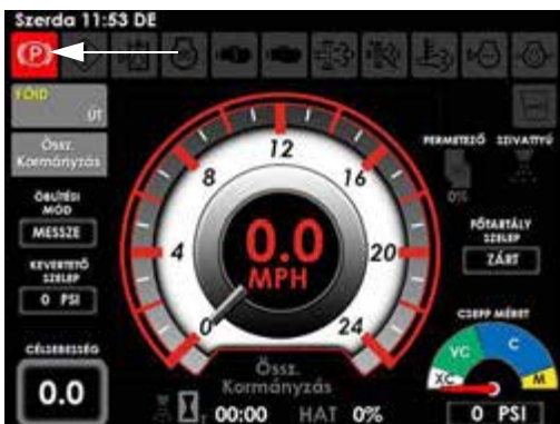
Rögzítőfék [parkolófék] fényjelzés (a munkagép kijelzőjének minden egyik oldalán, a bal felső részen)
