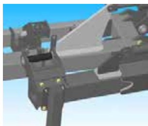
Zárószelvény „Kiengedett/Nyitott” helyzetét mutatja
