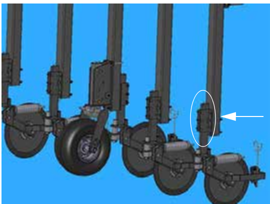
Szerelő csavarok (a csoroszlya rögzítő foglalatának oldalán helyezkedik el) - Tipikus nézet
