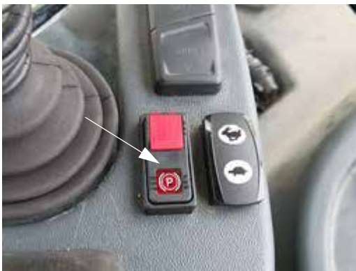
Rögzítőfék (parkolófék) kapcsoló (a hidrosztatikus vezérlést irányító kar közelében) - Tipikus nézet
