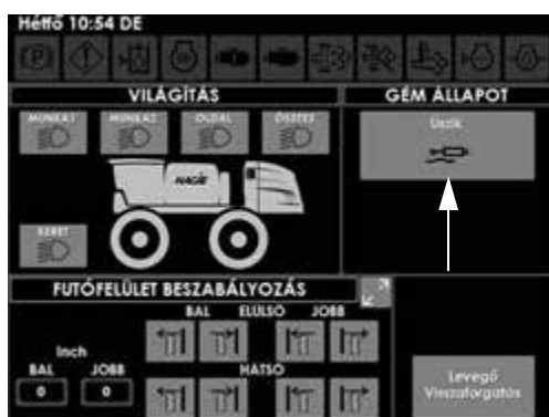
Lebegtetés (úsztatás) gomb (a munkagép képernyőjének segédvezérlések oldalán)
