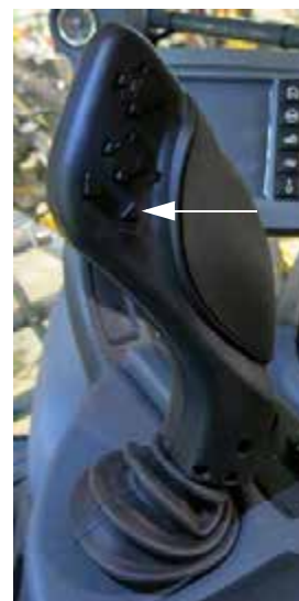
Támasztómű kapcsoló - FEL (a hidrosztatikus vezérlést irányító karon 1-es változatnál) - Tipikus nézet
