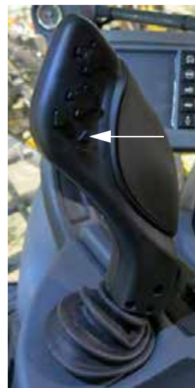
Támasztómű kapcsoló - FEL (a hidrosztatikus vezérlést irányító karon - 1-es változat) - Tipikus nézet
