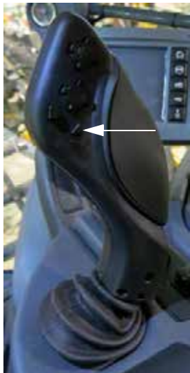
Támasztómű kapcsolója - FEL (a hidrosztatikus vezérlést irányító kar 1-es változatán) - Tipikus nézet
