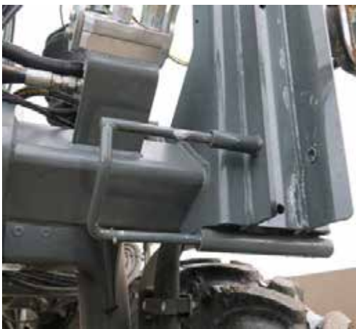
Záró csapszeg (a munkagép elülső bal és jobb oldalán) - Tipikus nézet
