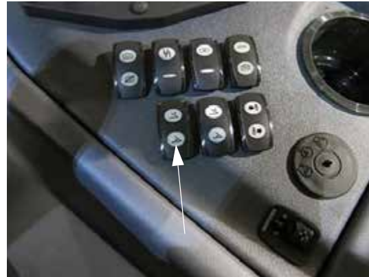
Gém/NTB toldalék kapcsoló (oldalsó vezérlőpulton) - Tipikus nézet
