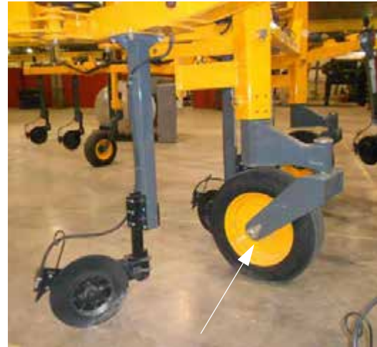
Mérőkerék - Kaliber kerék (az NTB mindegyik oldalán egy-egy) - Tipikus nézet
