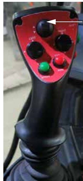
Támasztómű kapcsoló - Fel [UP] (a hidrosztatikus vezérlést irányító karon - 2-es változaton) - Tipikus nézet
