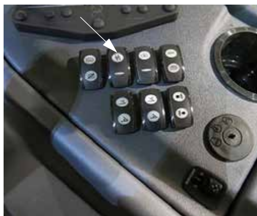
Permetlé szivattyú kapcsolója (oldalsó vezérlőpulton) - Tipikus nézet
