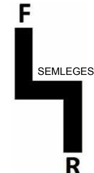
Hidrosztatikus vezérlést irányító kar (2-es változat)
