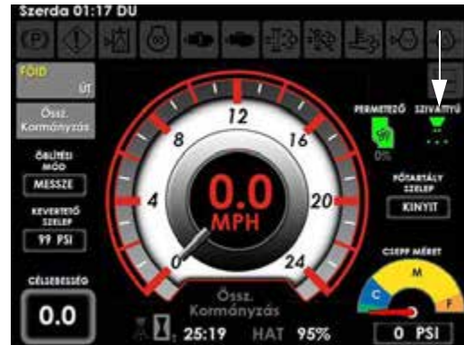
Elsődleges permetező kijelzője (a munkagép képernyőjének kezdőoldalán - Mezei módban)
