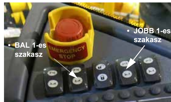
Fő-(1-es) szakaszok Felemelés/Leengedés kapcsolói (oldalsó vezérlőpulton) - Tipikus nézet
