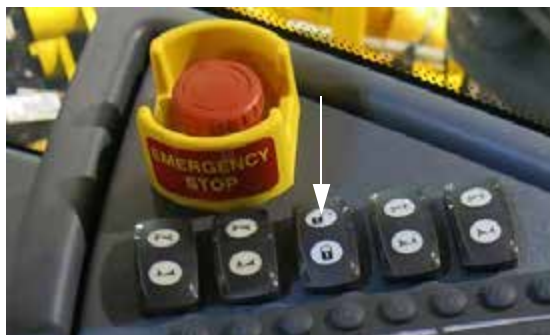
A kaliber kerék/rögzítő szerelvény kapcsolója (az oldalkonzolon van) - Tipikus nézet
