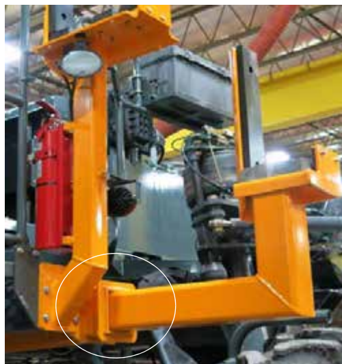
Tartónyereg csatlakozóaljzata (a gép tartónyeregénél a munkagép oldalán) - Tipikus nézet
