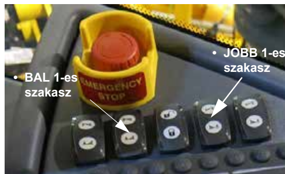
1-as szakaszok Felemelés/Leengedés kapcsolói (oldalsó vezérlőpulton) - Tipikus nézet
