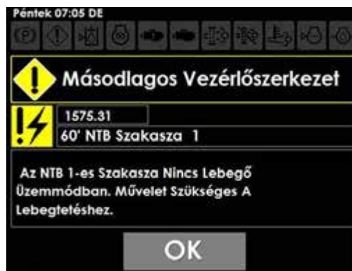
60' NTB főszakasz (1-es szakasz) figyelmeztető üzenete
