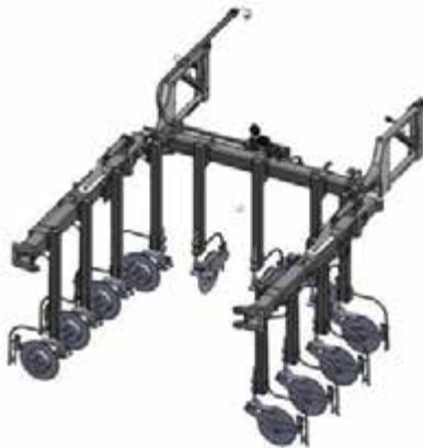
30 láb hosszú NTB csuklópontjai (Behajtott pozíciót mutatja) - Tipikus nézet
