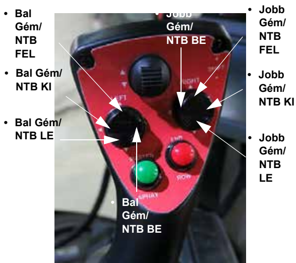
Bal és jobb gém/NTB kapcsolók (a hidrosztatikus vezérlést irányító kar 2-es változatán) - Tipikus nézet
