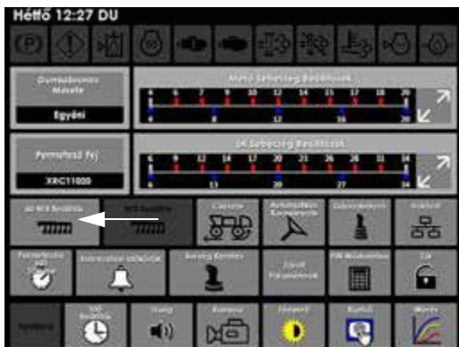
A 60' NTB beállítás gombja (a munkagép képernyőjének beállítások oldalán)
