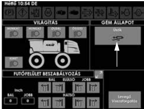
Lebegtetés (úsztatás) gomb (a munkagép képernyőjének segédvezérlések oldalán)
