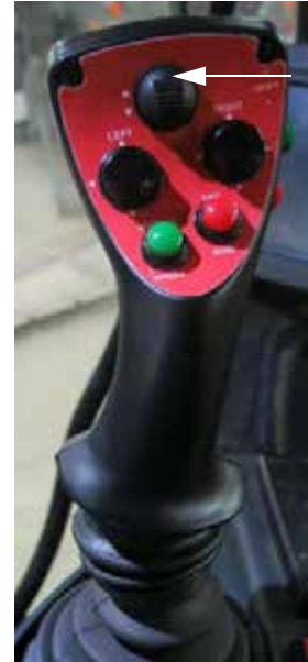
Támasztómű kapcsolója - FEL (a hidrosztatikus vezérlést irányító kar 2-es változatán) - Tipikus nézet
