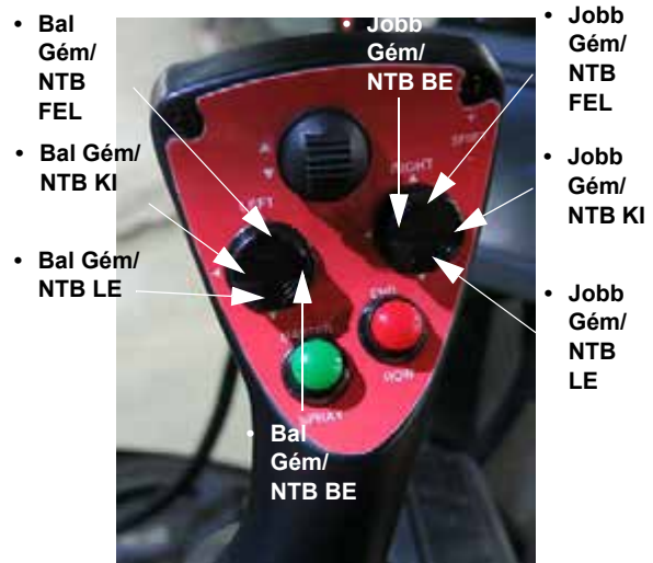
Bal és jobb gém/NTB kapcsolói (a hidrosztatikus vezérlést irányító kar 2-es változatán) - Tipikus nézet
