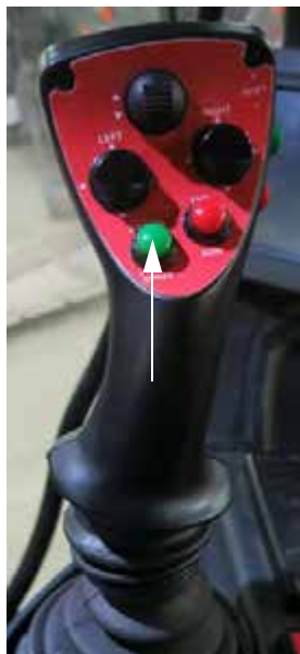
Elsődleges permetező kapcsoló (a hidrosztatikus vezérlést irányító kar hátoldalán - 2-es változatnál) - Tipikus nézet
