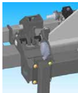
Zárószelvény „Rögzített/Zárt” helyzetét mutatja
