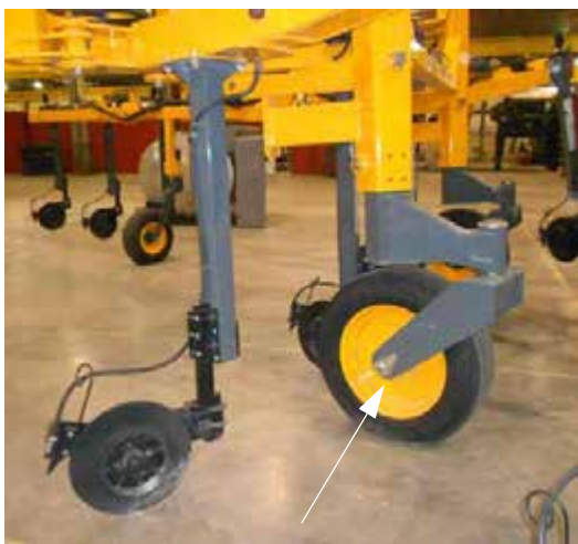
Mérőkerék - Kaliber kerék (az NTB mindegyik oldalán egy-egy) - Tipikus nézet
