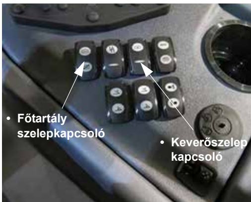
Főtartály és keverőszelep kapcsolók (oldalsó vezérlőpulton) - Tipikus nézet
