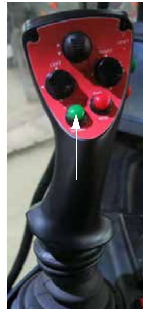
Elsődleges permetező kapcsoló (a hidrosztatikus vezérlést irányító kar hátdalán - 2-es változaton) - Tipikus nézet
