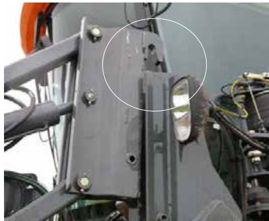
Szerelvény leválasztása a tartócsapról - Tipikus nézet
