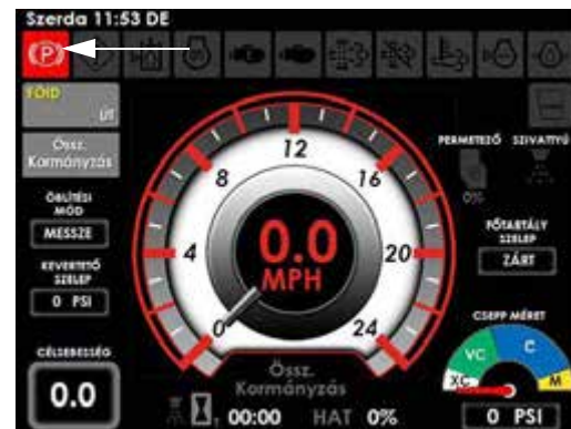
Rögzítőfék jelzés (A munkagép képernyőjének minden egyik oldalán, a bal felső részen)
