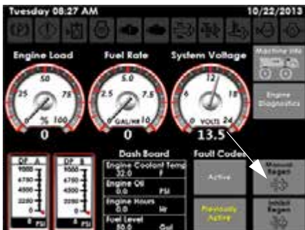
Kézi regeneráló gomb (a gépdiagnosztika oldal alján)
