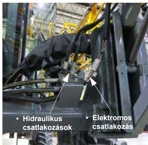
Hidraulikus/elektromos csatlakozások – “szabványos” (a gép elülső bal oldalánál helyezkedik el) – Tipikus nézet
