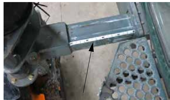
Nyomtáv beállítás jelzőmatrica (Első lábak) - Tipikus nézet
