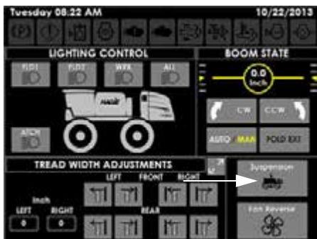
Felfüggesztés gomb (a munkagép képernyőjén található) segédvezérlések oldalán)
