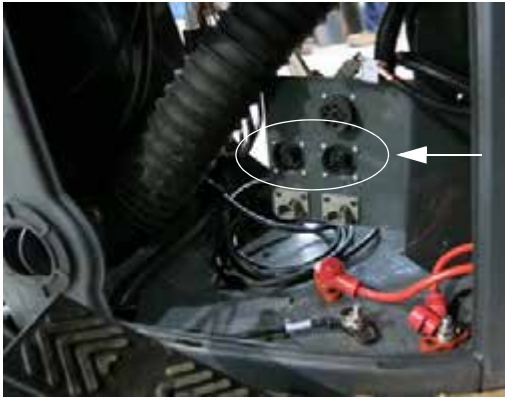
Hagie diagnosztikai csatlakozások (2) (az oldalkonzol belsejében – a panel levételével férhet hozzá) – Tipikus nézet
