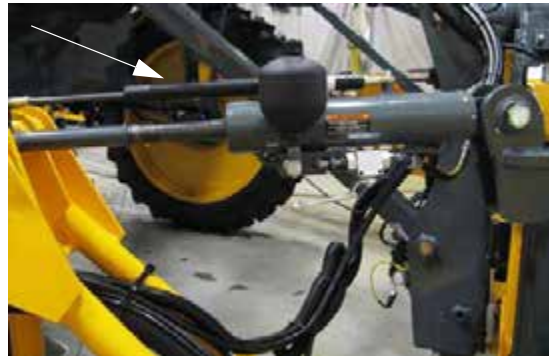
Helyzetérzékelők – Tipikus nézet
