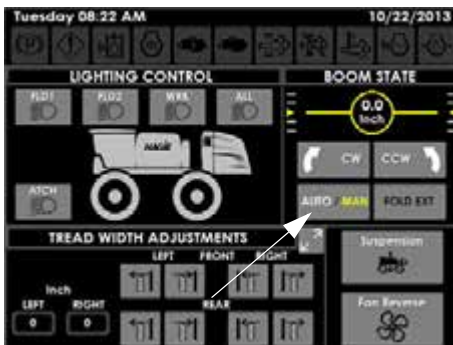
Gém állapot gombok - Automatikus/Kézi (a Segédvezérlések oldalán)
