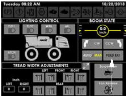
Hajt. tartozék (Ext) gomb (a munkagép képernyőjének Segédvezérlések oldalán)
