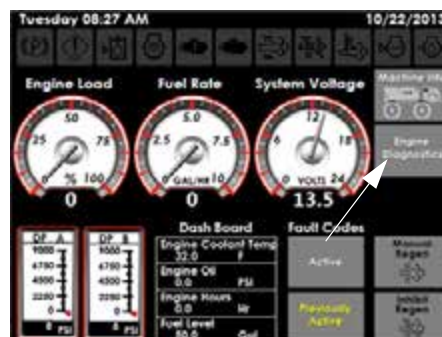
Motor diagnosztikai gomb (a gépdiagnosztikai oldalon)
