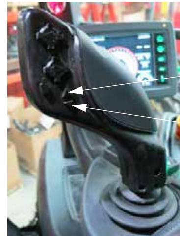
Összes – Fel/Le kapcsolók (a hidrosztatikus hajtás vezérlő karján helyezkedik el) – Tipikus nézet
