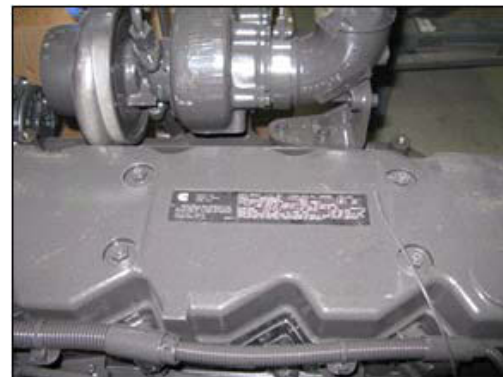
Motor gyári száma – Tipikus nézet
