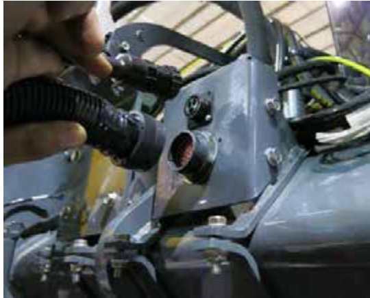
Elektromos csatlakozások (a gép jobb oldalánál helyezkedik el) – Tipikus nézet
