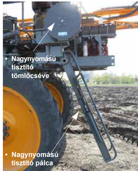
Nagynyomású tisztító rúd/ Tömlőrső szerelvény (a gép bal oldalán a létra közelében) – Tipikus nézet
