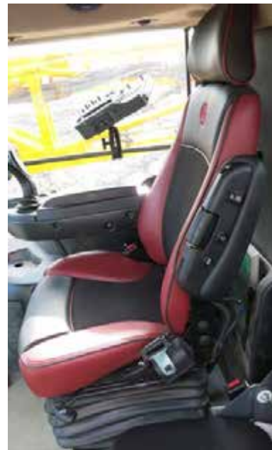
Kezelőjelenlét kapcsoló (a kezelő ülésében) - Tipikus nézet
