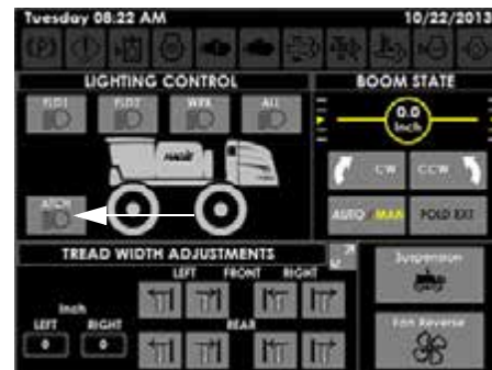
Tartozék lámpák gombja (a Kiegészítő vezérlők oldalán)
