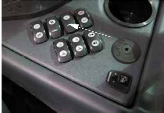
Keverőszelep kapcsoló (oldalsó vezérlőpulton) - Tipikus nézet
