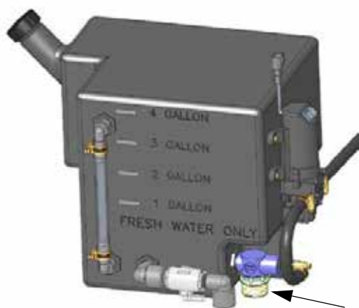
Kézmósó szűrőszita (a kézi víz tartály aljának közelében van elhelyezve) – Tipikus nézet
