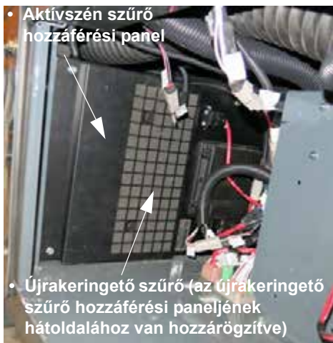
Aktívszén szűrő hozzáférési panel (a vezetőfülke jobb oldalán, a külső szerviz panel mögött helyezkedik el) – Tipikus nézet
