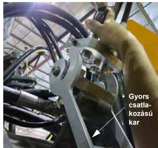
Hidraulikus/elektromos multi-csatlakozó összeszerelés (a gép bal oldalánál helyezkedik el) – Tipikus nézet
