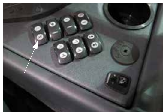
Főtartály szelep kapcsolója (oldalsó vezérlőpulton) - Tipikus nézet
