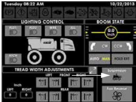
Felfüggesztés gomb (a munkagép képernyőjén található a segédvezérlések oldalán)
