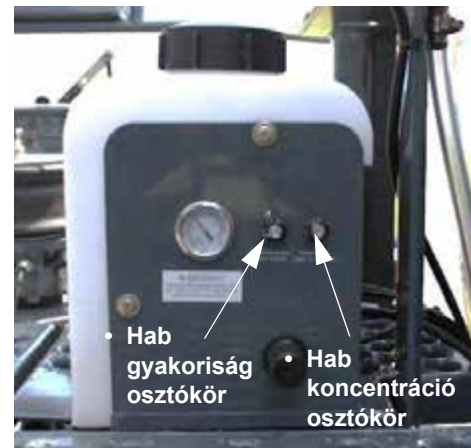
Hab nyomás és koncentrációs osztókör (a habzást jelző tartály oldalán) – Tipikus nézet
