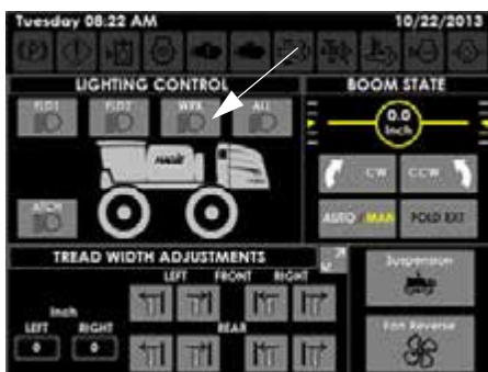
Munkalámpák gombjai (a Kiegészítő vezérlők oldalán)
