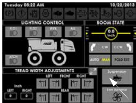
Felfüggesztés gombja (a munkagép Képernyőjén található a segédvezérlések oldalán)
