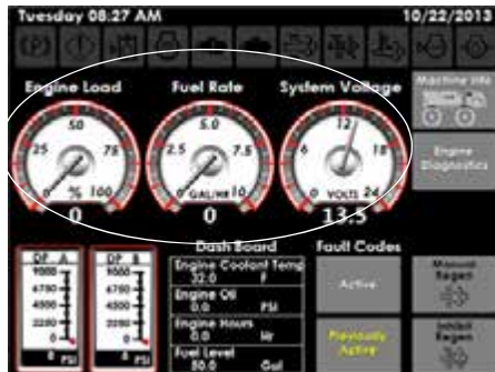
A munkagép mérőműszerei (a gépdiaosztikái oldalon)
