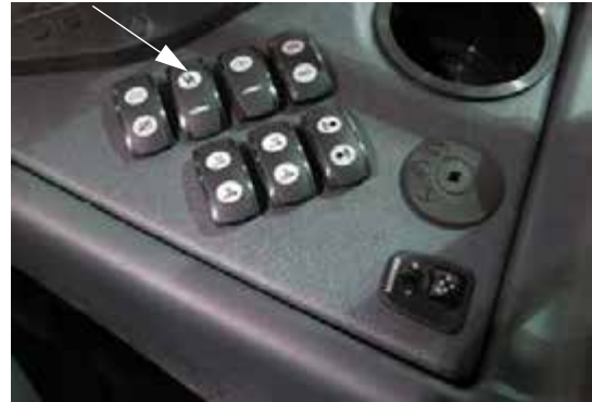
Permetlé szivattyú kapcsolója (oldalsó vezérlőpulton) – Tipikus nézet
