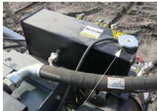
Vízhűtő sapka (a motortérben van elhelyezve) – Tipikus nézet
