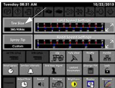
Gumiabroncs méret (gumitömlő terjedelem) gomb (a beállítások oldalán)
