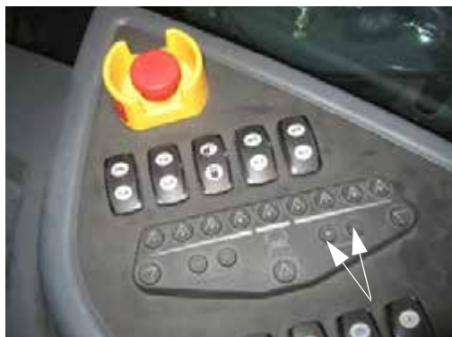
Szivattyú sebesség/Arány kapcsolók (oldalsó vezérlőpulton) –Tipikus nézet
