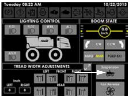
Felfüggesztés gomb (munkagép képernyőjén található a Segédvezérlések oldalán)
