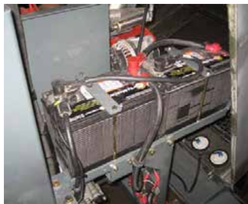
Hozzáférés az akkumulátorokhoz (a gép bal oldalán – a hozzáféréshez nyissa ki a motorháztetőt) – Tipikus nézet
