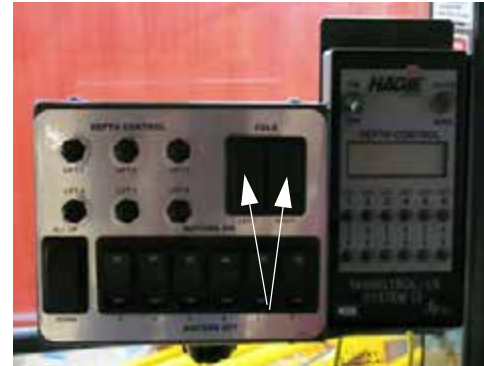
Bal/jobb behajtó kapcsolók (a címerező vezérlőpaneljén található) -Tipikus nézet
