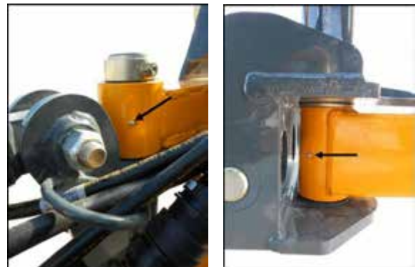
Forgótengelyes támasztómű – Tipikus nézet
