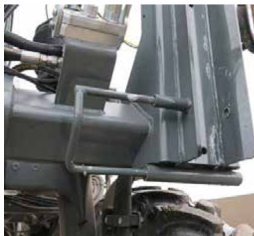
Záró csapszeg (a gép elülső bal, és jobb oldalánál helyezkedik el) – Tipikus nézet
