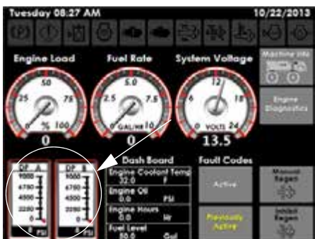
HSZ-A/HSZ-B mérőműszerek (a gépdiagnosztika oldal jobb oldalán alul)
