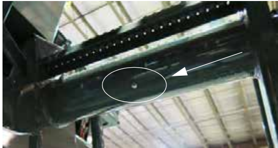
Létra, forgástengely hüvely – Tipikus nézet
