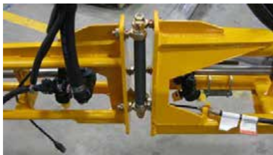
Gém törésgátló – Tipikus nézet
