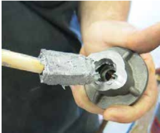
Beragadás gátló kenőanyag alkalmazása – Tipikus nézet
