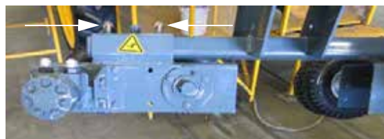
Tépőfej csavarok (minden egyes tépőfej rögzítő csövön el van helyezve) – Tipikus nézet
