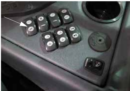
Főtartály szelep kapcsolója (oldalsó vezérlőpulton) – Tipikus nézet
