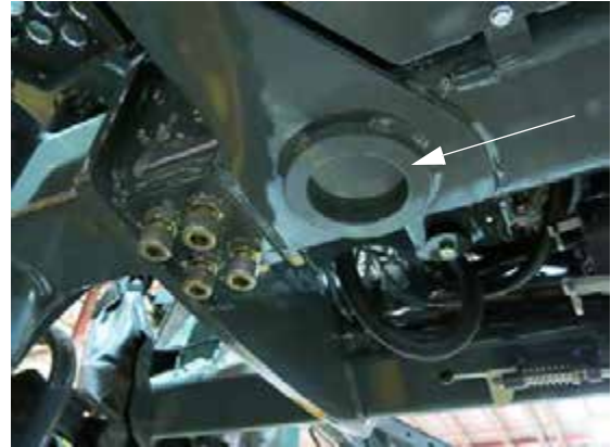
Emelési pont, szorító gyűrűk (a vázon vannak elhelyezve, az egyes lábak közelében) – Tipikus nézet
