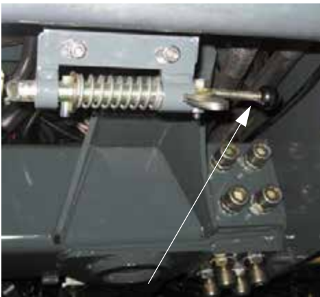
Elülső töltő kioldó kar (a gép elülső vége alatt van elhelyezve) – Tipikus nézet
