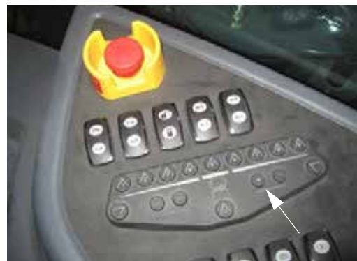
„+” szivattyú sebesség/arány kapcsoló (oldalsó vezérlőpulton) – Tipikus nézet
