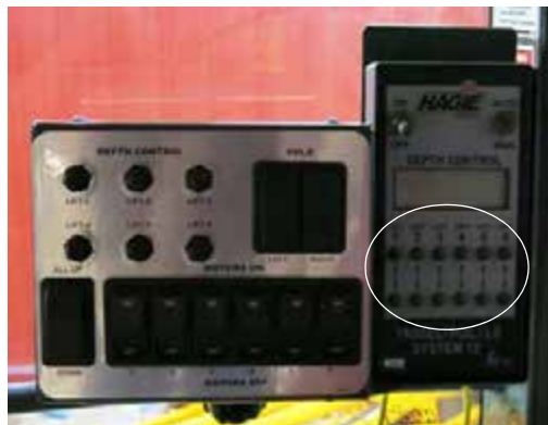
Felemelés/lesüllyesztés kapcsolók (a Tasselrol vezérlőpanelen található) – Tipikus nézet
