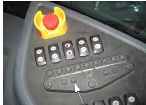
Kézi „KÉZI” arány szabályzó kapcsoló (oldalsó vezérlőpulton)
