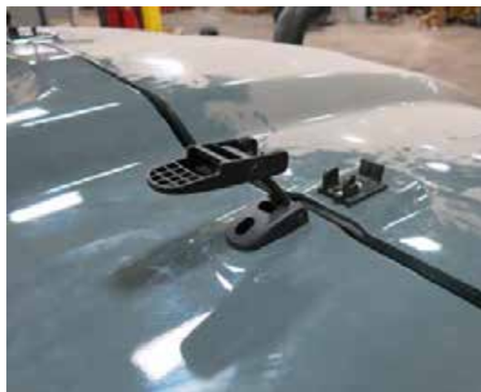
Motorházatetű retesz (2) (a motorházatetű mindkét oldalán) – Tipikus nézet
