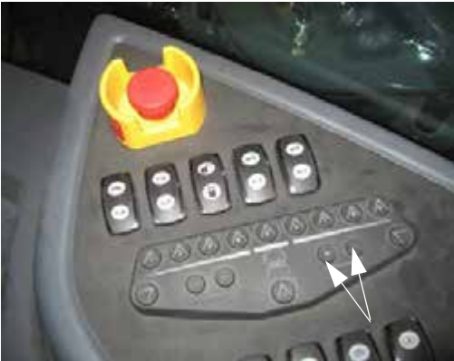
Szivattyú sebesség/Arány kapcsolók (oldalsó vezérlőpulton) – Tipikus nézet
