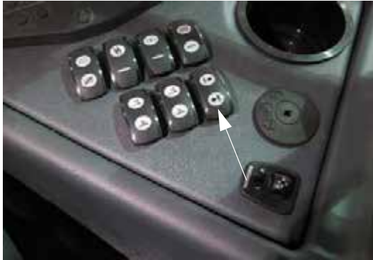
Habjelölő kapcsolója (oldalsó vezérlőpulton) – Tipikus nézet
