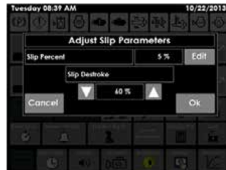
Csúszási értékek be szabályozása képernyő
