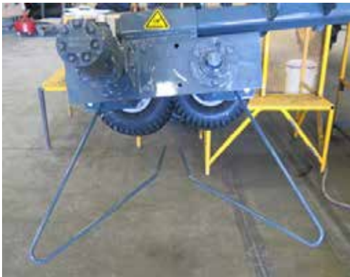
Szár vezető elhelyezése – Tipikus nézet
