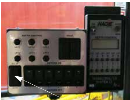
Összes – Fel/Le kapcsoló (a címerező vezérlő paneljén helyezkedik el) – Tipikus nézet
