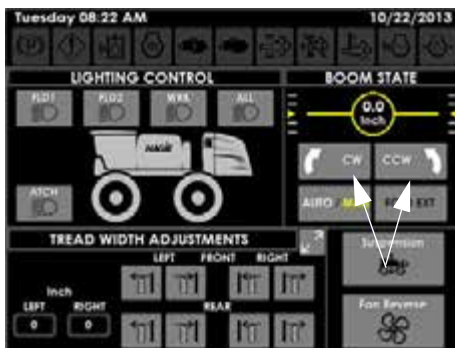
Behajtás/forgatás vezérlő gombok (CW/CCW)
