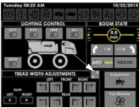
Nyomtáv oldal gomb (a Gép képernyője – Kiegészítő vezérlők oldalán)
