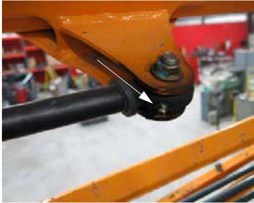
Gém törésgátló henger rúd vég – Tipikus nézet
