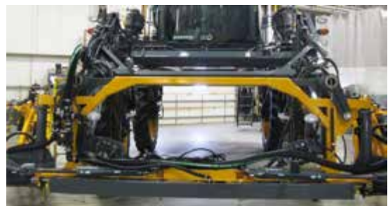
Forgótengelyes támasztómű – Tipikus nézet
