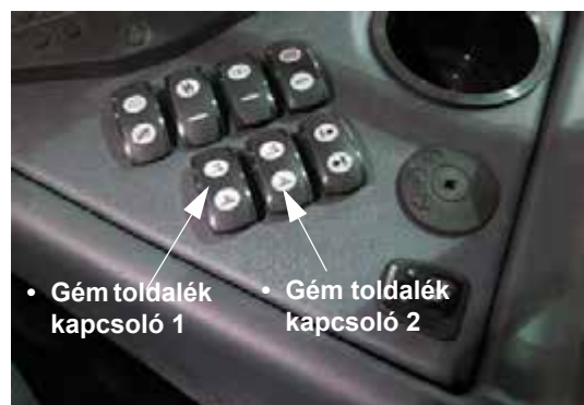
Gém toldalék kapcsolók (oldalsó vezérlőpulton) – Tipikus nézet
