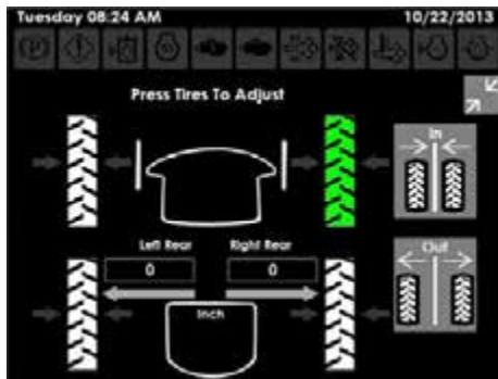
Nyomtáv beállítása oldal
