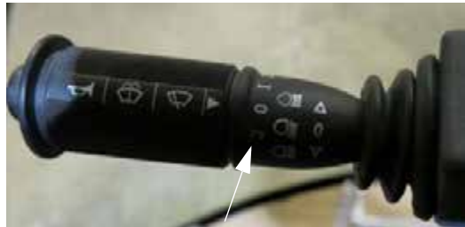
Ablaktörlő sebesség (az irányjelző kapcsolón) – Tipikus nézet
