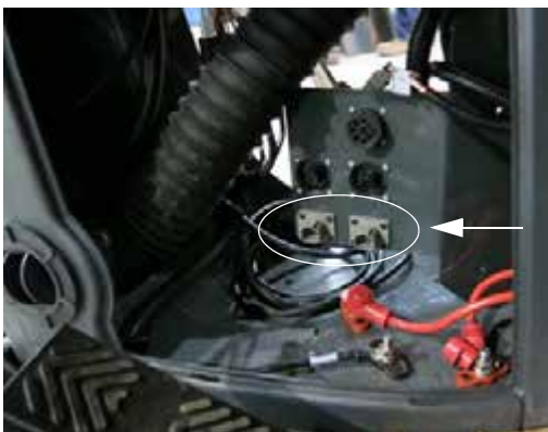
4 tús elektromos csatlakozó (2) (az oldalkonzol belsejében – a panel levételével férhet hozzá) – Tipikus nézet
