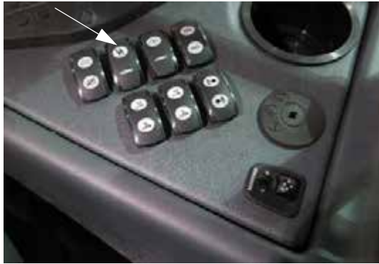
Permetlé szivattyú kapcsolója (oldalsó vezérlőpulton) – Tipikus nézet
