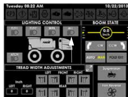
Összes lámpa gombja (a Kiegészítő vezérlők oldalán)
