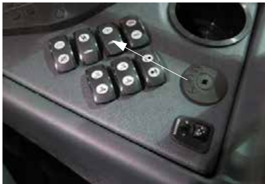
Keverőszelep kapcsoló (oldalsó vezérlőpulton) – Tipikus nézet
