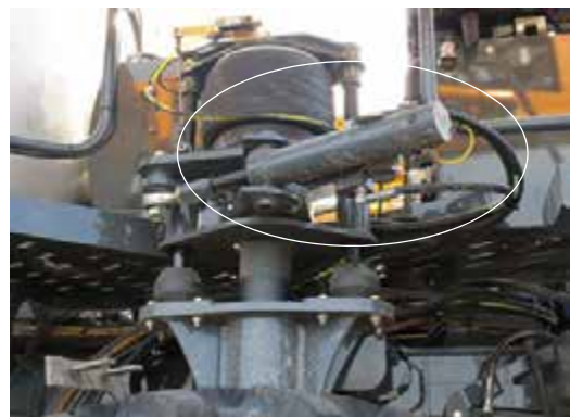
Kormány munkahenger (a hátsó lábakon) – Tipikus nézet
