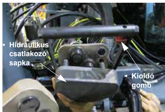
Hidraulikus csatlakozó sapka és kioldó gomb (a gép jobb oldalánál helyezkedik el) – Tipikus nézet
