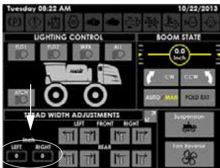
Bal/jobb nyomtáv szélesség kijelzők - hátsó lábak (a munkagép képernyőjének Segédvezérlések oldalán)
