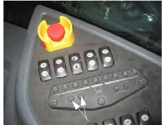
Mérték szabályzó kapcsolók (oldalsó vezérlőpulton) – Tipikus nézet
