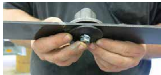
Vágó penge összeszerelés – Tipikus nézet
