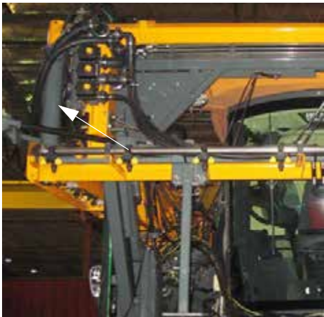
Támasztómű, forgástengely hüvely – Tipikus nézet
