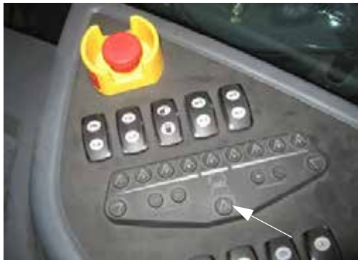
Hátsó fúvóka kapcsoló (oldalsó vezérlőpulton) – Tipikus nézet
