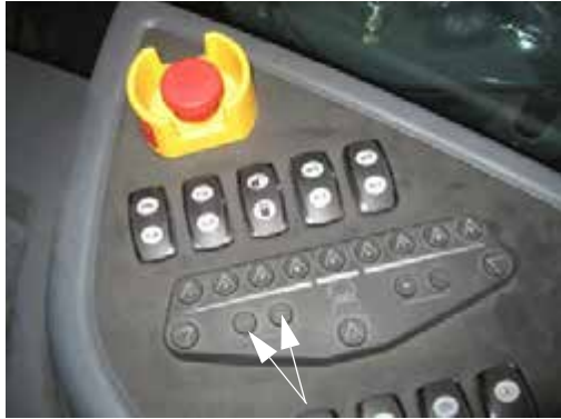
Mérték szabályzó kapcsolók (oldalsó vezérlőpulton) – Tipikus nézet
