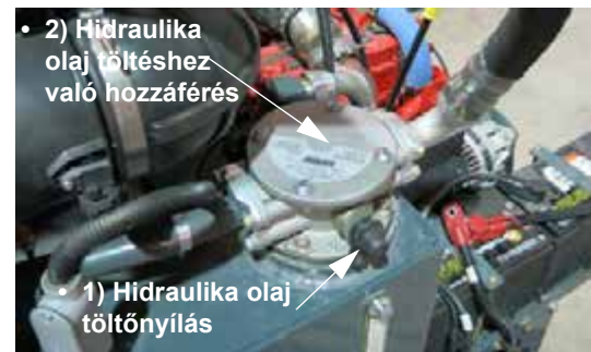
Hidraulika olaj töltés opciók – Tipikus nézet
