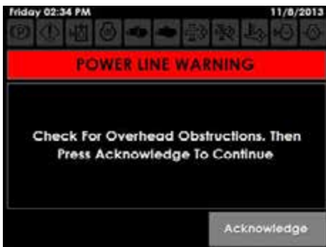
Elektromos vezeték figyelmeztető üzenet (munkagép képernyőjén található)
