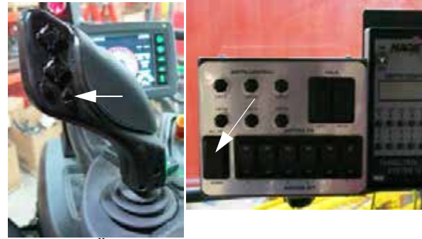
Összes – Fel/Le kapcsoló (a hidrosztatikus vezérlést irányító karon vagy a címerező vezérlő paneljén) – Tipikus nézet
