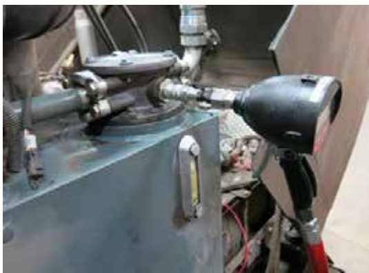
Tartály töltése a hidraulikus olaj töltő nyíláson keresztül –Tipikus nézet
