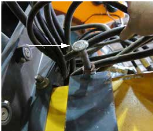
Rögzítő csap (minden egyes kombinált szerelvény állvány belső oldalánál helyezkedik el) – Tipikus nézet
