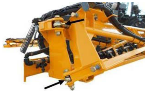
Gém összehajtás kapcsolódásai – Tipikus nézet
