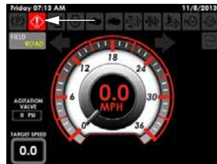
Figyelmeztető fényjelzés (a gép kijelzőjének minden egyes oldalán, a bal felső részen)
