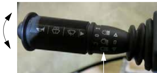
Reflektor (az irányjelző kapcsolón) – Tipikus nézet
