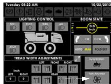
Változtatható forgásirányú ventilátor gomb (a Segédvezérlések oldalán)
