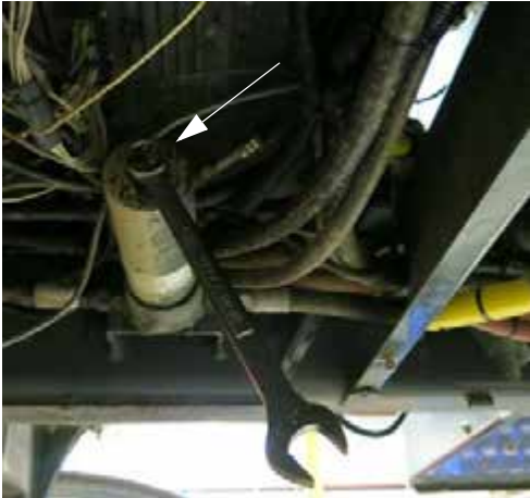
Carcasa filtrului de presiune (amplasat sub partea dreaptă a utilajului - coborâți scutul metalic pentru accesare) - Vedere tipică
