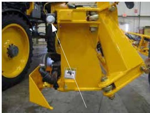
Senzori de proximitate - Vedere tipică
