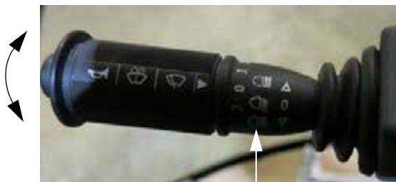
Fază lungă (amplasată pe maneta de semnalizare) - Vedere tipică
