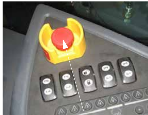
Comutator E-Stop (amplasat pe consola laterală) - Vedere tipică
