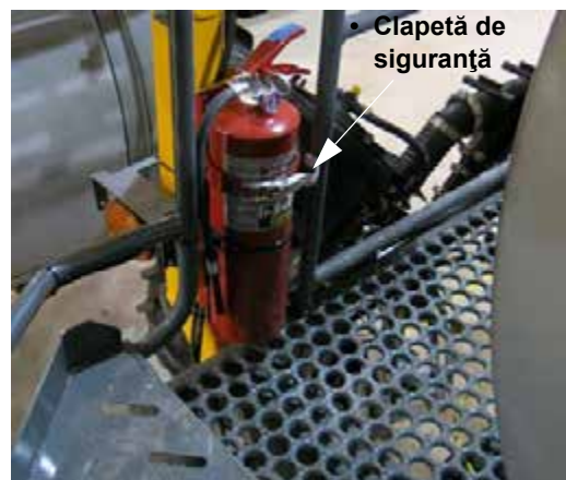
Extingtor (amplasat de-a lungul punții de acces, pe partea stângă a utilajului) - Vedere tipică
