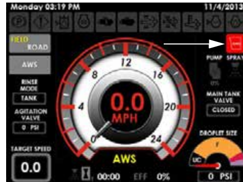
Indicator Presiune aer insuficientă în cabină (amplasat pe Pagina inițială a afișajului utilajului - modul Drum sau Câmp)
