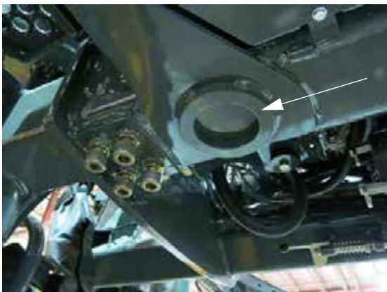
Inele de izolare punct de ridicare (amplasate pe cadru, aproape de fiecare picior) - Vedere tipică
