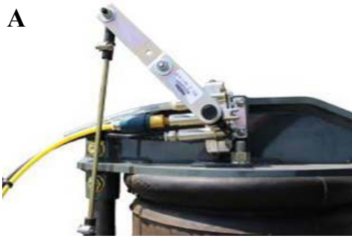
Supapă golire (o supapă este amplasată pe fiecare picior) - Vedere tipică
