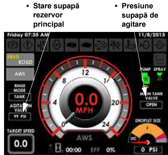
Indicatoarele presiunii supapei de agitare și stării supapei rezervorului principal (amplasate pe Pagina inițială a afișajului utilajului - modul Câmp)
