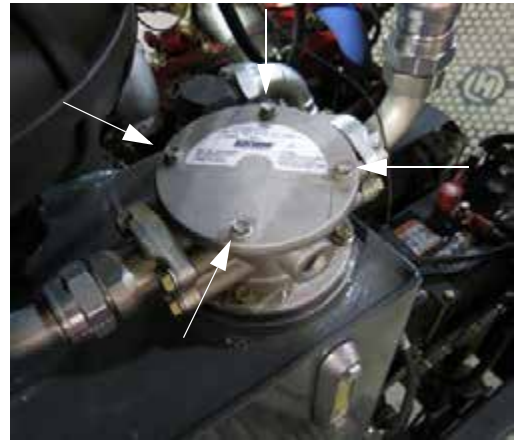
Carcasa filtrului de retur (amplasat pe partea stângă a utilajului - lângă rezervorul de ulei hidraulic) - Vedere tipică
