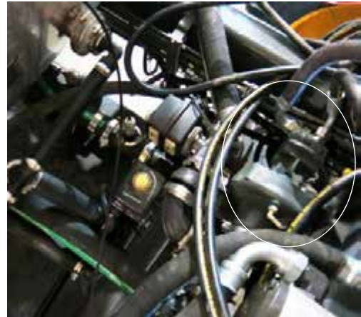
Pompă de soluție (amplasată în apropierea centrului utilajului) - Vedere tipică * Vedere de sus a utilajului
