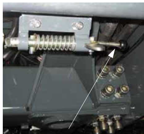
Maneta de eliberare a gurii de umplere frontală (amplasată sub capătul frontal al utilajului) -Vedere tipică
