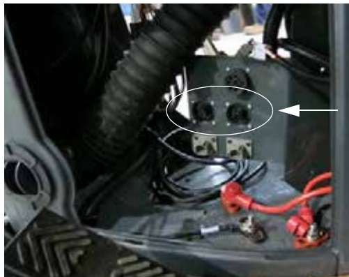
Porturi de Diagnoză Hagie (2) (amplasate în interiorul consolei laterale - demontați panoul frontal pentru acces) - Vedere tipică
