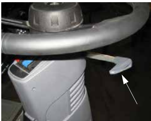
Mâner reglare tub telescopic volan (amplasat la dreapta coloanei de direcție) - Vedere tipică
