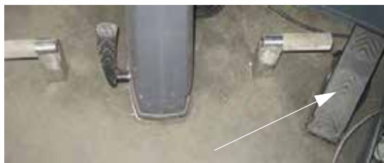
Pedală de decelerare (amplasată pe partea din dreapta jos a coloanei de direcție) - Vedere tipică
