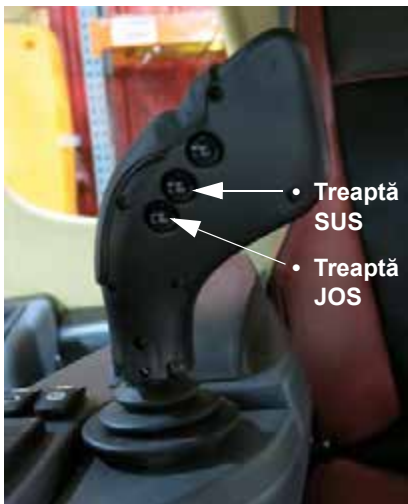
Comutatoare schimbare într-o treaptă superioară/inferioară (amplasate pe partea din spate a manetei de comandă a transmisiei hidrostactice) - Vedere tipică
