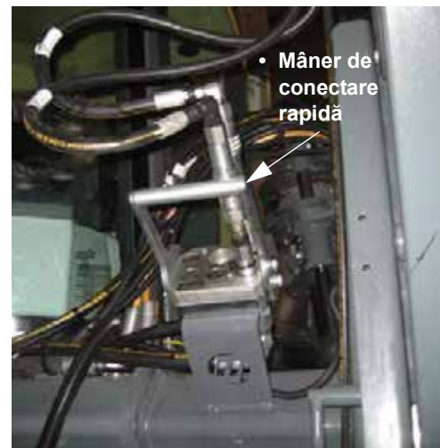
Ansamblu cuplaj multiplu hidraulic/electric - „dacă este prevăzut cu această componentă” (amplasat pe partea din stânga față a utilajului)
