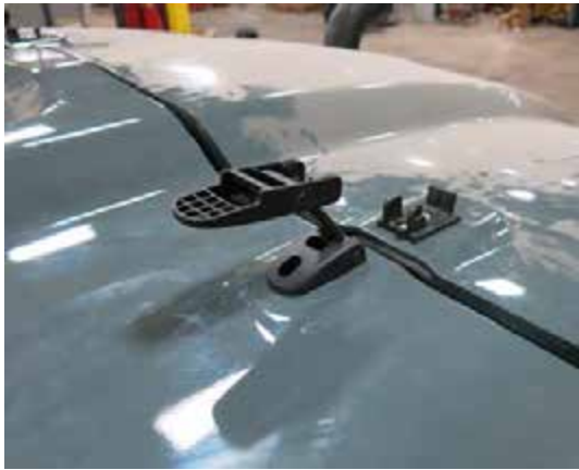
Clapetă de siguranță capotă (2) (amplasate pe ambele părți ale capotei superioare) - Vedere tipică
