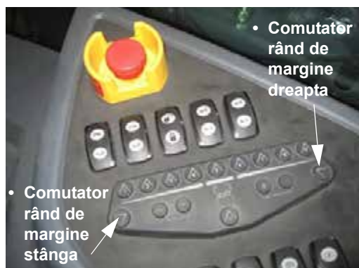
Comutatoarele rândurilor de la margine - stânga și dreapta (Pe consola laterală) - Vedere tipică
