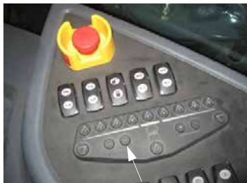
Comutatorul de control al debitului „MAN” (manual) (amplasat pe consola laterală) - Vedere tipică
