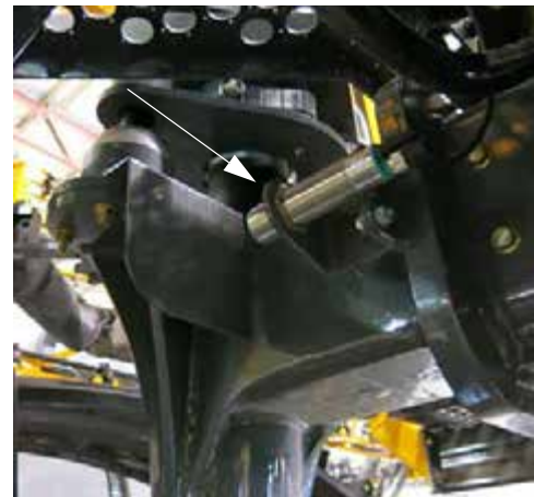
Senzor electronic de reglare a benzii de rulare (picioare spate) - Vedere tipică
