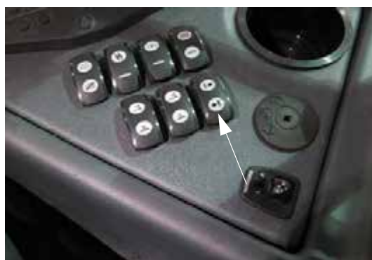
Comutator marcator cu spumă (amplasat pe consola laterală) - Vedere tipică
