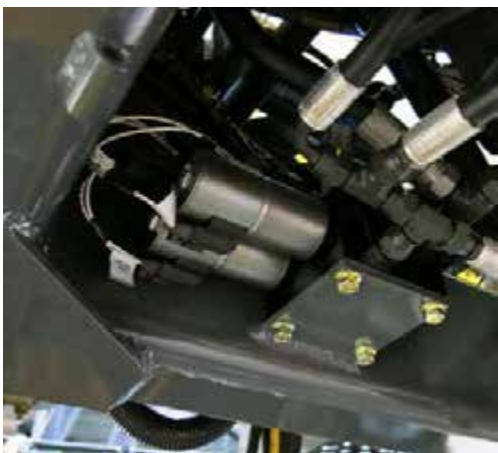
Colector de supape (amplasat pe partea inferioară a utilajului) - Vedere tipică
