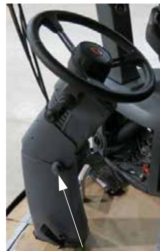
Buton de reglare a înclinării coloanei de direcție (amplasat pe partea stângă a coloanei de direcție) - Vedere tipică
