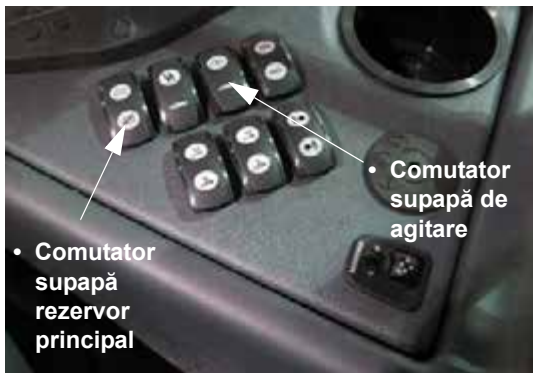
Comutatoarele supapei de agitare și rezervorului principal (amplasate pe consola laterală) - Vedere tipică
