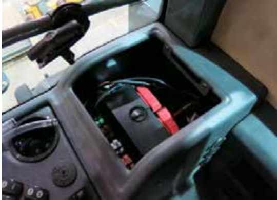
Înterupătoare de circuit/Siguranțe (interior) (amplasate pe consola laterală - demontați tava pentru a le accesa) - Vedere tipică
