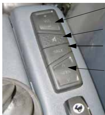
Comenzi sistem stereo de la distanță (amplasate lângă maneta de comandă a transmisiei hidrostatice) - Vedere tipică
