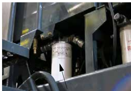
Filtru de drenare a carcasei (amplasat pe partea stângă a utilajului) - Vedere tipică
