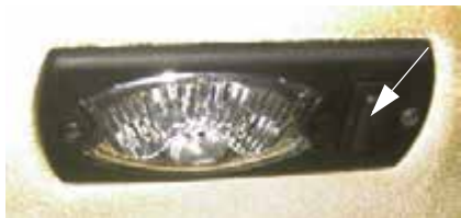
Comutator lampă interioară de lucru - Vedere tipică
