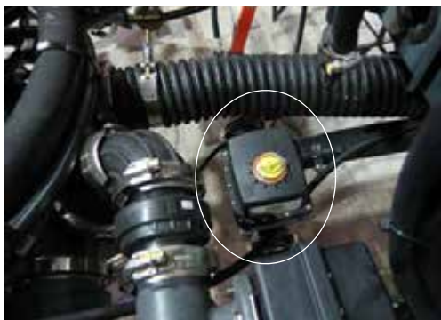
Supapă de agitare (amplasată în apropierea centrului utilajului) - Vedere tipică * Vedere de sus a utilajului
