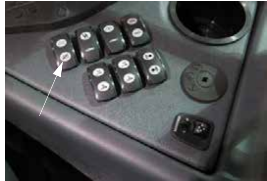
Comutator supapă rezervor principal (amplasat pe consola laterală) - Vedere tipică
