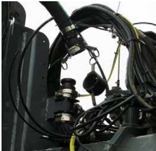
Conexiune pentru soluție (amplasată pe partea din dreapta față a utilajului) - Vedere tipică
