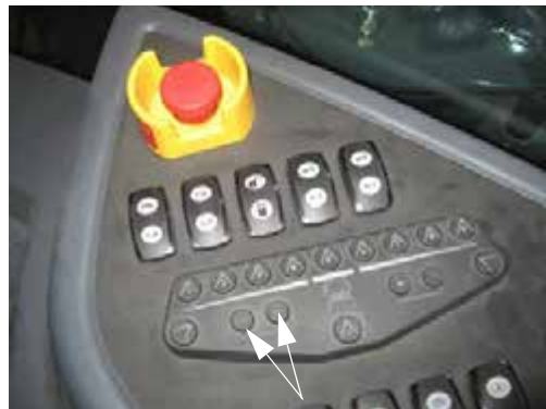
Comutatoare de control debit (amplasat pe consola laterală) - Vedere tipică
