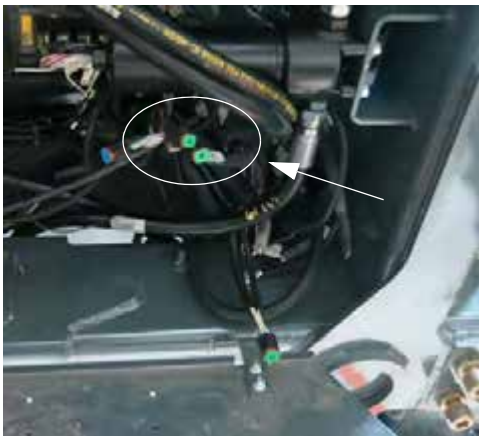
Conexiuni de intrare cameră video (amplasate sub cabină - demontați panoul frontal pentru acces) - Vedere tipică
