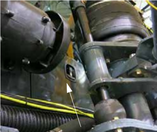
Panou de revizie exterior (amplasat pe partea dreaptă a cabinei) - Vedere tipică
