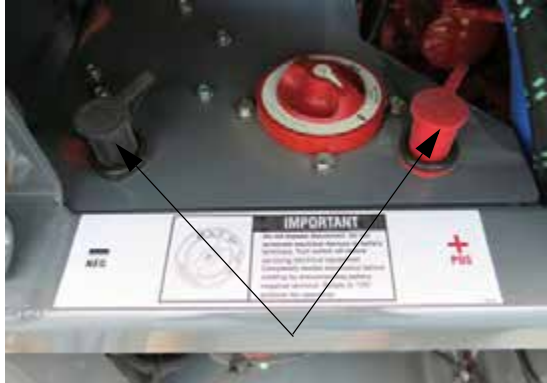
Borne auxiliare pentru încărcarea bateriilor (amplasate pe cadrul principal din spate) - Vedere tipică
