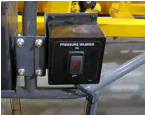
Comutator aparat de curățat cu presiune (amplasat de-a lungul balustradei, pe partea stângă a utilajului) - Vedere tipică
