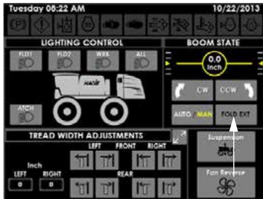
Butonul Fold Extension (Ext) (pliere extensie) (amplasat pe pagina Comenzi auxiliare de pe afișajul utilajului)
