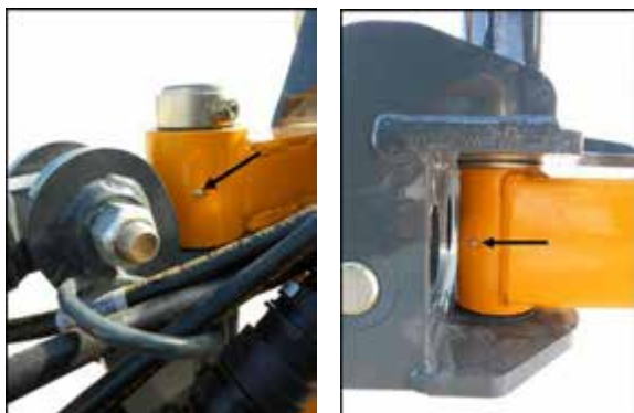
Traversă pivotantă - Vedere tipică
