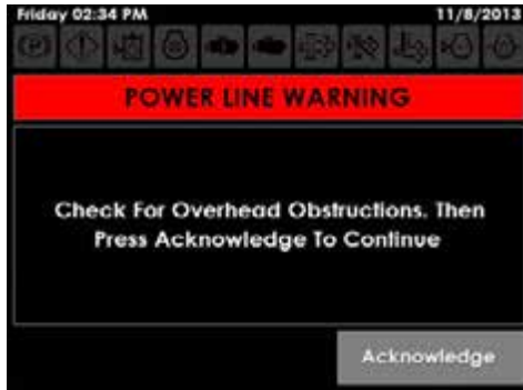
Mesaj de avertizare privind liniile de alimentare cu energie electrică (amplasat pe afișajul utilajului)
