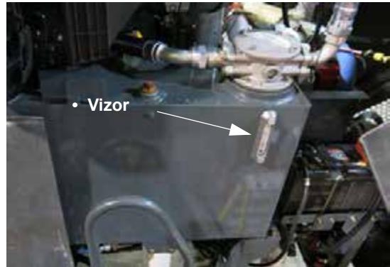
Rezervor de ulei hidraulic (amplasat pe partea stângă a utilajului - deschideți capota pentru accesare) - Vedere tipică
