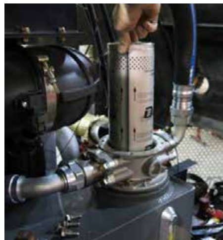
Filtru de retur (amplasat în carcasa filtrului, pe partea stângă a utilajului) - Vedere tipică
