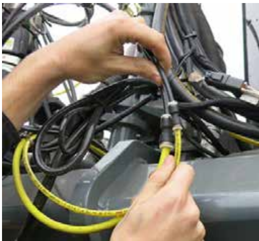
Conexiune marcator cu spumă (amplasată pe partea din dreapta față a utilajului) - Vedere tipică
