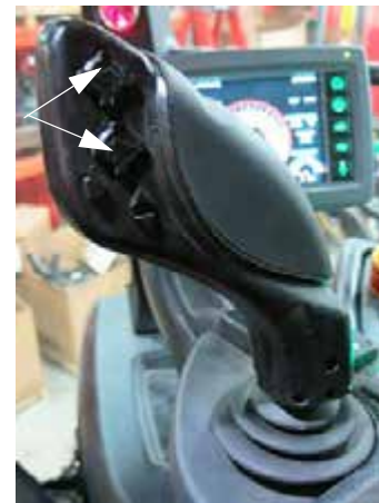
Comutatoare brațe stânga și din dreapta (amplasate pe maneta de comandă a transmisiei hidrostactice) - Vedere tipică
