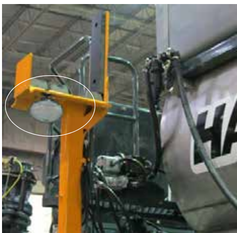
Lumini de lucru (amplasate pe fiecare cadru de braț) - Vedere tipică
