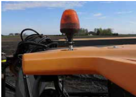
Girofar (amplasat pe fiecare parte laterală a cabinei) - Vedere tipică
