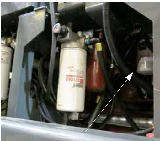
Filtrul de ulei de motor (amplasat în partea stângă a utilajului) - Vedere tipică
