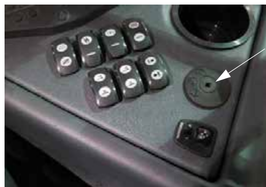
Contact de pornire (amplasat pe consola laterală) - Vedere tipică
