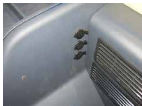
12 porturi de alimentare de 12 V - Se ilustrează instalarea tipică
