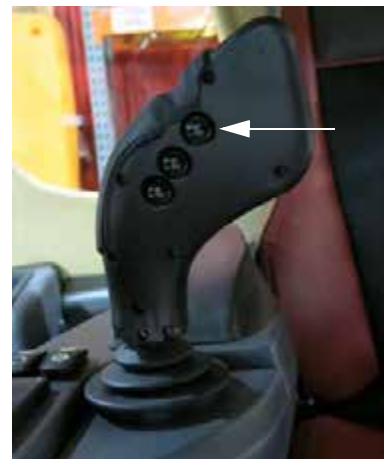
Comutator pulverizator principal (amplasat pe partea din spate a manetei de comandă a transmisiei hidrostactice)
