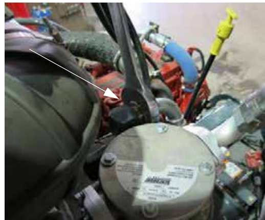
Furtun de drenare a carcasei (amplasat lângă partea superioară a rezervorului hidraulic) - Vedere tipică
