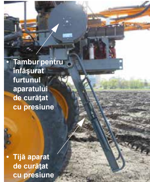
Ansamblu tijă/ tambur pentru înfășurat furtunul al aparatului de curățat cu presiune (amplasat lângă scară, pe partea stângă a utilajului) - Vedere tipică
