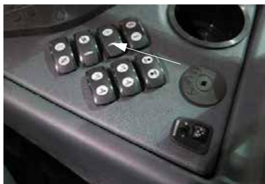
Comutator de agitare (amplasat pe consola laterală) - Vedere tipică
