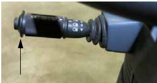
Comutator spălător parbriz (amplasat la capătul manetei de semnalizare) - Vedere tipică
