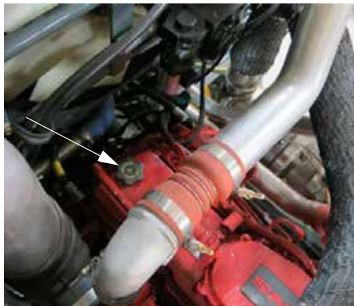
Gură de umplere cu ulei de motor (amplasată în apropierea părții frontale a motorului) - Vedere tipică
