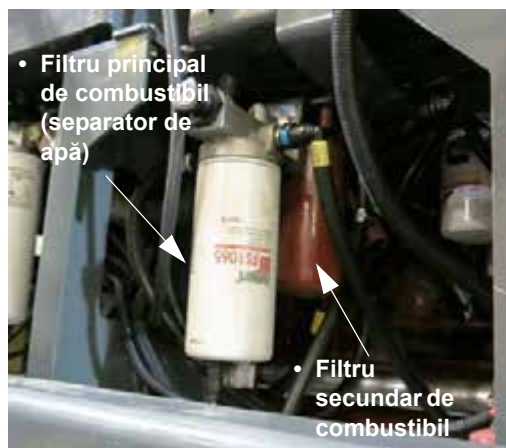
Filtre de combustibil principal și secundar (amplasat în partea stângă a utilajului) - Vedere tipică
