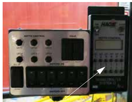
Panou de comandă Tasseltrol/LS System 12 - Vedere tipică
