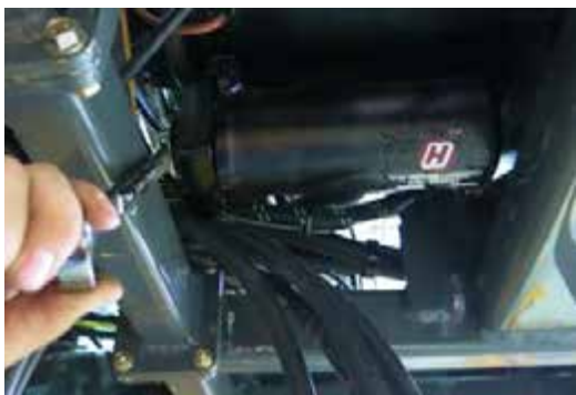
Filtru pompă de încărcare (amplasat sub pompa de transmisie) - Vedere tipică
