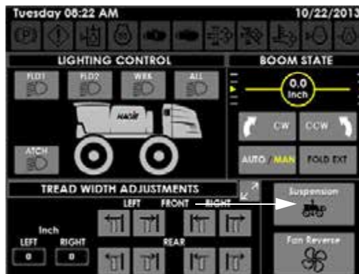
Butonul Suspensie (amplasat pe pagina Comenzi auxiliare de pe afișajul utilajului)
