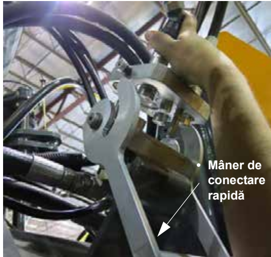
Ansamblu cuplaj multiplu hidraulic/electric (este prezentată partea stângă a utilajului) - Vedere tipică
