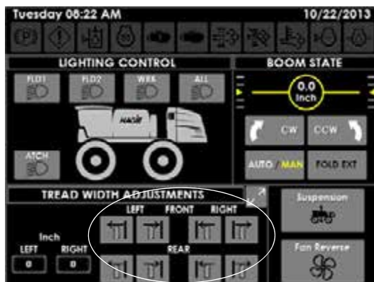
Butoane de reglare a benzii de rulare (amplasate pe partea inferioară a paginii Comenzi auxiliare de pe afișajul utilajului)
