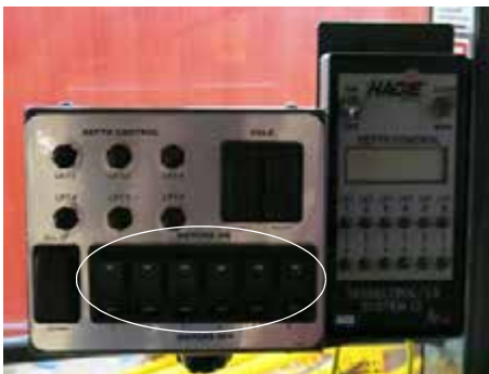
Comutatoarele de comandă a motorului (amplasate pe panoul de comandă pentru castrarea porumbului) - Vedere tipică
