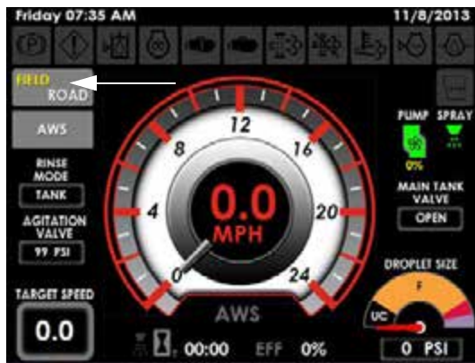
Buton Field/Road (Câmp/Drum) (amplasat pe Pagina inițială a afișajului utilajului)
