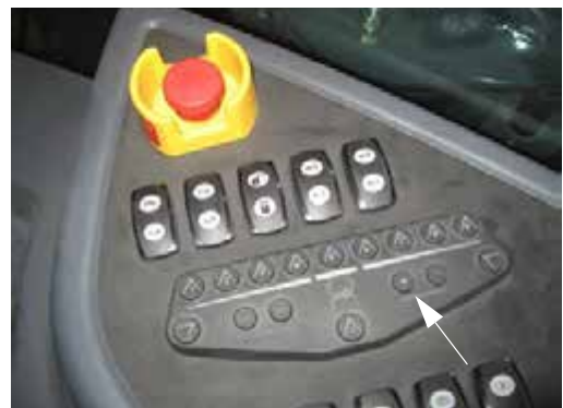
Comutator de debit/turație pompă „+” (amplasat pe consola laterală) - Vedere tipică
