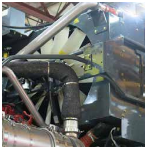
Ventilatorul reversibil (amplasat în apropierea părții din spate a utilajului - deschideți capota pentru acces) - Vedere tipică
