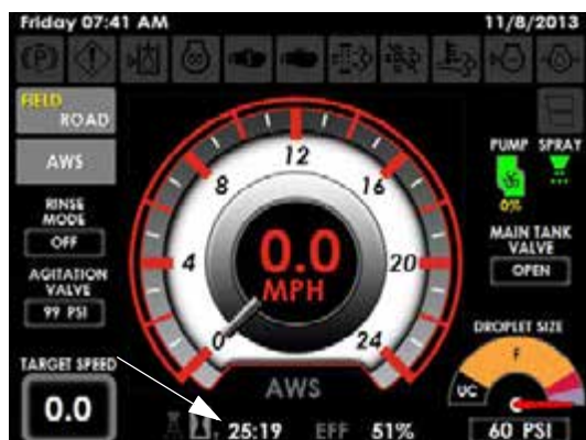
Indicator timp aplicare stropire (amplasat pe Pagina inițială - modul Câmp)
