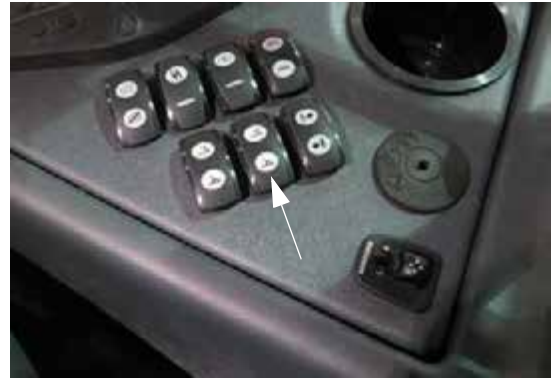
Comutator de extensie braț - „Acționare braț” (amplasat pe consola laterală) - Vedere tipică
