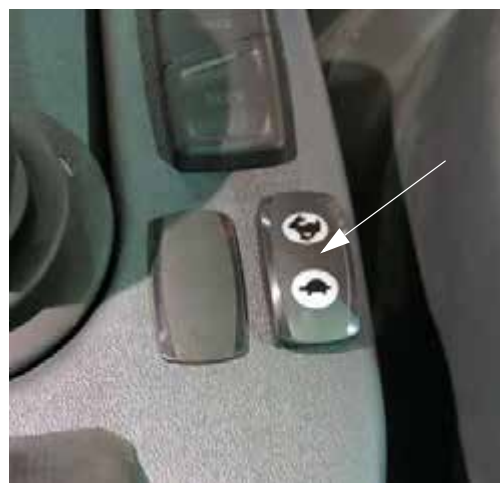
Comutator Accelerație (amplasat lângă maneta de comandă a transmisiei hidrostactice) - Vedere tipică
