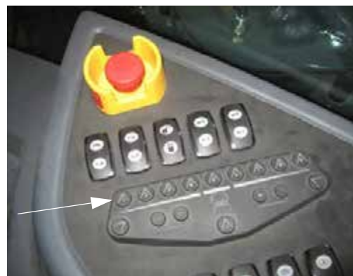
Comutatoare supape de soluție de pe brațe (amplasate pe consola laterală) - Vedere tipică
