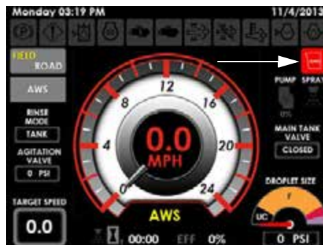
Indicator Presiune aer insuficientă în cabină (amplasat pe Pagina inițială a afișajului utilajului - modul Drum sau Câmp)
