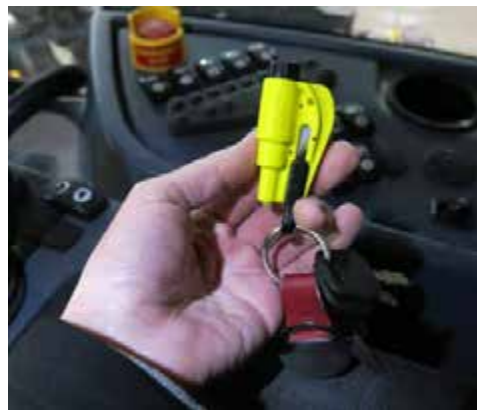
Instrument pentru ieșire de urgență (amplasat pe inelul de chei) - Vedere tipică
