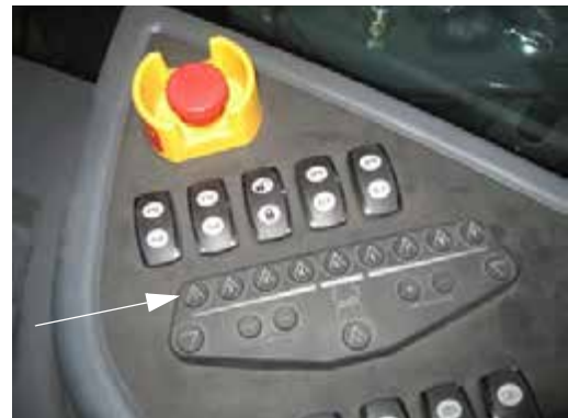
Comutatoare supapă de soluție braț (amplasate pe consola laterală) -Vedere tipică
