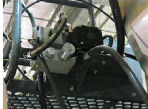
Pompă aparat de curățat cu presiune (amplasată în spate pe partea dreaptă a utilajului) - Vedere tipică
