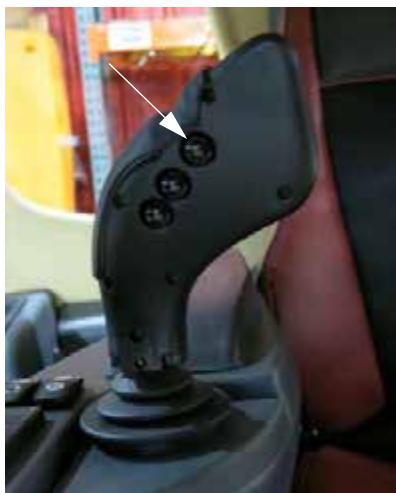
Comutatorul de comandă principal (amplasat pe partea din spate a manetei de comandă a transmisiei hidrostactice) - Vedere tipică
