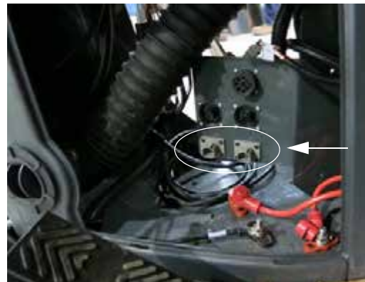
Conectori de alimentare cu 4 pini (2) (amplasați în interiorul consolei laterale - demontați panoul frontal pentru acces) - Vedere tipică
