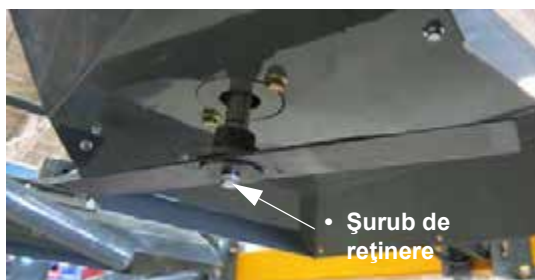
Ansamblu lamă de tăiere (montat pe partea de jos a capului de tăiere) - Vedere tipică
