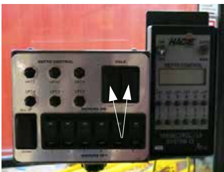
Comutatoare de pliere stânga/dreapta (amplasate pe panoul de comandă pentru castrarea porumbului) - Vedere tipică
