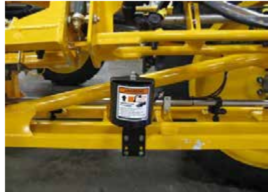
Garnitură de burete sensor Norac (amplasată pe fiecare sensor Norac) - Vedere tipică
