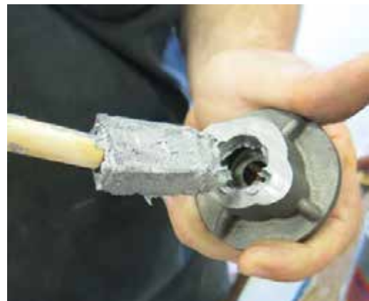
Aplicarea lubrifianțului antigripant - Vedere tipică
