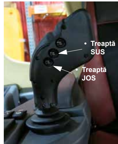
Comutatoare schimbare într-o treaptă superioară/inferioară (amplasate pe partea din spate a manetei de comandă a transmisiei hidrostatice) - Vedere tipică
