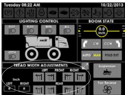
Indicatoare/butoane de reglare a lățimii benzii de rulare (amplasate pe pagina Comenzi auxiliare)
