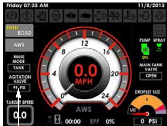
Indicator de presiune a supapei de agitare (amplasat pe Pagina inițială a afișajului utilajului - modul Câmp)
