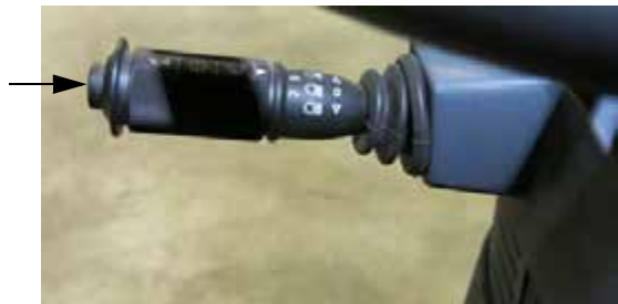
Buton claxon (amplasat la capătul manetei de semnalizare) - Vedere tipică
