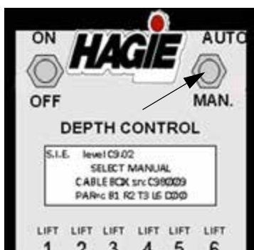
Comutator Auto/Man (pe panoul de comandă Tasseltról)
