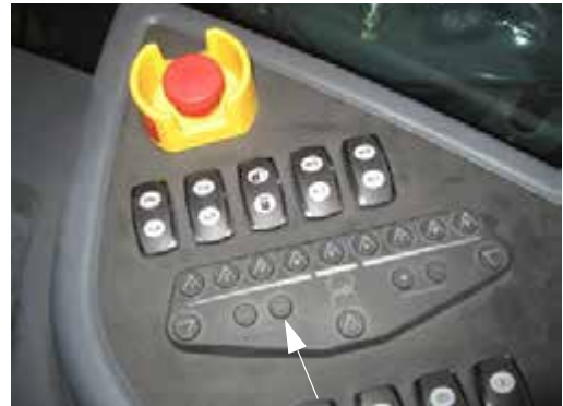
Comutatorul de control al debitului „MAN” (manual) (amplasat pe consola laterală) - Vedere tipică
