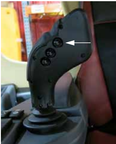
Comutator pulverizator principal (amplasat pe partea din spate a manetei de comandă a transmisiei hidrostatice) - Vedere tipică
