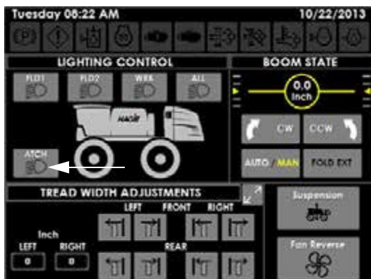
Buton pentru luminile atașamentului (amplasat pe pagina Comenzi auxiliare)
