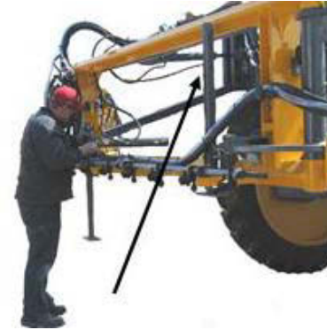
Suport braț în poziție de deplasare - Vedere tipică
