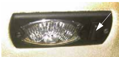
Comutator lampă interioară de lucru - Vedere tipică
