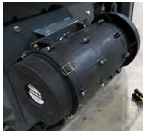
Sistem de filtrare al cabinei (amplasat pe partea dreaptă, în exteriorul cabinei) - Vedere tipică
