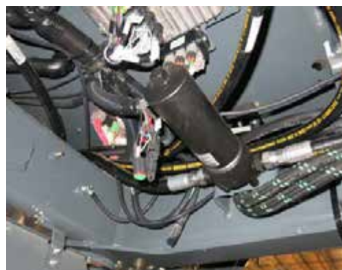
Filtru de presiune (amplasat pe partea dreaptă a utilajului - coborâți scutul metalic pentru accesare) - Vedere tipică
