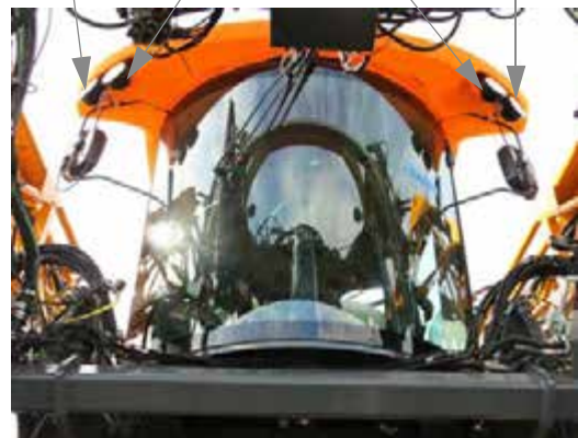
Lumini de câmp (amplasate pe partea din față a cabinei) - Vedere tipică
