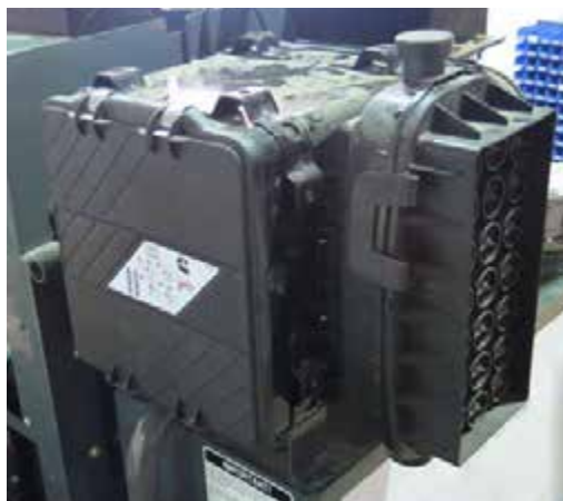
Filtrul pentru aerul de admisie al motorului (amplasat de-a lungul punții de acces pe partea stângă a utilajului - deschideți capota pentru acces) - Vedere tipică
