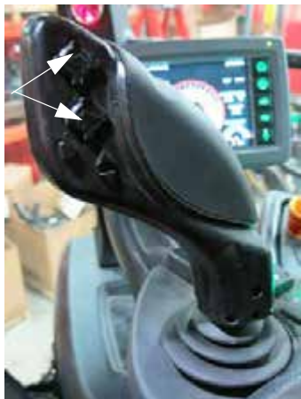
Comutatoare brațe stânga și din dreapta (amplasate pe maneta de comandă a transmisiei hidrostatice) - Vedere tipică
