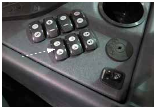
Comutator de extensie braț * Brațe de stropit de 90° (Pe consola laterală) - Vedere tipică
