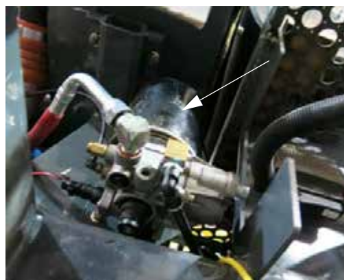
Uscătorul de aer (amplasat sub partea dreaptă a utilajului) - Vedere tipică
