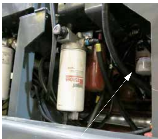
Filtrul de ulei de motor (amplasat în partea stângă a utilajului) - Vedere tipică
