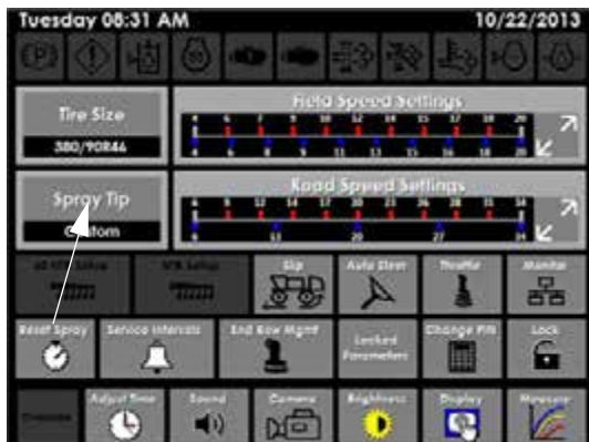
Buton Vârf de pulverizare (amplasat pe pagina Setări)
