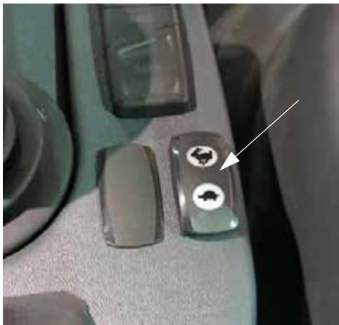
Comutator Accelație (amplasat lângă maneta de comandă a transmisiei hidrostatice) - Vedere tipică
