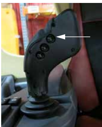
Comutator Pulverizator principal (amplasat pe partea din spate a manetei de comandă a transmisiei hidrostactice) - Vedere tipică
