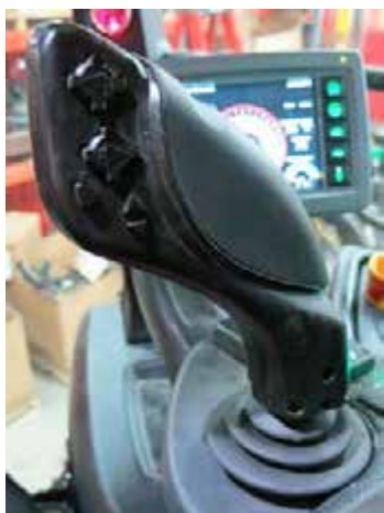
Manetă de comandă transmisie hidrostatică (amplasată pe consola laterală) - Vedere tipică
