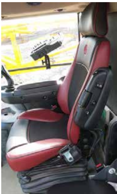
Comutator de detectare a prezenței operatorului (amplasat în interiorul scaunului operatorului) - Vedere tipică
