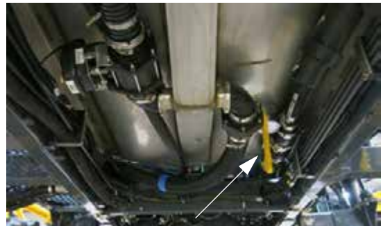
Supapă colector (amplasată sub rezervorul de soluție pe partea dreaptă a utilajului) - Vedere tipică
