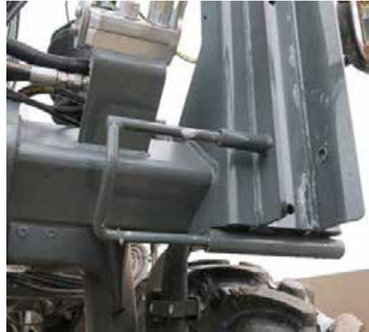
Știft de blocare (amplasat pe partea din stânga și dreapta față a utilajului) - Vedere tipică
