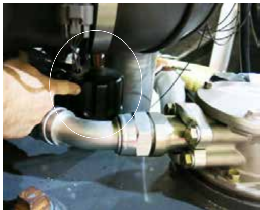
Capac supapă de aerisire (amplasat pe partea stângă a utilajului - lângă carcasa filtrului de retur) - Vedere tipică
