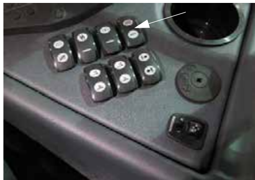
Переключатель системы промывки (расположен на боковой панели) - Стандартный вид
