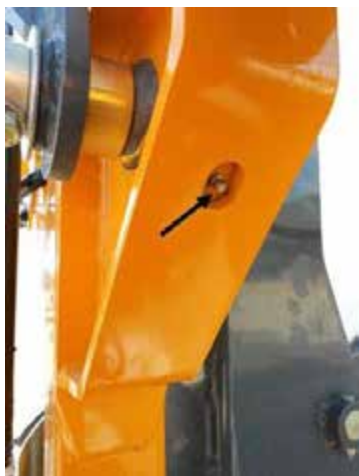
Шаровые соединения поворотной поперечины - стандартный вид
