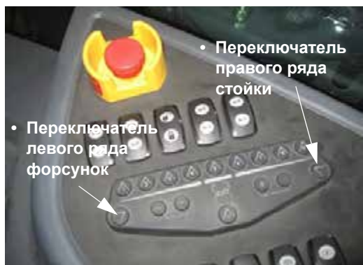
Переключатели ряда форсунок - левого и правого (расположен на боковой панели) - стандартный вид
