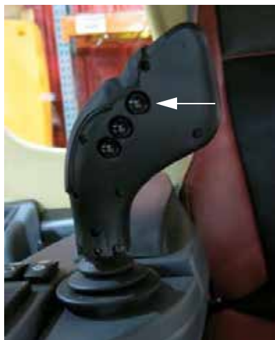
Главный выключатель опрыскивателя (расположен сзади Рукоятки управления гидростатической передачей) - Стандартный вид
