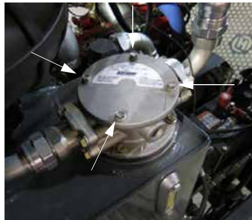
Корпус обратного фильтра (расположен с левой стороны машины рядом с гидробаком) - стандартный вид
