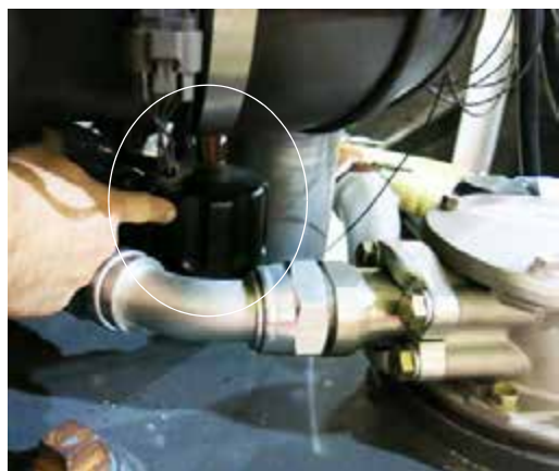
Крышка сапуна (расположена с левой стороны машины возле корпуса обратного фильтра) - стандартный вид
