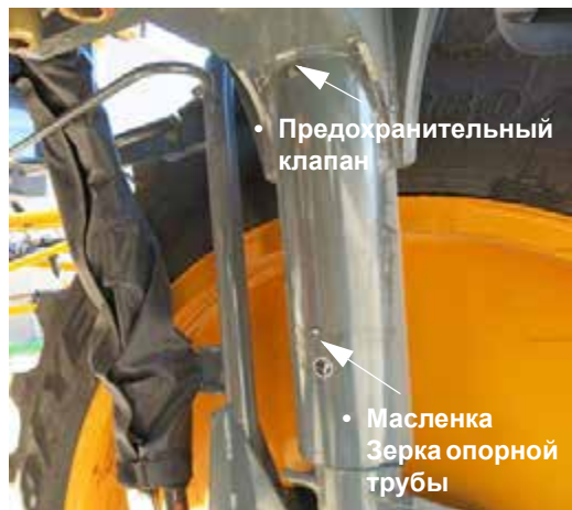
Масленка Зерка опорной трубы и Предохранительный клапан (расположен на передней и задней опорах) - стандартный вид
