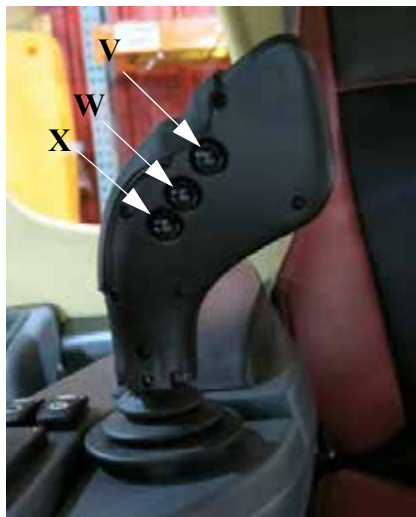
Рукоятка управления гидростатической передачей Вид сзади - Стандартный вид
