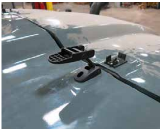
Защелка капота (2) (расположен с обеих сторон верхнего капота) - стандартный вид
