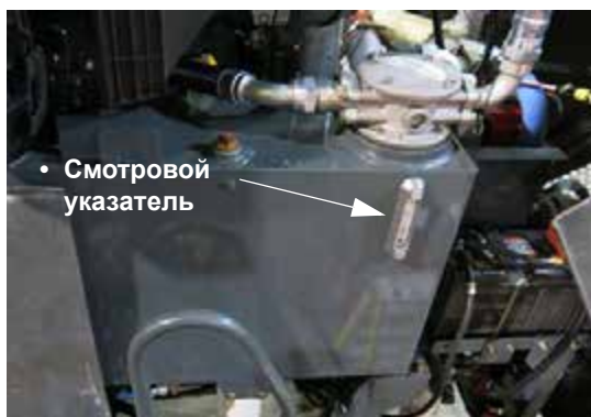
Гидробак (расположен на левой стороне машины, откройте капот для доступа) - стандартный вид
