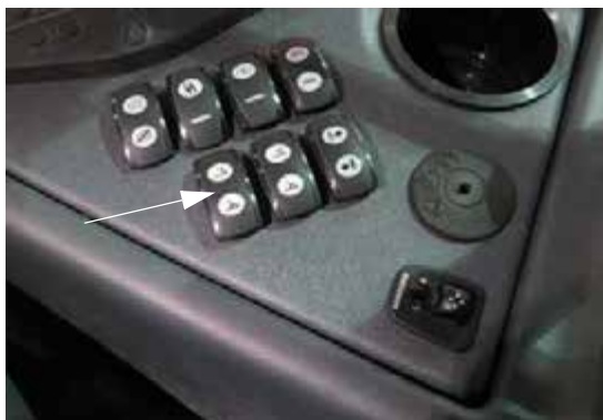
Переключатель выдвижения штанги * Штанги опрыскивателя дл. 90 футов (расположен на боковой панели) - стандартный вид
