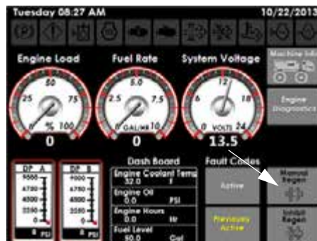
Кнопка ручной регенерации (расположен внизу страницы диагностики машины)
