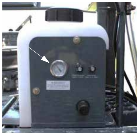
Манометр пены (расположен на стороне Бака индикатора пены, установленного с правой стороны машины) - стандартный вид
