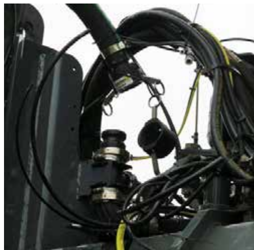
Подключение подачи раствора (на передней правой стороне машины) - стандартный вид
