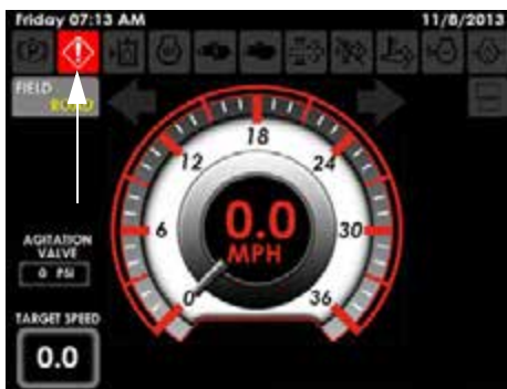
Индикатор световой сигнализации (находится в левой верхней части дисплея машины)
