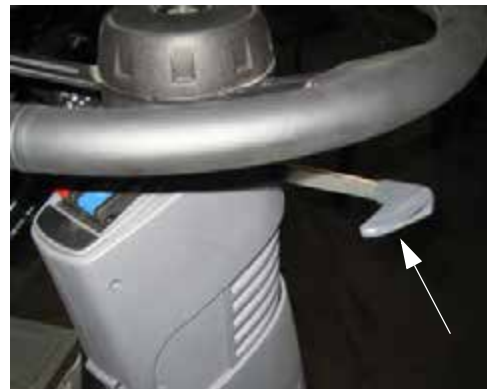
Рукоятка регулировки телескопического рулевого колеса (находящаяся справа на рулевой колонке) - Стандартный вид
