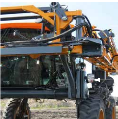
Сигнальные лампы поворотов и аварийных сигналов (расположены спереди и сзади машины, а также на ее крыше) - Стандартный вид
