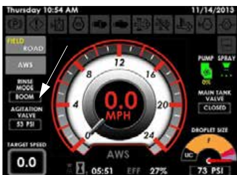
Индикатор режима промывки (на Главной странице дисплея машины – Полевой режим)
