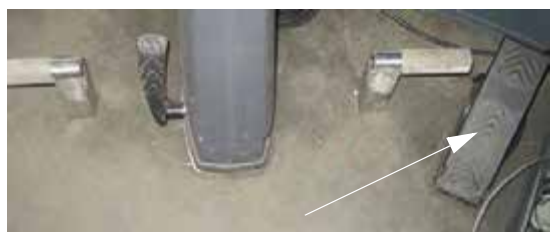
Педаль уменьшения скорости (расположена в правой нижней части рулевой колонки) - Стандартный вид
