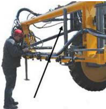
Опора для штанги в Ходовом положении - стандартный вид
