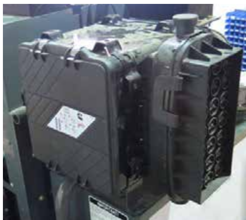
Фильтр впуска воздуха в двигатель (расположен вдоль лестницы снаружи с левой стороны машины - откройте капот для доступа) - стандартный вид
