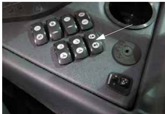
Переключатель индикатора пены (на боковой панели) - стандартный вид
