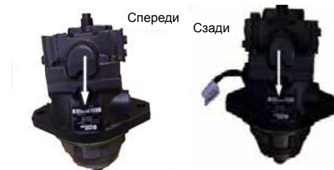
Идентификационные таблички колесного гидромотора - стандартный вид
