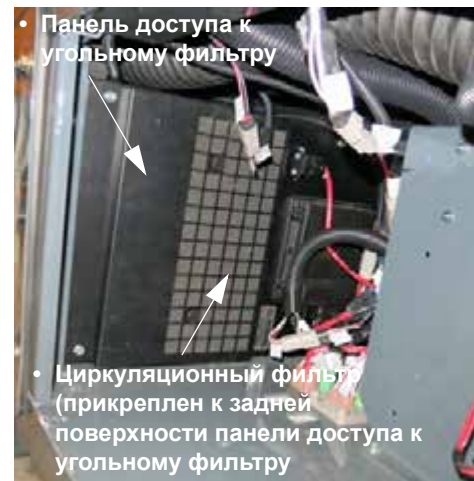
Панель доступа к угольному фильтру (расположен за эксплуатационной панелью наружной обшивки с правой стороны кабины) - Стандартный вид
