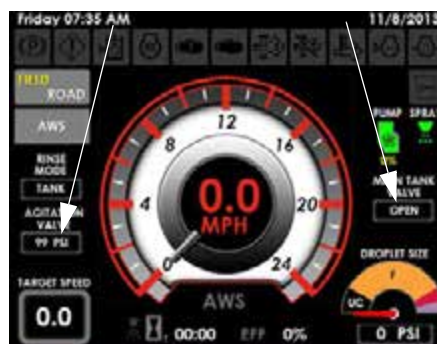
Индикаторы состояния главного бака и давления в клапане перемешивания (на Главной странице дисплея машины – Полевой режим)
