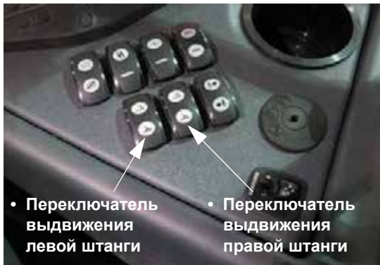
Переключатели выдвижения левой и правой штанг (расположен на боковой панели) - стандартный вид
