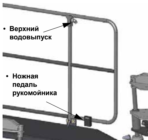
Верхний водовыпуск/Ножная педаль рукомытника (расположен вдоль поручня с левой стороны машины) - стандартный вид
