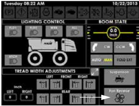
Кнопка реверсивного вентилятора (на Странице вспомогательных органов управления)
