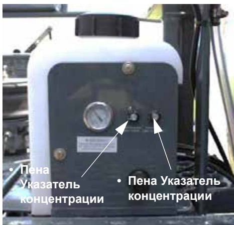
Указатели частоты подачи и концентрации пены (на стороне Бака индикатора пены) - стандартный вид
