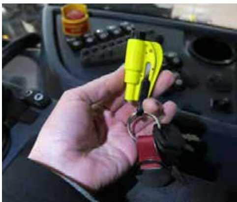
Инструмент запасного выхода (находится на кольце для ключей) - стандартный вид
