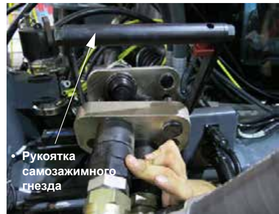
Узел комбинированной гидравлической муфты (показана правая сторона машины) - стандартный вид
