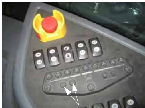
Переключатели регулирования скорости (расположены на боковой панели) - стандартный вид
