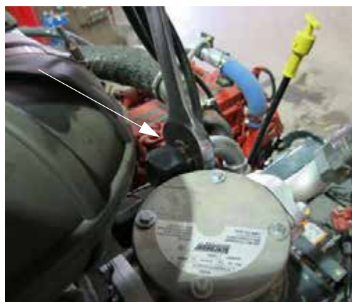
Сливной шланг картера (расположен рядом с верхней частью гидробака) - стандартный вид
