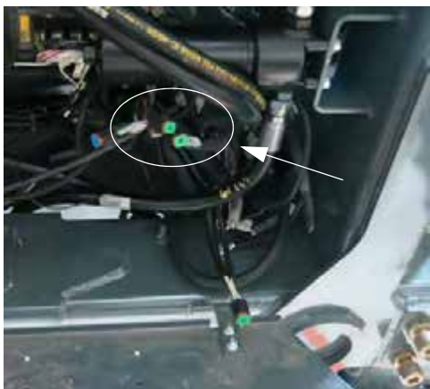
Входные соединения видеокамеры (расположены под кабиной, снимите переднюю панель для получения доступа) - стандартный вид
