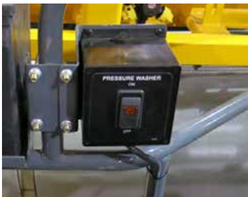
Выключатель мойки под давлением (расположен вдоль перил на левой стороне машины) - стандартный вид
