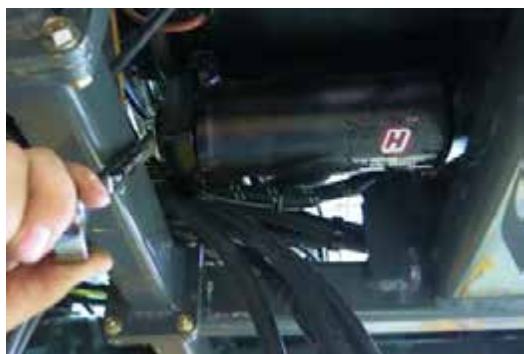
Фильтр нагнетательного насоса (расположен под насосом привода) - стандартный вид
