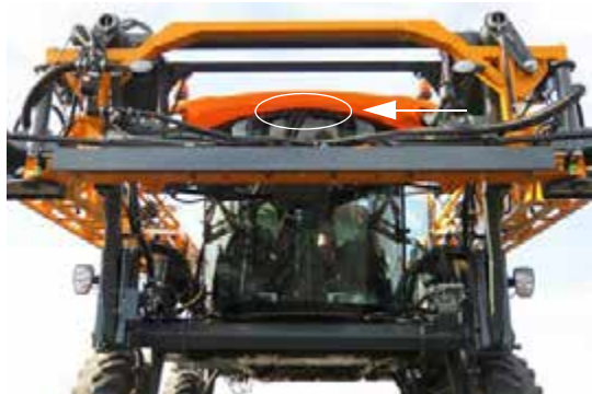
Спринклер жидкости омывателя ветрового стекла (расположен возле верха снаружи кабины) - стандартный вид
