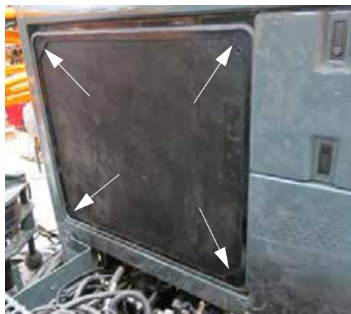
Защелки жалюзи радиатора (расположены на каждом углу жалюзи) - стандартный вид
