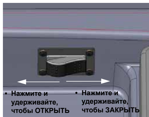
Переключатель капота (расположен перед задним капотом над жалюзи радиатора) - стандартный вид
