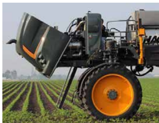
Задний капот (показано открытое положение) - стандартный вид
