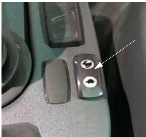
Переключатель дроссельной заслонки (расположен возле Рукоятки управления гидростатической передачей) - стандартный вид
