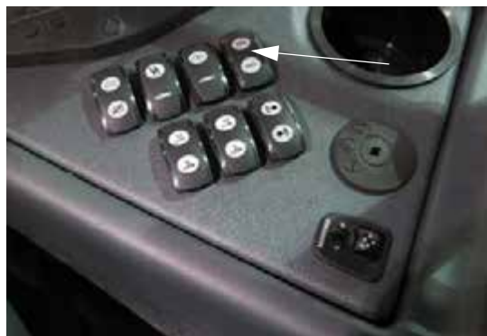
Переключатель системы промывания (на боковой панели) - стандартный вид
