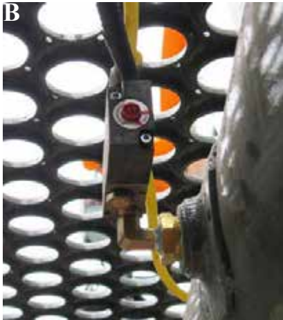
В Управляющий клапан (возле ресивера) - стандартный вид
