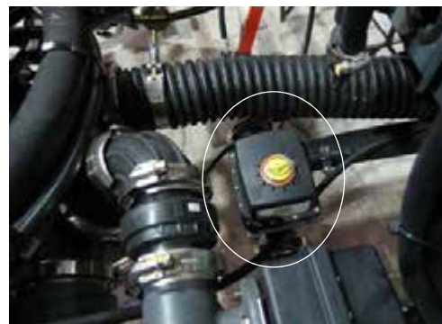
Клапан перемешивания (расположен рядом с центром машины) - стандартный вид
