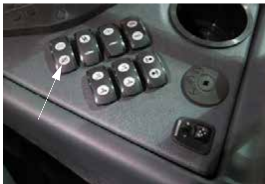
Переключатель клапана главного бака (расположен на боковой панели) - стандартный вид
