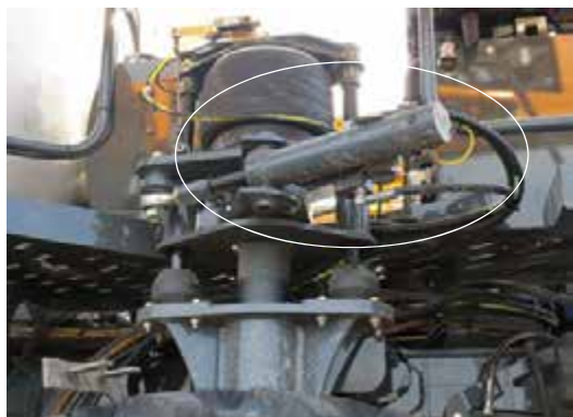
Цилиндр рулевого управления (расположен на задней стойке) - стандартный вид
