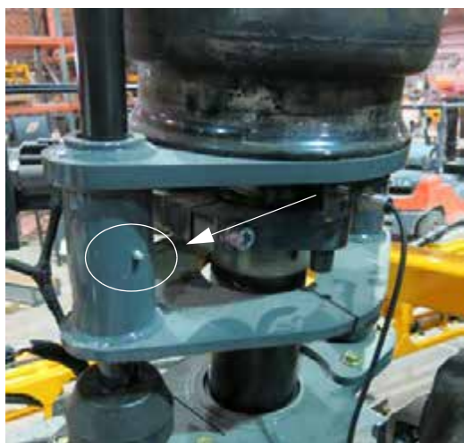
Масленка Зерка опорного подшипника (расположен на передней и задней опорах) - стандартный вид
