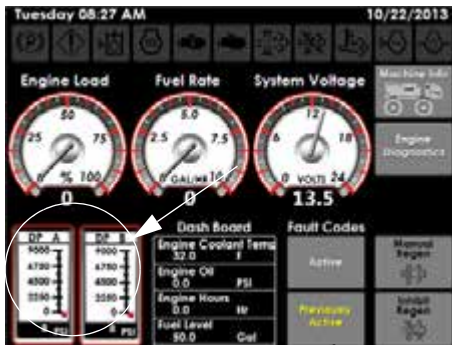
Измерительные приборы приводов насоса, порты A/B (расположены в нижней левой части страницы диагностики машины)
