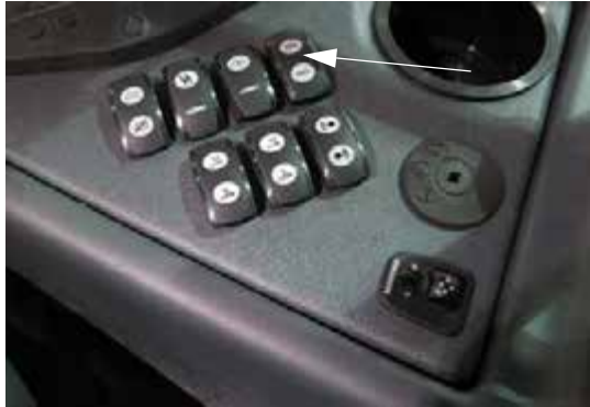
Переключатель промывки (на боковой панели) – стандартный вид
