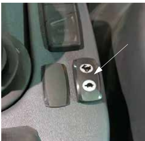
Переключатель дроссельной заслонки (находится рядом с рукояткой управления гидростатической передачей) - Стандартный вид
