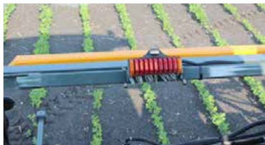
Индикаторы клапана для раствора штанги (расположены на поперечине) - стандартный вид
