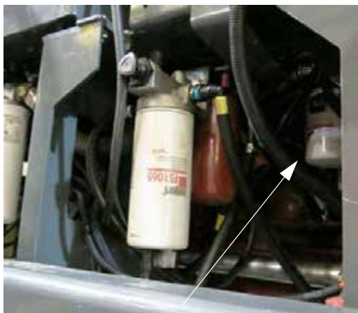
Масляный фильтр двигателя (расположен вдоль левой стороны машины) - стандартный вид
