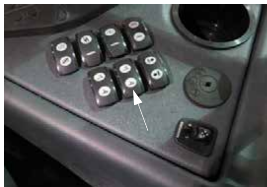
Переключатель выдвижения штанги - “Сгибание штанги” (расположен на боковой панели) - стандартный вид
