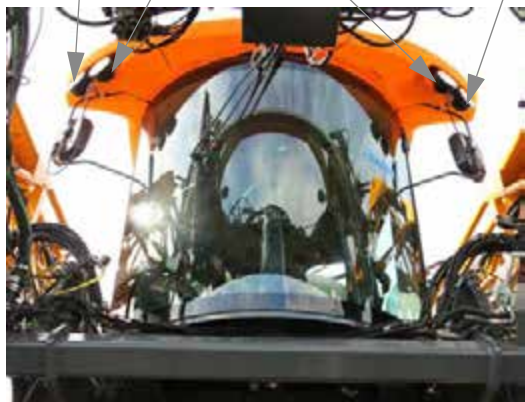
Полевые фонари (расположены спереди кабины) - Стандартный вид
