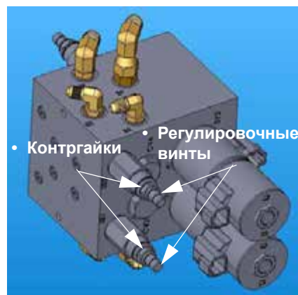
Контргайки/Регулировочные винты (расположены на Клапанном блоке) - стандартный вид
