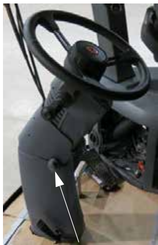
Кнопка регулировки угла наклона рулевой колонки (находящаяся слева на рулевой колонке) - Стандартный вид
