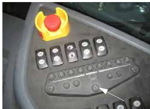
Переключатель задней форсунки (расположен на боковой панели) - стандартный вид
