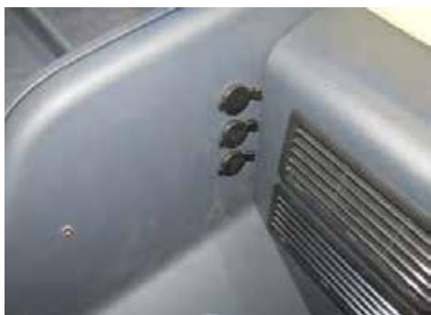
Силовые гнезда (12 В) - стандартная установка гнезд
