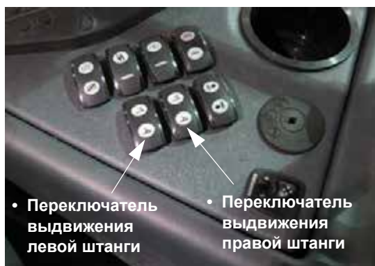
Переключатели выдвигания левой и правой штанг (расположен на боковой панели) - стандартный вид
