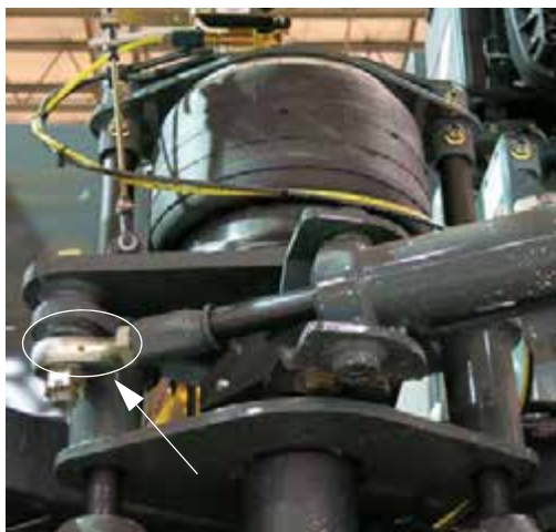
Масленка Зерка шаровой опоры поперечной рулевой тяги (расположена на передней опоре) - стандартный вид
