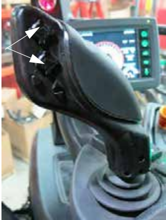
Переключатели левой и правой штанг (расположены на Рукоятке управления гидростатической передачей) - стандартный вид
