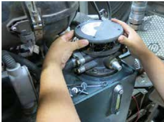
Заполнение через обратный жидкостный фильтр корпус фильтра - стандартный вид
