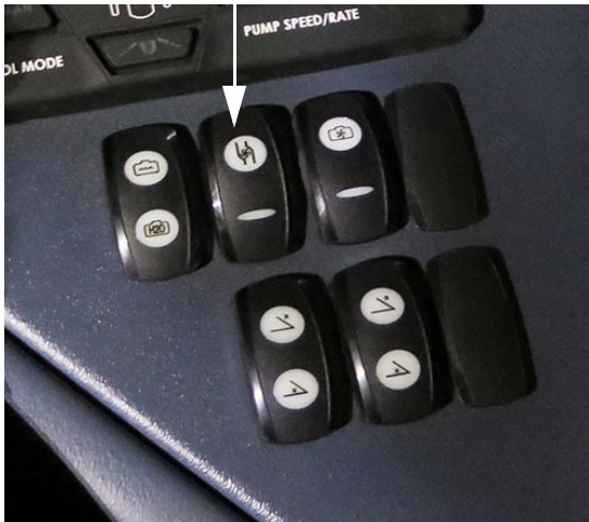
Tartály szivattyú kapcsoló (az oldalkonzolon) – Tipikus nézet
