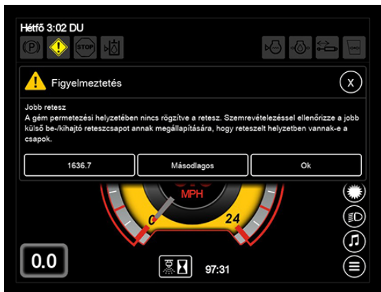
Külső gémtoldalék retesz „Nincs csatlakoztatva” hibaüzenet
