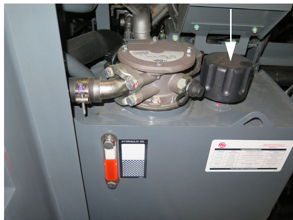
Légzősapka - STS10/STS12 (A hidraulika olaj tartály tetején található) – Tipikus nézet
