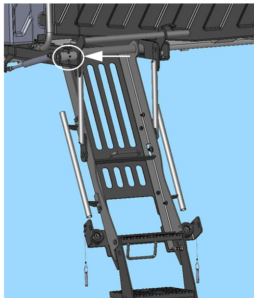
Gázrugó tengely zsírzószem (a létra bal felső részének közelében található) – Tipikus nézet
