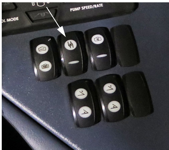
Permetlé oldat szivattyú kapcsolója (oldalsó vezérlőpulton) – Tipikus nézet
