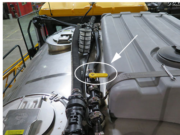
Kettős permetlé öblítő szelep (a permetlé tartály tetején)
