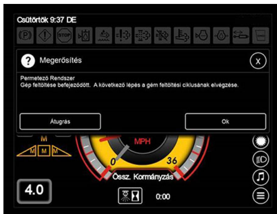
Gép légtelenítés elvégzésének megerősítése
