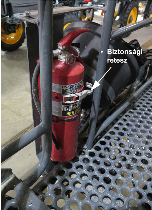
Tűzoltókészülék (a gép bal oldalán, az emelvény mellett található) – Tipikus nézet
