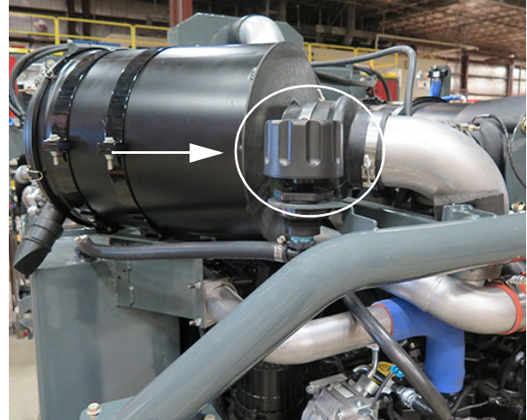
Légzősapka - STS14/STS16 (a munkagép bal hátsó részén, a levegőszűrő mögött található) – Tipikus nézet
