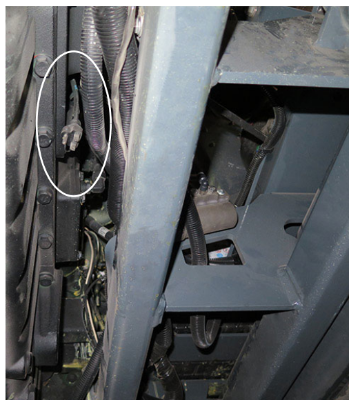
Motormelegítő tápkábel - ST514/ST516 (A munkagép alatt a motor jobb oldalánál található) – Tipikus nézet
