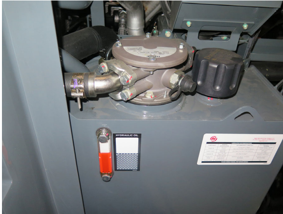
Hidraulika olaj tartály (a gép bal oldalánál van elhelyezve – a hozzáféréshez nyissa ki a motorháztetőt) – Tipikus nézet
