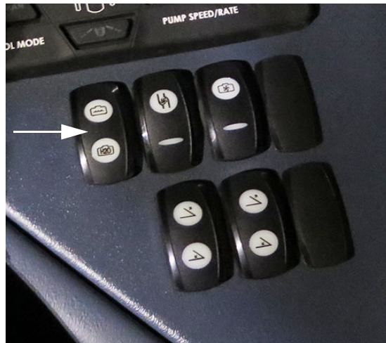
Tartály szelep választó kapcsoló (oldalkonzolon) – Tipikus nézet
