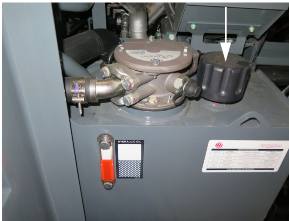
Légzősapka - STS10/STS12 (a hidraulika olaj tartály tetején helyezkedik el) – Tipikus nézet
