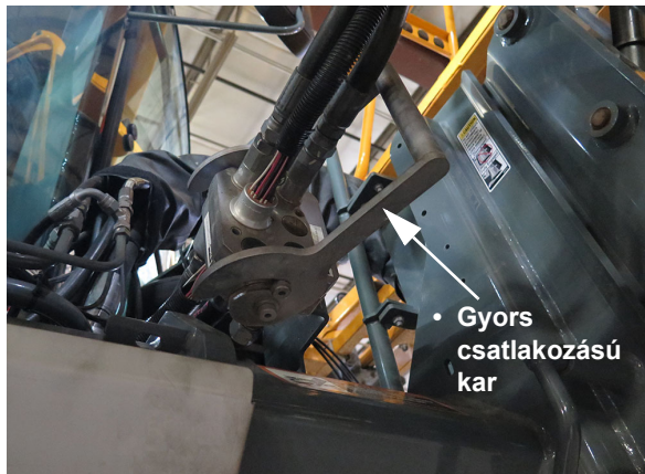
Hidraulikus/elektromos multi-csatlakozó összeszerelés - Ha fel van szerelve (el van látva) (a gép elülső, bal oldalánál helyezkedik el) – Tipikus Nézet
