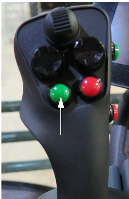
Elsődleges permetező kapcsoló (a hidrosztatikus vezérlést irányító karon) – Tipikus nézet
