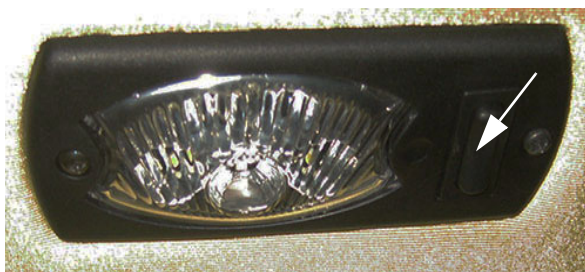
Belső munkalámpa kapcsoló – Tipikus nézet
