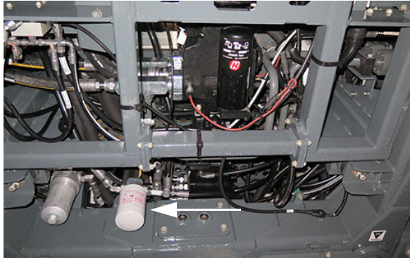
2. ház leeresztő szűrő (a munkagép bal oldalán, a motorváz előtt található) – Tipikus nézet
