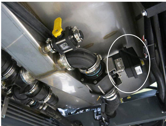
Permetlé tartály szelep (a gépezet alsó oldalán a permetlé tartály alatt) – Tipikus nézet
