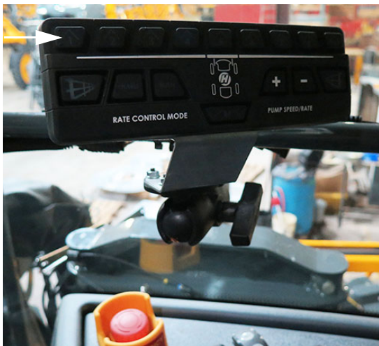
Gém permetlé szelep kapcsolók - Kettős permetlé billentyűblokk, 10-14 szakaszok
