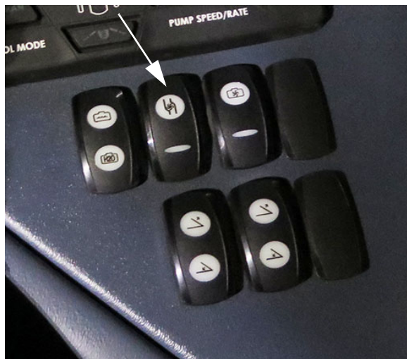
Permetlé Szivattyú Kapcsoló (oldalkonzolon) – Tipikus nézet
