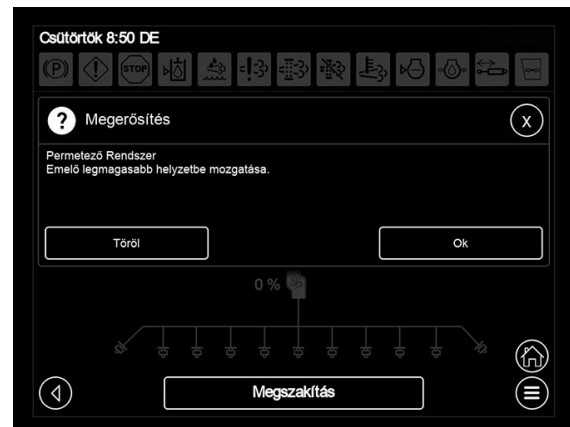
Központi emelő legmagasabb helyzetbe emelésének a megerősítése
