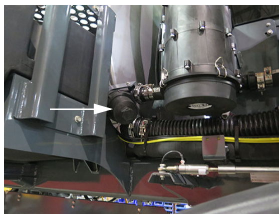
Permetezőszer csőhálózati szűrőszita - Másodlagos (a gépezet elülső jobb oldalának közelében) – Tipikus nézet
