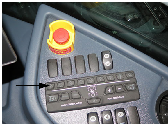
Gémmel permetlé szelep kapcsolók - Különálló permetlé mód, 1-9 szakaszok (oldalkonzolon) – Tipikus nézet
