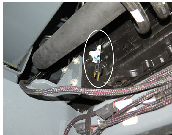
Motorblokk melegítő tápkábel - ST510/ST512 (a munkagép bal oldalán, a motor alatt található) – Tipikus nézet
