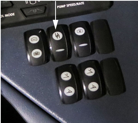
Permetlé szivattyú kapcsoló - Elsődleges (oldalkonzolon) – Tipikus nézet
