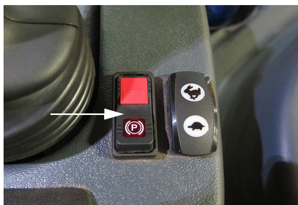
Rögzítőfék (parkolófék) kapcsoló (a hidrosztatikus vezérlést irányító kar közelében) - Tipikus nézet
