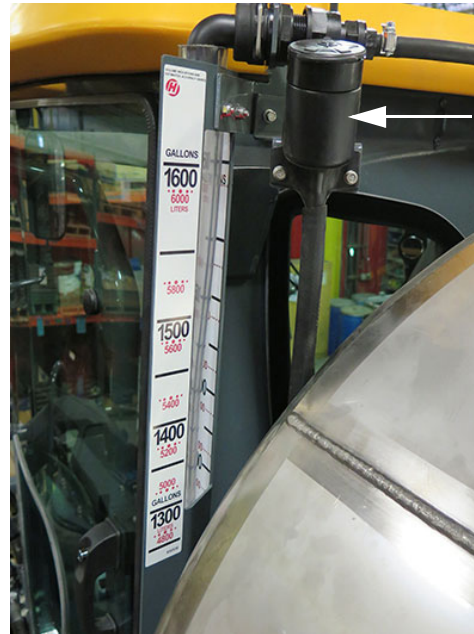
Szélvédő mosó folyadék tartály (a vezetőfülke mögött, bal kéz felől helyezkedik el) – Tipikus nézet
