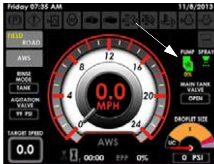
Permetlé szivattyú kijelző (a gépezet kijelzőjének kezdő oldalán a felső, jobb kéz felőli oldalt – Mezei üzemmód)
