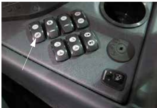
Főtartály szelep kapcsoló (oldalsó vezérlőpulton) – Tipikus nézet
