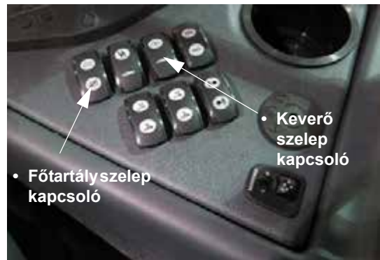
Főtartály és keverőszelep kapcsolók (oldalsó vezérlőpulton) – Tipikus nézet
