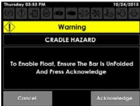
Úszó figyelmeztető üzenet (csak 60' NTB)
