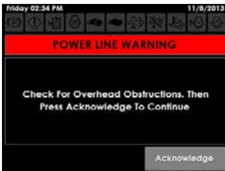
Elektromos vezeték figyelmeztető üzenet (munkagép képernyőjén található)
