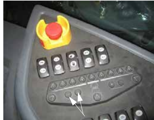
Mérték szabályzó kapcsolók (oldalsó vezérlőpulton) – Tipikus nézet
