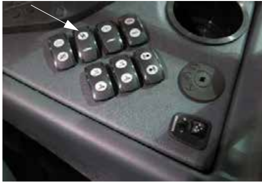
Permetlé szivattyú kapcsoló (oldalsó vezérlőpulton) – Tipikus nézet
