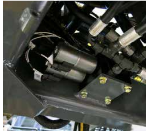
Elosztószelep (a gép alján) – Tipikus nézet
