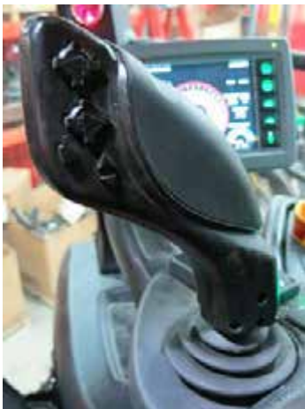
Hidrosztatikus hajtás vezérlőkarja (oldalsó vezérlőpulton) – Tipikus nézet
