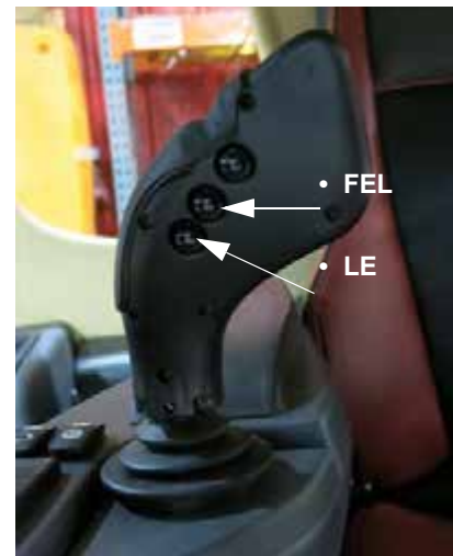
Fel/le váltás kapcsolók (a hidrosztatikus hajtás vezérlőkarjának hátsó oldalán) – Tipikus nézet
