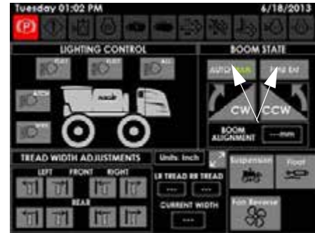
Behajtás vezérlő gombok (CW/CCW) (a munkagép képernyőjének Segédvezérlések oldalán)
