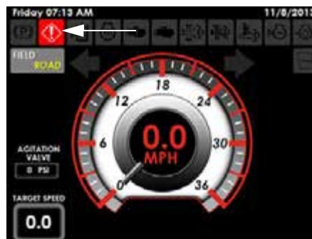
Figyelmeztető fényjelzés (a gép kijelzőjének minden egyes oldalán, a bal felső részen)
