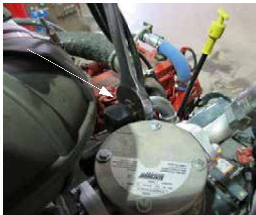
Ház leeresztő tömlő (a hidraulikus tartály tetejének közelében helyezkedik el) – Tipikus nézet
