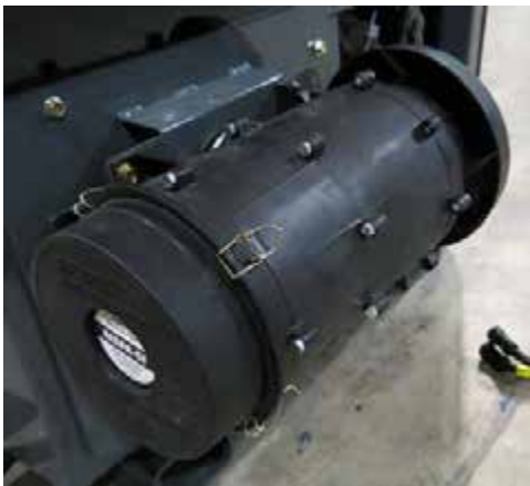
Fülke szűrőrendszer (a fülke külsejének jobb oldalán) – Tipikus nézet
