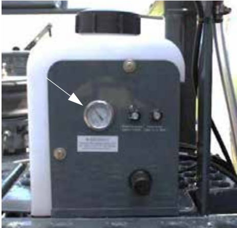
Hab nyomás beállító készülék (a habzás jelző tartály oldalánál van, a gép jobb oldalán van elhelyezve) – Tipikus nézet
