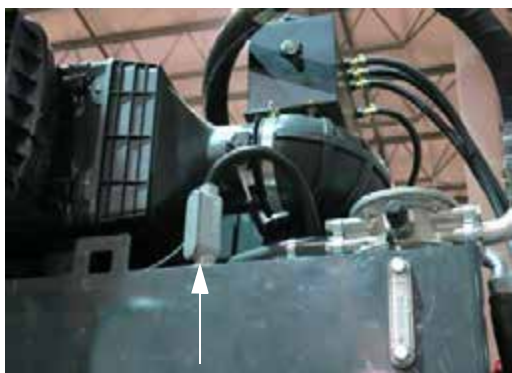
Szint/Hőm. érzékelő (a hidraulikaolaj tartály mellett) – Tipikus nézet
