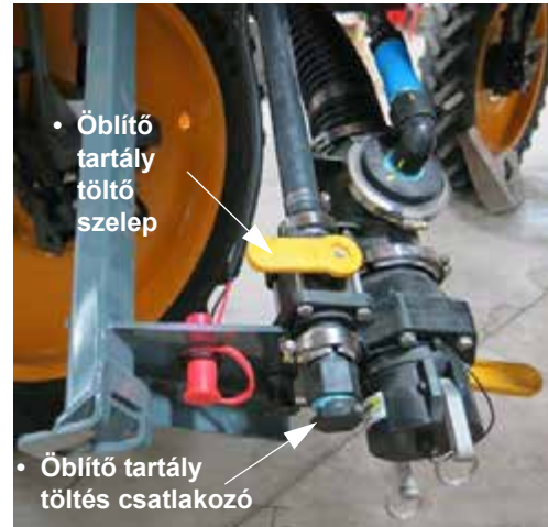
Elülső töltő összeszerelés (lentebbi pozíció látható) – Tipikus nézet
