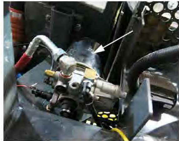
Dessiccateur d'air (situé en dessous de la plate-forme, du côté droit de la machine) - Vue typique
