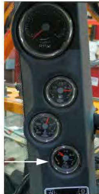
Jauge d'AUS 32 (située sur le montant A) - Vue typique
