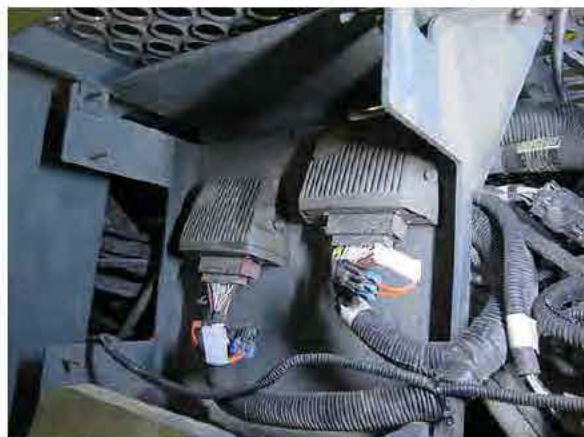
Fusibles d'alimentation des capteurs arrière (situés sous la machine près de la roue arrière droite) - Vue typique
