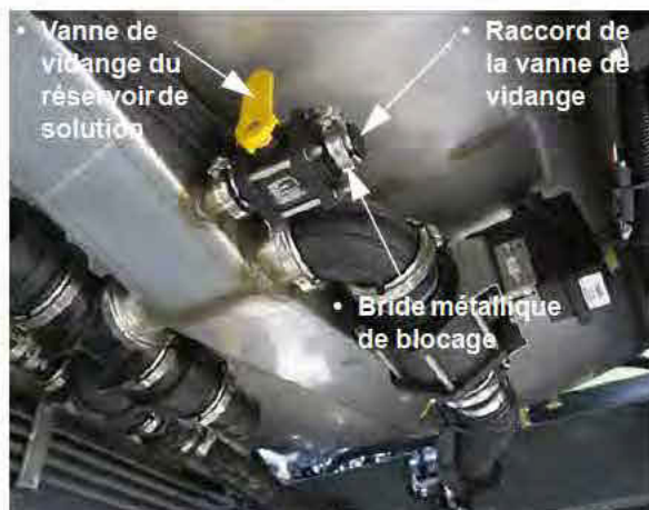
Ensemble de la vanne de vidange du réservoir de solution (situé sous le réservoir de solution sur le dessus de la machine) - Vue typique
