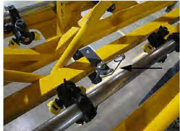
Goupille de verrouillage pour le transport (illustrée en position « Transport ») - Vue typique
