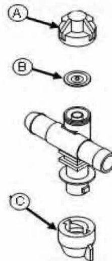
Diaphragmes et embouts de pulvérisation des buses - Vue typique
