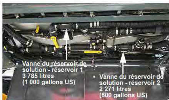
Vannes des réservoirs de solution - réservoirs 1 et 2 (situées sous le réservoir de solution sur le dessous de la machine) - Vue typique
