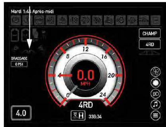
Voyant Buses arrière (situé sur la page d'accueil de l'afficheur de la machine - mode Champ)
