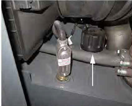
Bouchon de reniflard (situé sur le dessus du réservoir d'huile hydraulique) - Vue typique
