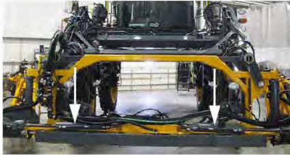
Vérins principaux de pivotement/décrochage - Vue typique
