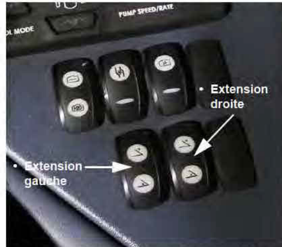
Commutateurs des extensions de la rampe - gauche/droit (situés sur la console latérale) - Vue typique
