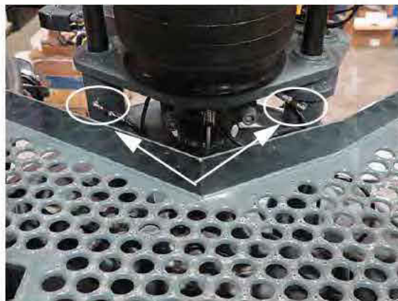
Embout de graissage des roulements d'élévation (8) (situés sur les jambes avant et arrière) - Vue typique
