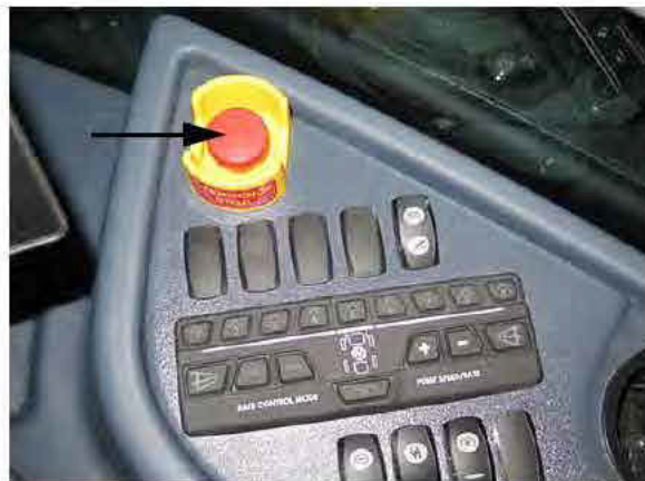
Bouton d'arrêt d'urgence (situé sur la console latérale) - Vue typique
