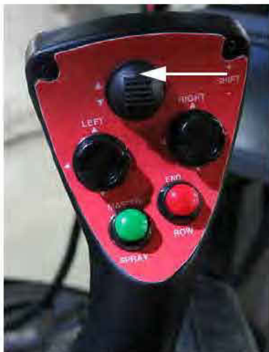
Interrupteur de la traverse - HAUT (situé sur le levier de commande de l'entraînement hydrostatique) - Vue typique
