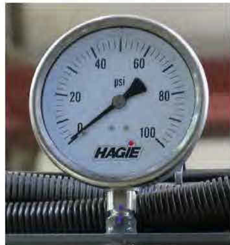
Jauge de pression (montée sur la rampe) - Vue typique
