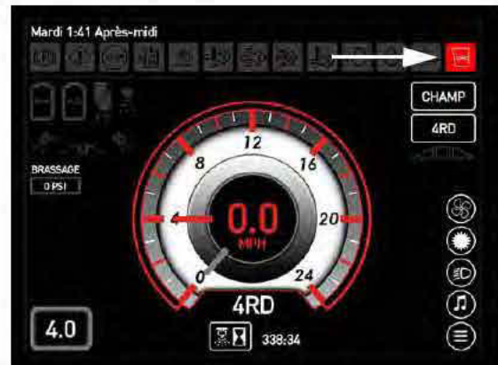
Témoin de pression insuffisante de l'air dans la cabine (situé sur la page d'accueil de l'afficheur de la machine - Mode Route ou mode Champ)
