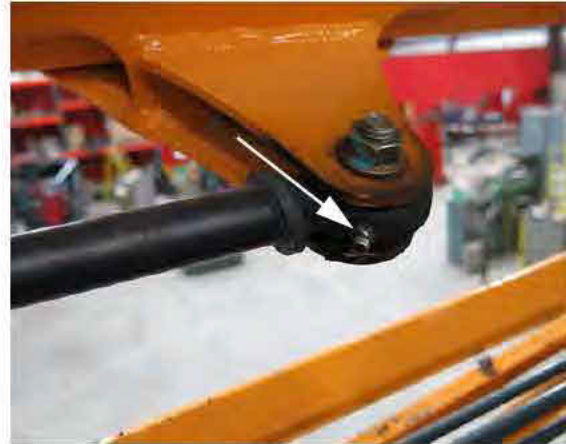
Extrémité de la tige du vérin de décrochage de la rampe - Vue typique
