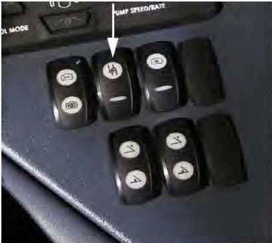
Interrupteur de la pompe à solution (situé sur la console latérale) - Vue typique
