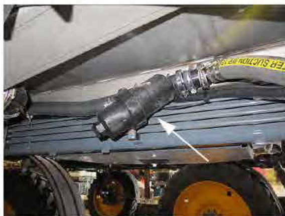
Crépine de la conduite de solution (située en dessous de la partie centrale, du côté droit de la machine) - Vue typique
