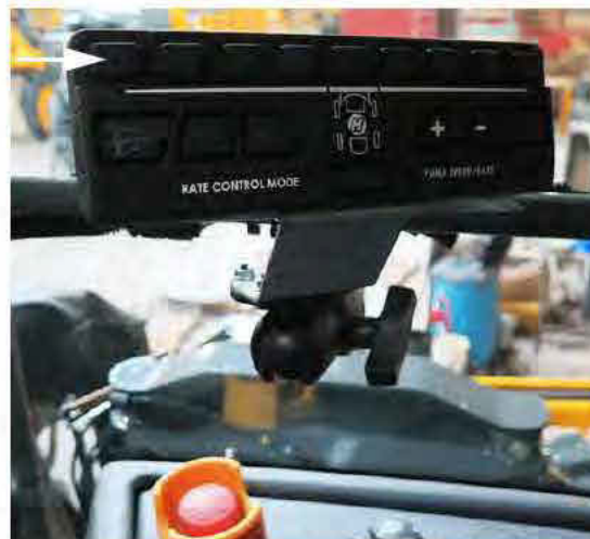
Interrupteurs des vannes de solution de la rampe - Pavé numérique de la section Deux produits, Sections 10 à 14 (monté près de la console latérale) - Vue typique
