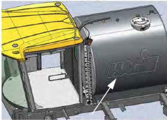
Réservoir de solution - Vue typique
