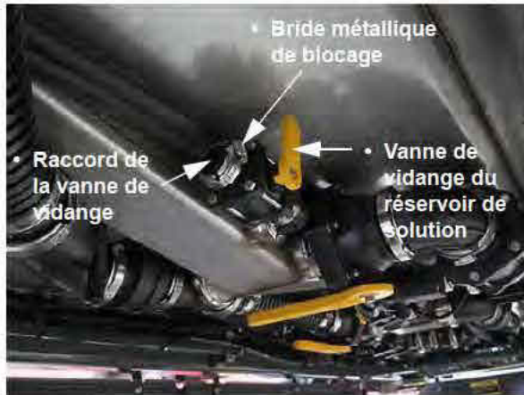
Dispositif de la vanne de vidange du réservoir de solution (situé sous le réservoir de solution sur le dessous de la machine) - Vue typique
