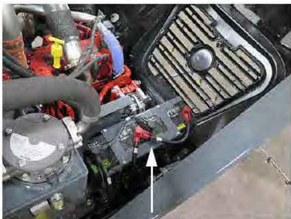
Accès à la batterie (située dans la partie arrière gauche De la machine - ouvrez le capot pour y accéder) - Vue typique
