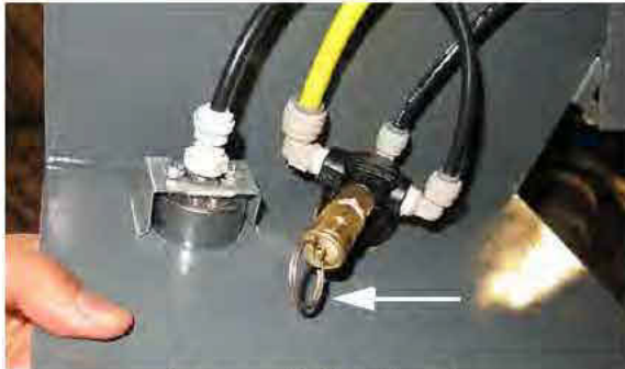
Anneau de traction de décharge de la pression (situé sur la partie arrière du régulateur de pression du mousseur) - Vue typique
