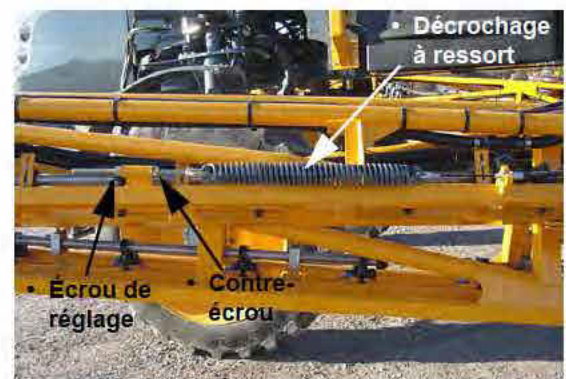
Contre-écrou et écrou de réglage du décrochage à ressort (situés près de l'extrémité extérieure du décrochage à ressort) - Vue typique
