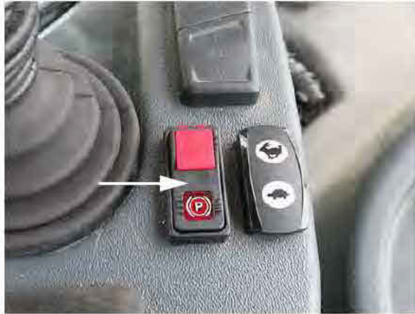
Interrupteur du frein de stationnement (situé près du levier de vitesse de la transmission hydrostatique) - Vue typique
