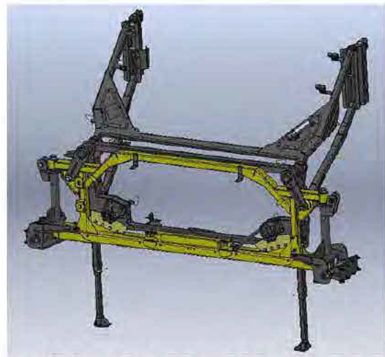
Chandelles de support de la rampe (rampe de 40 mètres) - Vue typique
