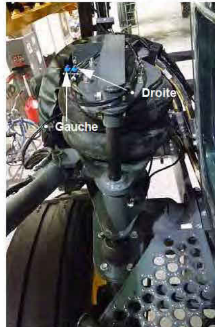
Vannes de la suspension pneumatique (situées sur le coussin d'air gauche avant) - Vue typique
