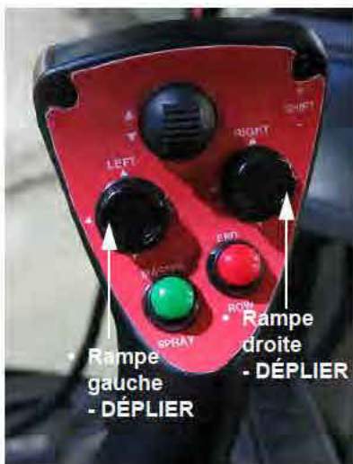
Commutateurs des rampes droite et gauche (situés sur le levier de commande de l'entraînement hydrostatique) - Vue typique
