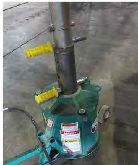
Installation des goupilles de blocage - Vue typique
