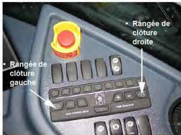
Commutateurs de rangée de clôture - Gauche/Droit (situés sur la console latérale) - Vue typique
