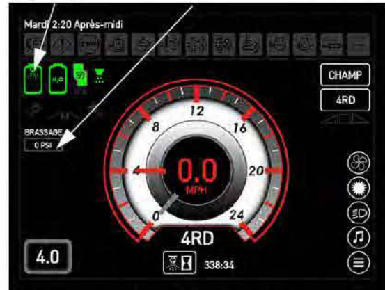
Indicateurs de pression de la vanne du réservoir principal et de la vanne de brassage (situés sur la page d'accueil de l'afficheur de la machine - mode Champ)
