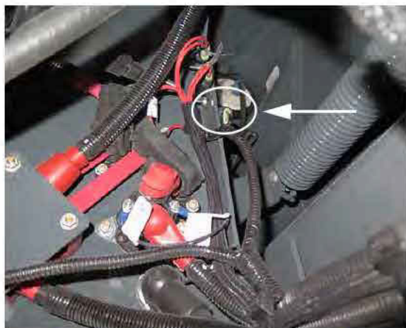
Fusible de l'actionneur du capot (situé en dessous de la partie arrière gauche de la machine) - Vue typique
