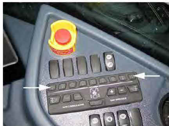
Interrupteurs des vannes de solution de la rampe - Sections 1 et 9 (situés sur la console latérale) - Vue typique
