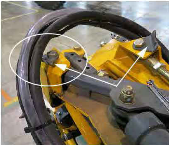
Supports d'acheminement des tuyaux flexibles (2) (situés près de l'extrémité des extensions extérieures de la rampe) - Vue typique
