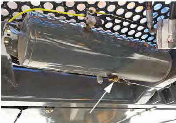
Vanne de vidange du réservoir (située en dessous de la plate-forme sur le côté gauche de la machine)
