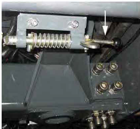
Levier de déblocage pour le remplissage par l'avant (situé sous la partie avant de la machine) - Vue typique
