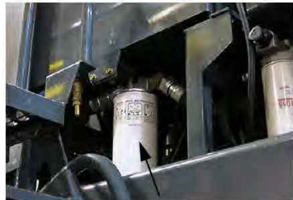
Filtre de retour au carter (situé sur le côté gauche de la machine) - Vue typique
