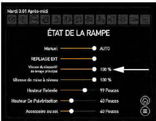
Vitesse du dispositif de levage principal (située sur l'écran État de la rampe)
