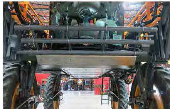
Installation du pare-broussailles - Vue typique
