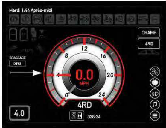
Compteur de vitesse (situé sur la page d'accueil de l'afficheur de la machine - Mode Route et mode Champ)
