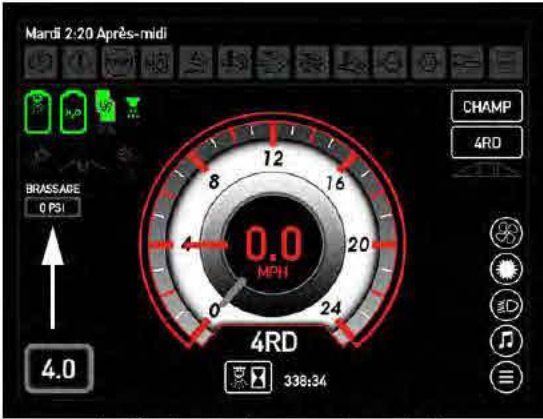
Indicateur de pression de la vanne de brassage (situé sur la page d'accueil de l'afficheur de la machine - mode Champ)
