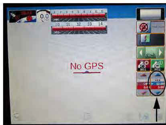
Touche Produit secondaire (située sur la console du système de pulvérisation) - Vue typique
