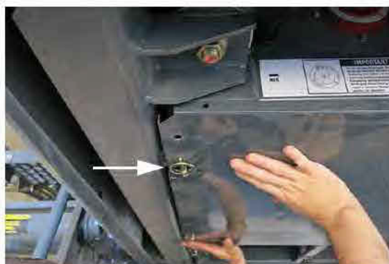
Goupille clip de sécurité (installée sur la goupille percée) - Vue typique
