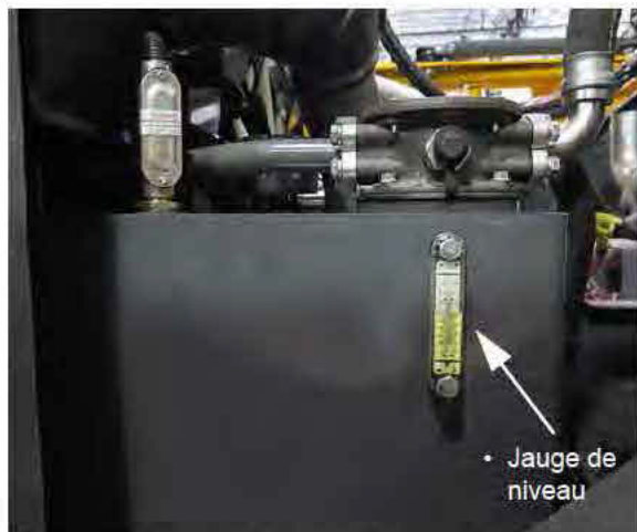
Réservoir d'huile hydraulique (situé sur le côté gauche de la machine - ouvrez le capot pour y accéder) - Vue typique
