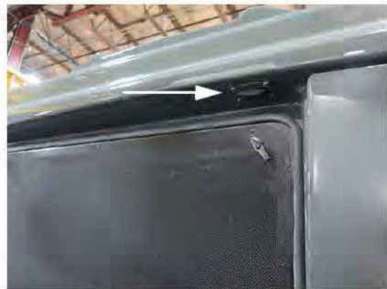
Bouton d'ouverture du capot (situé devant le capot arrière, au-dessus de la calandre) - Vue typique
