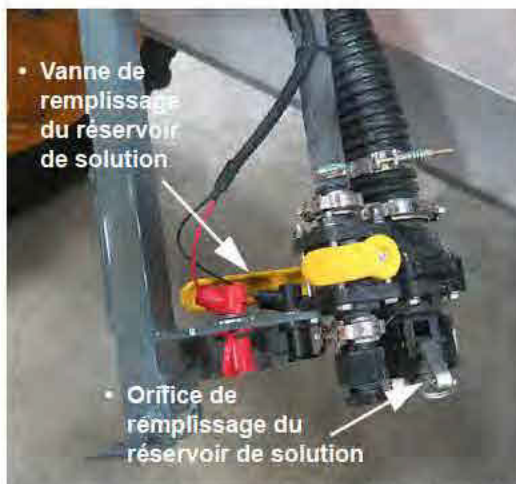
Dispositif de remplissage par l'avant (illustré en position abaissée) - Vue typique
