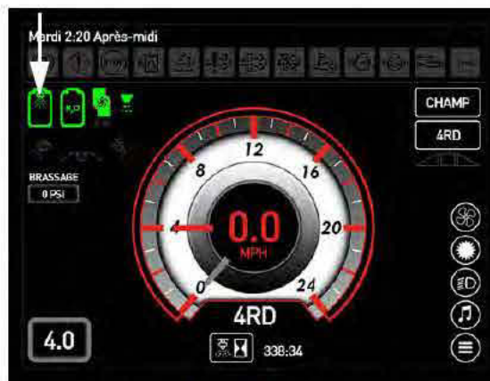
Voyant d'état de la vanne du réservoir principal (situé sur la page d'accueil de l'afficheur de la machine - mode Champ)
