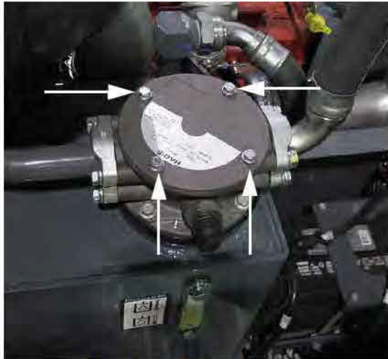
Boîtier du filtre de retour (situé sur le dessus du réservoir d'huile hydraulique) - Vue typique
