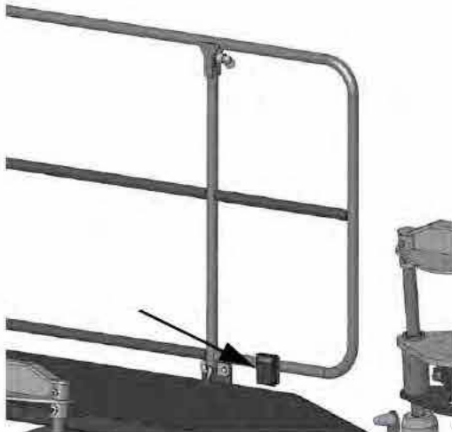
Pédale du lave-mains (située le long de la rambarde inférieure de gauche) - Vue typique
