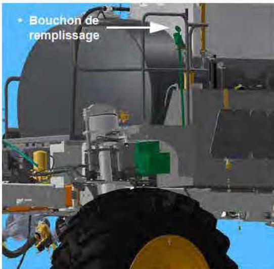
Remplissage du réservoir de marqueur à mousse (situé sur la main courante sur la partie arrière droite de la machine) - Vue typique
