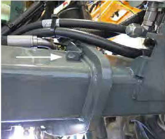
Support de fixation du pare-broussailles (côté gauche de la machine illustré) - Vue typique
