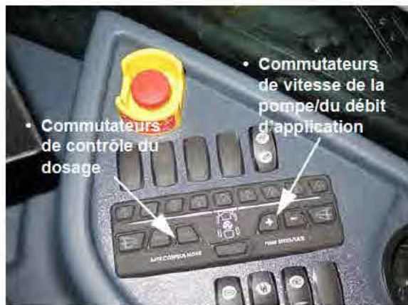
Commutateurs de contrôle du dosage et de vitesse/de débit de la pompe (situés sur la console latérale) - Vue typique
