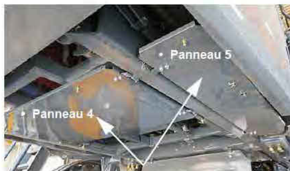
Installation du bouclier de bas de caisse arrière - Vue typique
