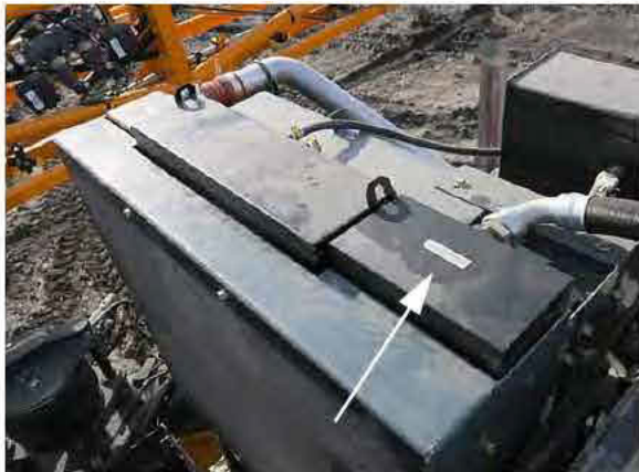
Refroidisseur d'huile (situé vers l'arrière de la machine - ouvrez le capot pour y accéder) - Vue typique
