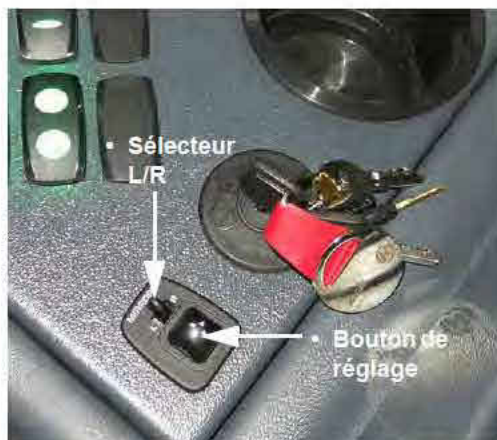
Bouton de réglage des rétroviseurs à commande électrique (situé sur la console latérale) - Vue typique
