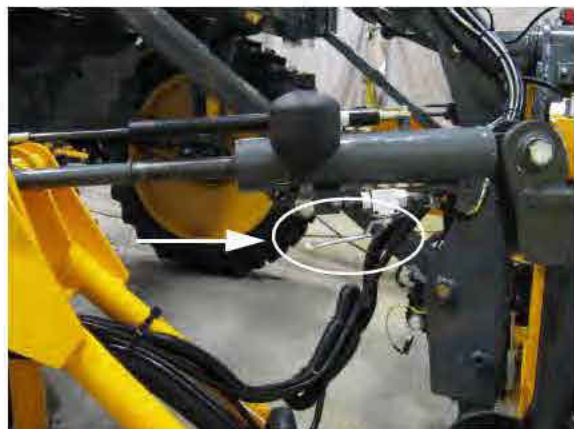
Vannes manuelles NORAC (2) (situées sur les vérins de mise de niveau gauche et droit) - Vue typique
