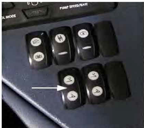
Commutateur des extensions de la rampe * Rampes de pulvérisation de 27 mètres (situé sur la console latérale) - Vue typique
