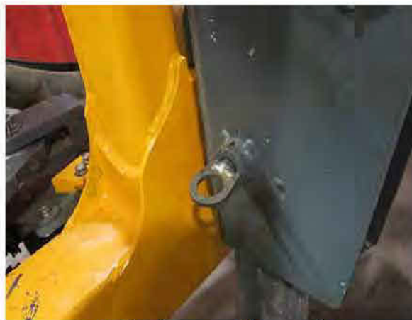
Goupille de verrouillage retirée - Vue typique
