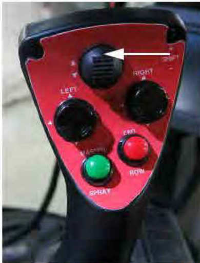
Interrupteur de la traverse - HAUT (situé sur le levier de commande de l'entraînement hydrostatique) - Vue typique
