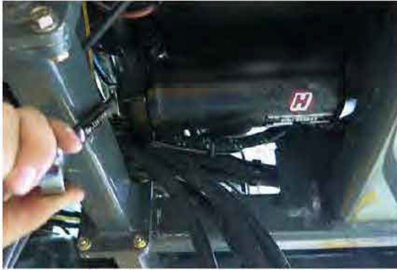
Filtre de la pompe de charge (situé sous la pompe d'entraînement) - Vue typique
