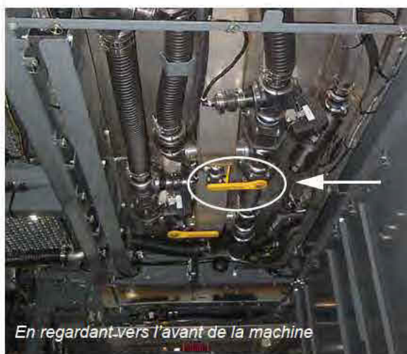
Vanne de siphonnage deux produits (située sous la partie centrale de la machine) - Vue typique
