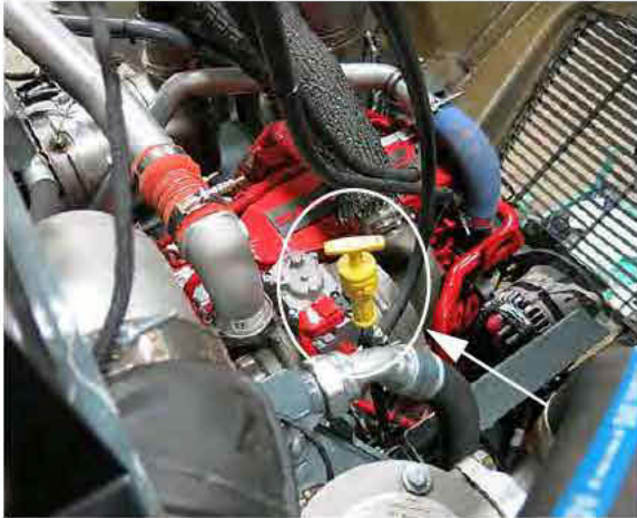
Jauge de niveau de l'huile moteur (située sur le côté gauche du moteur - ouvrez le capot pour y accéder) - Vue typique
