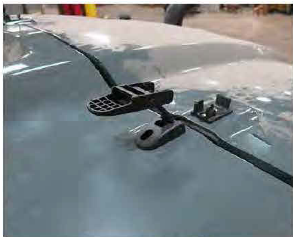
Loquet du capot (2) (situés de chaque côté du capot supérieur) - Vue typique
