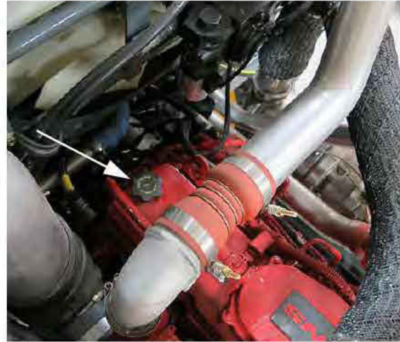
Remplissage d'huile moteur (situé sur le dessus du moteur) - Vue typique
