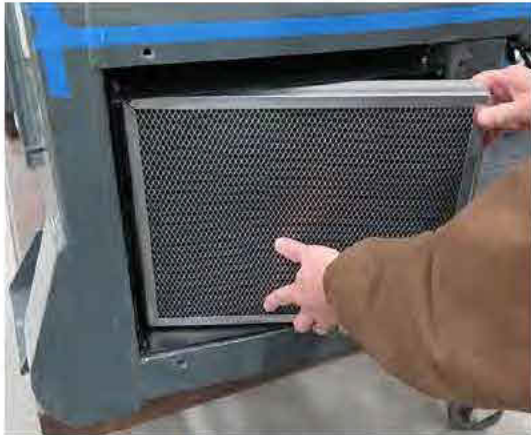
Filtre à charbon (situé derrière le panneau d'entretien extérieur sur le côté droit de la cabine) - Vue typique
