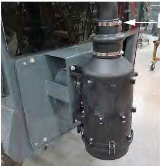
Bride de fixation supérieure (située à proximité du haut de l'unité de filtration RESPA) - Vue typique
