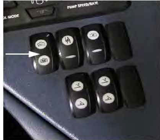
Commutateur de sélection des vannes des réservoirs (situé sur la console latérale) - Vue typique
