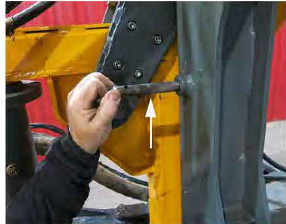
Boulon de fixation (situé sur la partie extérieure du châssis de la traverse) - Vue typique
