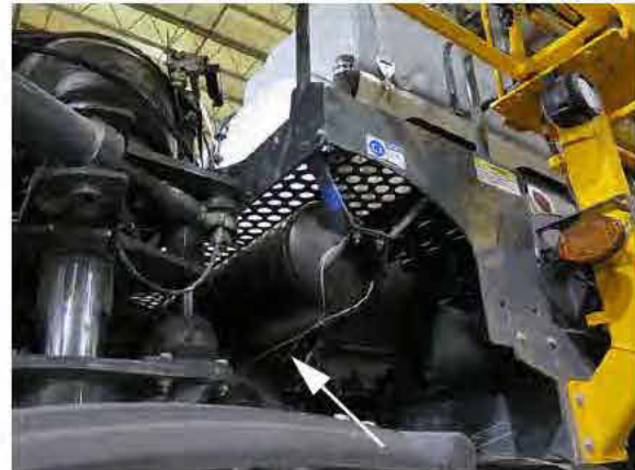
Vanne de vidange du réservoir (de purge de l'air) - si la machine en est équipée (située en dessous de la plate-forme, près de la partie centrale, du côté droit de la machine)
