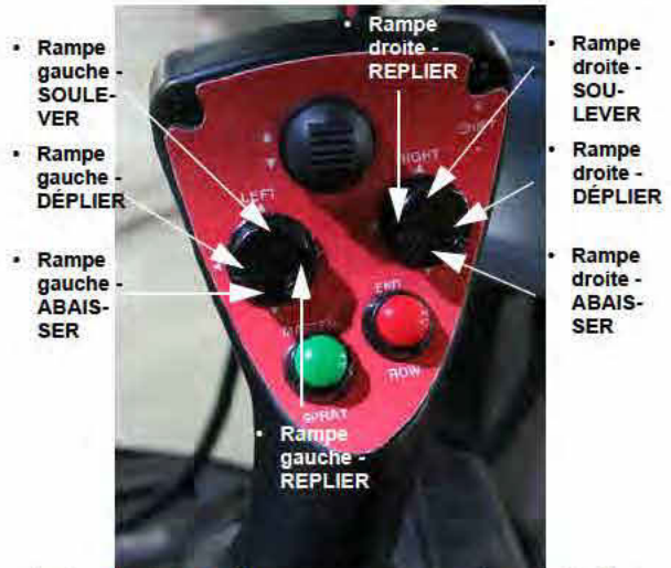
Interrupteurs des rampes gauche et droite (situés sur le levier de vitesse de la transmission hydrostatique) - Vue typique
