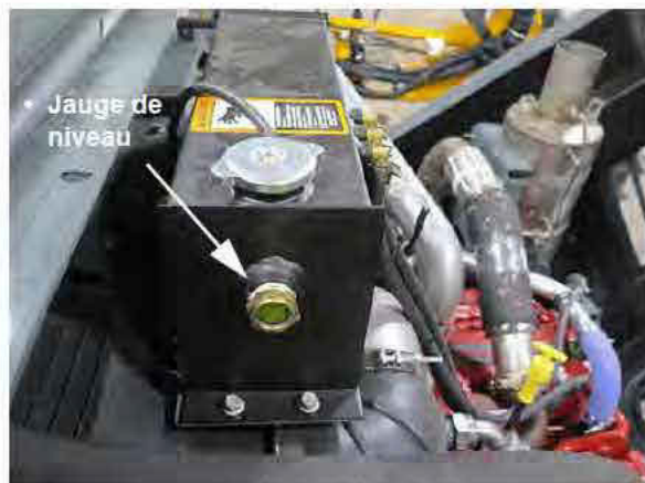
Radiateur (situé sur la partie arrière de la machine - ouvrez le capot pour y accéder) - Vue typique
