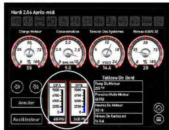
Instruments de mesure PE A et PE B (situés sur l'écran Diagnostics du moteur)
