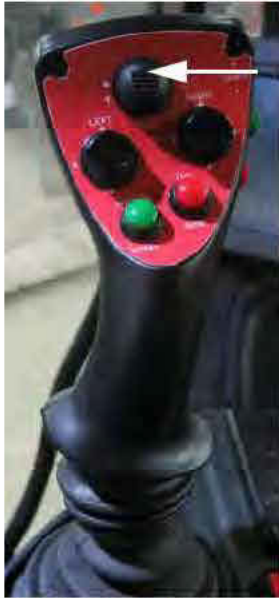
Commutateur de la traverse - HAUT (situé sur le levier de vitesse de la transmission hydrostatique) - Vue typique
