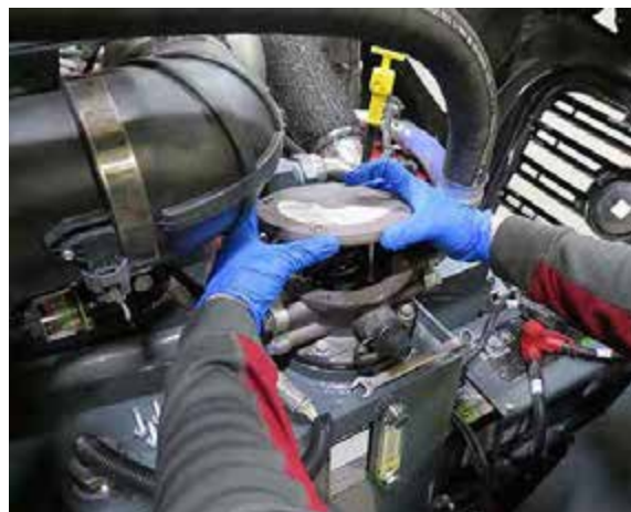
Remplissage du réservoir par le haut du boîtier du filtre de retour hydraulique - Vue typique
