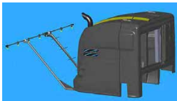
Installation de la rampe arrière - Vue typique
