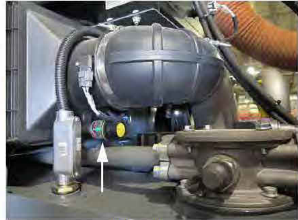
Filter Minder (situé près du préfiltre du moteur - ouvrez le capot pour y accéder) - Vue typique
