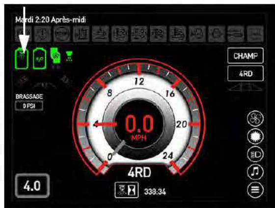
Voyant d'état de la vanne du réservoir principal (situé sur la page d'accueil de l'afficheur de la machine - mode Champ)
