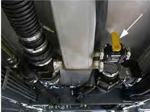
Vanne de vidange du réservoir de solution (située sous le réservoir de solution sur le dessous de la machine) - Vue typique
