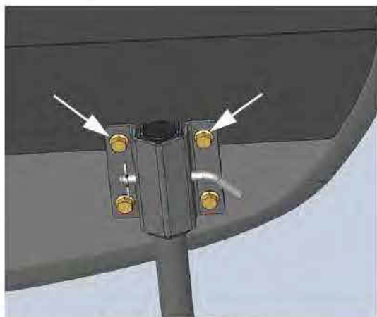
Boulons de fixation (Deux de chaque côté du support du capot) - Vue typique
