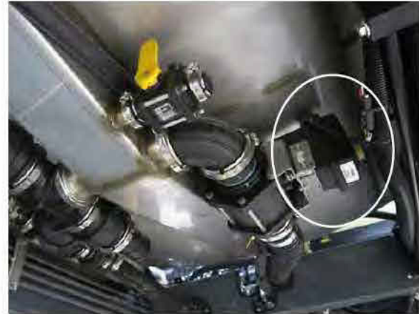
Vanne du réservoir de solution (située sous le réservoir de solution sur le dessous de la machine) - Vue typique
