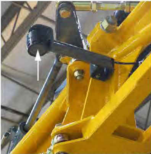
Plaques de mousse d'un capteur NORAC (situées dans la partie inférieure de chaque capteur) - Vue typique
