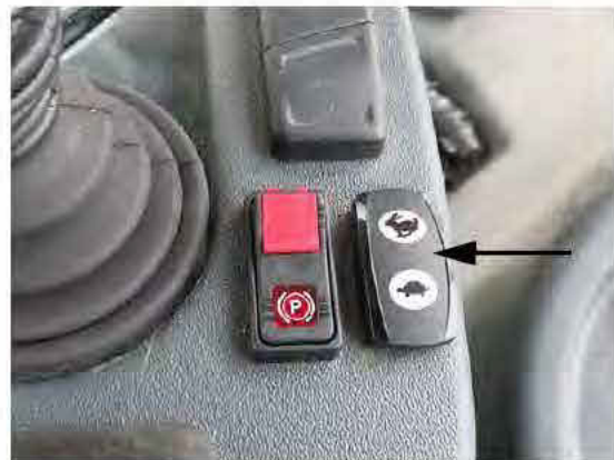
Bouton d'accélération (situé près du levier de vitesse de la transmission hydrostatique) - Vue typique
