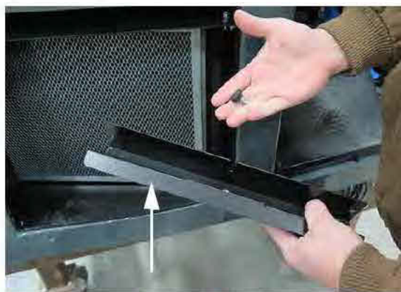
Support du filtre (situé sur le côté droit du filtre à charbon actif) - Vue typique
