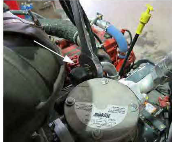
Tuyau flexible de vidange du carter (situé près de la partie supérieure du réservoir d'huile hydraulique) - Vue typique
