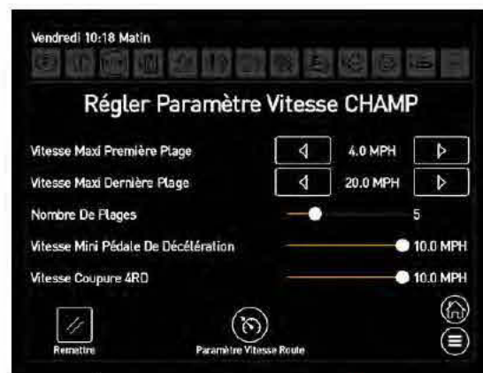
Écran Paramètres de vitesse - Paramètres de vitesse sur champ illustrés
