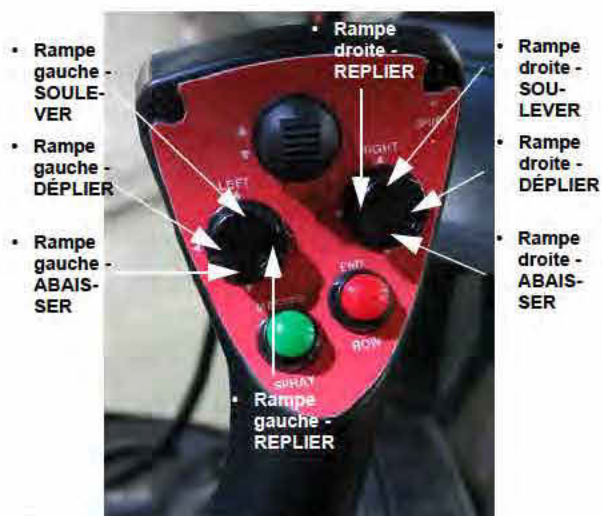
Commutateurs des rampes droite et gauche (situés sur le levier de vitesse de la transmission hydrostatique) - Vue typique
