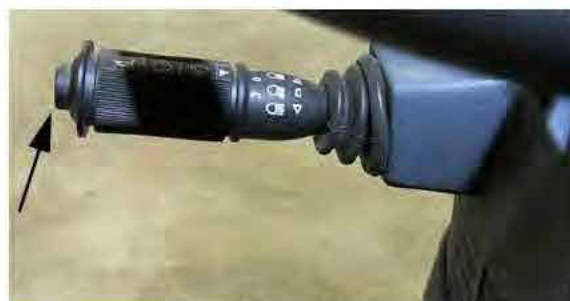
Touche du klaxon (située à l'extrémité du levier des clignotants) - Vue typique
