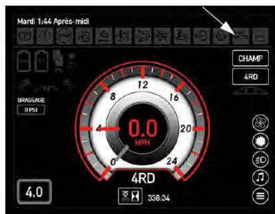
Indicateur de pression dans la rampe (situé sur la page d'accueil de l'afficheur de la machine - mode Champ)
