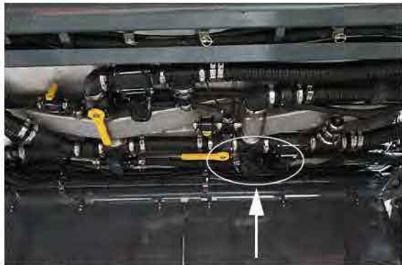
Crépine en ligne de la solution - Primaire (située en dessous de la partie centrale, du côté droit de la machine) - Vue typique
