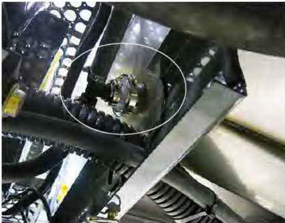
Agitateurs à jet (2) (situé à chaque extrémité du réservoir de solution) - Vue typique
