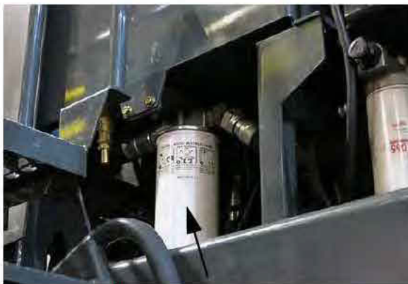
Filtre de retour au carter (situé sur le côté gauche de la machine) - Vue typique
