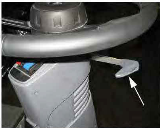
Poignée de réglage de la colonne de direction télescopique (située sur le côté droit de la colonne de direction) - Vue typique
