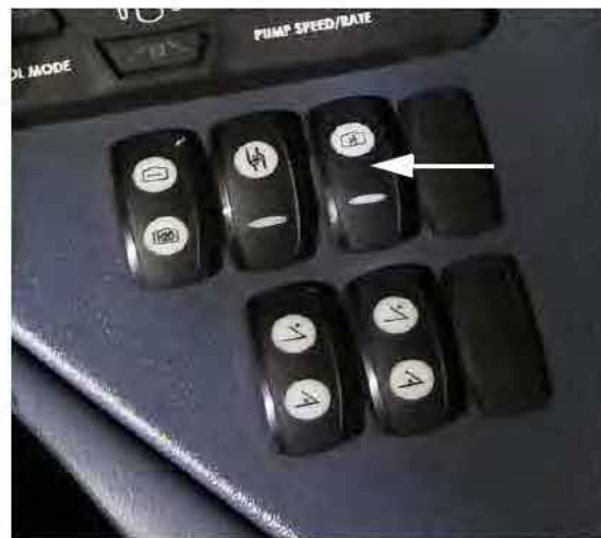
Commutateur de la vanne de brassage (situé sur la console latérale) - Vue typique
