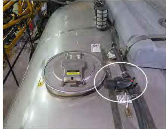
Crépine de rinçage du réservoir - Réservoir en acier inoxydable (située sur le haut du réservoir de solution) - Vue typique
