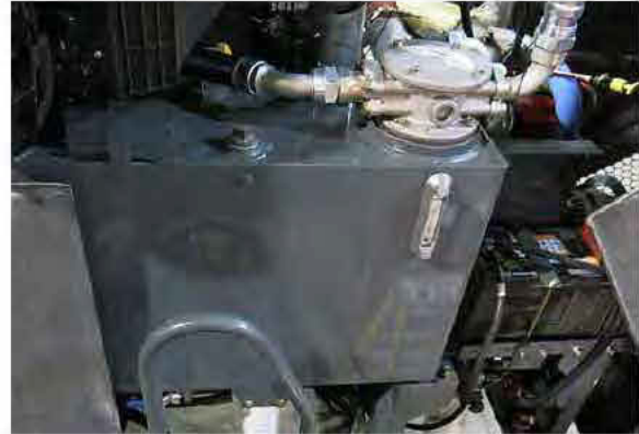
Réservoir d'huile hydraulique (situé sur le côté gauche de la machine - ouvrez le capot pour y accéder) - Vue typique
