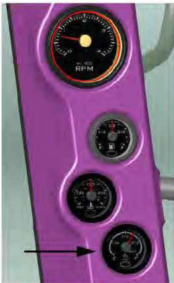
Jauge d'AUS 32 (située sur le montant A) - Vue typique
