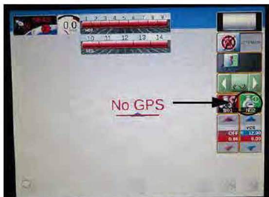
Interrupteur de pompe à solution - Secondaire (situé sur la console du système de pulvérisation) - Vue typique
