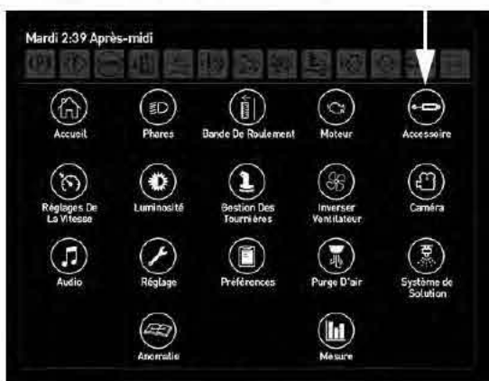
Touche Outil de travail (située sur la page Menu principal de l'afficheur de la machine)
