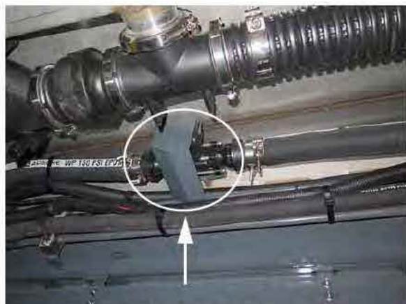
Débitmètre - Primaire (situé en dessous de la partie centrale, du côté droit de la machine) - Vue typique
