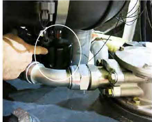
Bouchon de reniflard (situé sur le côté gauche de la machine près du boîtier de filtre de retour) - Vue typique
