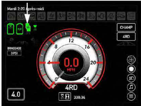
Indicateur de la pompe à solution (situé sur la page d'accueil de l'afficheur de la machine - mode Champ)
