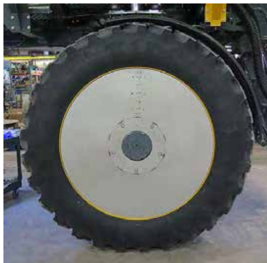
Installation du flasque de roue - Vue typique
