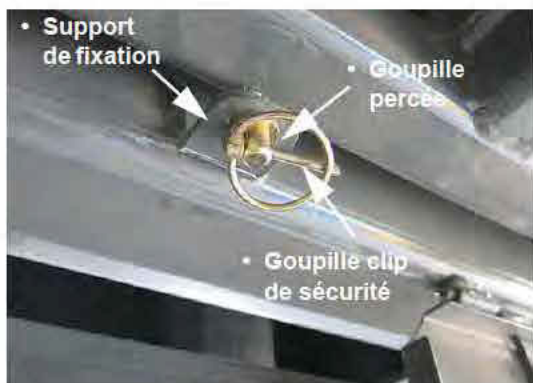
Support de fixation / ensemble de la goupille clip de sécurité - Vue typique
