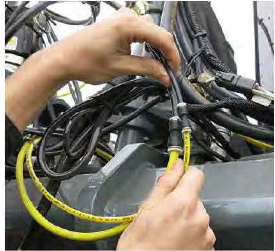
Branchement du marqueur à mousse - Standard (situé sur le côté avant droit de la machine) - Vue typique
