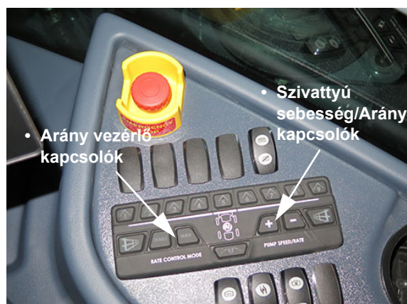
Arány szabályozó, és szivattyú sebesség/arány kapcsolók (a vezérlőpult oldalán helyezkedik el) – Tipikus nézet
