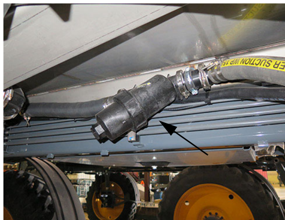
Permetezőszert csőhálózati szűrőszitája (a gépezet alján, közepén jobb-kéz felőli oldalt) – Tipikus nézet
