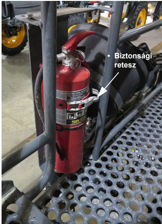
Tűzoltókészülék (a gép bal oldalán, az emelvény mellett található) – Tipikus nézet
