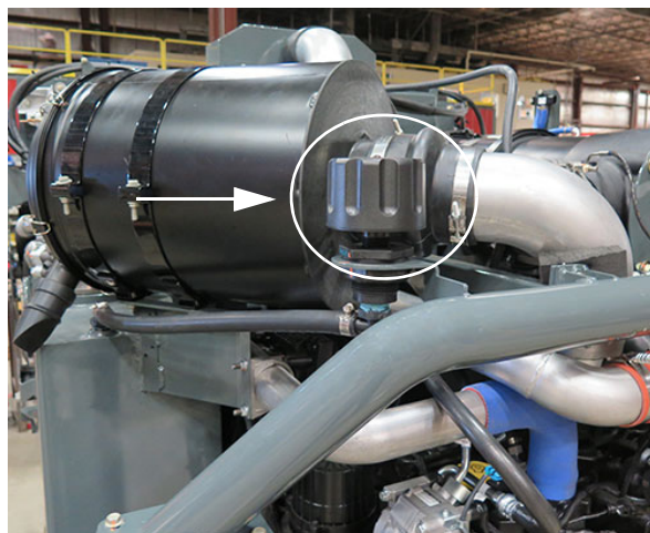
Légzsapka - STS14/STS16 (a munkagép bal hátsó részén, a levegőszűrő mögött található) – Tipikus nézet
