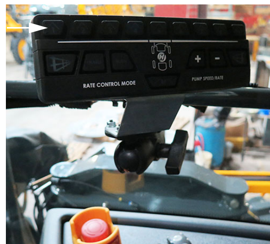
Gémmel szemelt szelep kapcsolók - Kettős permetlé billentyűblokk (az oldalsó konzol közelében van felszerelve) – Tipikus nézet
