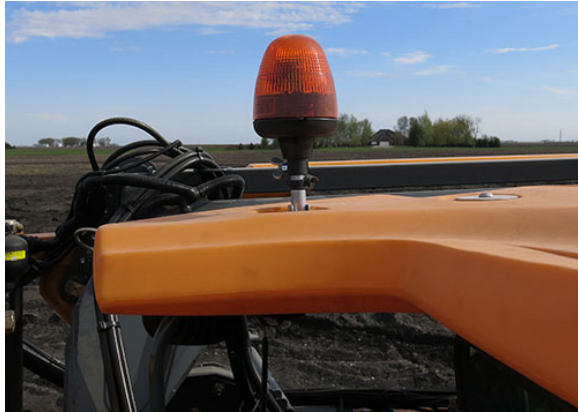
Körforgó jelzőfény (Elhelyezve az elülső tetősapkán) – Tipikus nézet
