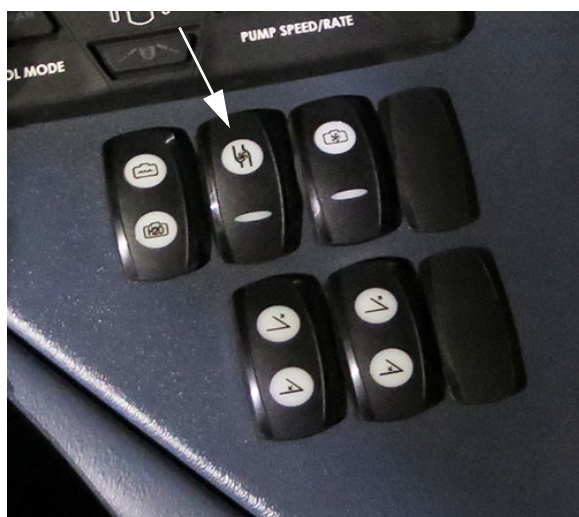
Permetlé szivattyú kapcsoló (oldalkonzolon) – Tipikus nézet
