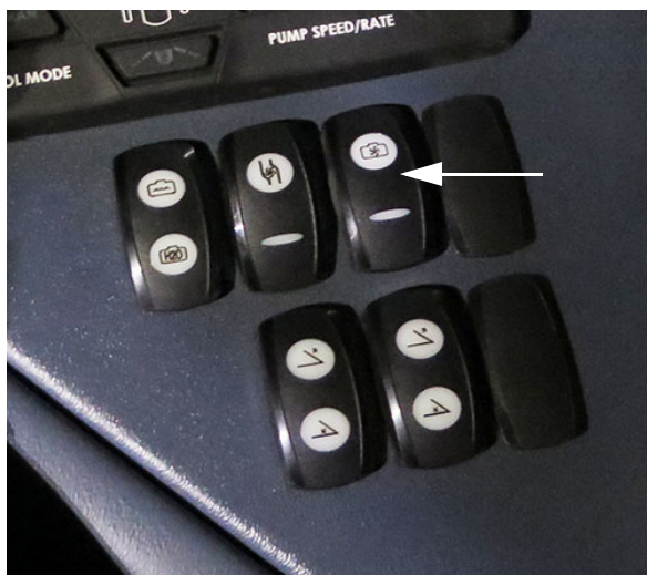
Keverőszelep kapcsoló (oldalsó vezérlőpulton) – Tipikus nézet
