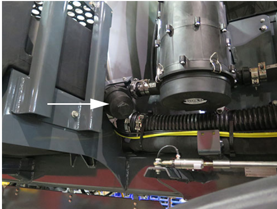
Permetezőszerszög csőhálózati szűrőszita - Másodlagos (a gépezet elülső jobb oldalának közelében) – Tipikus nézet
