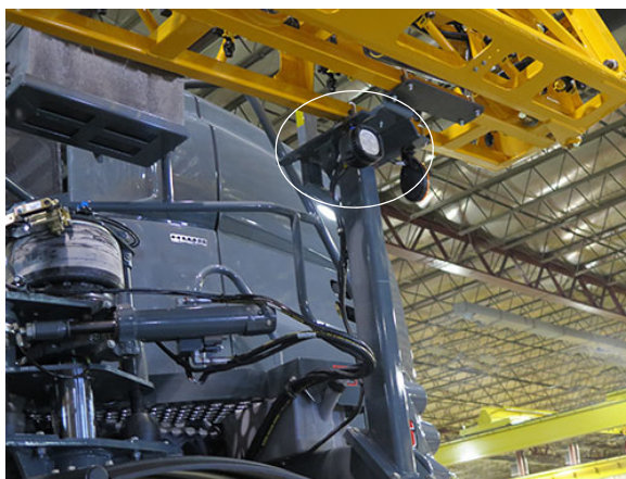
Munkalámpák (2) (a fülke mindkét oldalán) – Tipikus nézet
