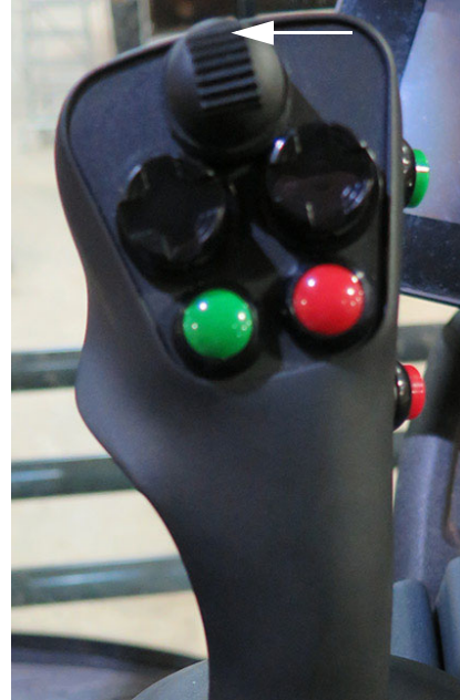
Támasztómű kapcsolója - FEL (a hidrosztatikus vezérlést irányító karon) – Tipikus nézet
