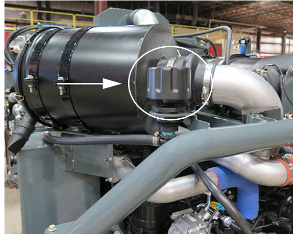
Légzősapka - STS14/STS16 (A munkagép bal hátsó részén, a levegőszűrő mögött található) – Tipikus nézet
