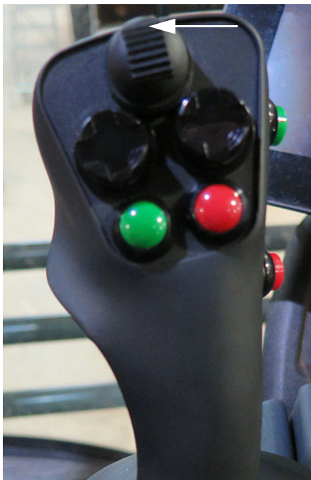
Támasztómű kapcsoló - FEL (a hidrosztatikus vezérlést irányító karon) - Tipikus nézet
