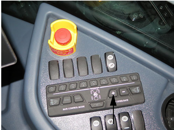
„+” Szivattyú sebesség/arány kapcsoló (oldalkonzolon) – Tipikus nézet
