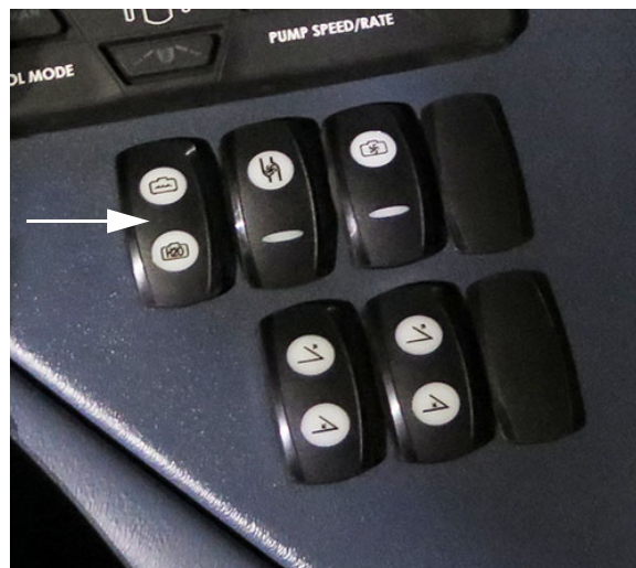
Tartály szelep választó kapcsoló (oldalkonzolon) - Tipikus nézet
