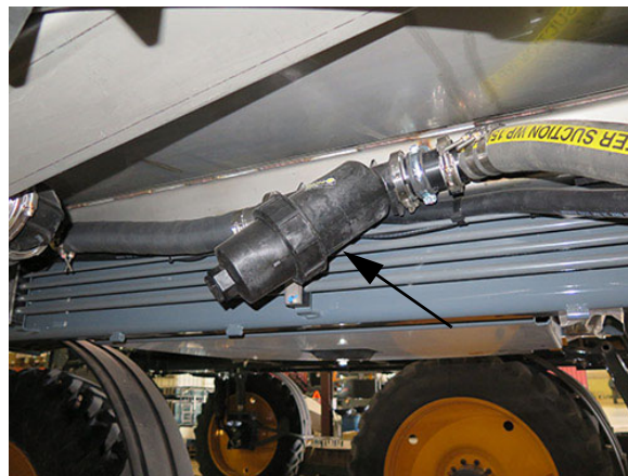
Permetezőszerszám csőhálózat szűrőszita (a gép jobb oldalán, annak középső része alatt helyezkedik el) – Tipikus nézet
