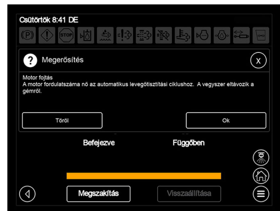
A gép gázt ad az automatikus légtisztítási ciklus alatt és kiszorítja a vegyszert a gémből nyugtázása
