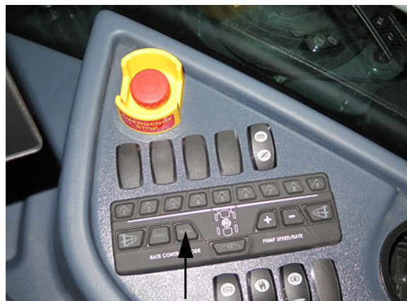
Kézi „MAN” arány szabályzó kapcsoló (oldalsó vezérlőpulton) – Tipikus nézet
