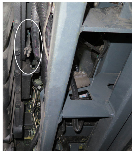
Motormelegítő tápkábel - STS14/STS16 (A munkagép alatt a motor jobb oldalánál található) – Tipikus nézet
