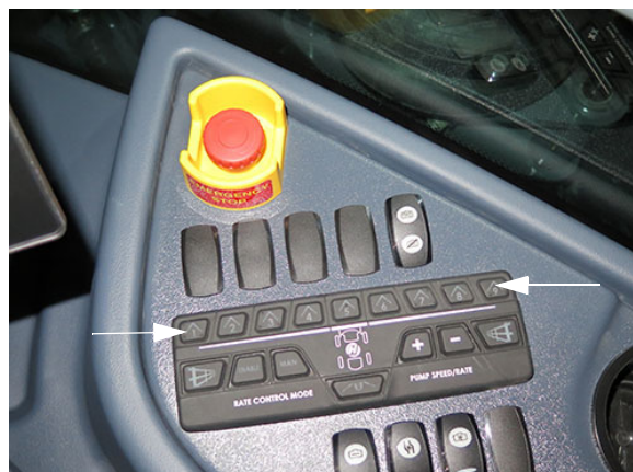
Gém permetlé szelep kapcsolók - 1-es, és 9-es szakasz (oldalkonzolon) - Tipikus nézet
