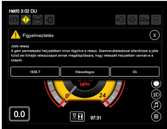
Külső gémtoldalék retesz „Nincs csatlakoztatva” hibaüzenet
