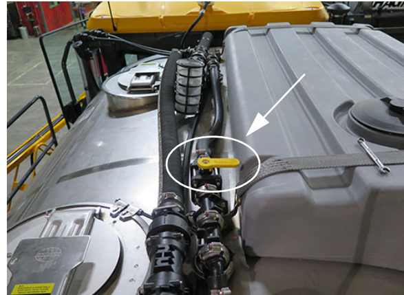
Kettős csőhálózatú öblítő szelep (mindegyik permetlé tartály tetején el van helyezve) – Tipikus nézet
