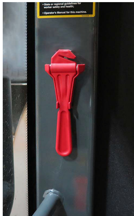
Vészhelyzeti üvegtörő eszköz (a fülke hátsó jobb oldalán) –Tipikus nézet
