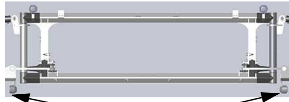
Éjszakai permetező lámpák (2) - 90/100' gém (a fő gém hajtási szakaszának mindkét oldalán) – Tipikus nézet
