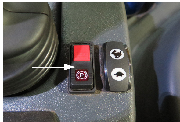
Rögítőkék (parkolófék) kapcsoló (a hidrosztatikus vezérlést irányító kar közelében) - Tipikus nézet
