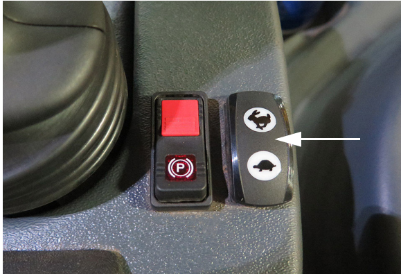
Gáyszabályzó/Fojtás kapcsolója (a hidrosztatikus hajtás vezérlőkarja mellett) – Tipikus nézet
