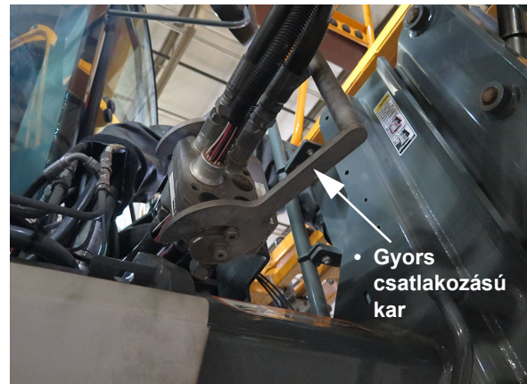
Hidraulikus/elektromos multi-csatlakozó összeszerelés (a gép elülső, bal oldalánál helyezkedik el)
