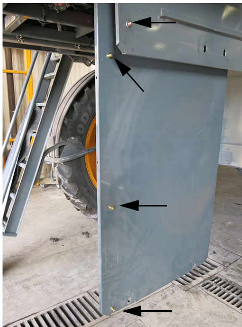
Függő csapok (szerelje fel a csapokat a 4., 5. és 6. panelre) – Tipikus nézet
