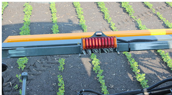
Gém permetlé szelep jelzőfények (a támasztóművön található) – Tipikus nézet
