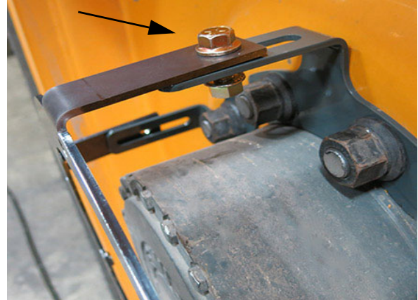
Kerékagy lemezsapkát rögzítő szerelvénylemez telepítése – Tipikus nézet
