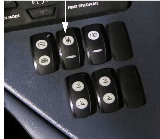
Tartály szivattyú kapcsoló (az oldalkonzolon) – Tipikus nézet
