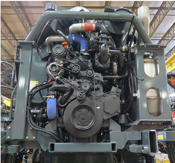
John Deere 4-es besorolású 4 PSS 9,0 l dízelmotor - STS14/STS16 – Tipikus nézet
