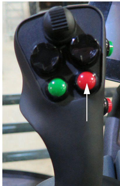
Sorvég kezelés kapcsoló (a hidrosztatikus vezérlést irányító karon) – Tipikus nézet
