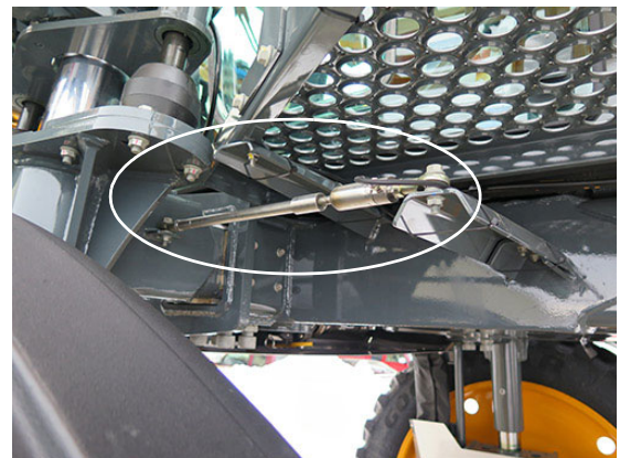
Nyomtáv beállítás érzékelő (4) (minden lábon) - Tipikus nézet
