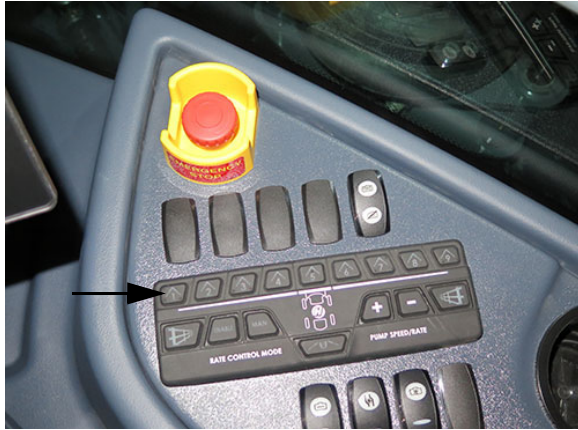
Gép permetlé szivattyú kapcsolók (oldalkonzolon) – Tipikus nézet
