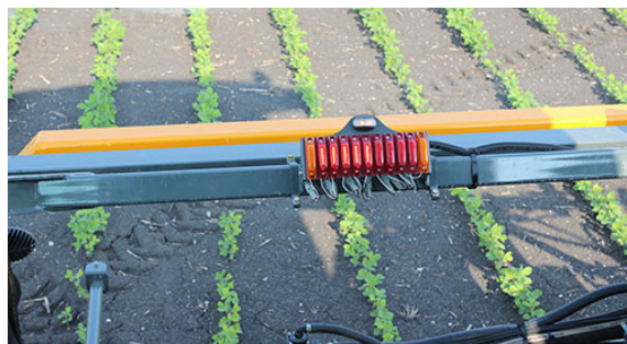
Gém permetlé-szelep állapotjelzők (támasztóművön) – Tipikus nézet
