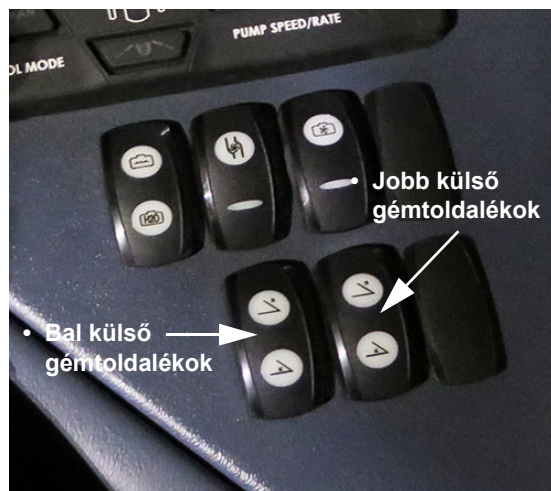
Gém toldalék kapcsolók - Bal/Jobb (oldalkonzolon) - Tipikus nézet
