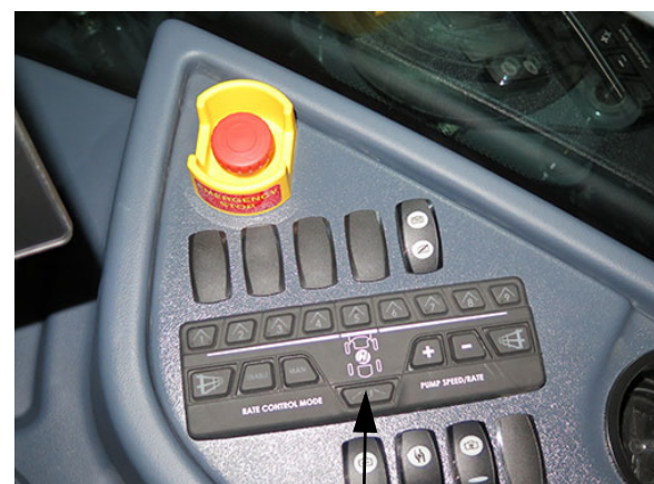
Hátsó fúvóka kapcsolója (oldalsó vezérlőpulton) – Tipikus nézet
