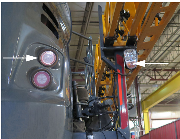
Hátsó vészjelző/ figyelmeztető fény villogók (4) – Tipikus nézet
