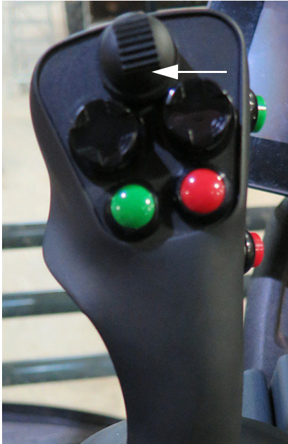
Támasztómű kapcsoló - LE (a hidrosztatikus vezérlést irányító karon) – Tipikus nézet
