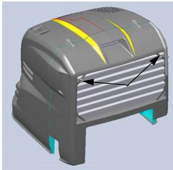
Radiátor üveg rugós szorítói (2) (az üveg tetején, bal és jobb oldalán) – Tipikus nézet
