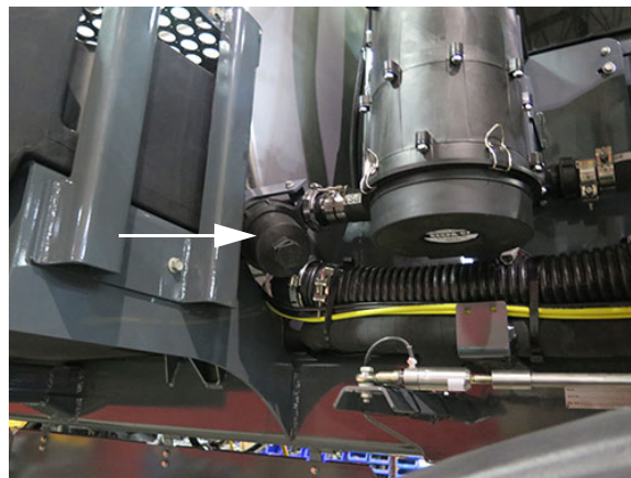
Permetezőszer csőhálózati szűrőszita - Másodlagos (a gépezet elülső jobb oldalának közelében) – Tipikus nézet
