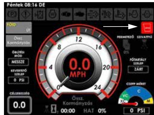
Elégtelen fülkenyomás jelző (Munkagép képernyője főoldal – Közúti vagy mezei üzemmód)
