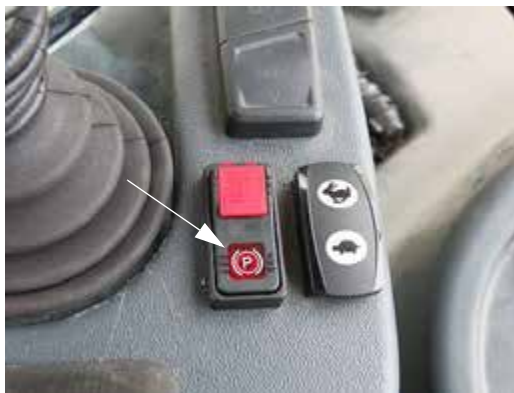
Rögzítőfék (parkolófék) kapcsoló (a hidrosztatikus vezérlő kar közelében) - Tipikus nézet
