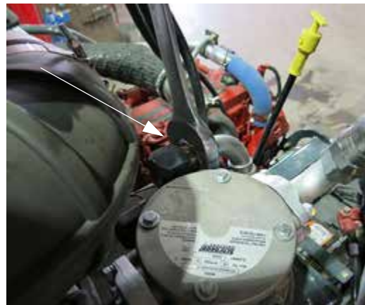
Ház leeresztő tömlő (a hidraulikus tartály tetejének közelében helyezkedik el) – Tipikus nézet
