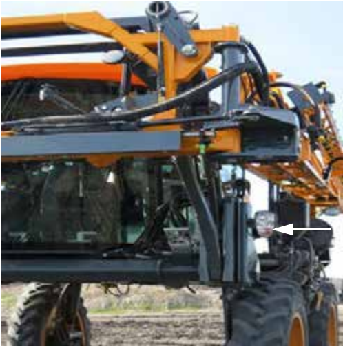
Vészjelző/figyelmeztető fények (a gép elején/hátulján és a motorháztetőn mindkét oldalon)
