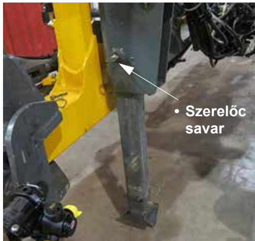
Gém állvány (Kihajtott pozíciót mutatja) – Tipikus nézet
