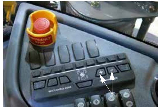
Szivattyú sebesség/Árány kapcsolók (oldalsó vezérlőpulton) – Tipikus nézet
