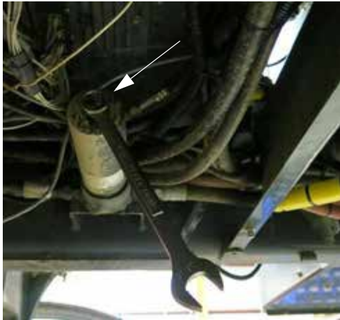
Nyomó vezeték szűrő háza (A gép jobb oldala alatt - a fém lemez levételével férhet hozzá) – Tipikus nézet
