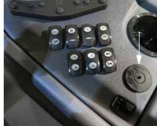
Gyújtáskapcsoló (oldalsó vezérlőpulton) – Tipikus nézet
