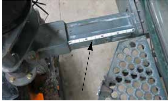
Nyomtáv beállítás jelzőmatrica (Első lábak) - Tipikus nézet
