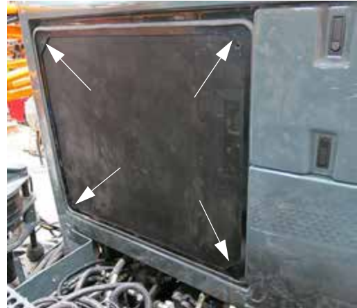
Radiátor üveg reteszek (az üveg négy sarkánál helyezkednek el) – Tipikus nézet
