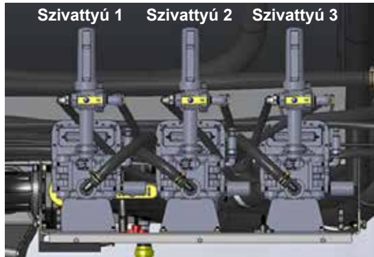
Befecskendező szivattyúk (A főtartály jobb oldalán helyezkedik el - a hozzáféréshez nyissa ki az ajtót) – Tipikus nézet
