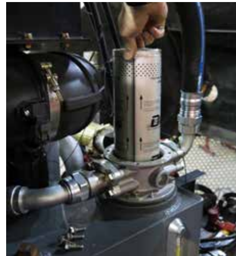
Visszatérő vezeték szűrő (a szűrőházon belül van elhelyezve) – Tipikus nézet
