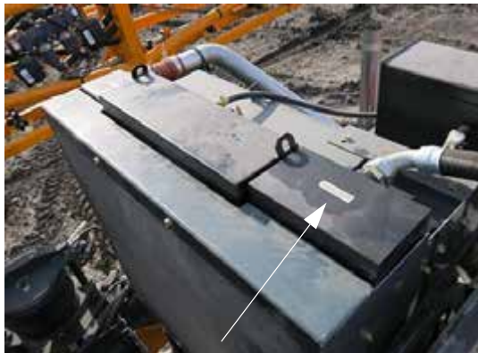
Olajhűtő (A gép hátulja mellett – a motorháztető kinyitásával férhet hozzá) – Tipikus nézet
