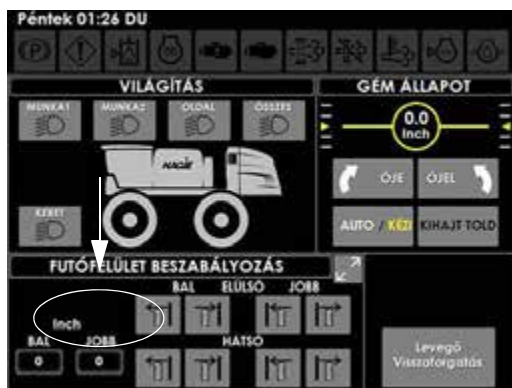
Bal/jobb nyomtáv szélesség kijelzők - hátsó lábak (a munkagép képernyőjének Segédvezérlések oldalán)
