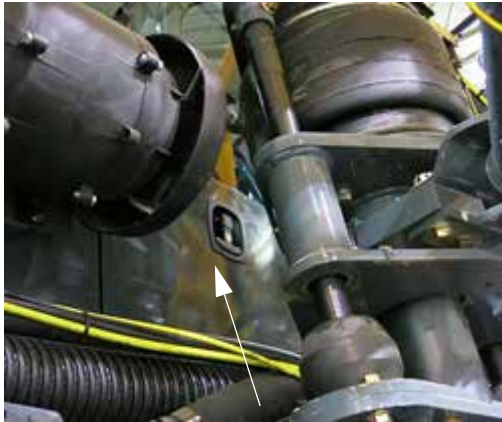
Külső szerviz panel (a vezetőfülke jobb oldalán helyezkedik el) – Tipikus nézet
