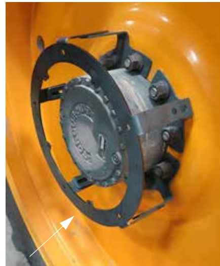
Kerékagy lemezsapkát rögzítő szerelvénylemez – Tipikus nézet
