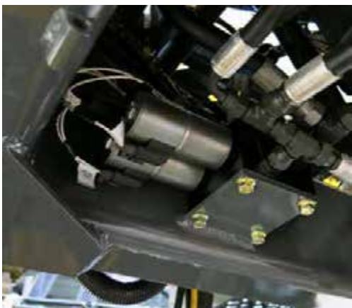
Elosztószelep (a gép alján) – Tipikus nézet
