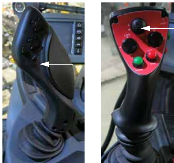
Támasztómű kapcsoló - LE (a hidrosztatikus vezérlést irányító karon) – Tipikus nézet
