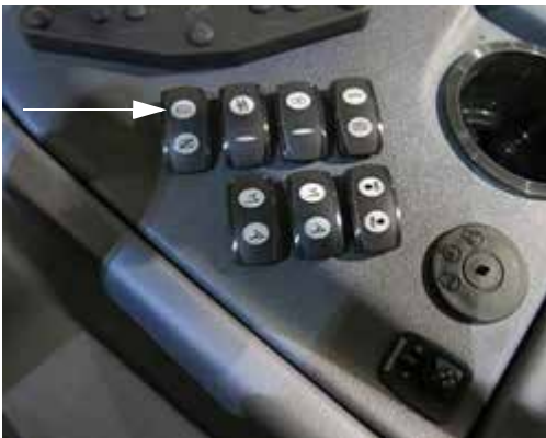
Főtartály szelep kapcsolója (oldalkonzolon) - Tipikus nézet
