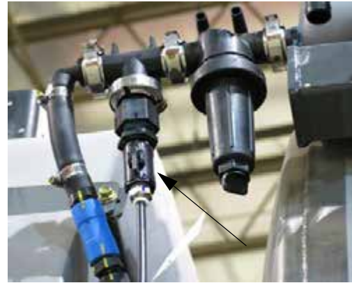
Habzás jelző szelep (az öblítő tartály hátuljánál helyezkedik el) – Tipikus nézet
