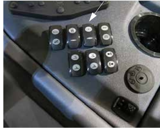
Keverőszelep kapcsolója (oldalsó vezérlőpulton) – Tipikus nézet
