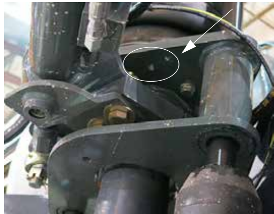
Gallér zsírzószem (a légzsák szerelőlapja alatt helyezkedik el) – Tipikus nézet
