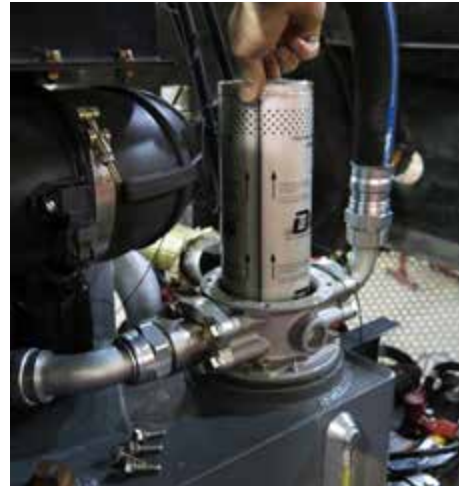
Visszatérő vezeték szűrő (a gép bal oldalán a visszatérő vezeték szűrő házában) – Tipikus nézet
