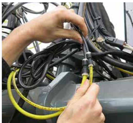
Habjelölő csatlakoztatása (a gép elülső jobb oldalánál helyezkedik el) – Tipikus nézet
