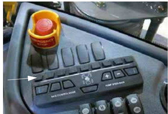
Keritéssor kapcsolók (oldalsó vezérlőpulton) – Tipikus nézet
