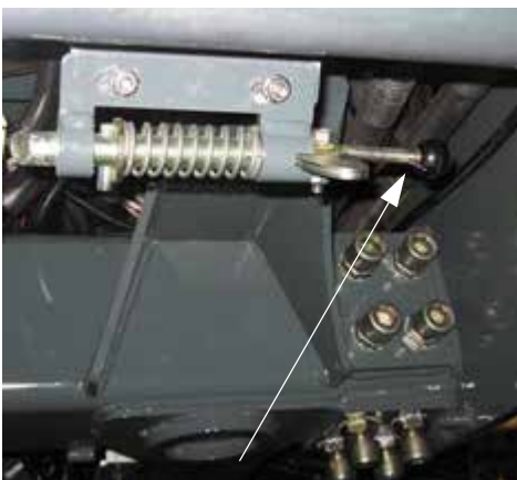
Elülső töltő kioldó kar (a gép elülső vége alatt) - Tipikus nézet
