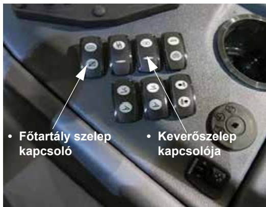
Főtartály és keverőszelep kapcsolók (oldalkonzolon) – Tipikus nézet
