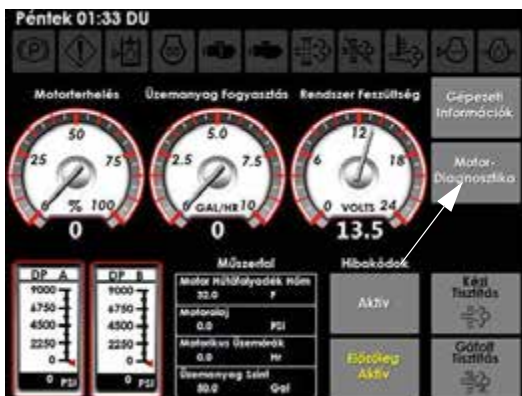
Motor diagnosztikai gomb (a gépdiagnosztikai oldalon)
