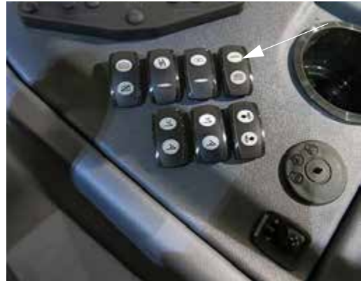
Permetlé szivattyú kapcsoló (oldalsó vezérlőpult) - Tipikus nézet
