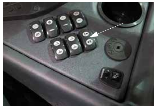
Habzás jelző kapcsoló (oldalsó vezérlőpulton) – Tipikus nézet
