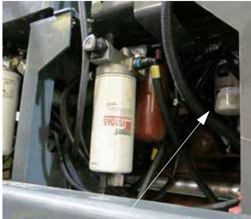
Motorolajszűrő (A gép bal-kéz felőli oldala mentén - hozzáféréshez nyissa fel a motorháztetőt) – Tipikus nézet
