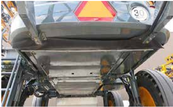
Alvázvédelmi szerelvény/súrlódásvédelmi gumifüggöny telepítés – Tipikus nézet
