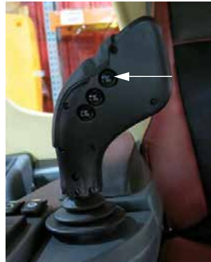
Elsődleges permetező kapcsoló (A hidrosztatikus vezérlést irányító kar 1-es változatának hátsó oldalán helyezkedik el) – Tipikus nézet
