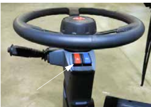
Vészjelző/figyelmeztető fények kapcsoló (a kormányoszlopon)
