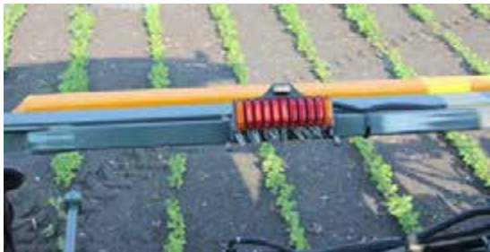
Gém permetlé szelep jelzőfények (a támasztóművön található) – Tipikus nézet
