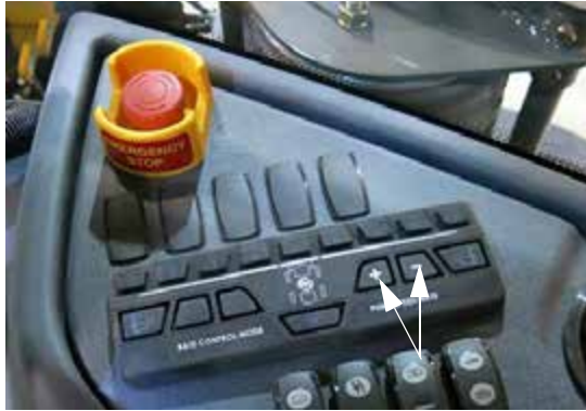
Szivattyú sebesség/Arány kapcsolók (oldalsó vezérlőpulton) – Tipikus nézet
