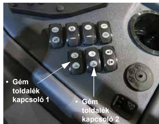
Gém toldalék kapcsolók (oldalsó vezérlőpulton) – Tipikus nézet
