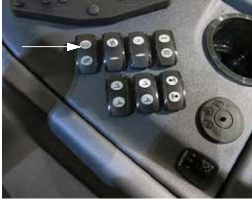
Főtartály szelep kapcsolója (oldalsó vezérlőpulton) – Tipikus nézet
