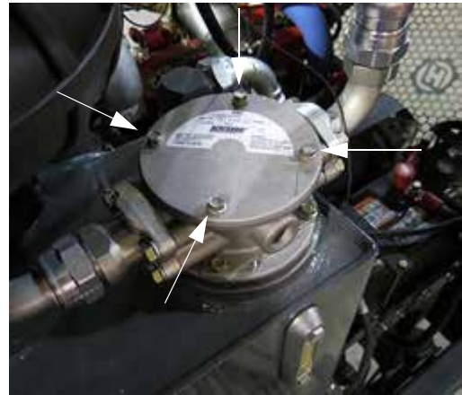
Visszatérő vezeték szűrő háza (a hidraulikus olaj tartály közelében, a gép bal oldalán elhelyezve) – Tipikus nézet
