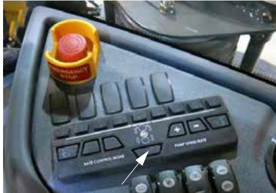
Hátsó fúvóka kapcsolója (oldalsó vezérlőpulton) – Tipikus nézet
