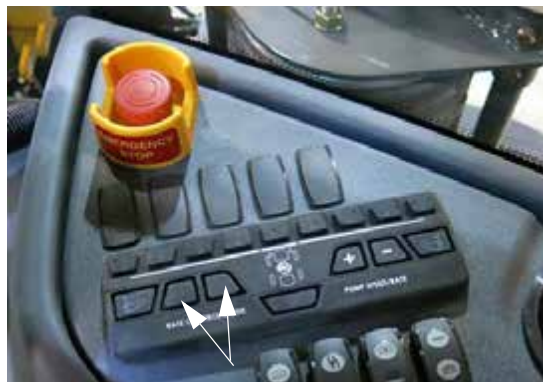
Mérték szabályzó kapcsolók (oldalsó vezérlőpulton) – Tipikus nézet
