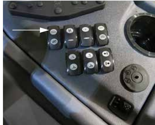
Főtartály szelep kapcsoló (oldalsó vezérlőpulton) - Tipikus nézet
