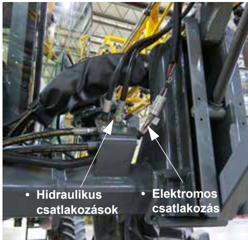
Hidraulikus/elektromos csatlakozások – “szabványos”
