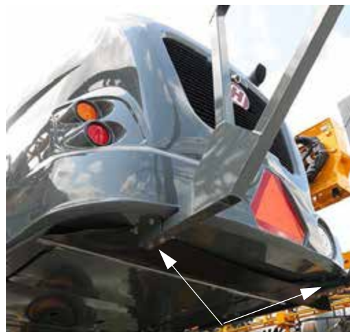
A súrolásvédelmi gumifüggöny csatlakoztatásra került a motorháztetőhöz – Tipikus nézet
