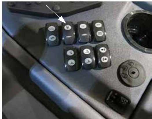
Főtartály szelep kapcsolója (oldalsó vezérlőpulton) - Tipikus nézet
