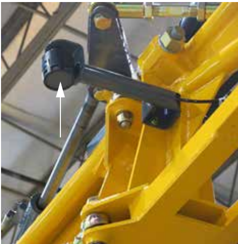
NORAC érzékelő habszivacs (a NORAC érzékelőn van elhelyezve) – Tipikus nézet
