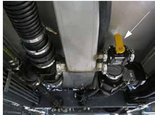
Permetlé tartály leeresztő szelep (a gépezet alsó oldalán a permetlé tartály alatt) – Tipikus nézet
