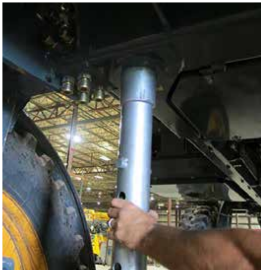
Az emelőrudat illessze az emelési pont támasz gyűrűjére – Tipikus nézet
