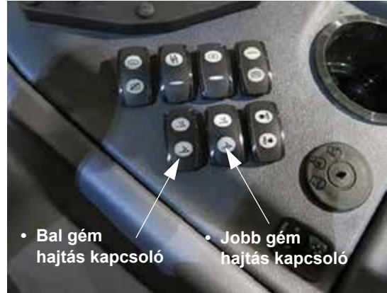
Bal és jobb gém toldalék kapcsolók (oldalsó vezérlőpulton) – Tipikus nézet
