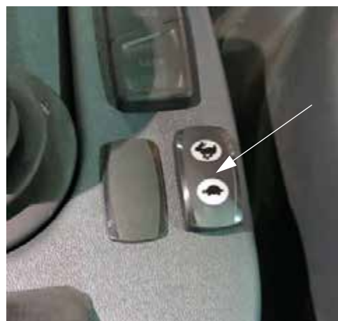
Gázszabályzó/Fojtás kapcsolója (a hidrosztatikus hajtás vezérlőkarja mellett) – Tipikus nézet
