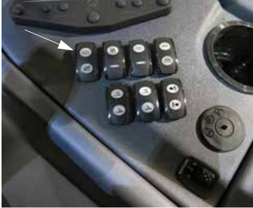
Főtartály szelep kapcsolója (oldalsó vezérlőpulton) – Tipikus nézet
