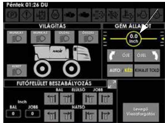
Gém igazítási érték (a segédvezérlések jobb kéz felőli oldalán)
