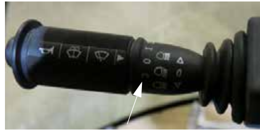
Ablaktörő sebesség (az irányjelző kapcsolón) – Tipikus nézet
