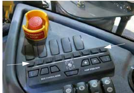
Gém permetlé szelep kapcsolók - 1-es, és 9-es szakasz (oldalkonzolon) - Tipikus nézet
