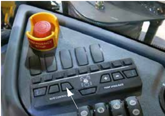
Kézi „KÉZI” arány szabályozó kapcsoló (oldalsó vezérlőpulton) – Tipikus mézet
