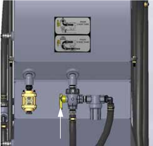
Bemenet választó szelep - 60 gallonos tartályok (az 1-es, 3-as tartályok külső oldalán) – Tipikus nézet
