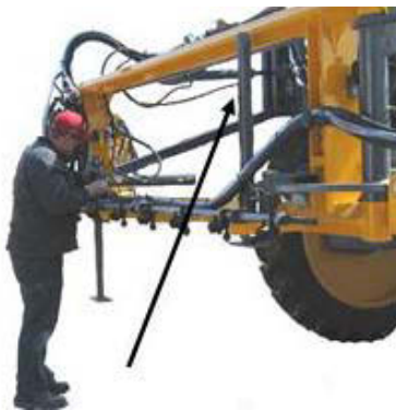
Gém állvány szállítási pozícióban – Tipikus nézet
