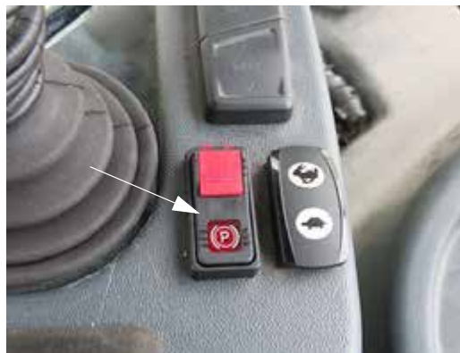
Rögzítőfék kapcsoló - ha van (a hidrosztatikus vezérlést irányító kar közelében) - Tipikus nézet
