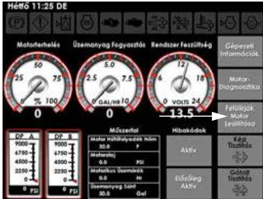
Motor leállító gomb felülírása (a gépdiaosztika oldalán)
