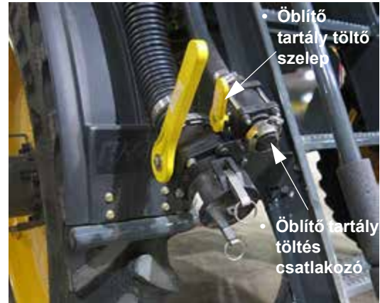
Hátsó töltő összeszerelés (a hátsó bal oldali kerék mögött) – Tipikus nézet
