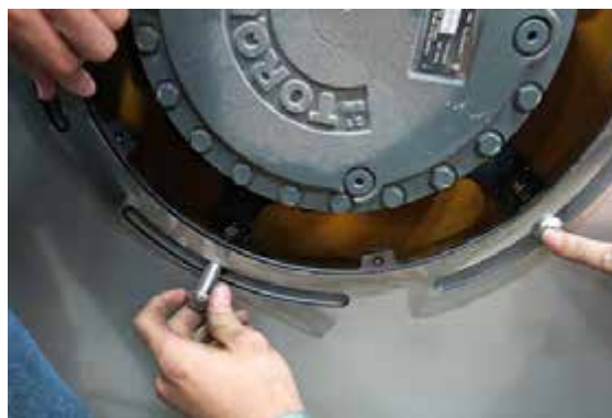
Kerék fedlemez szerelőcsavar telepítés – Tipikus nézet
