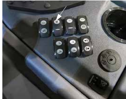
Permetlé szivattyú kapcsoló (oldalsó vezérlőpulton) – Tipikus nézet
