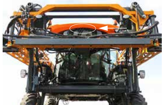
Szélvédőmosó folyadék fűvóka (a fülke külső részének a tetejénél) – Tipikus nézet
