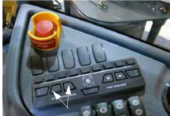
Mérték szabályzó kapcsolók (oldalsó vezérlőpulton) – Tipikus nézet
