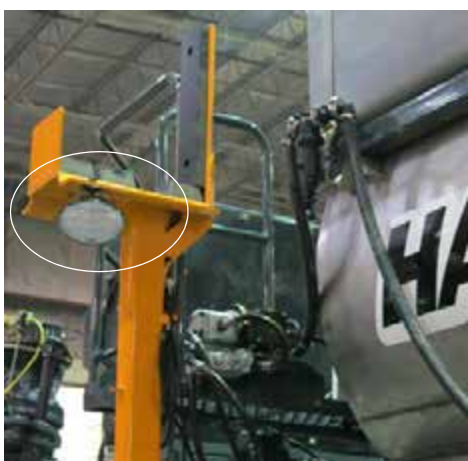
Munkalámpák (a fülke mindkét oldalán) – Tipikus nézet
