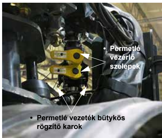
• Permetlé vezetékek bütykös rögzítő karok • Permetlé vezérlő szelepek Permetlé vezeték szelepek, és bütykös rögzítő karok (a munkagép elülső bal és jobb oldalán) – Tipikus nézet
