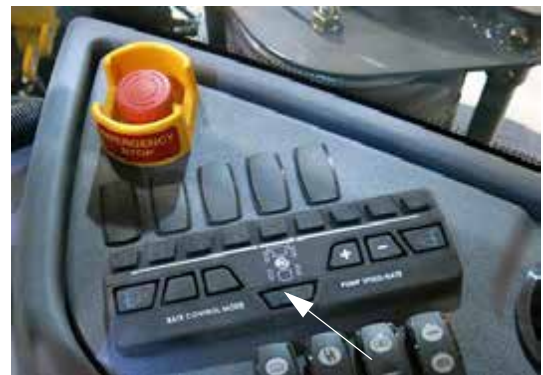
Hátsó fúvóka kapcsoló (oldalsó vezérlőpulton) – Tipikus nézet
