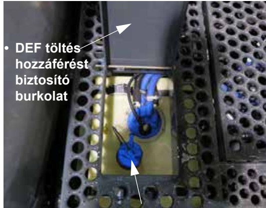
Páramentesítő (DEF) töltő sapka (a központi járópalló közelében a permetlé tartály mögött - a hozzáféréshez emelje fe a burkolatot) – Tipikus nézet
