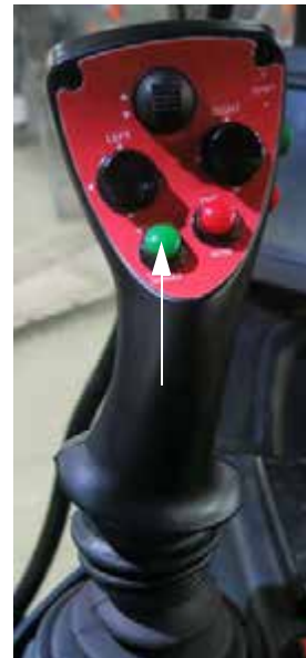
Elsődleges permetező kapcsoló (A hidrosztatikus vezérlést irányító kar 2-es változatán) – Tipikus nézet
