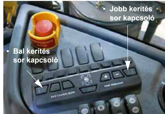
Kerítéssor kapcsolók – Bal és jobb (oldalsó vezérlőpulton) – Tipikus nézet
