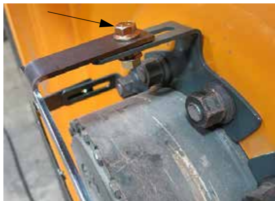
Kerékagy lemezsapkát rögzítő szerelvénylemez telepítése – Tipikus nézet
