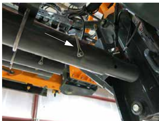
Termény súrlódás beállító kapocs (Az egyes cső végeknél helyezkedik el) – Tipikus nézet
