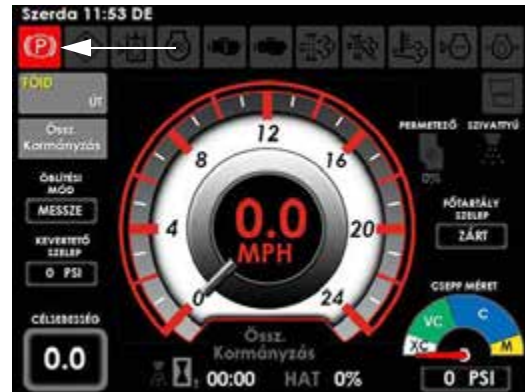
Rögzítőfék jelzés (A gép kijelzőjének minden egyes oldalán, a bal felső részen)
