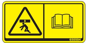
CAUTION CRUSH HAZARD. RISK OF INJURY DUE TO IMPROPER OPERATION. REFER TO OPERATOR'S MANUAL FOR INSTRUCTION.
