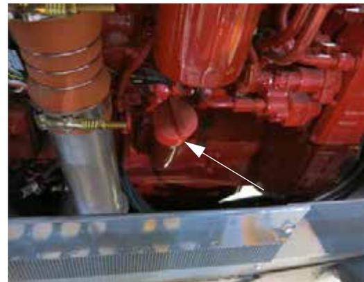
Orifice de remplissage d'huile moteur (situé sur le côté gauche du moteur - ouvrir le capot du moteur pour y accéder)
