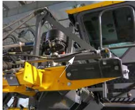
Vérin de repliement hydraulique
