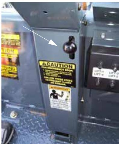
Levier de verrouillage de l'inclinaison de la colonne de direction (situé près du centre de la colonne de direction)
