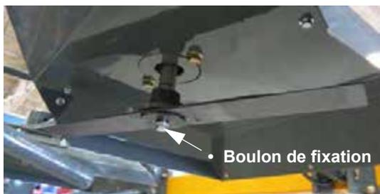
Assemblage d'une lame de coupe
