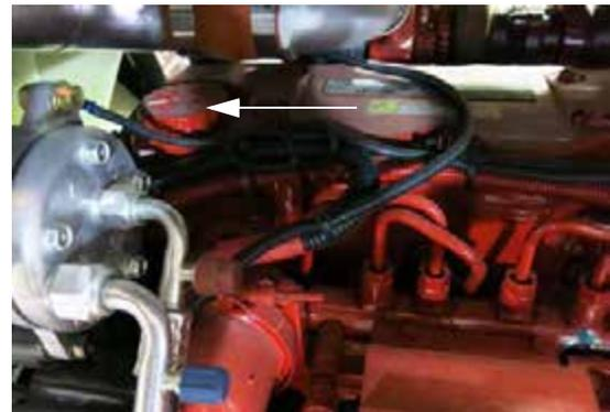
Orifice de remplissage d'huile moteur (situé sur le côté gauche du moteur - ouvrir le capot du moteur pour y accéder)
