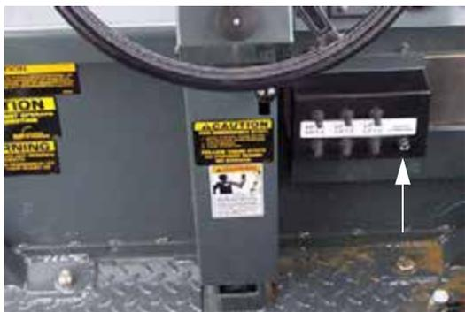
Fusible de contrôle de la profondeur
