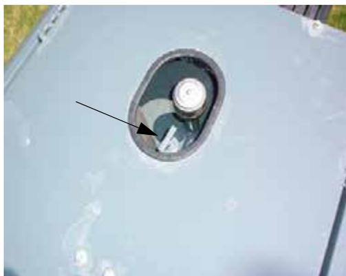
Jauge de niveau d'huile hydraulique (située sur le dessus du réservoir d'huile hydraulique)
