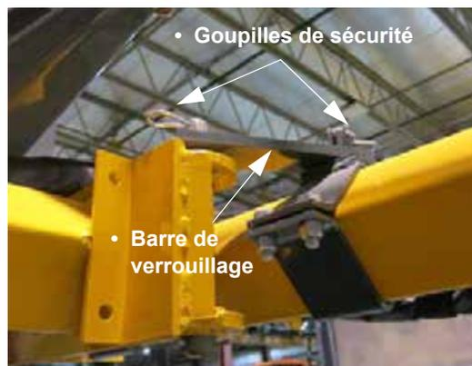
Assemblage goupille de sécurité-barre de verrouillage
