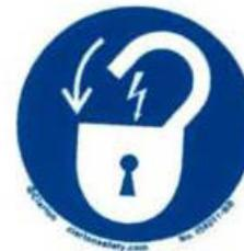
Illustre que le circuit électrique peut être interrompu, empêchant alors la machine de démarrer, lorsque la clé de contact est en position ARRÊT.
