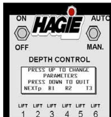
Pour programmer le module, sélectionner d'abord le paramètre de réponse. Si un réglage supplémentaire est nécessaire pour les paramètres du haut et (ou) du bas, procéder à leurs réglages.
