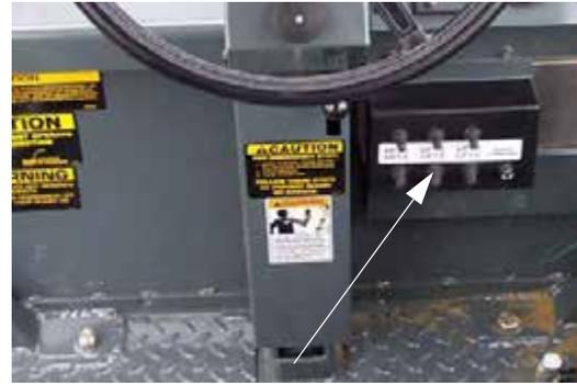
Boutons de contrôle de la profondeur
