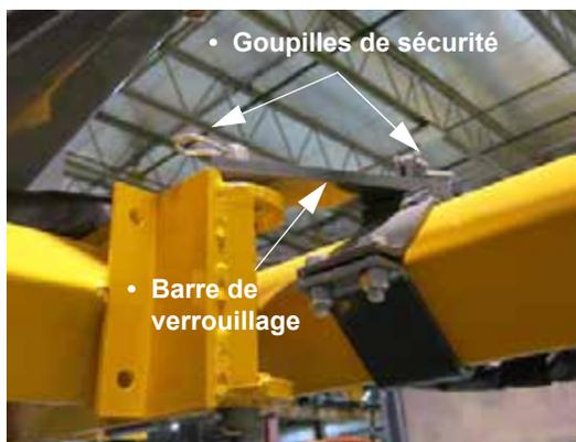
Assemblage goupille de sécurité-barre de verrouillage
