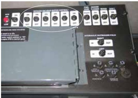
Interrupteurs de commande de moteurs de têtes de castration du maïs (situé sur le montant droit)
