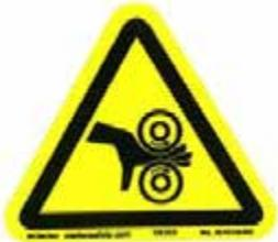
Avertit l'opérateur du risque de blessure par les pneus en rotation. Ne jamais tenter d'effectuer une opération d'entretien ou de maintenance quelconque, que ce soit sur les arracheuses tandis qu'elles sont en rotation. Ne jamais tenter de déloger avec la main un objet coincé dans les arracheuses.
