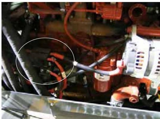
Disjoncteur et fusibles des faisceaux de fils
