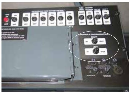
Boutons de repliement hydraulique des rampes
