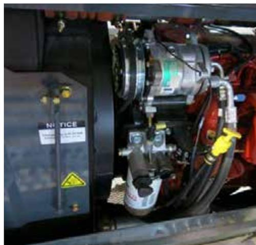
Orifice de remplissage de réfrigérant
