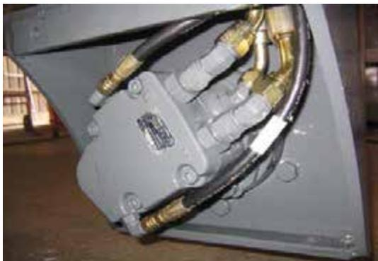
Moteurs des roues avant et arrière gauche
