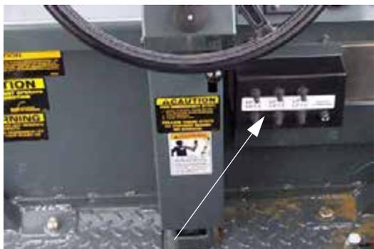
Boutons de contrôle de la profondeur
