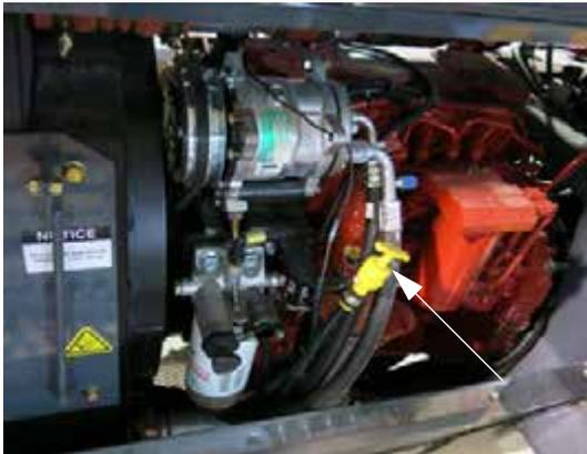
Jauge de niveau d'huile moteur (située sur le côté gauche du moteur - ouvrir le capot du moteur pour y accéder)
