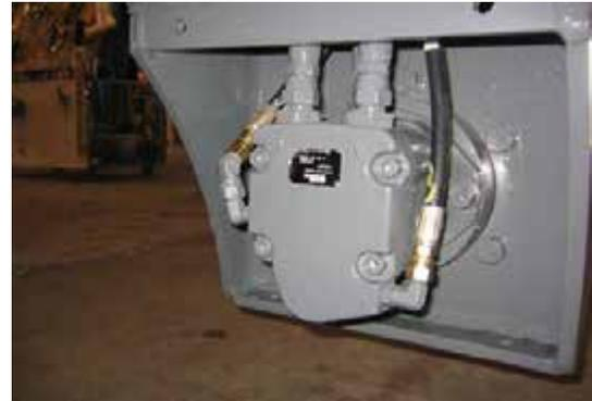
Moteur de roue arrière droit (avec capteur)
