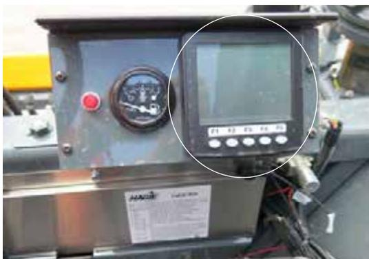
Écran de surveillance du moteur CANtrak (situé à l'avant du poste de conduite)
