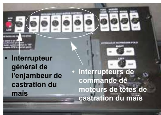
Interrupteur général de l'enjambeur de castration du maïs et boutons de gestion des moteurs des têtes de castration du maïs
