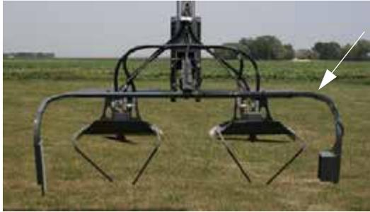
Système LS pour contrôle de la profondeur
