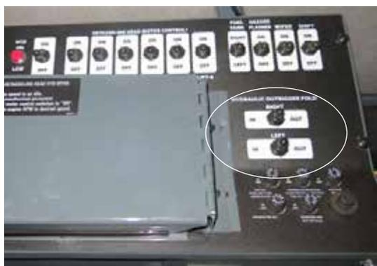
Boutons de repliement hydraulique des rampes
