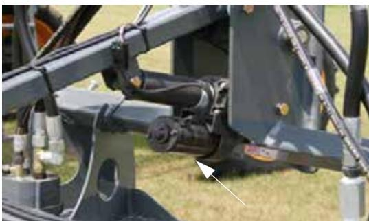
Actionneur de contrôle de la profondeur
