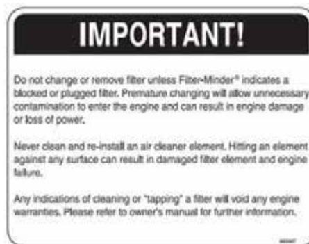
Ne pas modifier ou retirer le filtre, sauf si Filter Minder indique que le filtre est bouché ou obstrué. Changer le filtre prématurément risque d'entraîner une contamination superflue du moteur et peut entraîner des dommages au moteur et (ou) une perte de puissance.
