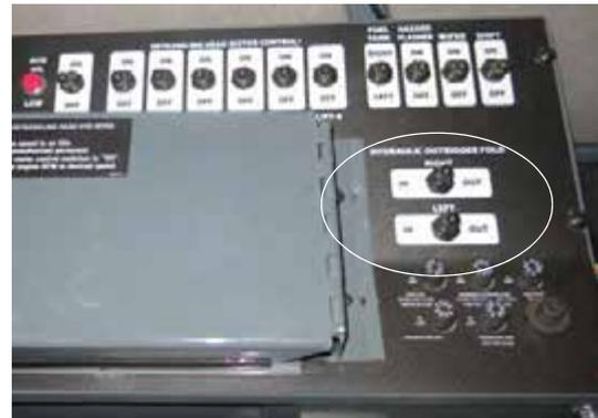
Boutons de repliement hydraulique des rampes (situés sur le montant droit)
