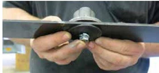
Assemblage d'une lame de coupe
