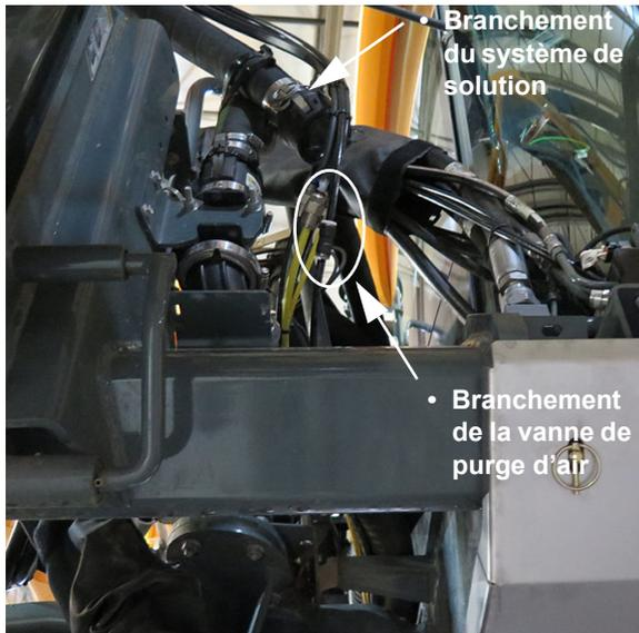
Branchements du système de solution et de la vanne de purge d'air - **Standard** (situé sur le côté avant droit de la machine)
