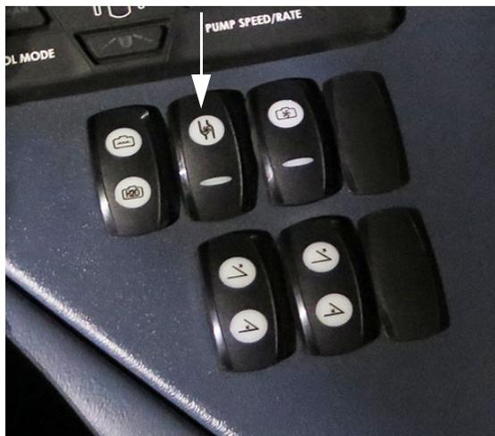
Interrupteur de la pompe à solution -
