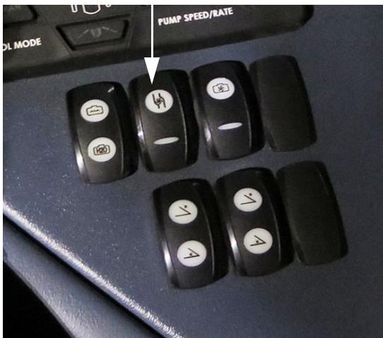
Interrupteur de la pompe à solution
