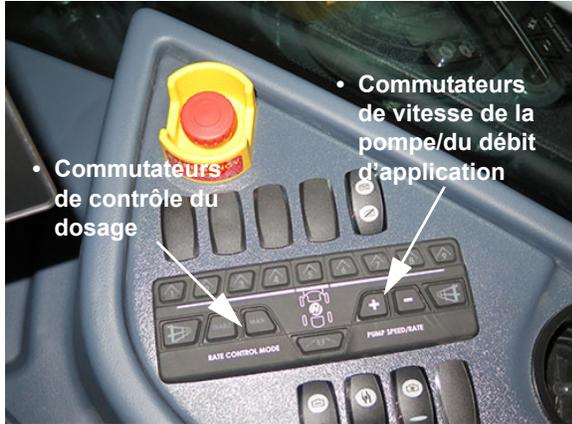
Commutateurs de contrôle du dosage et de vitesse/de débit de la pompe (situés sur la console latérale)
