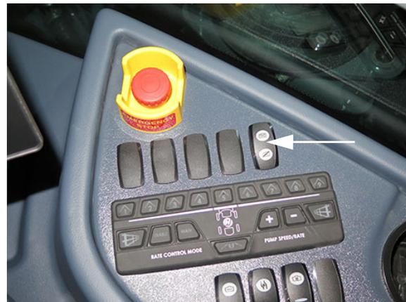
Interrupteur de rinçage du réservoir
