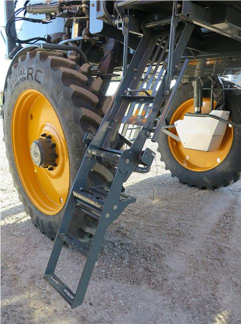
Échelle de remplissage de carburant
