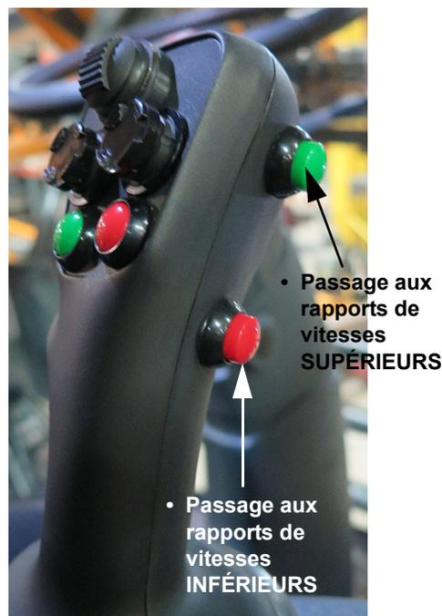
Commutateurs de passage aux rapports de vitesses supérieurs/inférieurs (situés sur le côté du levier de vitesse de la transmission hydrostatique)
