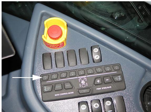
Interrupteurs des vannes
