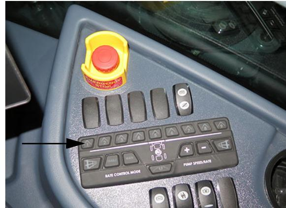
Interrupteurs des vannes
