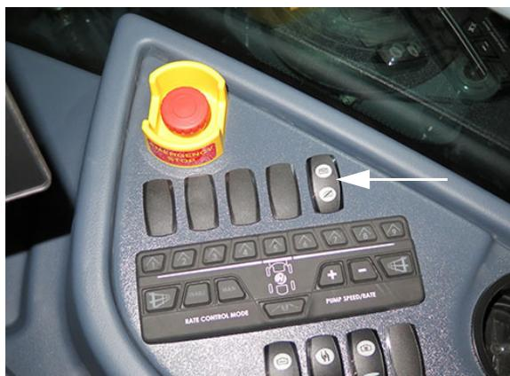
Interrupteur de rinçage du réservoir
