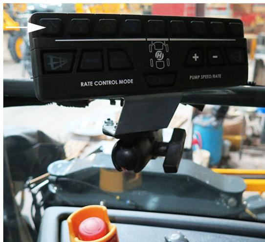
Interrupteurs des vannes
