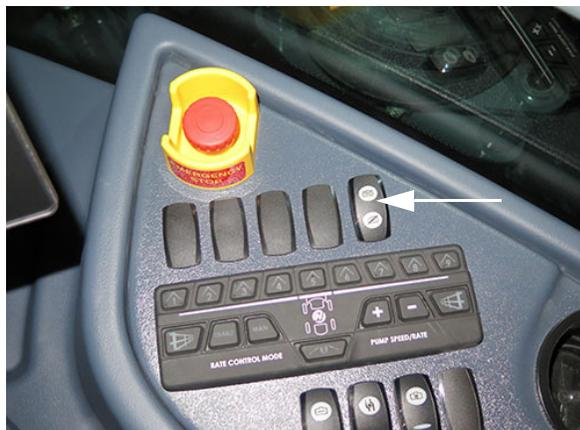
Interrupteur de rinçage du réservoir
