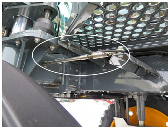
Capteur de réglage de largeur des roues (4)
