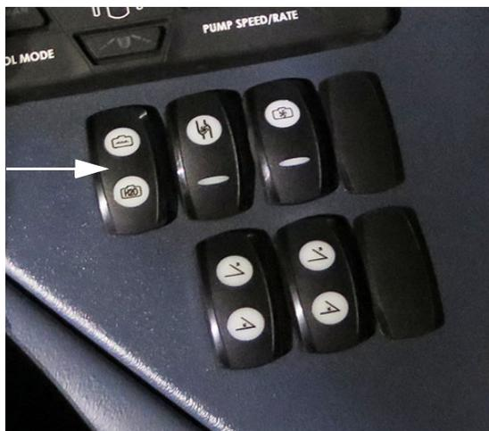
Commutateur de sélection des vannes des réservoirs
