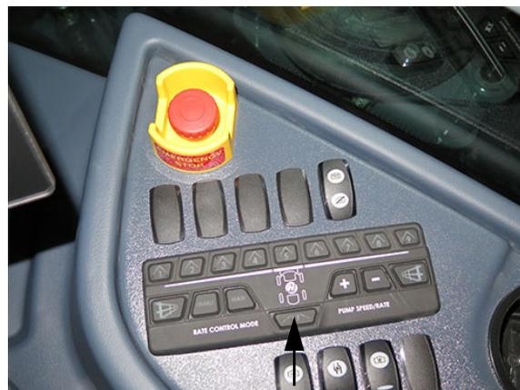
Interrupteur des buses arrière
