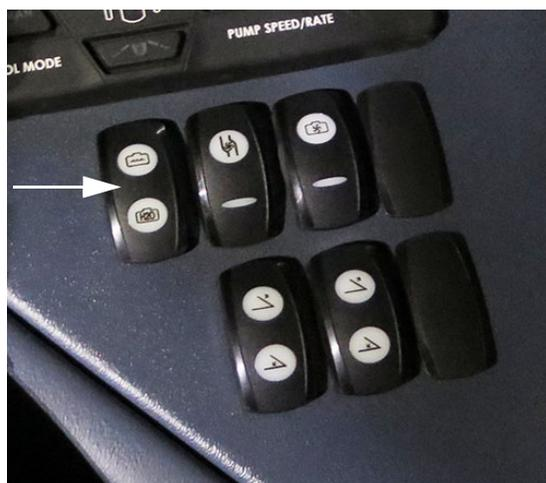
Commutateur de sélection des vannes des réservoirs (situé sur la console latérale)
