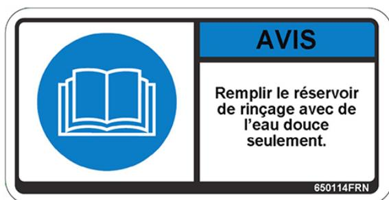
*REMARQUE : capacité du réservoir de rinçage = 378 litres (100 gallons US).*
