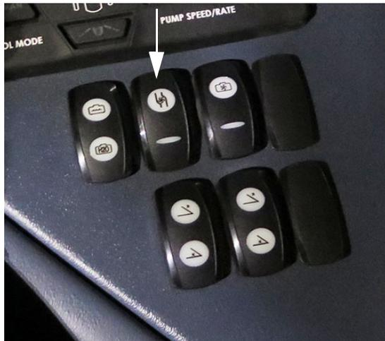
Interrupteur de la pompe à solution
