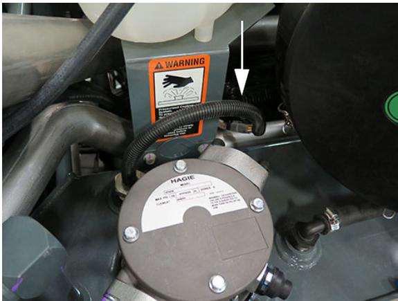
**Capteur de niveau / température**
