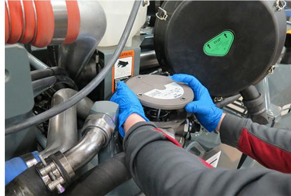
Remplissage du réservoir par le haut du boîtier du filtre de retour hydraulique
