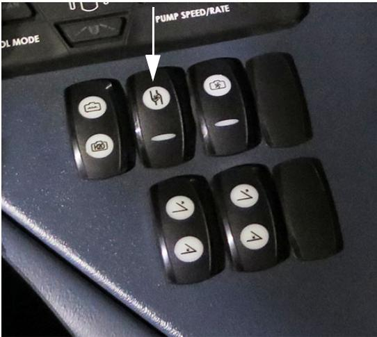
Interrupteur de la pompe à solution
