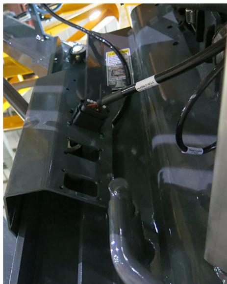
Branchement du système NORAC (situé sur le côté avant droit de la machine)
