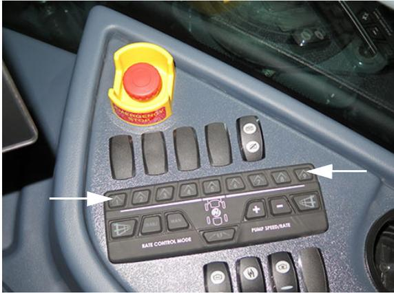
Interrupteurs des vannes de solution
