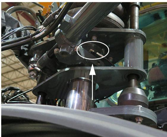
Embout de graissage de la bague (4)
