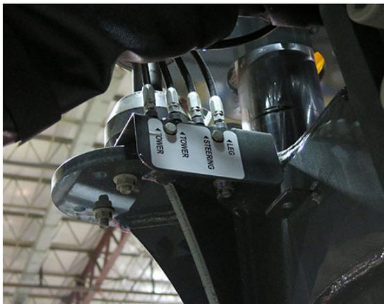
Bloc d'embouts de graissage (4)
