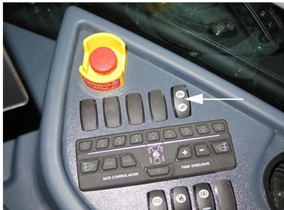
Interrupteur de rinçage du réservoir
