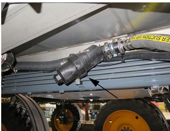
Crépine de la conduite de solution (située en dessous de la partie centrale, du côté droit de la machine)
