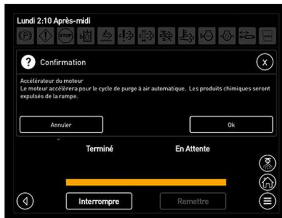
Confirmation que le régime moteur va augmenter pendant le cycle de purge par air automatique et que des produits chimiques seront expulsés de la rampe
