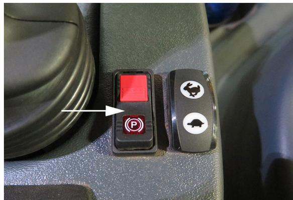
Interrupteur du frein de stationnement (situé près du levier de vitesse de la transmission hydrostatique)
