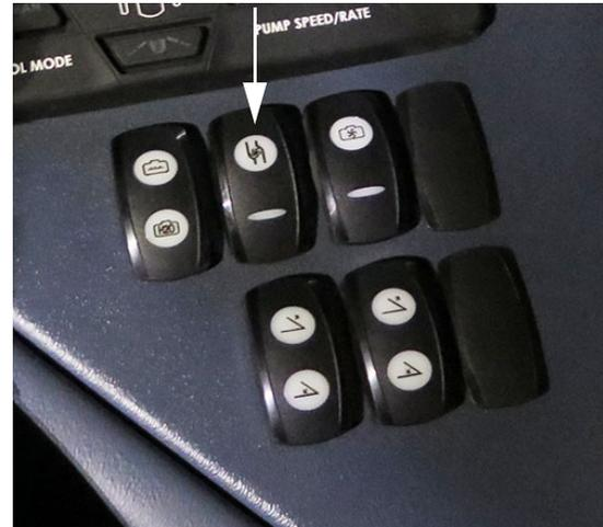
Interrupteur de la pompe à solution (situé sur la console latérale)
