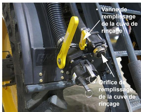
Dispositif de remplissage par l'arrière (situé derrière la roue arrière gauche)
