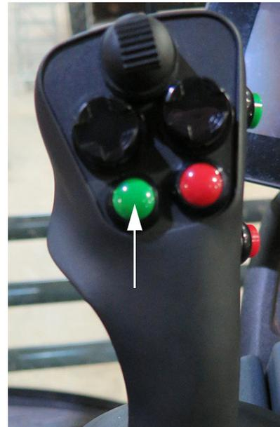
Interrupteur du pulvérisateur principal (situé sur le levier de vitesse de la transmission hydrostatique)
