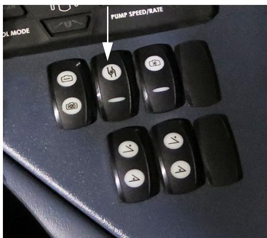
Interrupteur de la pompe à solution
