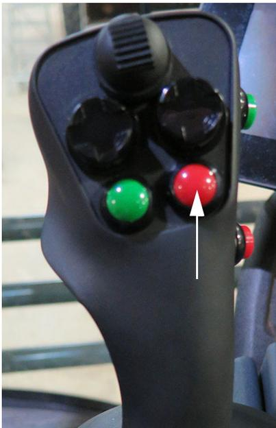
Commutateur de gestion des tournières (situés sur le levier de commande de l'entraînement hydrostatique)
