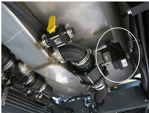
Vanne du réservoir de solution
