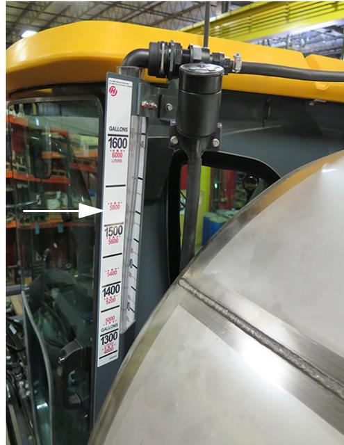
Jauge de niveau du réservoir de solution
