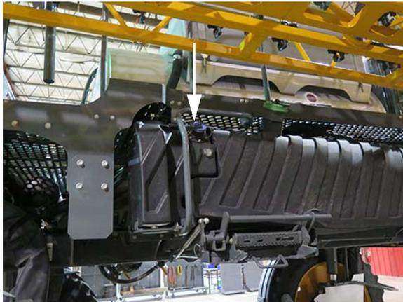
Bouchon de remplissage de l'AUS 32
