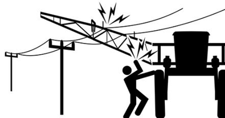
Par mesure de sécurité, un message d'avertissement concernant les lignes électriques à haute tension apparaît sur l'afficheur de la machine avant de déployer les extensions des rampes. Pour continuer, appuyer sur **ACKNOWLEDGE** (Confirmer) pour confirmer qu'il n'y a pas de lignes électriques aériennes ou d'obstacles.
