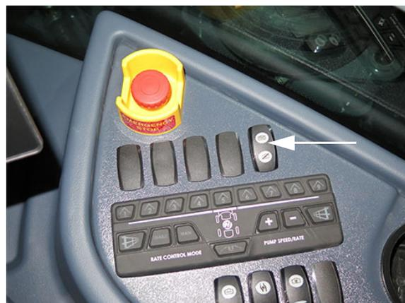
Interrupteur de rinçage du réservoir (situé sur la console latérale)
