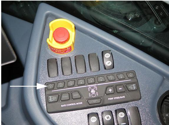
Interrupteurs des vannes de solution de la rampe (situés sur la console latérale)
