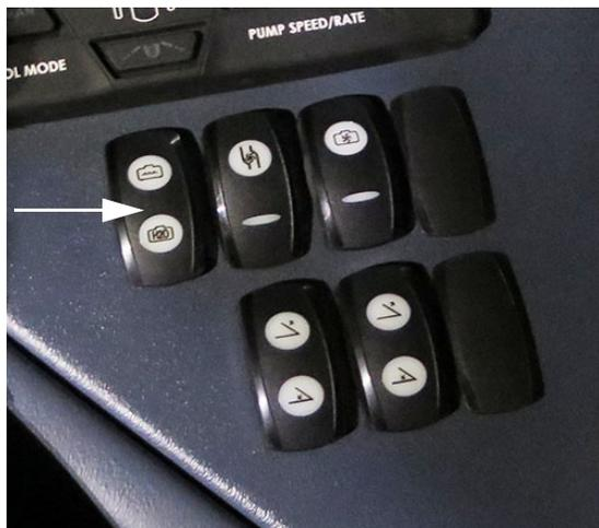
Commutateur de sélection des vannes des réservoirs (situé sur la console latérale)
