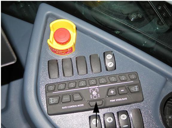
Interrupteur des buses arrière
