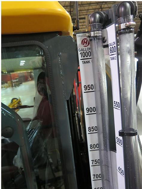
Double jauge de niveau du réservoir de solution (située derrière la partie arrière gauche de la cabine)
