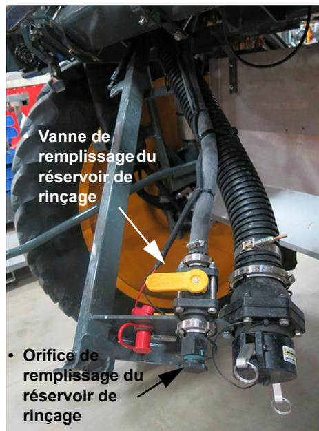
Dispositif de remplissage par l'avant (illustré en position abaissée)
