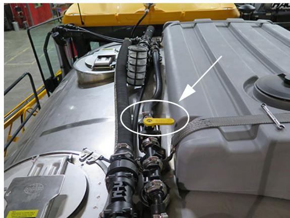
Vanne de rinçage deux produits (située sur le haut du réservoir de solution)
