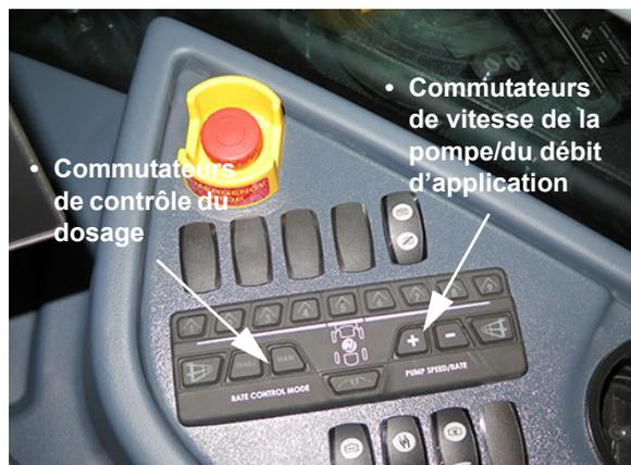
Commutateurs de contrôle du dosage et Commutateurs de vitesse de la pompe/du débit d'application (situés sur la console latérale)
