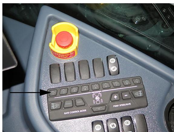
Interrupteurs des vannes
