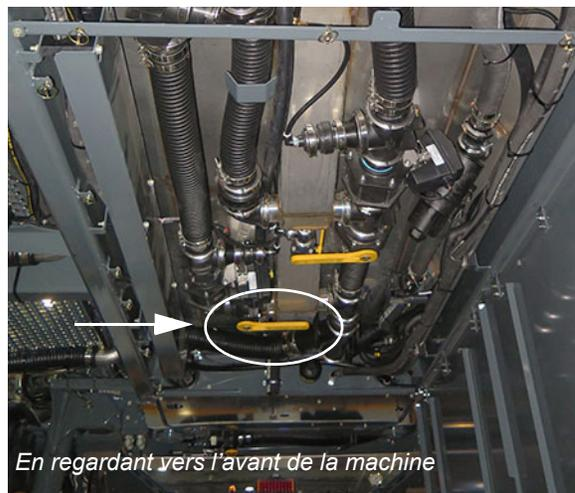
Vanne d'arrêt manuelle du réservoir 1
