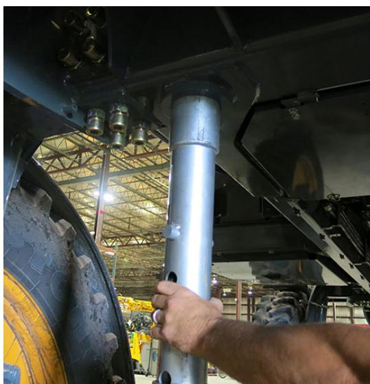
Insérez le cric dans l'anneau de rétention du point de levage
