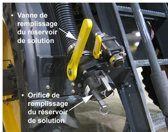
Dispositif de remplissage par l'arrière (situé derrière la roue arrière gauche)
