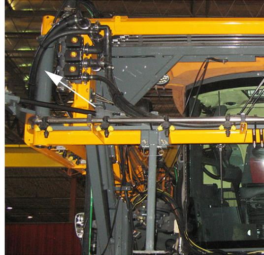
Tube de pivotement de la traverse
