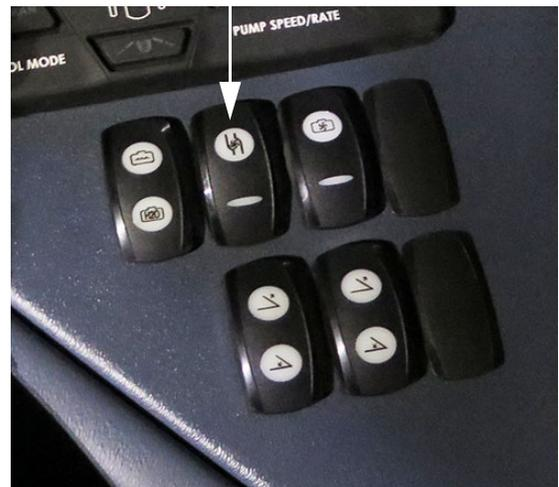
Interrupteur de la pompe à solution
