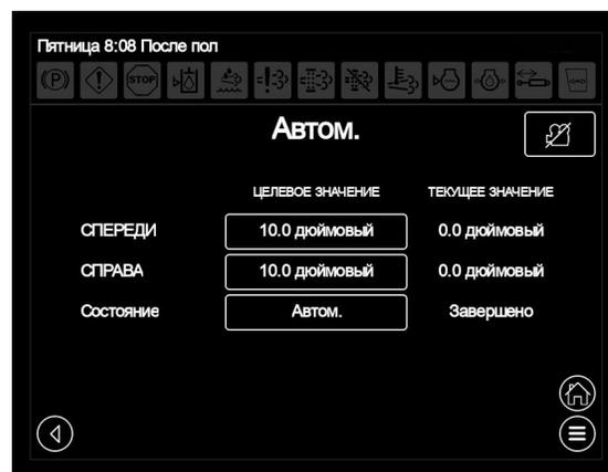
Экран Автоматическая регулировка колеи
