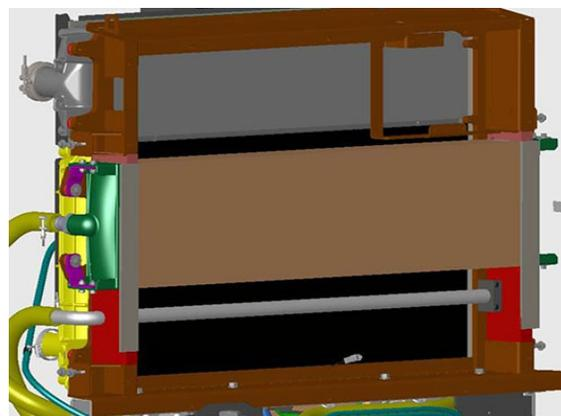
Охладитель масла – **Одиночный** (находится спереди двигателя – снимите экран радиатора для доступа) - стандартный вид
