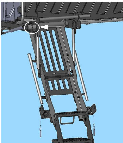
Масленка Зерка оси газовой пружины (находится рядом с верхней левой частью лестницы)
