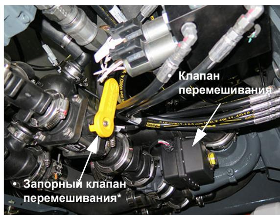
Клапан перемешивания и Запорный клапан перемешивания (находятся под задней частью машины) - стандартный вид
