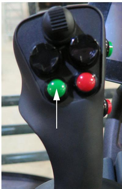
Главный выключатель опрыскивателя (находится на Рукоятке управления гидростатической передачей) - стандартный вид
