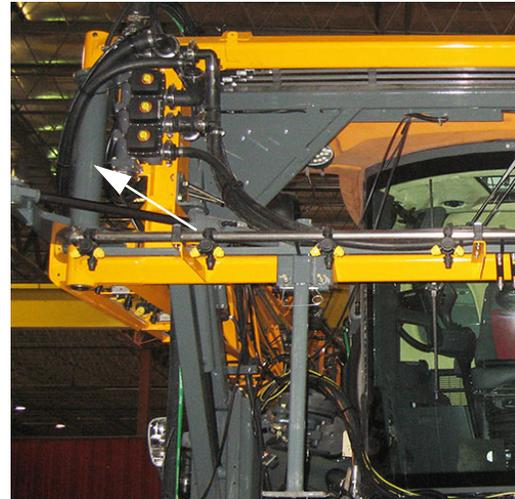
цилиндрический шарнир поперечины
