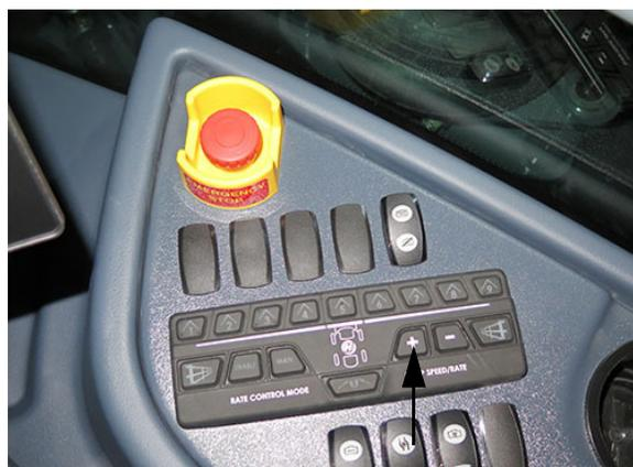
«+» Переключатель частоты вращения/расхода насоса (расположен на боковой панели) - стандартный вид
