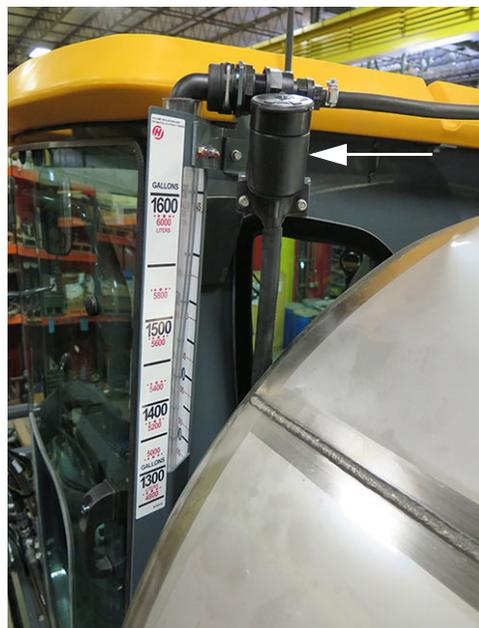
Емкость для жидкости омывателя ветрового стекла (расположена позади левой стороны кабины) - стандартный вид
