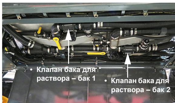
Клапаны бака для раствора – для Бакв 1 и 2 (находятся под баком для раствора на нижней стороне машины) - стандартный вид
