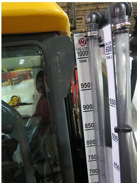
Смотровой указатель бака для раствора системы двойного действия (расположен за задней левой стороной кабины) - стандартный вид
