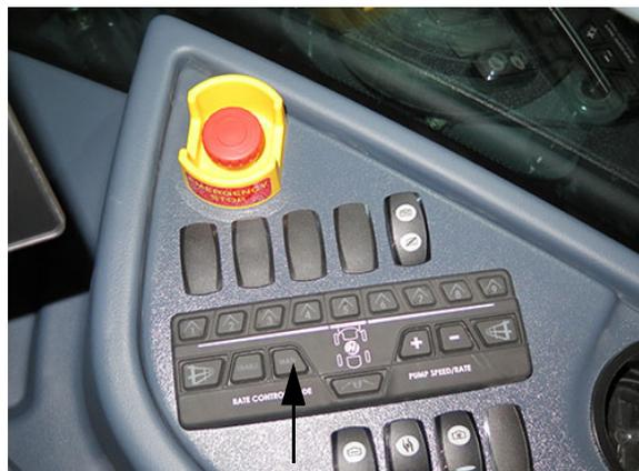
Ручной «MAN» переключатель регулятора расхода (расположен на боковой панели) - стандартный вид
