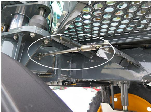
Датчик регулировки колеи (4)
