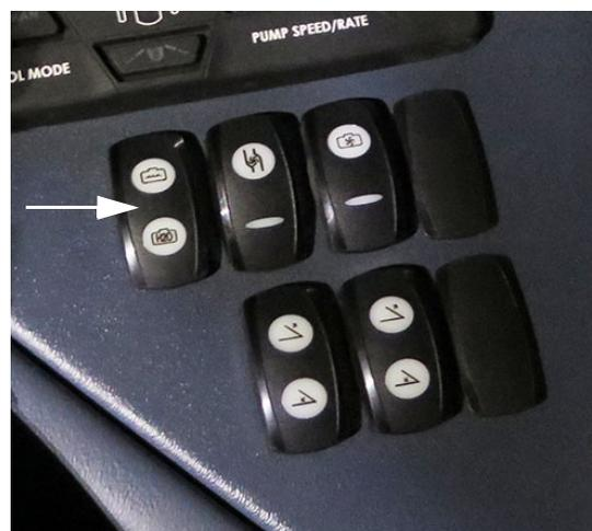
Переключатель селекторного клапана бака (находится на боковой панели) - стандартный вид
