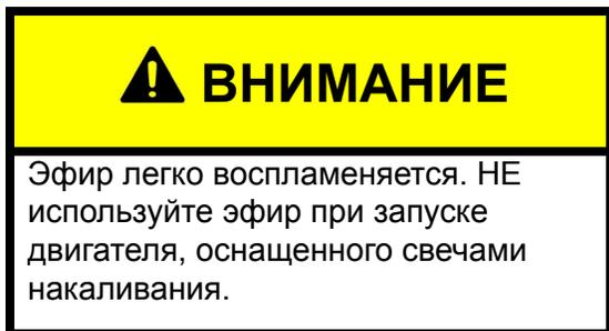
1. Поверните ключ зажигания во Включенное (ON) положение, но НЕ нажимайте на стартер. **(Ждите, пока индикатор Свечи накаливания активны не погаснет на Дисплее машины).** Следующее предупредительное сообщение появится на Дисплее машины при холодной погоде. Нажмите ОК (подтверждаете понимание того, что двигатель требует времени для прогрева перед включением стартера).
