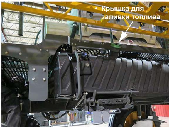
Патрубок для моторного топлива (расположен за топливным баком с правой стороны машины)
