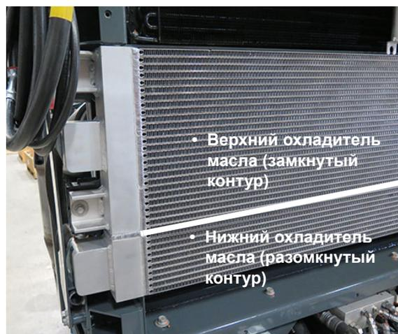
Охладитель масла – **Двойной** (находится спереди двигателя – снимите экран радиатора для доступа) - стандартный вид
