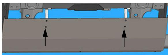
Узел монтажных шарниров/шплинтов
