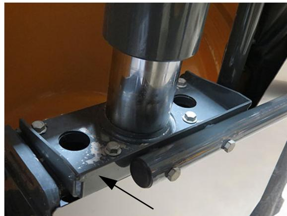
Установочная плита делителя жатки
