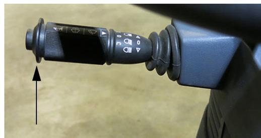
Кнопка омывателя ветрового стекла (расположен на конце рукоятки сигнала поворота) - стандартный вид
