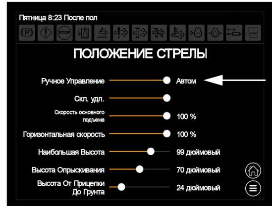
Режим Ручного/Автоматического управления (находится на экране Состояние штанги)
