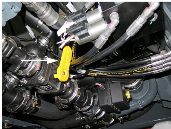
Запорный клапан перемешивания (находится под задней частью машины) - стандартный вид
