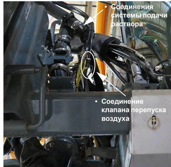
Соединения Системы подачи раствора и Клапана перепуска воздуха -
