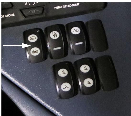
Переключатель селекторного клапана бака
