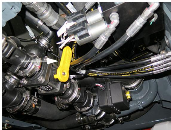
Запорный клапан перемешивания (находится под задней частью машины) - стандартный вид
