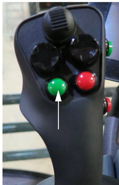
Главный выключатель опрыскивателя (находится на Рукоятке управления гидростатической передачей)
