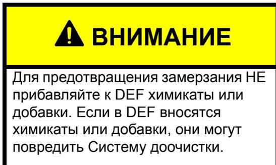
Температура замерзания DEF - около 12°F (-11°C). Система DEF, установленная на машине, спроектирована с учетом этого и не требует вмешательства оператора.
