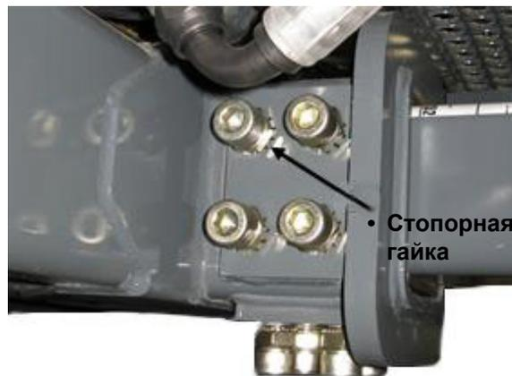
Опорные болты регулировки ширины колеи – Нижний/Боковой (расположены на каждой опоре) - стандартный вид
