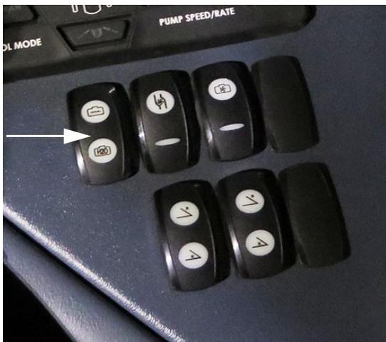
Переключатель селекторного клапана бака
