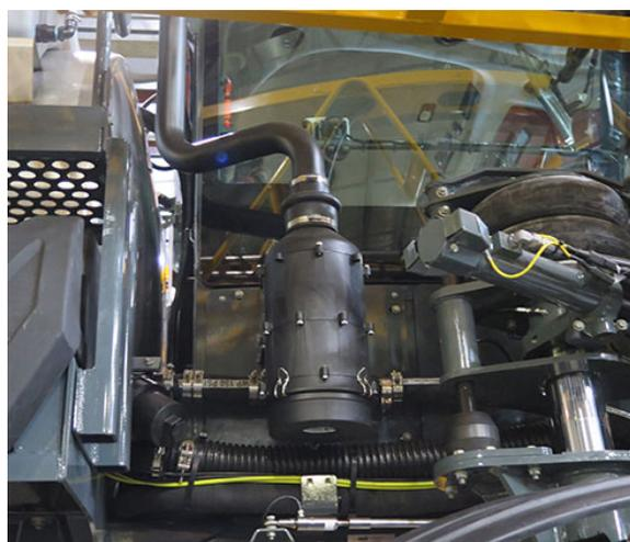
Система фильтрации кабины
