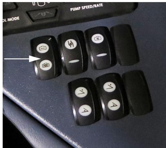
Переключатель селекторного клапана бака
