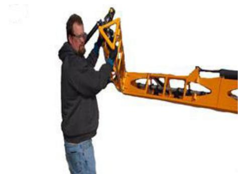
3. Закрепите на месте с помощью заднего Закрепляющего болта.
