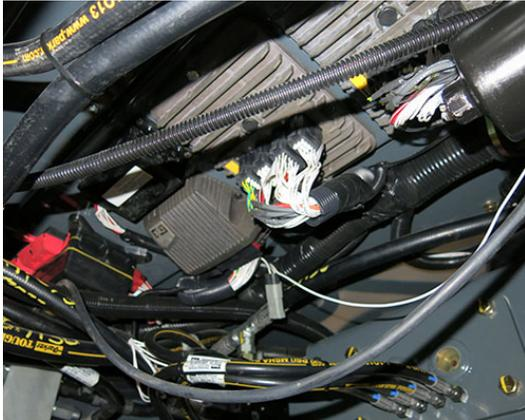
Автоматические выключатели и плавкие предохранители (внешние) (расположены под кабиной, снимите крышку для получения доступа)
