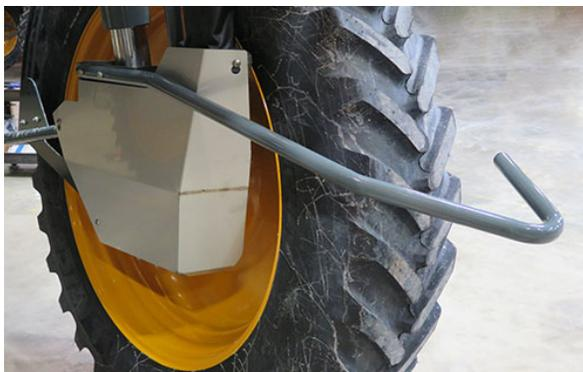
Установленный Делитель жатки
