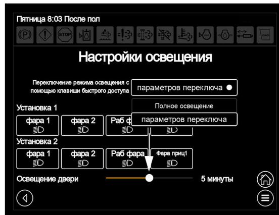
Бегунок таймера освещения выхода из машины
