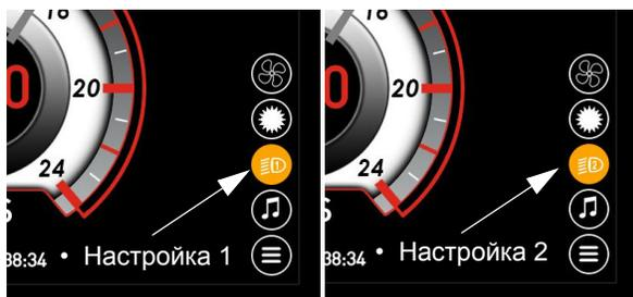
Кнопка быстрого доступа Освещение –
