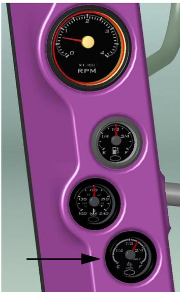
Датчик уровня жидкости для дизельного выхлопа (DEF) (находится на передней стойке кабины) - стандартный вид
