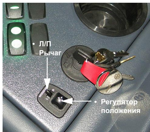
Выключатель зеркала с электроприводом
