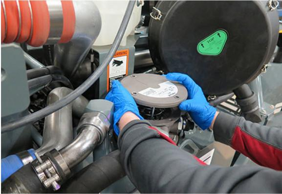
Заполнение через обратный жидкостный фильтр корпус фильтра - стандартный вид
