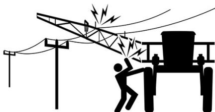
В качестве меры предосторожности, перед выдвиганием удлинителей штанг на дисплее машины появится предупреждение о линии электропередачи (Power Line). Перед продолжением нажмите на кнопку подтверждения (ACKNOWLEDGE) в знак того, что вы подтверждаете отсутствие воздушных линий электропередачи или препятствий.
