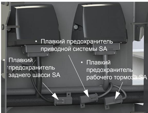
Плавкие предохранители задних датчиков
