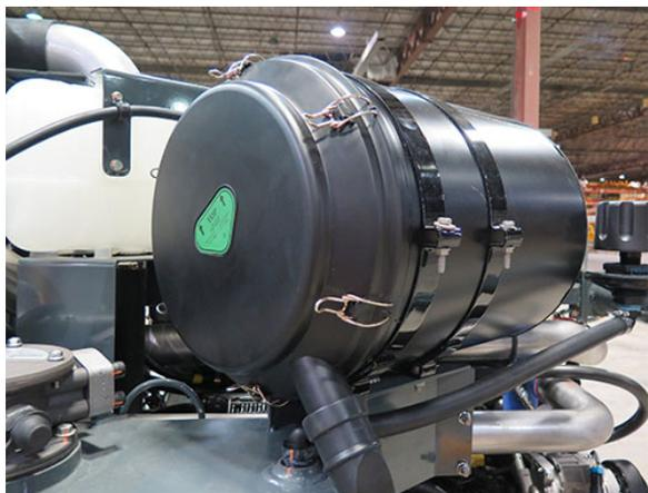
Фильтр впуска воздуха в двигатель
