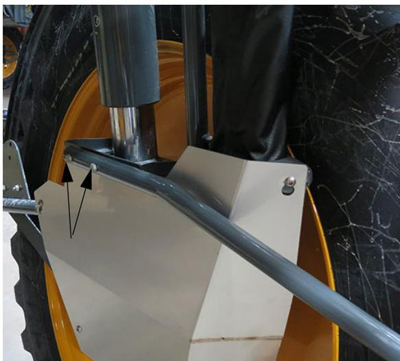
Монтажные болты делителя жатки (2)
