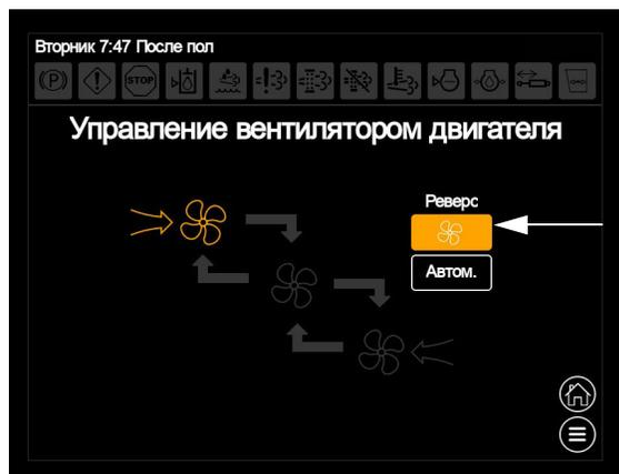
Кнопка Реверсивный вентилятор (находится на экране Управление вентилятором двигателя)
