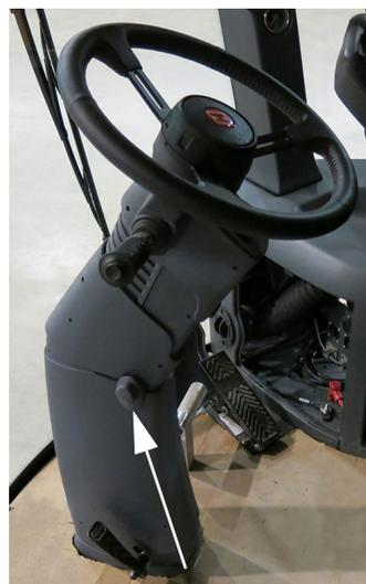
Кнопка регулировки угла наклона рулевой колонки (находящаяся слева на рулевой колонке)
