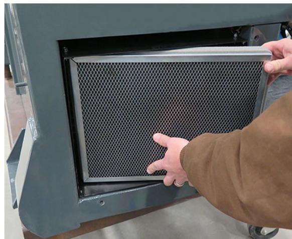
Угольный фильтр (расположен за эксплуатационной панелью наружной обшивки с правой стороны кабины) - стандартный вид
