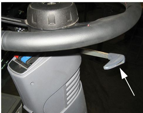
Рукоятка регулировки телескопического рулевого колеса (находящаяся справа на рулевой колонке)
