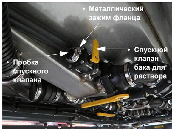
Узел спускного клапана бака для раствора
