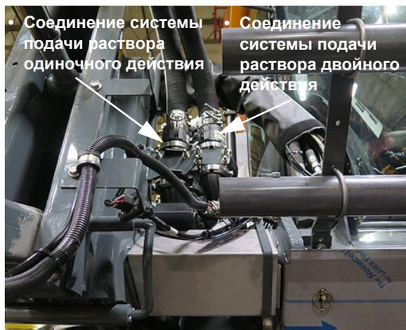
Соединения системы подачи раствора – **Одиночного/Двойного действия** (находятся в передней правой части машины) – стандартный вид
