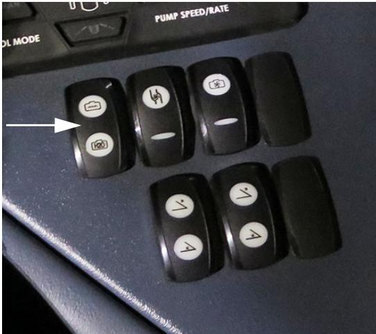
Переключатель селекторного клапана бака (расположен на боковой панели) - стандартный вид
