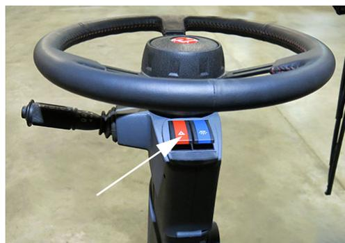
Переключатель сигнальных ламп поворотов и аварийных сигналов (расположенный на рулевой колонке)
