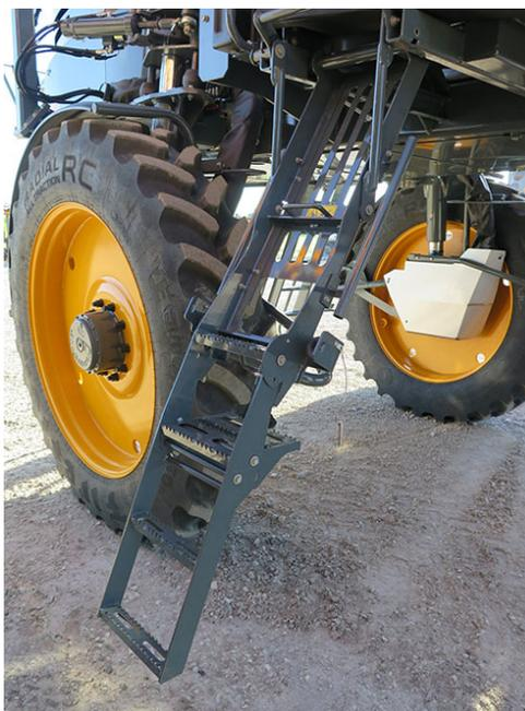
Лестница для заправки топливного бака
