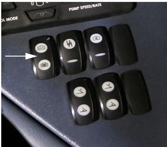
Переключатель селекторного клапана бака
