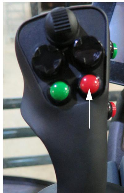
Переключатель управления конечным рядом (находится на Рукоятке управления гидростатической передачей) - стандартный вид
