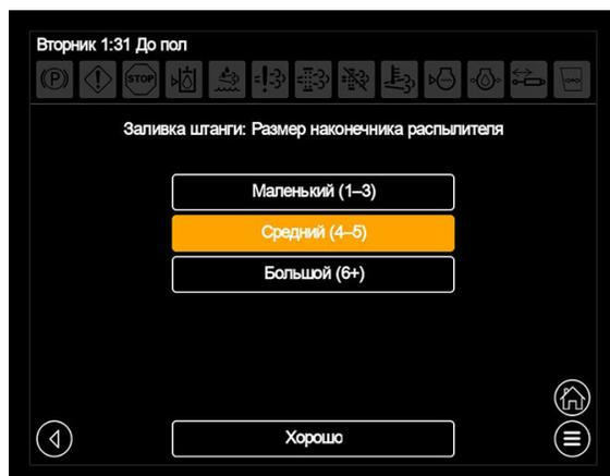
Экран Заливка штанги: размер наконечника распылителя
