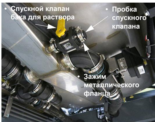
Спускной клапан бака для раствора в сборе (расположен под баком для раствора снизу машины) - стандартный вид
