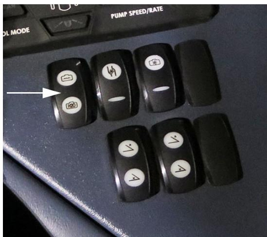
Переключатель селекторного клапана бака
