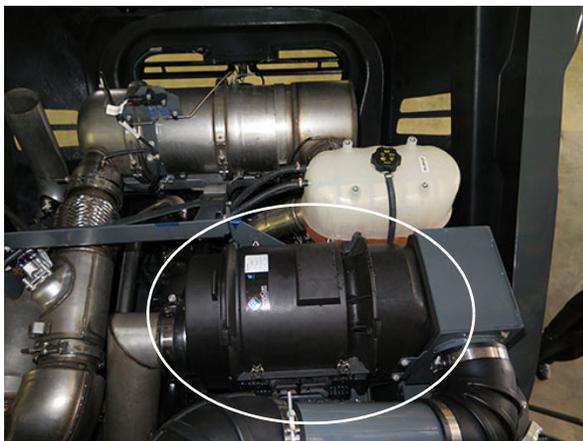
Фильтр впуска воздуха в двигатель
