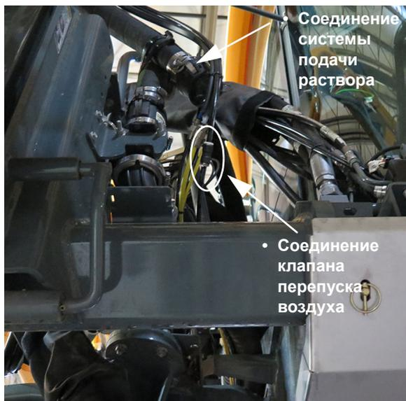
Соединения Системы подачи раствора и Клапана перепуска воздуха – **стандартные** (расположен спереди на правой стороне машины) – стандартный вид
