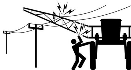
В качестве меры предосторожности, перед выдвиганием внешних удлинений штанг на дисплее машины появится предупреждение о линии электропередачи (Power Line). Перед продолжением нажмите кнопку подтверждения (ACKNOWLEDGE) в знак того, что вы подтверждаете отсутствие воздушных линий электропередачи или препятствий.
