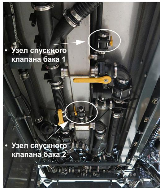
Узлы спускных клапанов бака для раствора (2)
