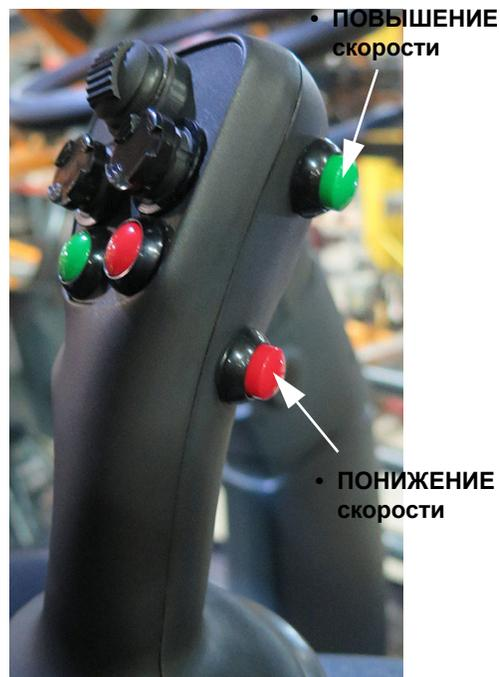
Переключатели Shift Up и Shift Down (расположены сбоку Рукоятки управления гидростатической передачей) - стандартный вид
