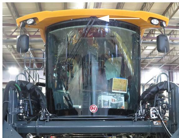
Спринклер жидкости омывателя ветрового стекла (расположен возле верха снаружи кабины)
