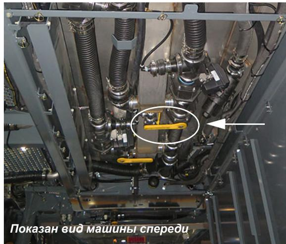
Отсечный клапан системы двойного действия
