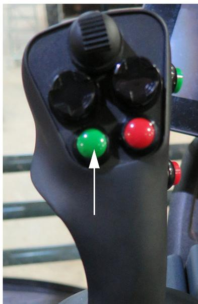
Главный выключатель опрыскивателя (находится на Рукоятке управления гидростатической передачей) - стандартный вид
