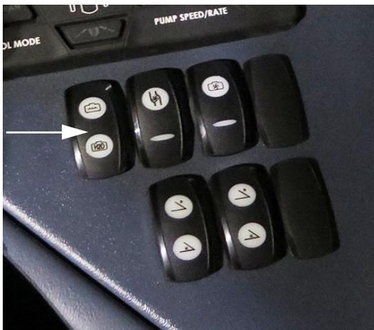
Переключатель селекторного клапана бака
