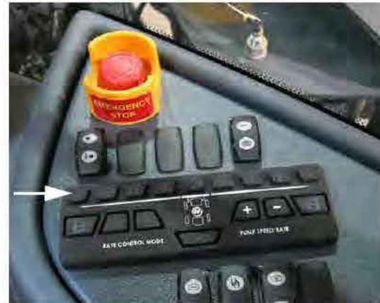
Interrupteurs des vannes de solution de la rampe (situés sur la console latérale)
