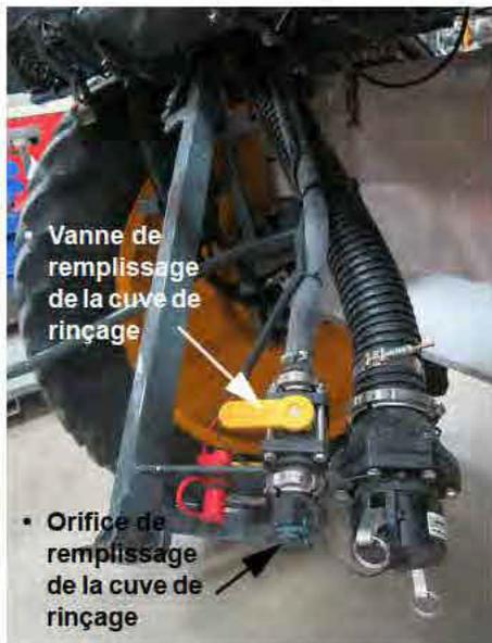
Dispositif de remplissage par l'avant
