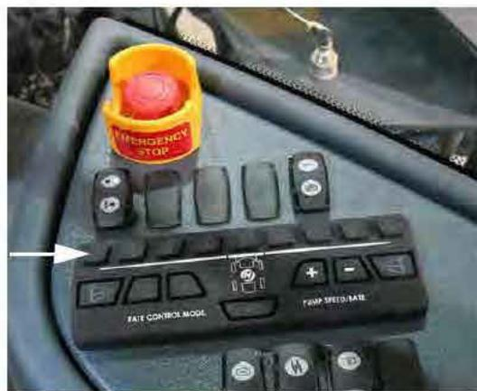
Interrupteurs des vannes
