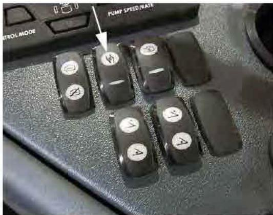
Interrupteur de la pompe à solution
