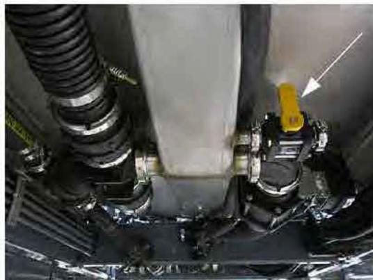
Vanne de vidange du réservoir de solution
