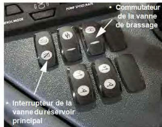
Commutateurs de la vanne du réservoir principal et de la vanne de brassage
