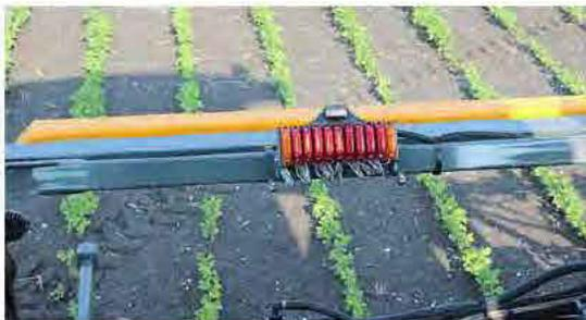
Indicateurs des vannes de solution de la rampe (montés sur la traverse)
