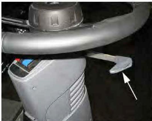
Poignée de réglage de la colonne de direction télescopique (située sur le côté droit de la colonne de direction)
