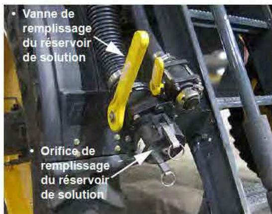
Dispositif de remplissage par l'arrière
