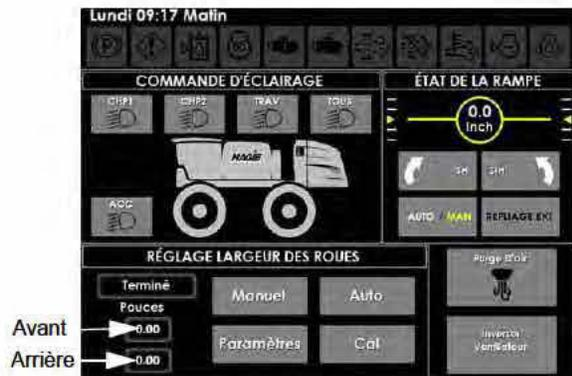
Indicateurs de largeur des roues avant/arrière (situés sur la page Contrôles auxiliaires de l'afficheur de la machine)
