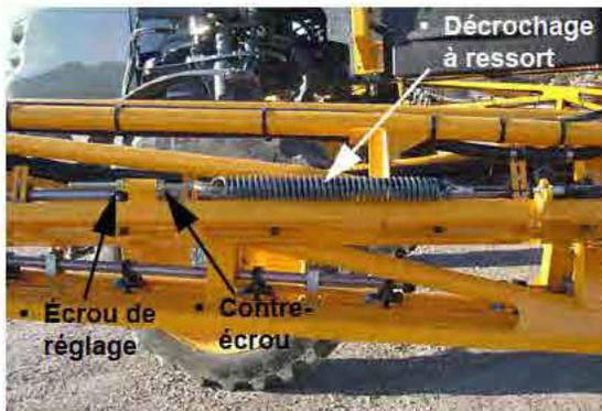
Contre-écrou et écrou de réglage du décrochage à ressort (situés près de l'extrémité extérieure du décrochage à ressort)
