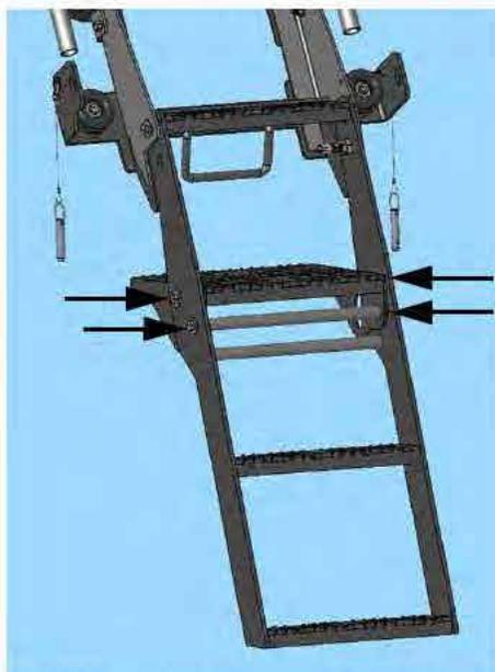
Points de pivotement inférieurs de l'échelle - Plate-forme (4)
