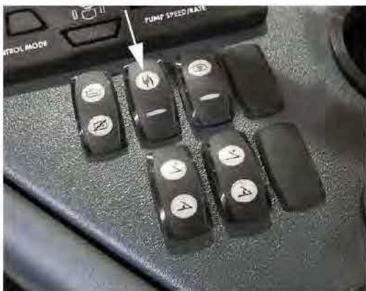
Interrupteur de la pompe à solution
