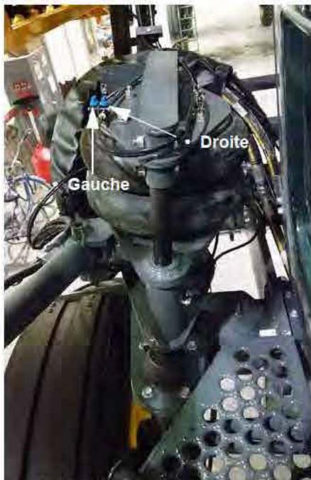
Vannes de la suspension pneumatique (situées sur le côté gauche Des coussins d'air avant et arrière)
