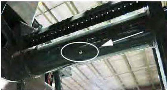
Tube de pivotement de l'échelle
