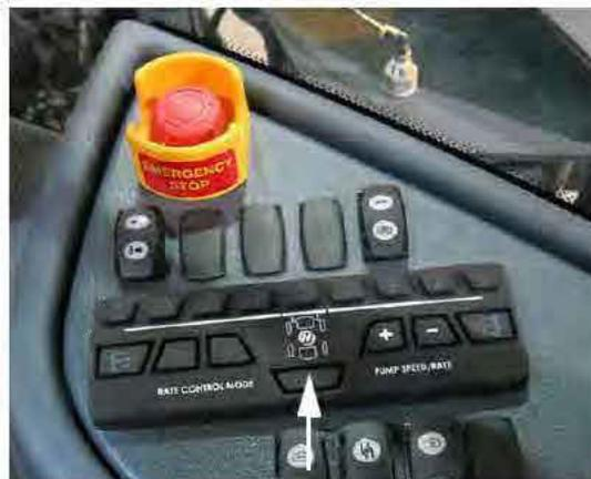
Interrupteur des buses arrière
