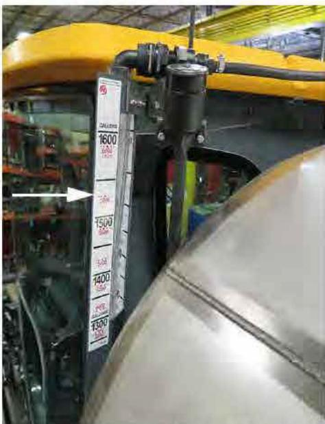
Jauge de niveau du réservoir de solution
