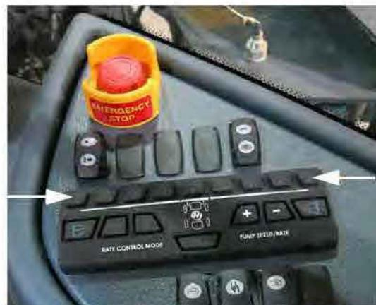
Interrupteurs des vannes de solution de la rampe - Sections 1 et 9
