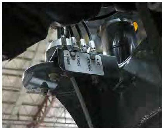
Bloc d'embouts de graissage (4)
