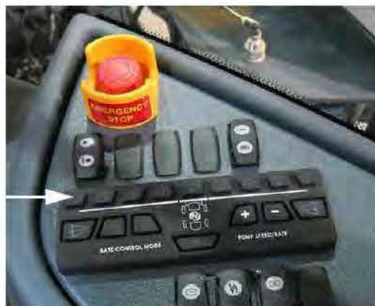
Interrupteurs des vannes de solution de la rampe
