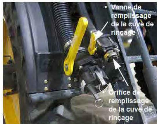
Dispositif de remplissage par l'arrière
