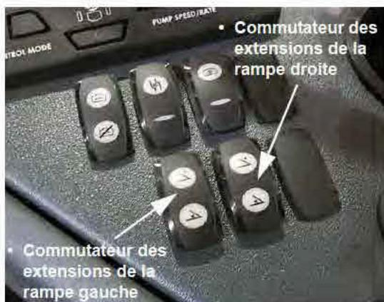
Commutateurs d'extension des rampes droite et gauche (situés sur la console latérale)
