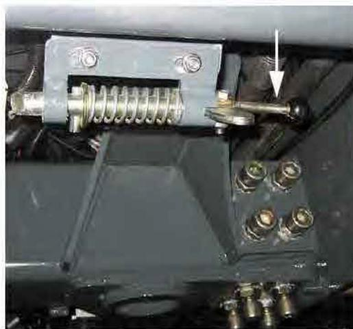
Levier de déblocage pour le remplissage par l'avant (situé sous la partie avant de la machine)
