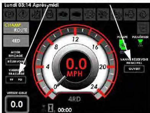
Indicateurs d'état de la vanne du réservoir principal et de la pression de la vanne de brassage (situés sur la page d'accueil de l'afficheur de la machine - mode Champ)
