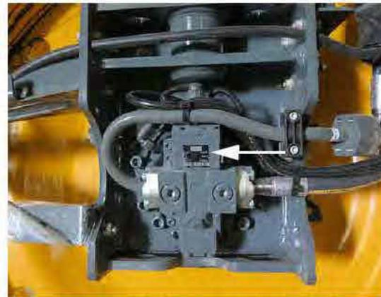
Plaque d'identification d'un moteur de roue
