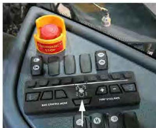
Interrupteur des buses arrière
