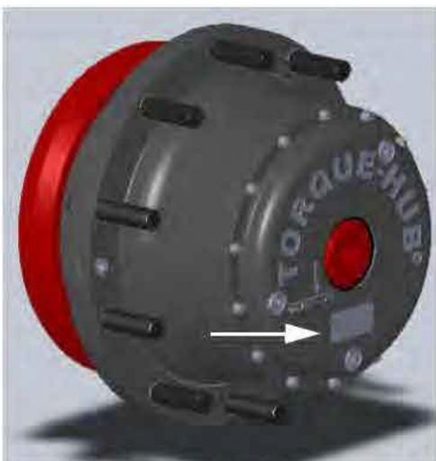
Plaque d'identification d'un moyeu de roue
