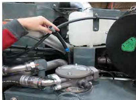
Capteur de niveau / température
