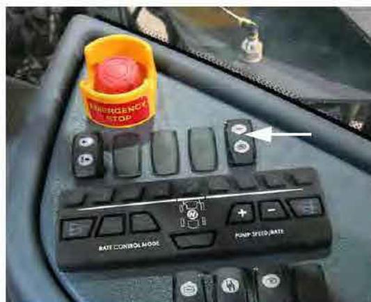
Interrupteur de rinçage
