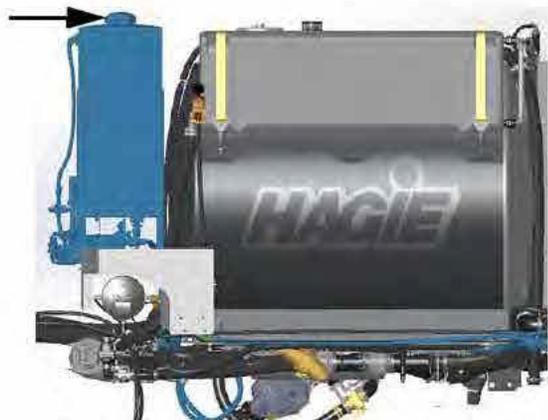
Bouchon de l'orifice de remplissage
