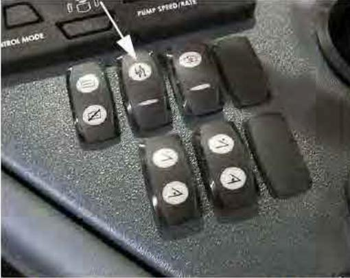
Interrupteur de la pompe à solution
