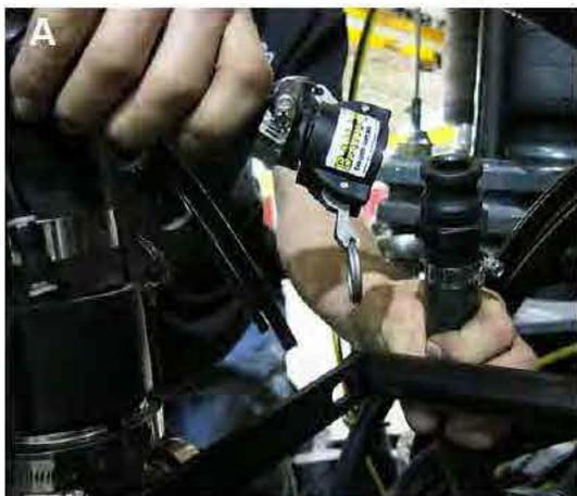
3. Faites tourner la vanne à 3 voies (B) de la rampe (située sur la section de pulvérisation centrale de la rampe avant) pour fournir de la solution à la rampe arrière.
