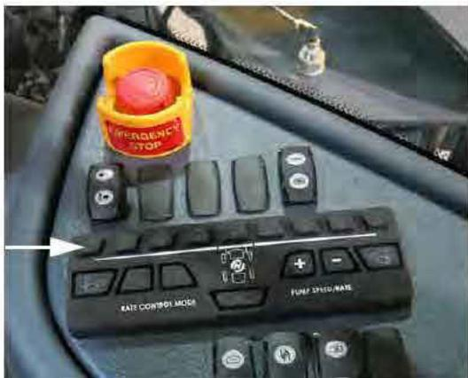
Interrupteurs des vannes de solution de la rampe (situés sur la console latérale)
