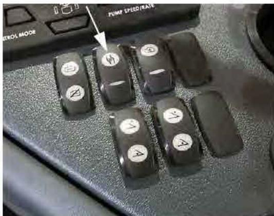
Interrupteur de la pompe à solution
