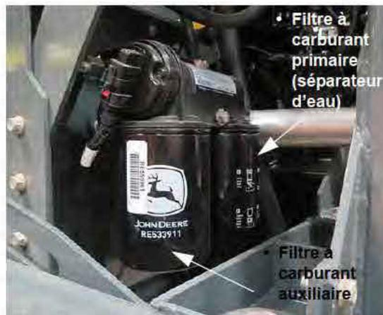
Filtres à carburant principal et auxiliaire
