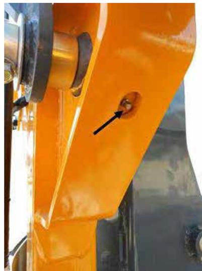
Joints à rotule de la traverse pivotante
