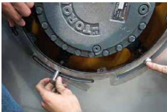
Installation d'un boulon de fixation du flasque de roue
