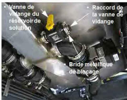
Ensemble de la vanne de vidange du réservoir de solution (situé sous le réservoir de solution sur le dessous de la machine)
