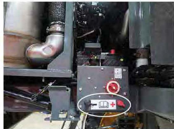
Bornes de charge de la batterie auxiliaire
