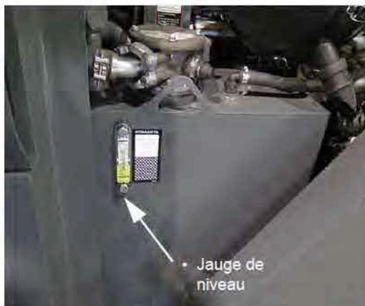
Réservoir d'huile hydraulique
