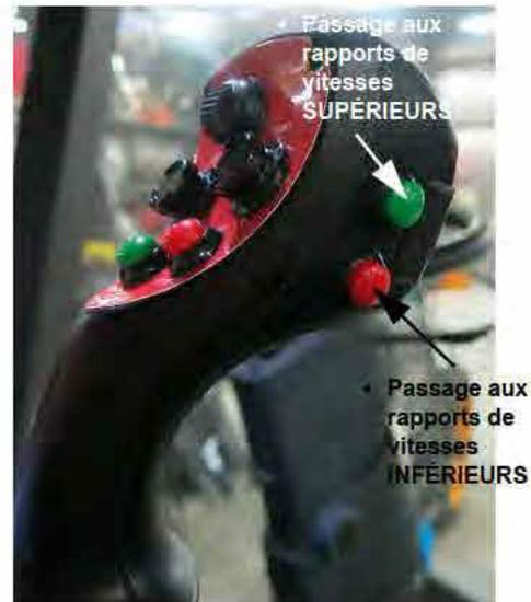
Commutateurs de passage aux rapports de vitesses supérieurs/inférieurs (situés sur le côté du levier de vitesse de la transmission hydrostatique)
