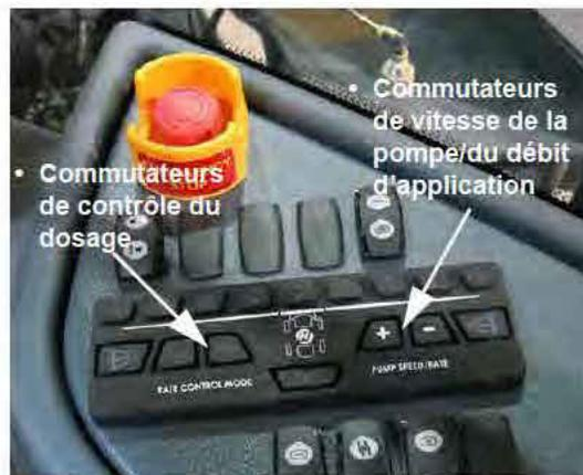
Commutateurs de contrôle du dosage et de vitesse/de débit de la pompe (situés sur la console latérale)
