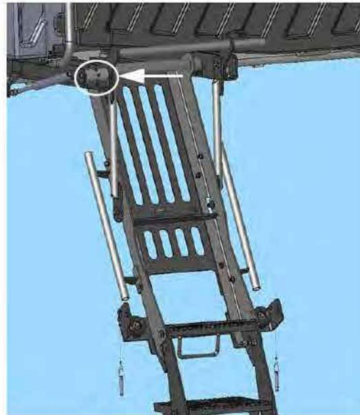
Embout de graissage de la tige du vérin à gaz (située près du côté supérieur gauche de l'échelle)
