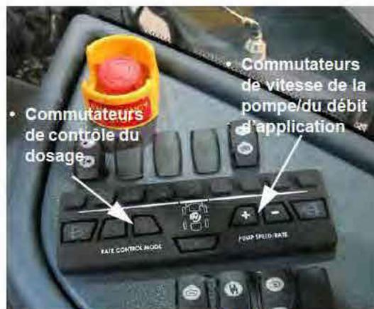
Commutateurs de contrôle du dosage et Commutateurs de vitesse de la pompe/du débit d'application (situés sur la console latérale) - Vue typique
