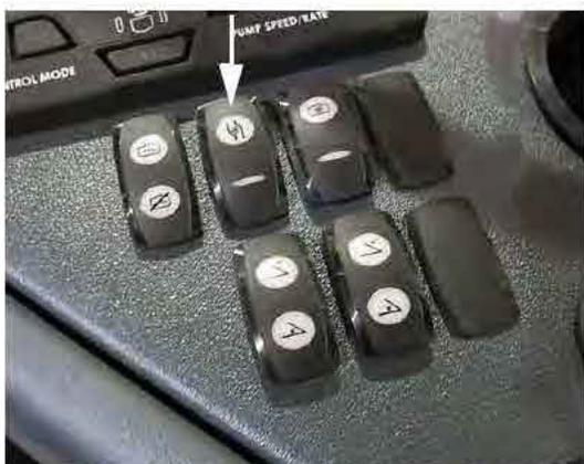
Interrupteur de la pompe à solution
