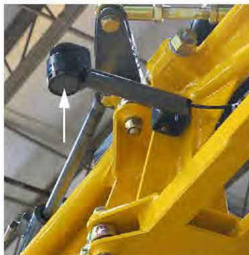
Plaque de mousse d'un capteur NORAC (situées dans la partie inférieure de chaque capteur)
