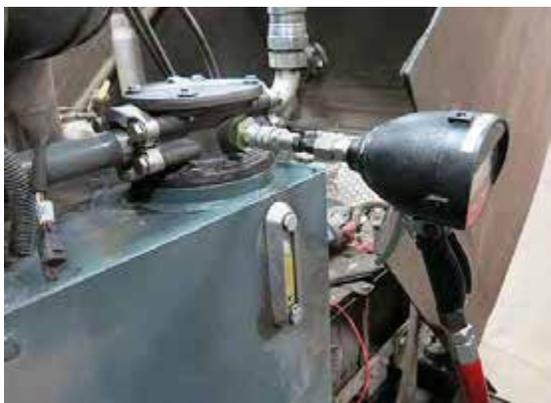
Remplissage du réservoir par l'orifice de remplissage d'huile hydraulique
