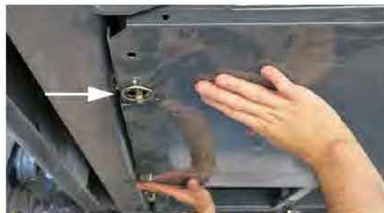
Goupille clip de sécurité (installée sur la goupille percée)
