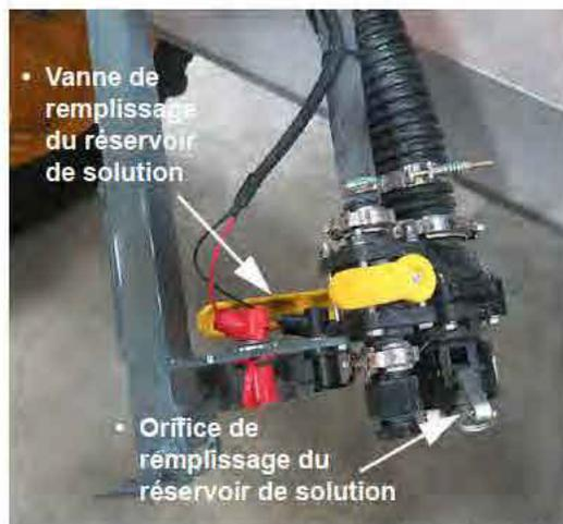
Dispositif de remplissage par l'avant (illustré en position abaissée)
