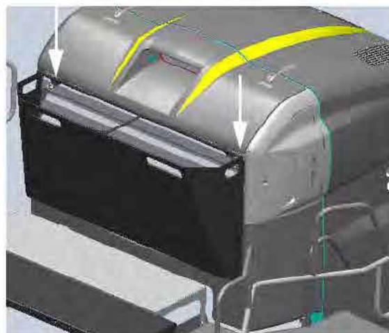
Brides à ressort de la prise d'air du moteur (situées en haut à gauche et à droite de la prise d'air intérieure)
