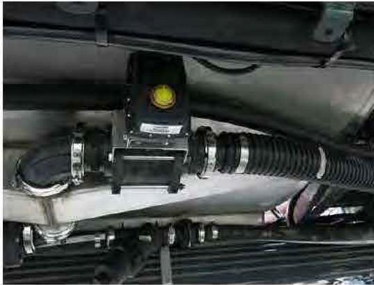
Vanne du réservoir de solution
