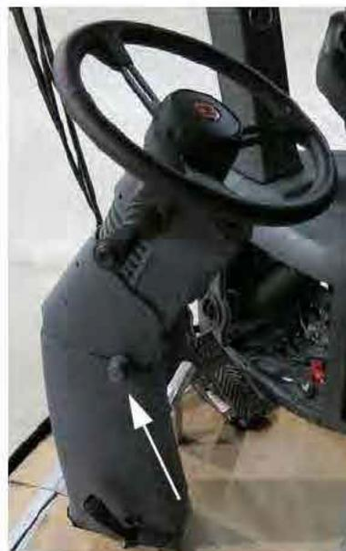
Bouton de réglage de l'inclinaison de la colonne de direction (situé sur le côté gauche de la colonne de direction)
