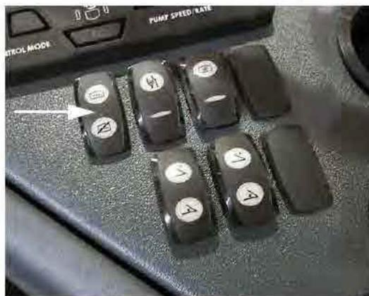
Interrupteur de la vanne du réservoir principal (situé sur la console latérale)
