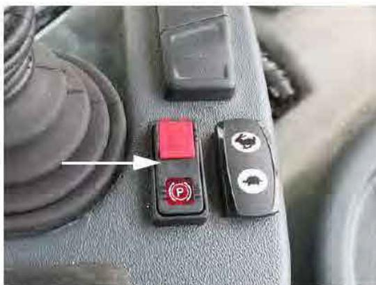
Interrupteur du frein de stationnement (situé près du levier de vitesse de la transmission hydrostatique)
