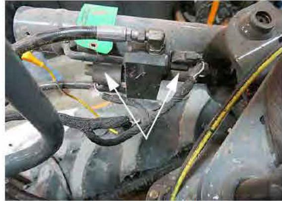
Soupapes de verrouillage
