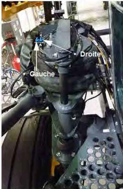
Vannes de la suspension pneumatique
