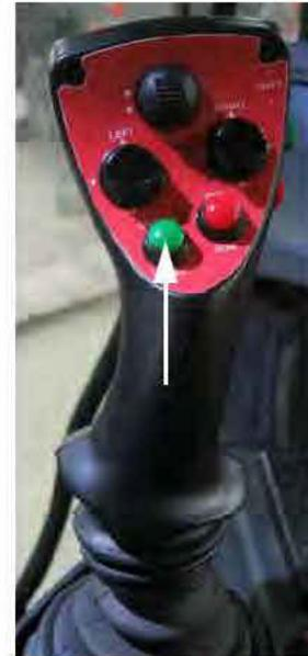
Interrupteur du pulvérisateur principal (situé sur le levier de vitesse de la transmission hydrostatique)
