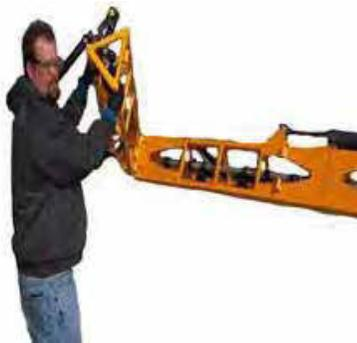
3. Fixez en place à l'aide du boulon de fixation arrière.
