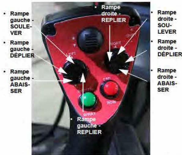
Commutateurs des rampes droite et gauche (situés sur le levier de vitesse de la transmission hydrostatique)
