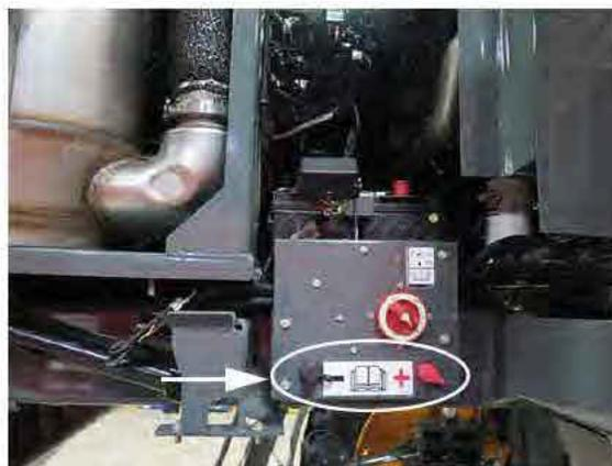
Bornes de charge de la batterie auxiliaire
