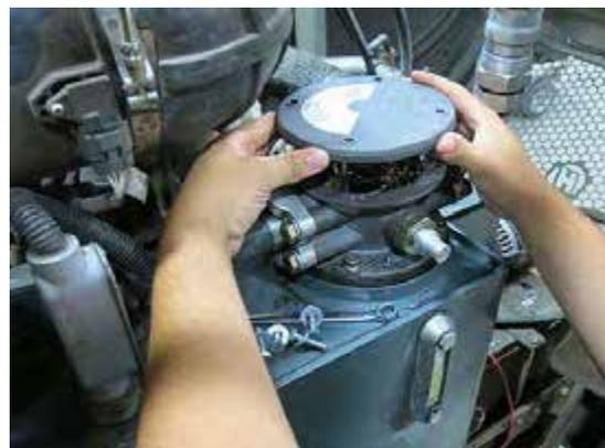
Remplissage du réservoir par le haut du boîtier du filtre de retour hydraulique
