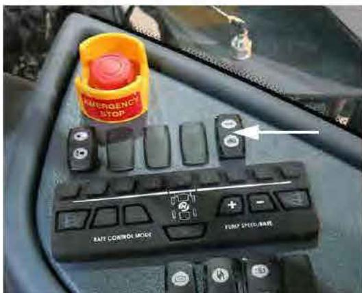
Interrupteur de rinçage
