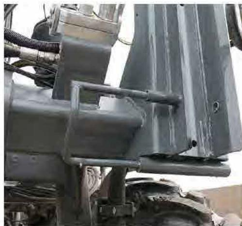
Clavette de sécurité (situées à l'avant gauche et droit de la machine)
