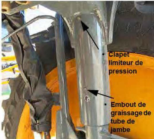
Embout de graissage de tube de jambe et clapet limiteur de pression (situés sur les jambes avant et arrière)
