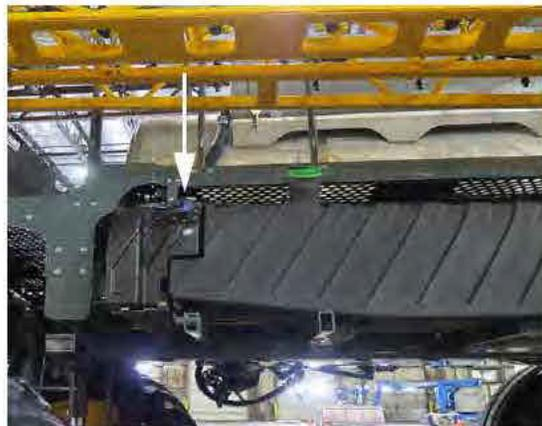
Bouchon de remplissage de l'AUS 32 (située sur la partie avant du réservoir d'AUS 32)
