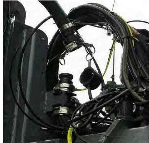
Branchement du système de solution (situé sur le côté avant droit de la machine)
